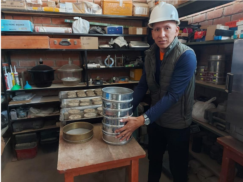
Ensayo de granulometría con los tamices normados
