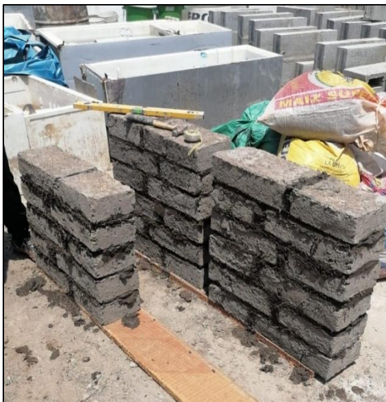
Fig 17. Elaboración y resultado de los muretes con dimensiones de 0.60x0.60m.
