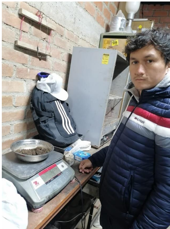
Cuarteo de suelo para ensayo de granulometría
