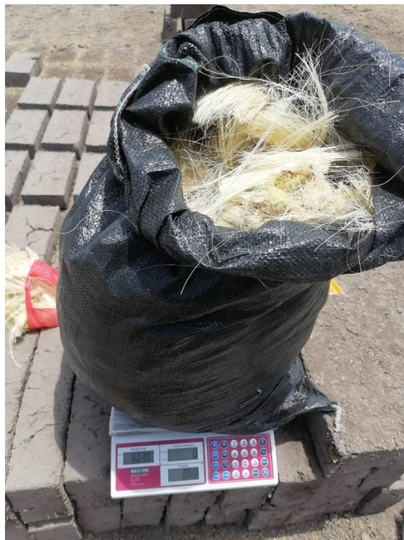
Fibra de Sisal obtenida y cortada para realizar la investigación
