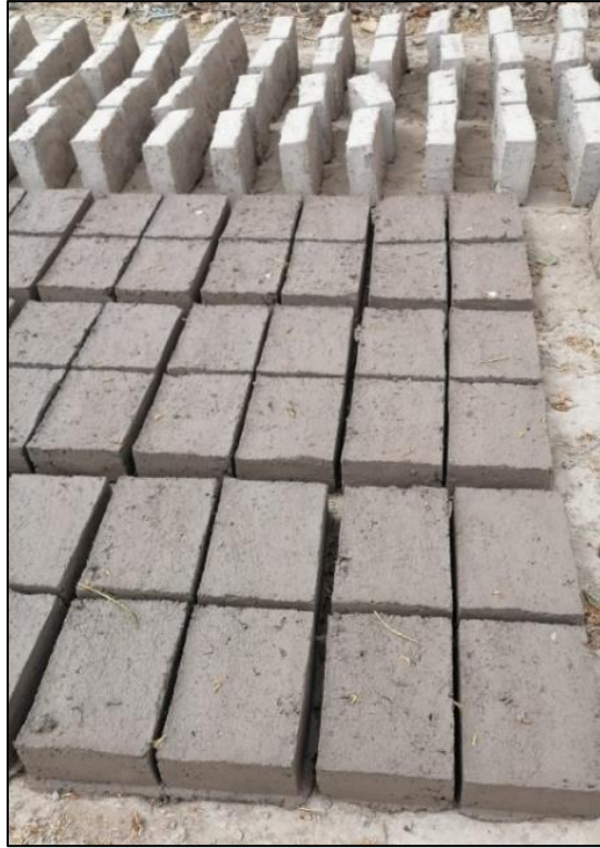
Fig 1. Elaboración de adobes para la investigación
