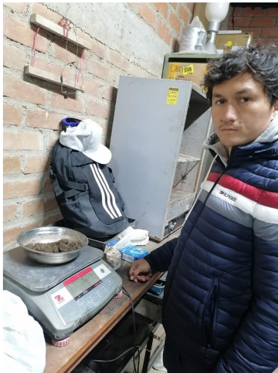
Cuarteo de suelo para ensayo de granulometría
