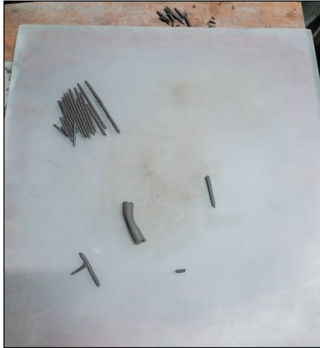
Fig 11. Elaboración Bastones para ensayo, determinación del límite plástico
