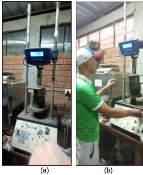
Fig 14. Ensayo para determinar la resistencia a la compresión.
