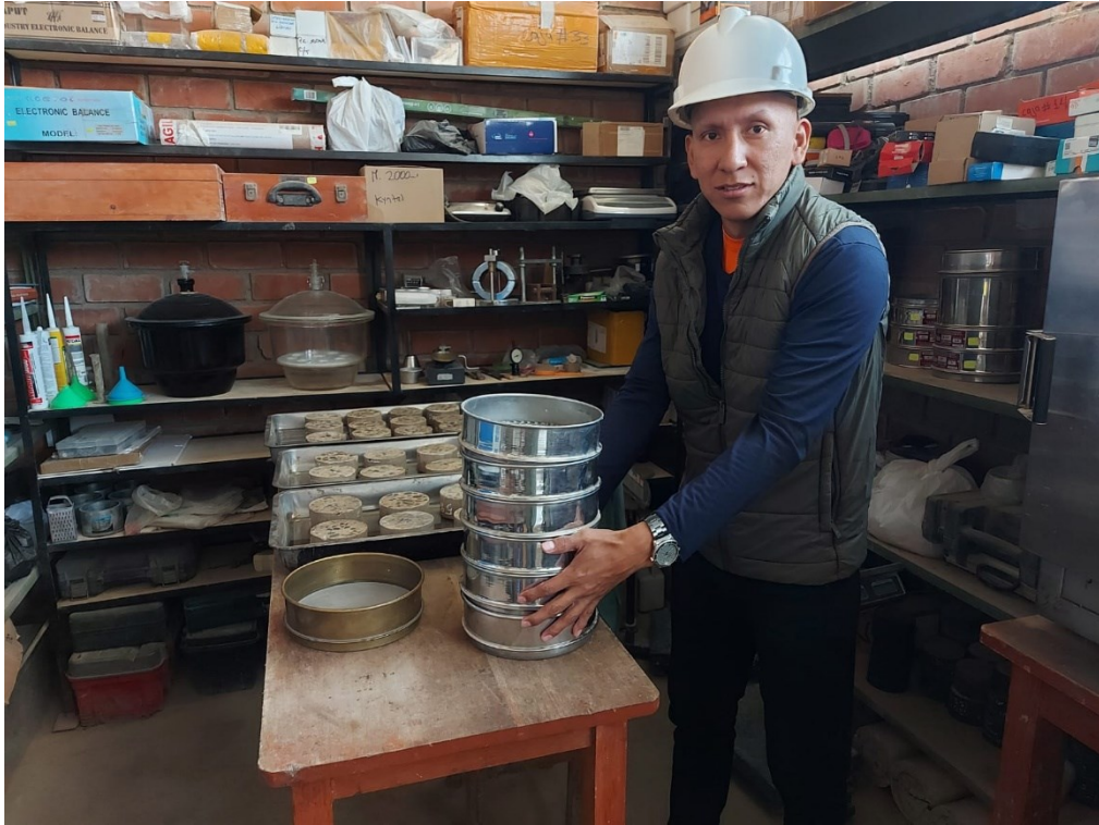
Ensayo de granulometría con los tamices normados
