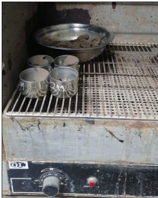
Fig 10. Muestras para obtener los límites de Atterberg puestas al horno.
