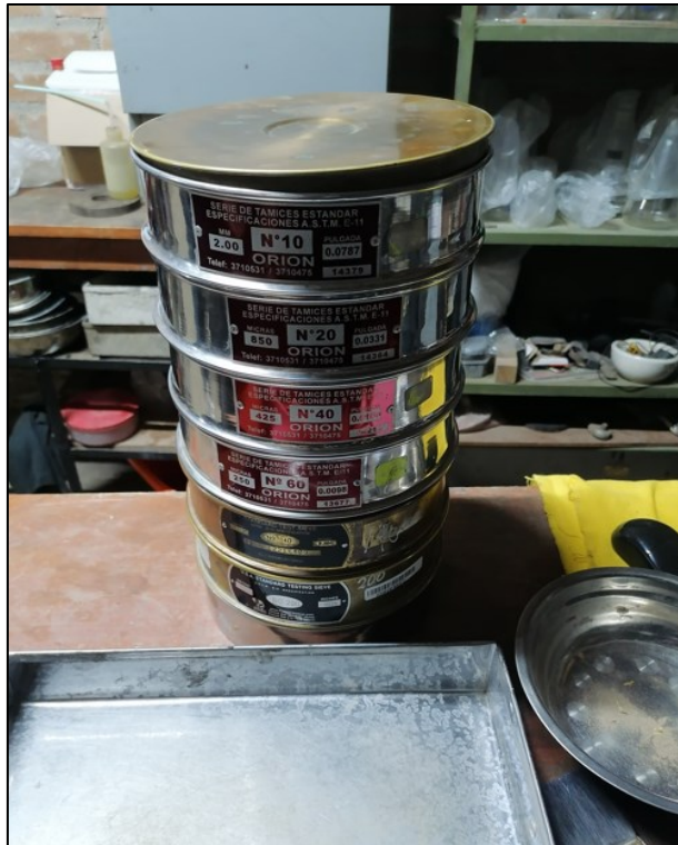
Fig 8. Mallas usadas para el ensayo de granulometría.
