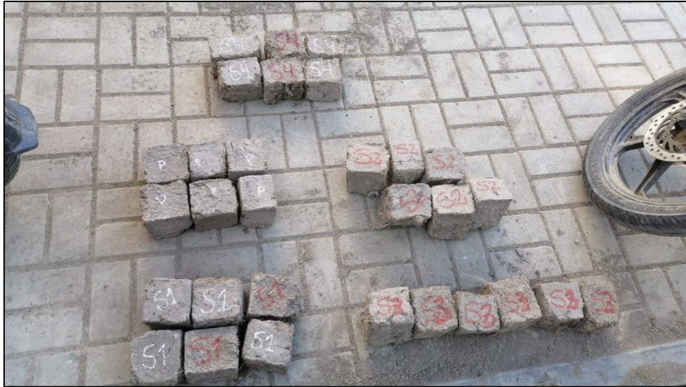
Fig 13. Adobe en cubos listos para ensayo de compresión.
