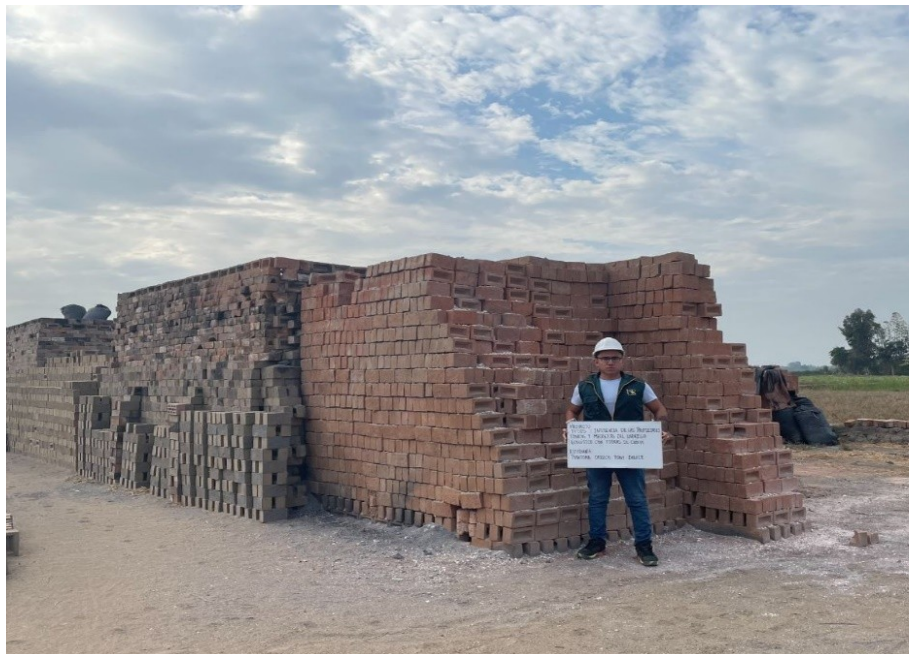
Fotografía 08: Horno artesanal para la elaboración de los ladrillos
