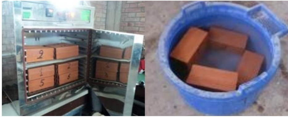
Fig. 4. Ensayo de absorción de unidades de ladrillo
