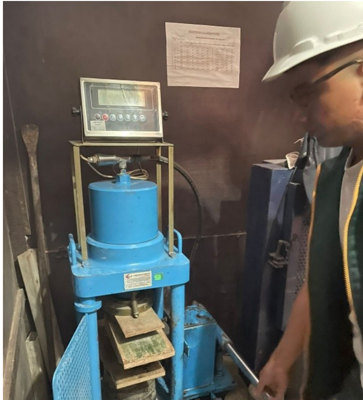
Fotografía 13: Ensayo de compresión en unidad de ladrillo
