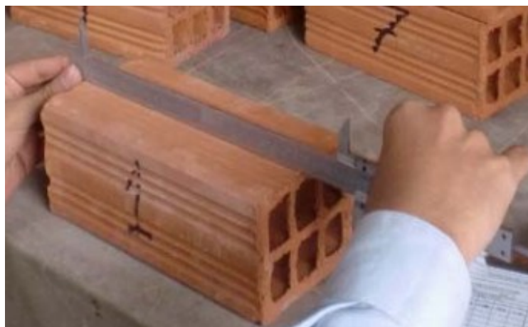
Fig. 3. Dimensionamiento del ladrillo
