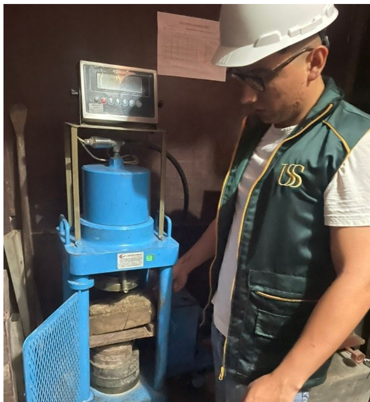
Fotografía 14: Ensayo de flexión en unidad de ladrillo
