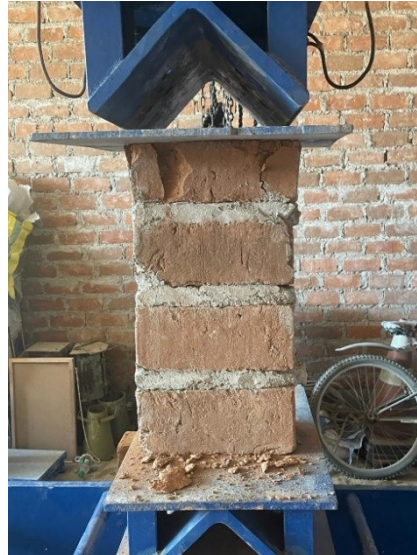
Fig. 6. Ensayo de compresión en pilas
