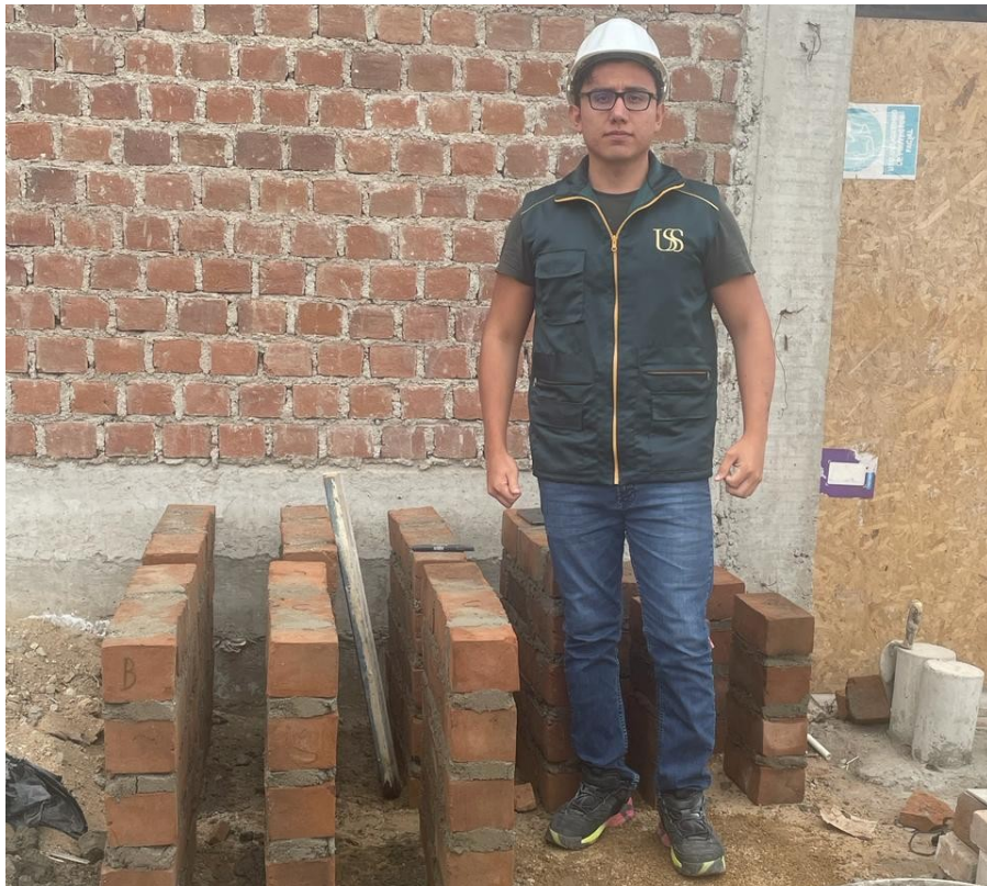
Fotografía 15: Elaboración de muretes y pilas para ensayos mecánicos en albañilería
