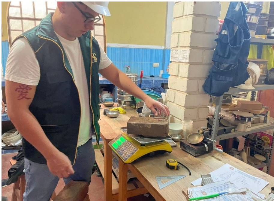
Fotografía 12: Ensayo porcentaje de absorción – pesado de ladrillo con fibra de cabuya
