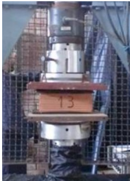
Fig. 5. Ensayo de compresión de unidades de ladrillo
