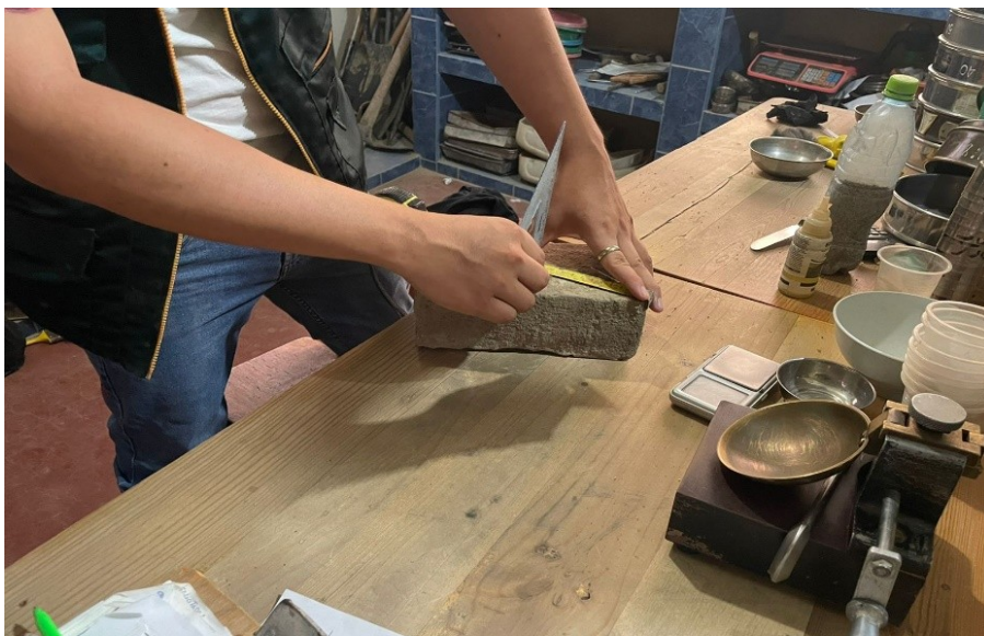
Fotografía 10: Ensayo de Alabeo
