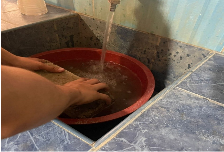
Fotografía 11: Ensayo de Absorción de unidad de ladrillo
