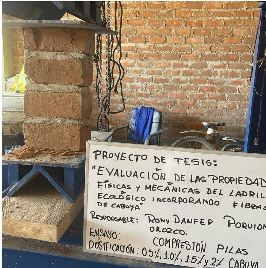
Fotografía 17: Rotura en ensayo de compresión en pilas
