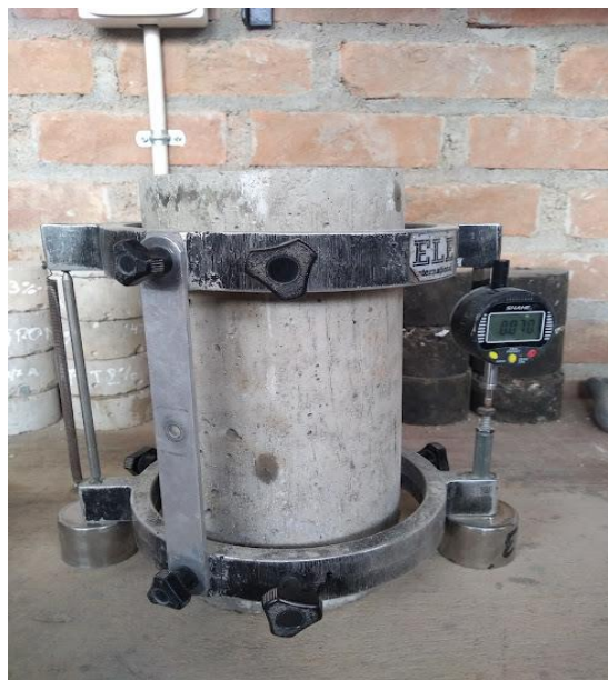
Fig. 20. Ensayo de Modulo elástico del Concreto
