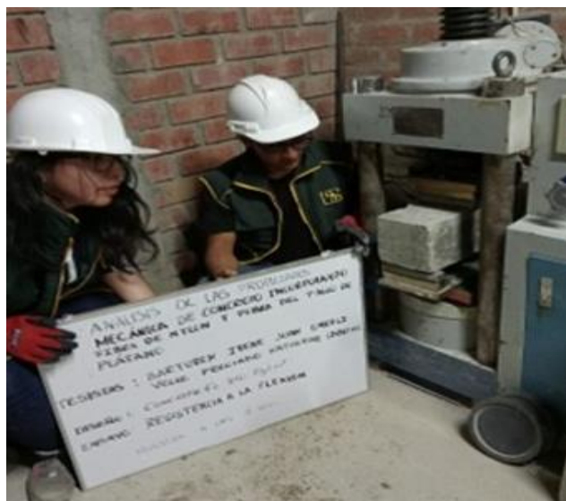
Fig. 19. Ensayo de la Resistencia a la Flexión del Concreto
