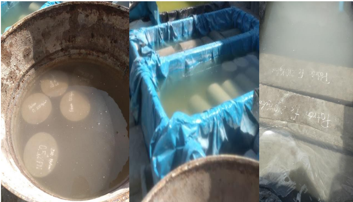
Fig. 38. Curado de Probetas y Vigas
