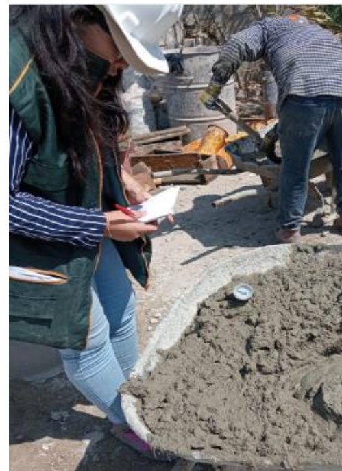
Fig. 36. Ensayo de Temperatura
