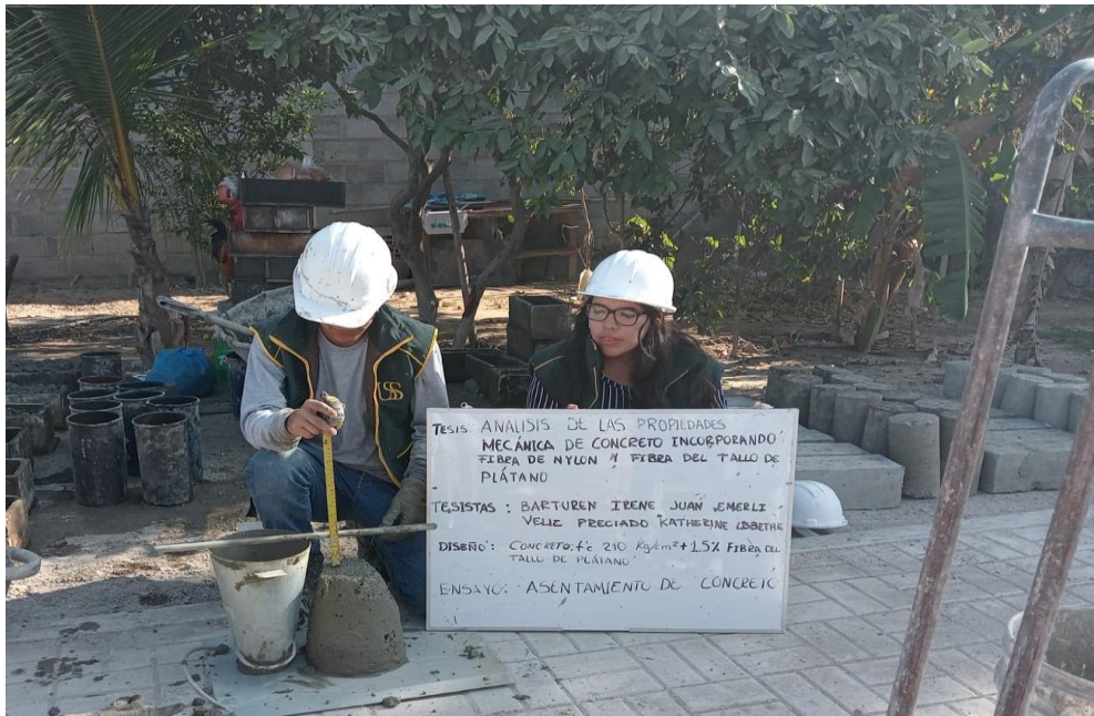
Fig. 34. Ensayo de Asentamiento del Concreto f'c 210kg/cm 2 +1.5% FTP
