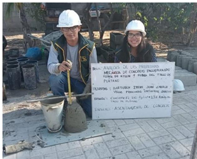
Fig. 14. Ensayo de Asentamiento del Concreto
