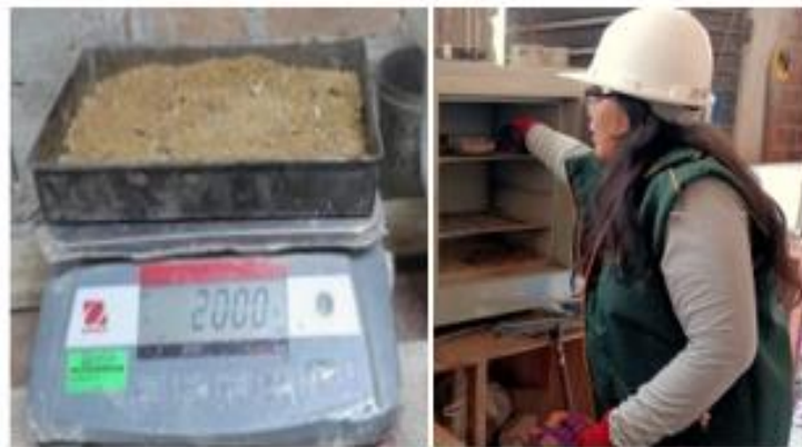
Fig. 11. Ensayo del Contenido de Humedad
