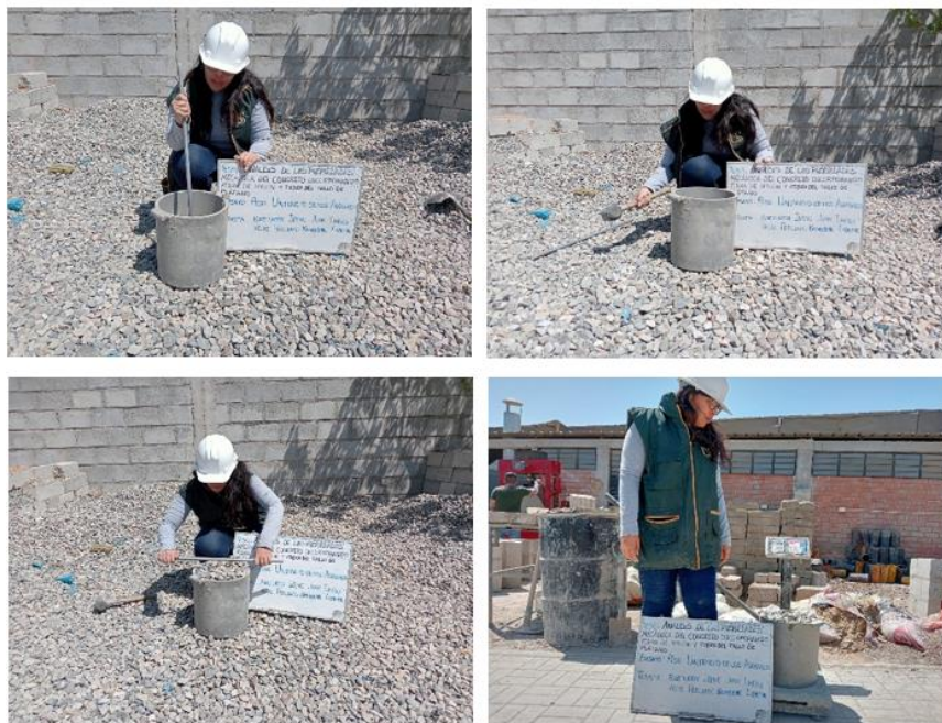
Fig. 31. Procedimiento del Ensayo de Peso Unitario de los Agregado Grueso
