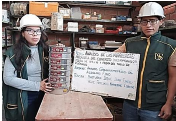
Fig. 9. Granulometría del Agregado Grueso
