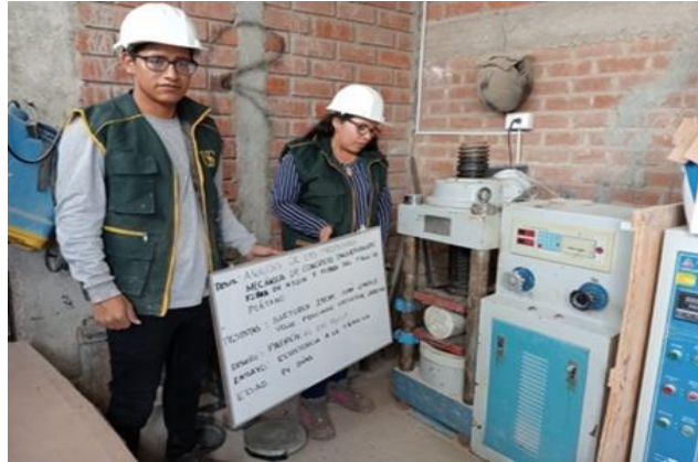
Fig. 18. Ensayo de la Resistencia a la Tracción del Concreto
