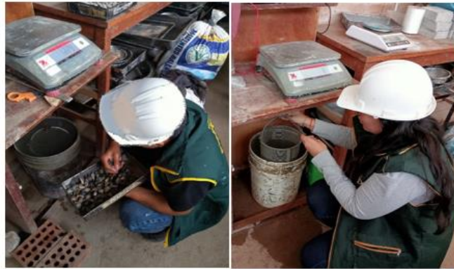
Fig. 32. Ensayo del Peso específico y porcentaje de absorción del agregado grueso
