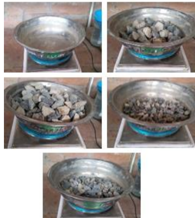
Fig. 30. Ensayo Granulométrico de los Agregado Grueso
