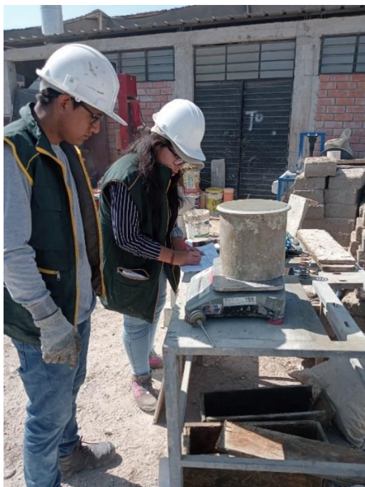
Fig. 35. Ensayo de Peso Unitario
