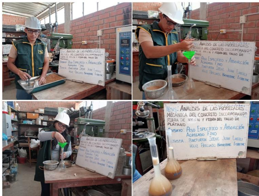
Fig. 33. Ensayo del Peso específico y porcentaje de absorción del agregado fino
