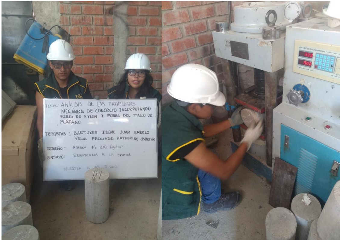
Fig. 43. Ensayo de Resistencia a la Tracción
