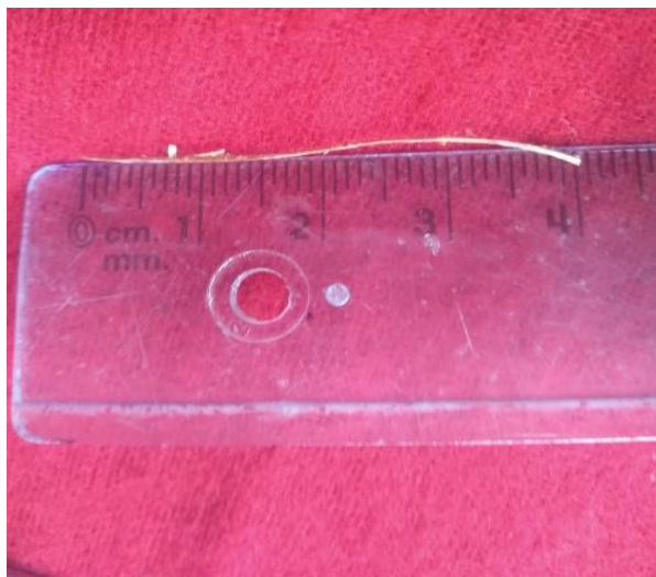
Fig. 7. Medición de la fibra del tallo de plátano
