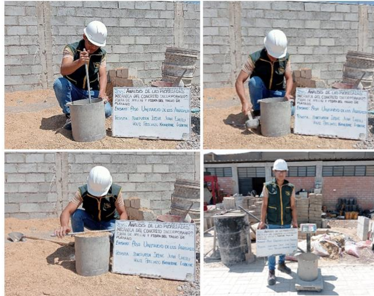
Fig. 10. Procedimiento del Ensayo de Peso Unitario de los Agregados Fino
