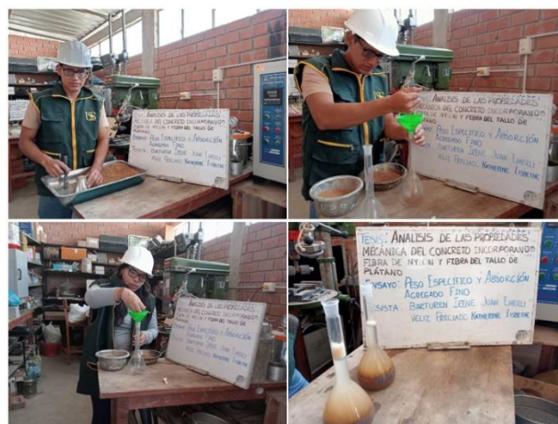
Fig. 13. Ensayo del Peso específico y porcentaje de absorción del agregado fino
