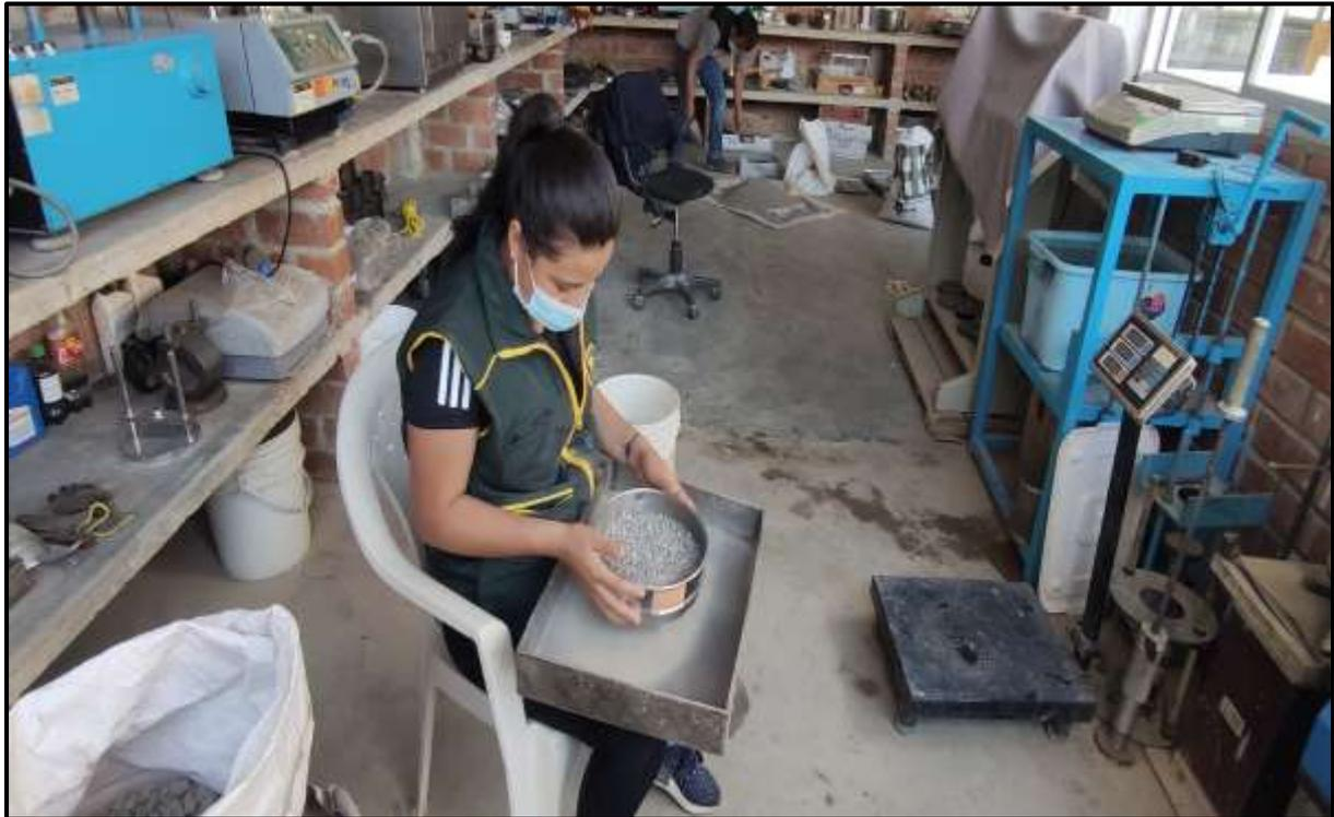
**Ilustración 9. Tamizado de concreto reciclado pasado por la pulverizadora por la malla N° 50**
