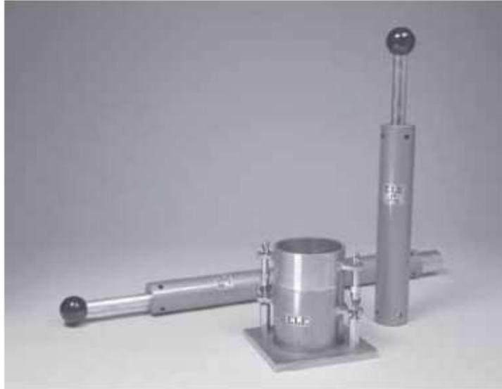
**Fig. 8.** Martillos utilizados en los ensayos Proctor estándar y modificada. [33]
