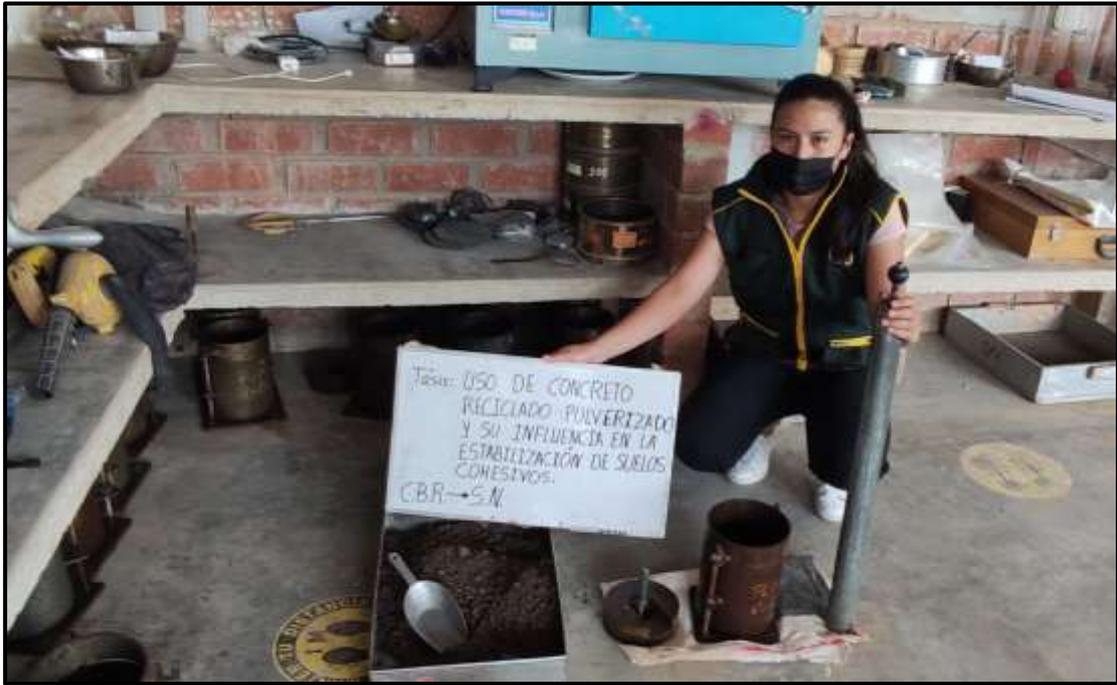
Ilustración 5. Ensayo de CBR del suelo natural
