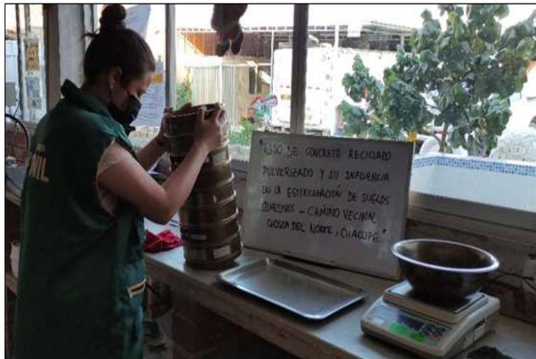
**Fig. 21.** Granulometría a través del tamizado
