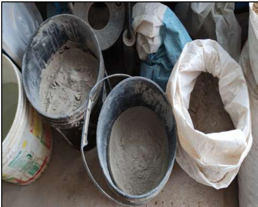
**Ilustración 10. Almacenamiento del concreto reciclado pulverizado pasado por malla N°50**
