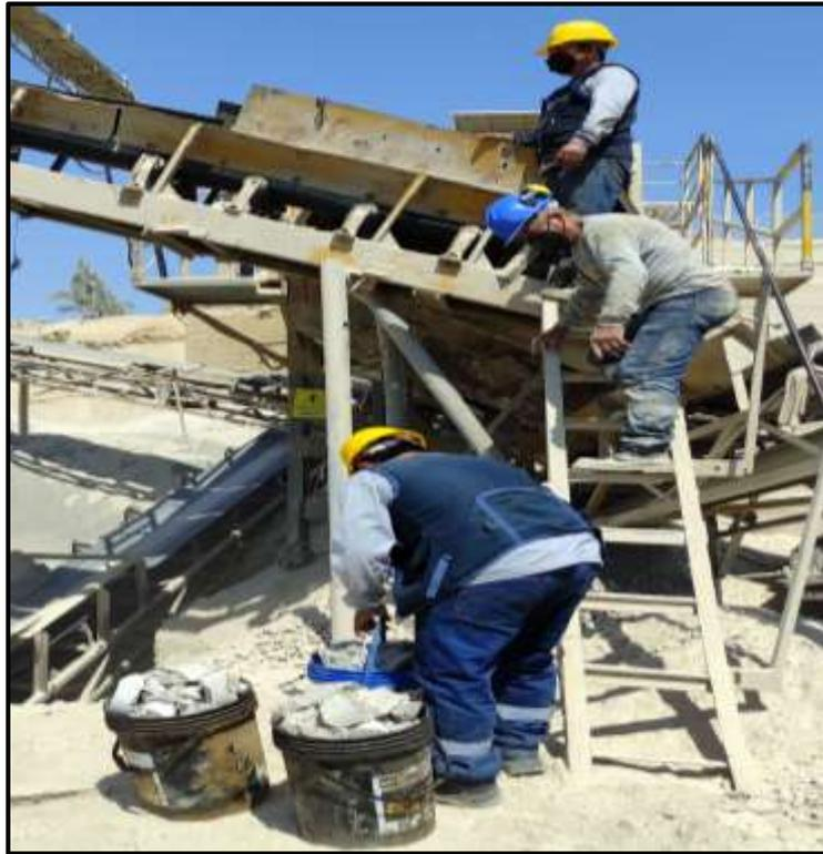
**Ilustración 7. Concreto reciclado llevado a cantera para realizarse el proceso de pulverización**
