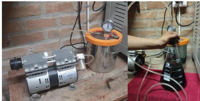
**Fig. 7.** Ensayo Rice
