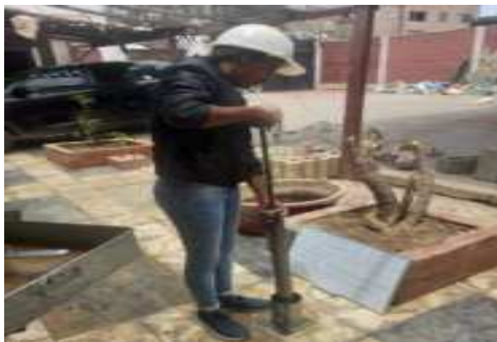
Fig. 21. Proceso de ensayo de análisis de Proctor modificado - Ensayo de compactación.
