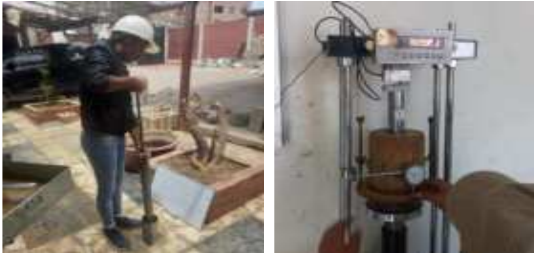
Fig. 36. Determinación de las propiedades mecánicas de Compactación y CBR.
