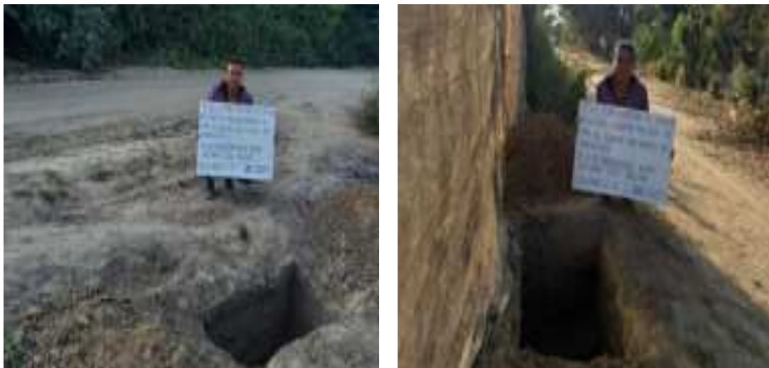
Fig. 33. Obtención de muestras de la calicata 03 y 04.
