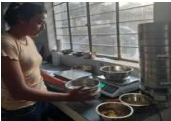
Fig. 15. Muestreo de proporciones retenidos de cada tamiz de la muestra de suelo arcilloso.
