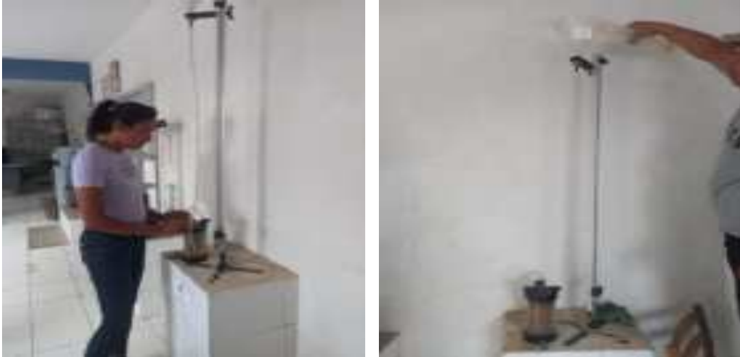
Fig. 38. Determinación de la permeabilidad de las muestras de suelo naturales.
