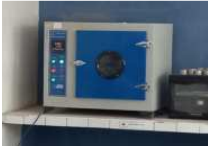
Fig. 18. Determinación del contenido de humedad natural de la muestra de suelo.
