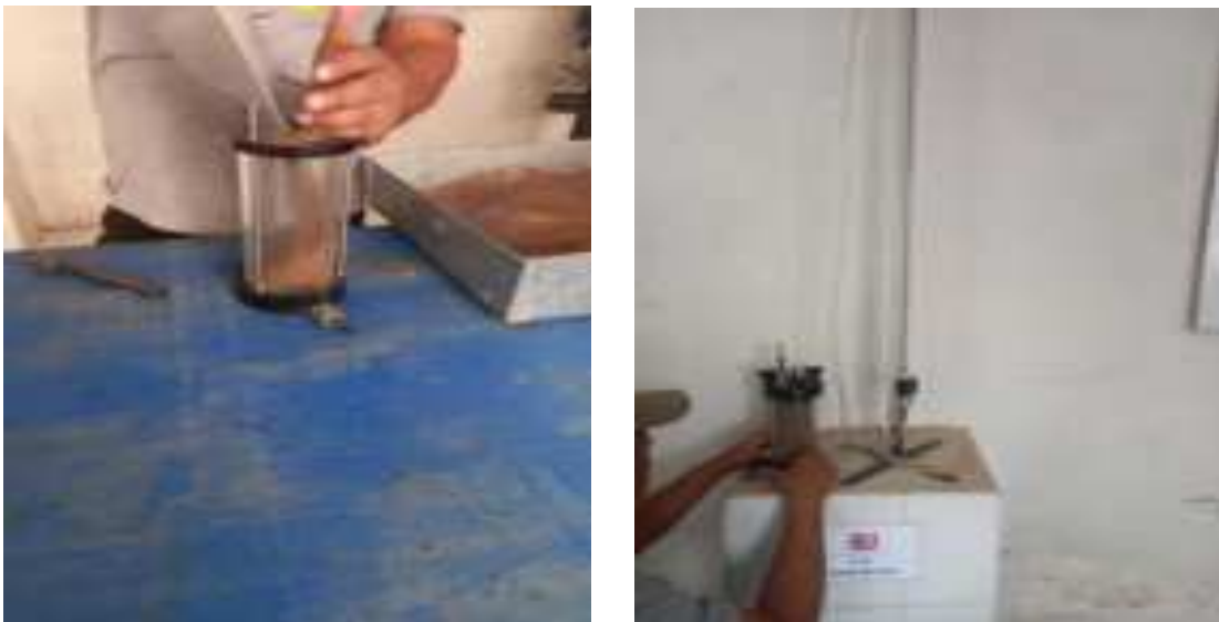
Fig. 39. Determinación de la permeabilidad de las muestras de suelo adicionando melaza de caña de azúcar en porcentajes de 3%, 5%, 7% y 9%.
