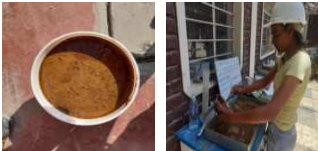
Fig. 37. Preparación de las muestras de suelo adicionando melaza de caña de azúcar en porcentajes de 3%, 5%, 7% y 9%.
