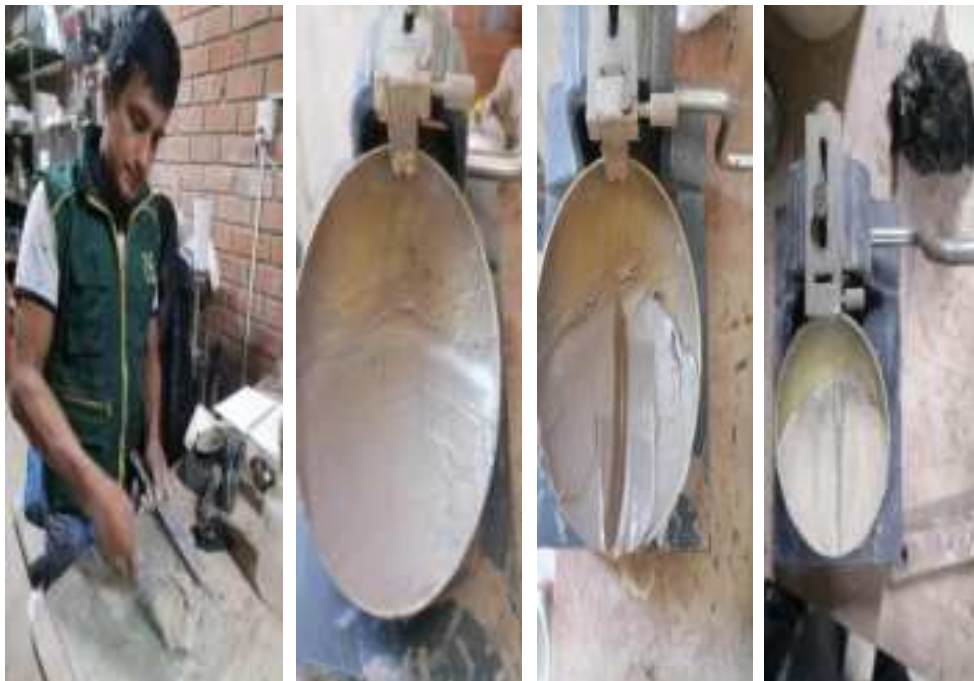
Fig. 18. Ensayo se verifica la copa de casa grande
