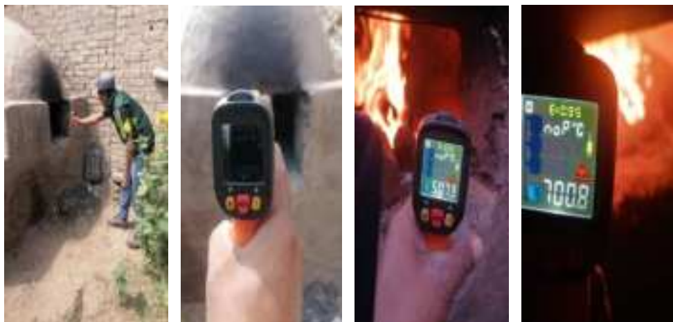
Fig. 16. Calcinación De Los Materiales SCBA y RHA Para Estabilización De Suelos.
