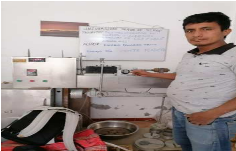
Fig. 23. Prueba de corte directo a la muestra después de ser saturada.
