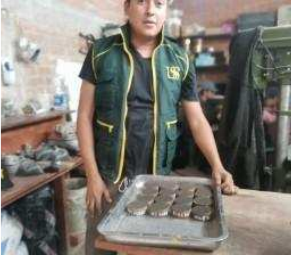
Fig. 24. Muestras saturadas para realizar la prueba de corte con adición de cenizas.
