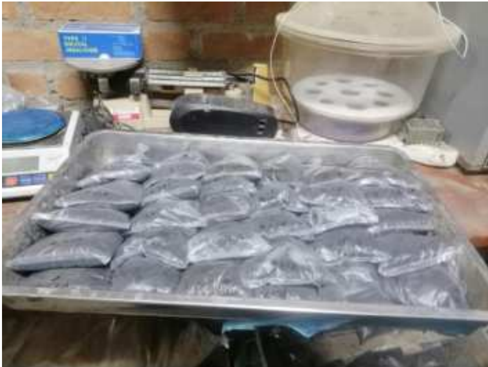
Fig. 27. Saturación de suelo natural, adicionando cenizas.
