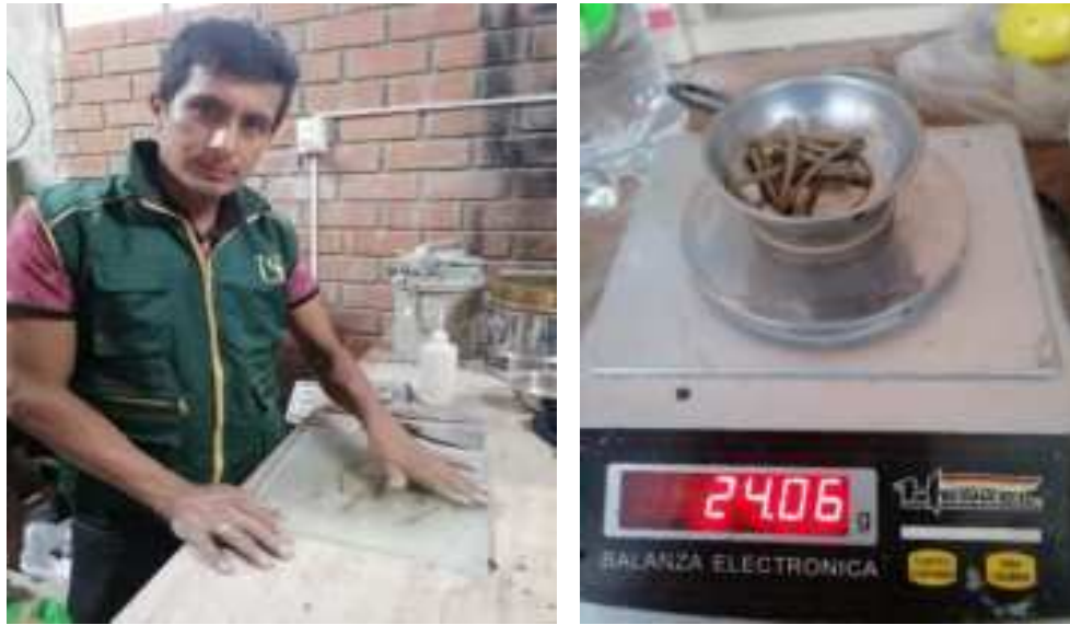
Fig. 21. Ensayo de limite plástico.
