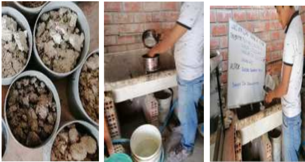
Fig. 25. Lavado del árido para ensayos de granulometría.
