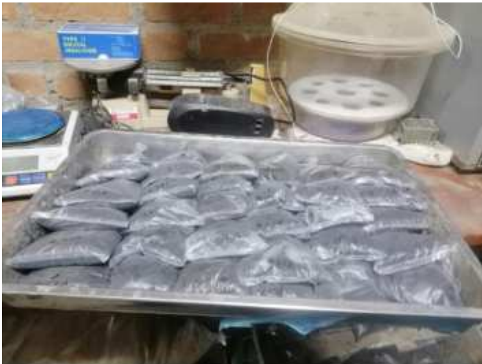
Fig. 27. Saturación de suelo natural, adicionando cenizas.
