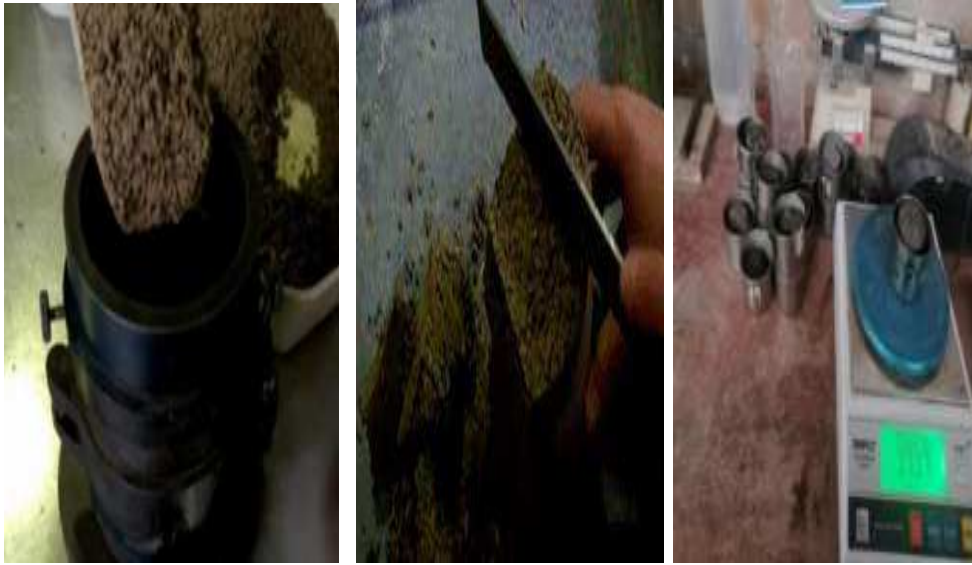
Fig. 29. Ensayo de Proctor modificado.
