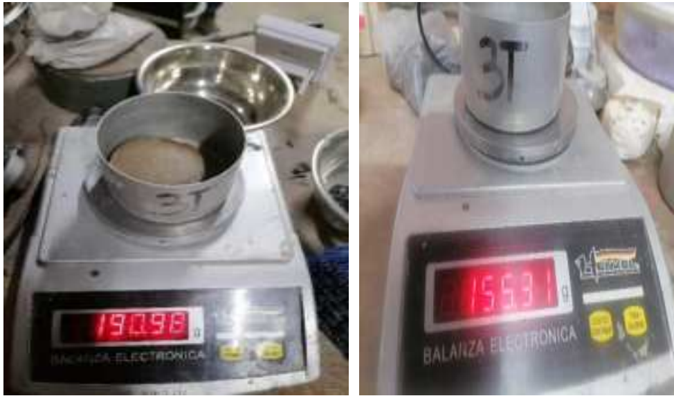
Fig. 26. Muestra Del Ensayo De Corte Directo Antes Y Después De Pasar Al Secado.
