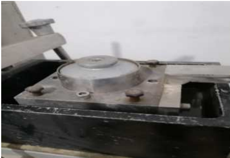
Fig. 22. Colocando Suelo natural para saturar.
