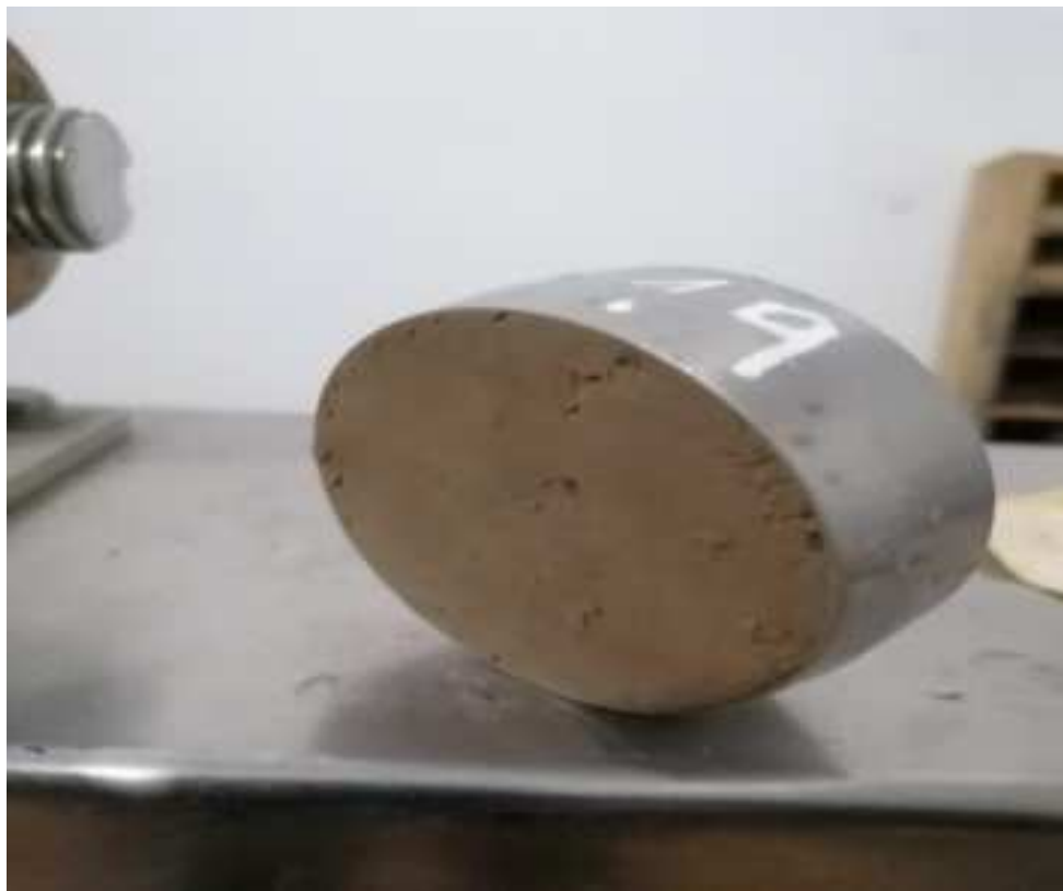
Fig. 20. Ensayo corte directo.
