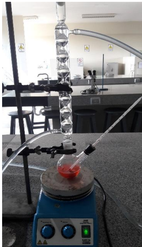
Figura 6 Sistema de extracción por destilación a reflujo
