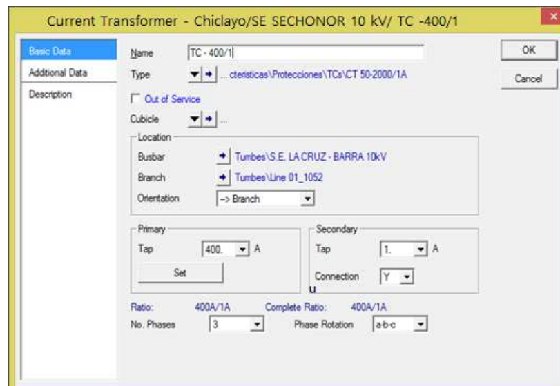
Figura 46: Entrada de información del TC en el DigSilent Power Factory, Relé G,E F650,
