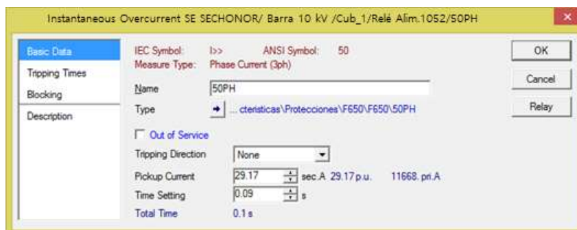
Figura 48: Ajuste de protección tiempo definido (50) – Fases, G,E F650,
