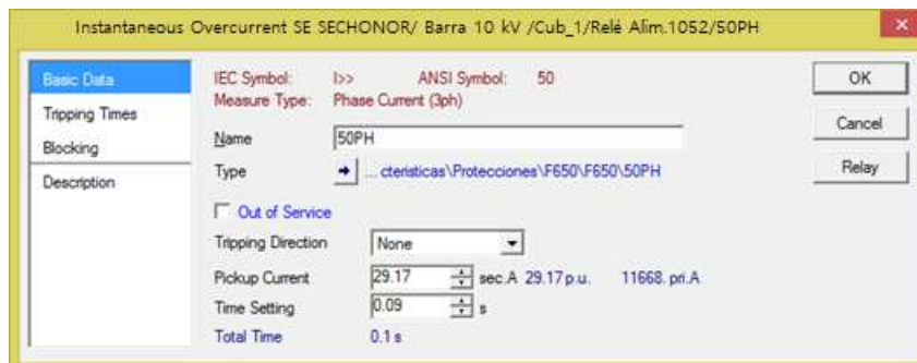
Figura 31: Protección ajustada por tiempo específico.(50) – Fases G,E F650
