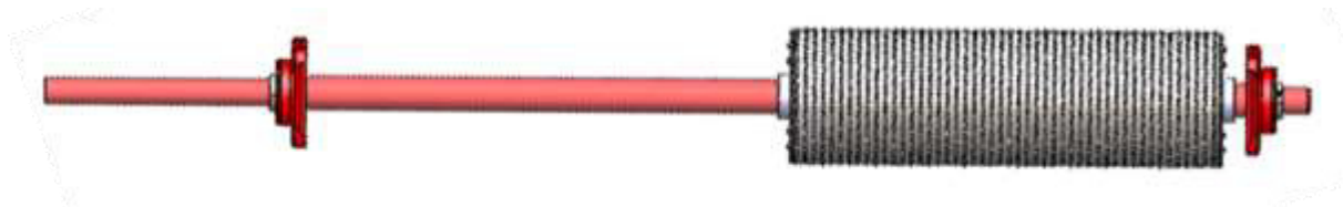
Fig. 23. Eje del rallador removedor
