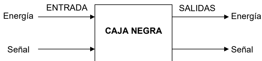
Fig. 11. La caja negra es utilizada para representar la función global del mecanismo
