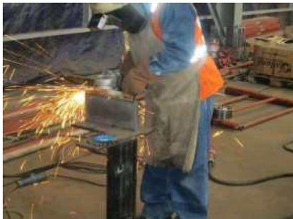
Se cortaron planchas con dimensiones de 300 mm x 300 mm x 30 mm de espesor y se procedió a maquinar los bordes en V.
