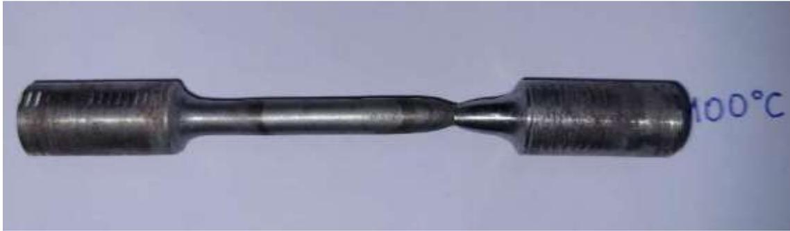
**Figura 28: Probeta de ensayo de tracción fracturada correspondiente a la últimas pasadas de soldadura de la junta soldada del acero DIN 1.8915 con una temperatura de precalentamiento de 100 °C.**
