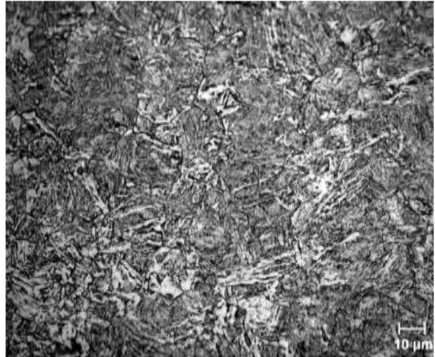
**Figura 36: ZAC de la junta soldada del acero DIN 1.8915 con una temperatura de precalentamiento de 200 °**
