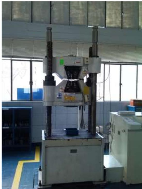
**Anexo 2: Máquina de ensayos de tracción Shimadzu**
