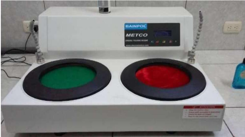
**Anexo 3: Preparación de maquina pulidora con pasta de diamante de 5  $\mu$ m y 1  $\mu$ m.**
