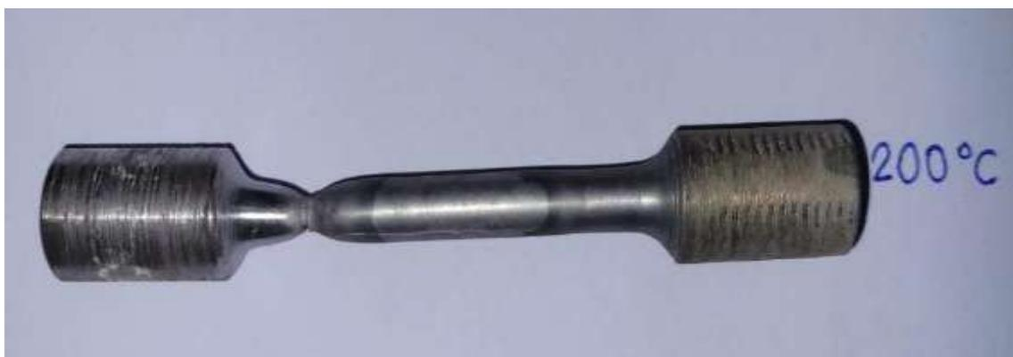
**Figura 39: Probeta de ensayo de tracción fracturada correspondiente a la últimas pasadas de soldadura de la junta soldada del acero DIN 1.8915 con una temperatura de precalentamiento de 200 °C.**
