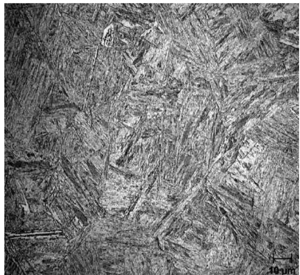
**Figura 24:** Estructura martensítica presente en los granos gruesos de austenita previa correspondiente a la ZACGG de la junta soldada del acero DIN 1.8915 con una temperatura de precalentamiento de 100 ° C.
