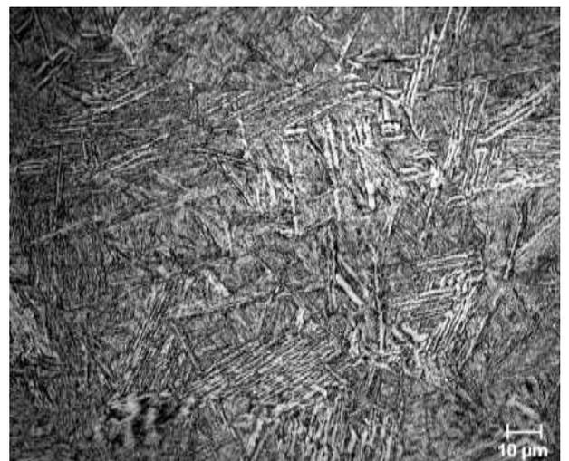
**Figura 34: Estructura martensítica presente en los granos gruesos de austenita previa correspondiente a la ZACGG de la junta soldada del acero DIN 1.8915 con una temperatura de precalentamiento de 200 ° C.**
