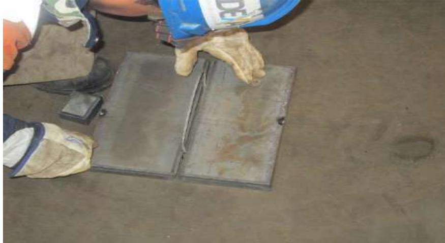
Mediante un equipo de oxicorte se calentaron las probetas a 100 °C y 200°C antes de soldar y entre cada pase la temperatura se controló con un pirómetro láser marca “FLUKE” que tiene una precisión de  $\pm 5^{\circ}\text{C}$ .
