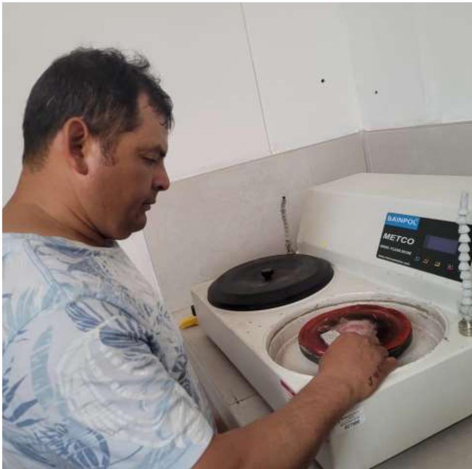
**Anexo 4: Pulido de probeta con pasta de diamante de 1  $\mu$ m.**
