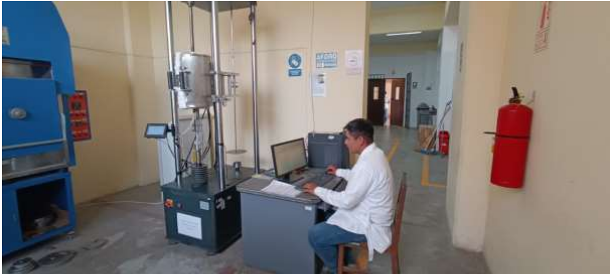
Anexo 3: Ejecución de maquinado de ensayo creep norma (GB/2039-1997).
