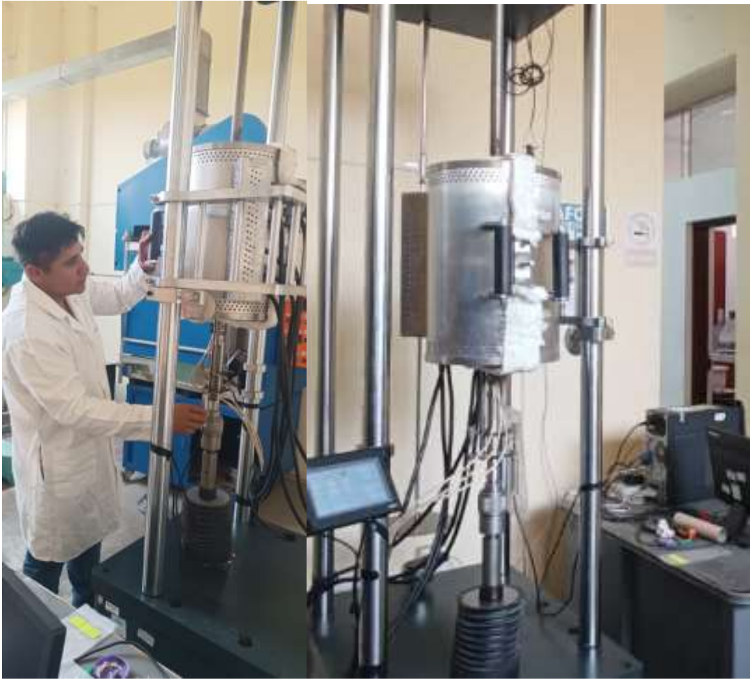
Anexo 1: preparación de máquina de ensayo creep normado (GB/2039-1997)
