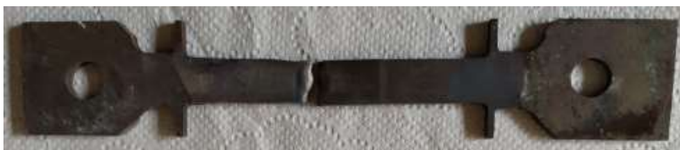
(d) Tratamiento térmico post soldadura de 8 h a 760 °C
