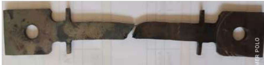
(b) Tratamiento térmico post soldadura de 2 h a 760 °C
