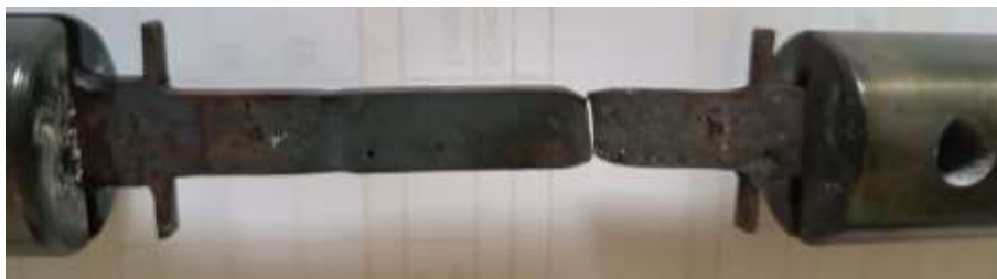
(c) Tratamiento térmico post soldadura de 4 h a 760 °C
