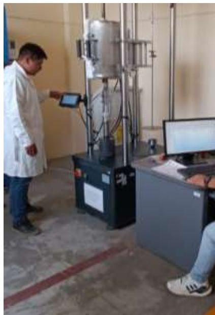
Anexo 4: probeta en maquina de ensayos bajo norma (GB/2039-1997) creep a 600 °C
