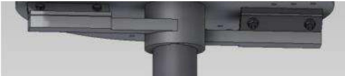
Figura 18: Posición de las cuchillas de corte
