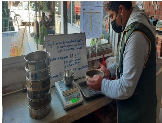
Fig. 7. Análisis granulométrico del agregado grueso
