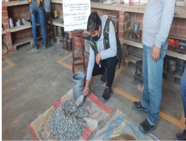
Fig. 9. Vaciado del agregado fino al molde metálico
