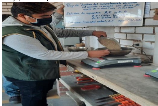
Fig. 6. Análisis granulométrico del agregado fino
