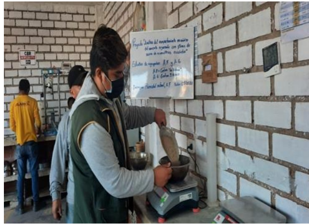
Fig. 11. Ensayo de contenido de humedad del agregado fino
