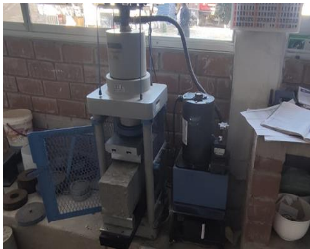
Fig. 17. Ensayo de resistencia a la flexión
