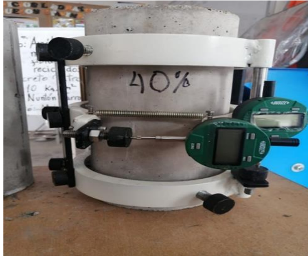
Fig. 18. Ensayos de módulo de elasticidad
