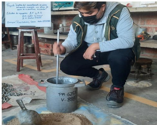
Fig. 8. Vaciado del agregado fino al molde metálico
