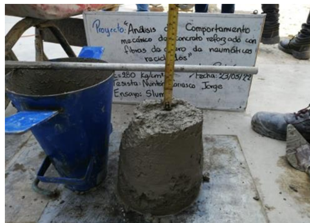
Fig. 13. Ensayo de asentamiento
