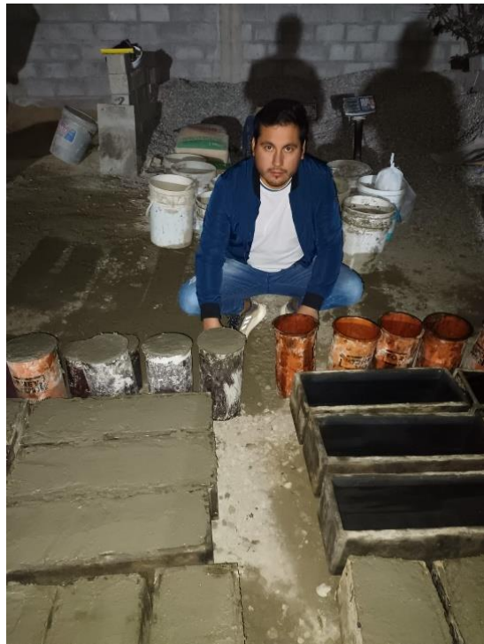
Figura 12: Vaciado de concreto patrón f'c 210 kg/cm 2 a los moldes de probetas y viguetas
