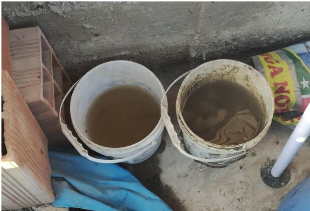
Figura 08: Muestras para ensayo de absorción y peso específico del agregado fino y grueso
