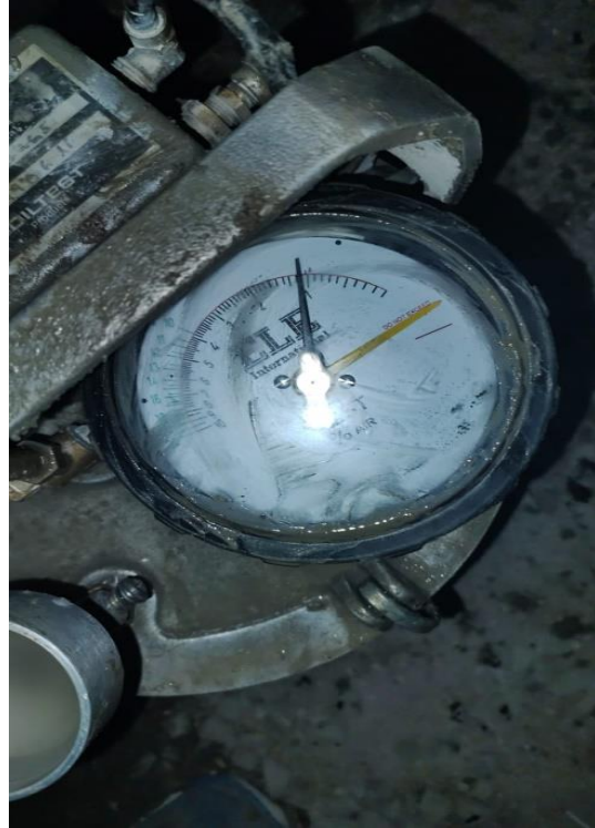
Figura 11: Ensayo de contenido de aire del concreto en su estado fresco
