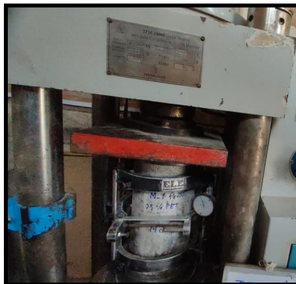
Fig. 8. Ensayo de módulo elástico
