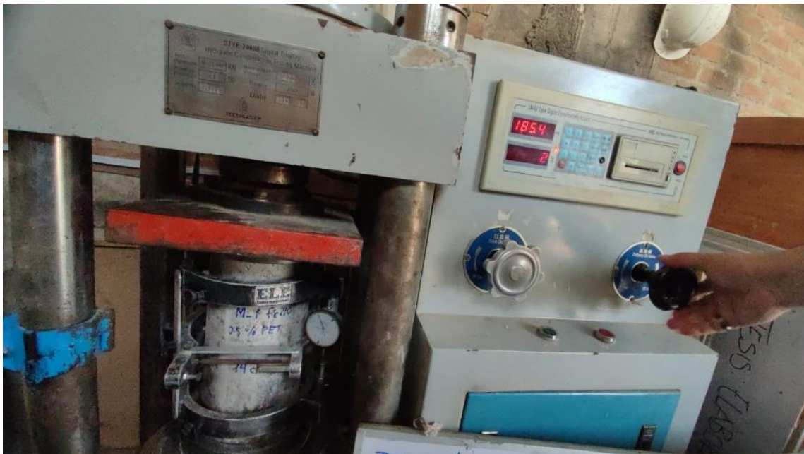
Figura 22: Colocación de probeta para ensayo de módulo de elasticidad
