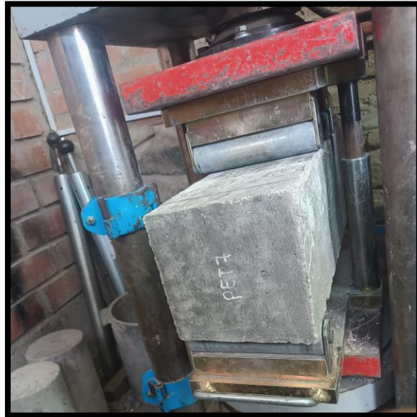
Fig. 7. Ensayo de resistencia a flexión
