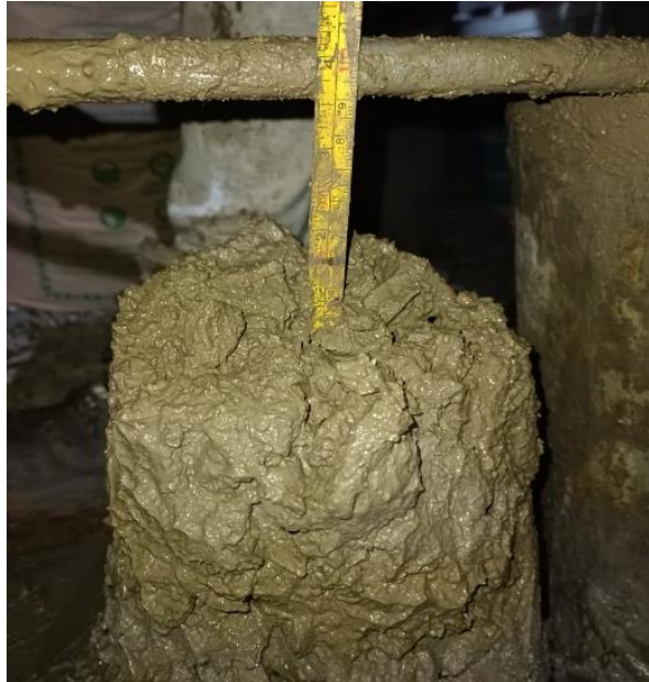
Figura 9: Ensayo de consistencia del concreto en su estado fresco
