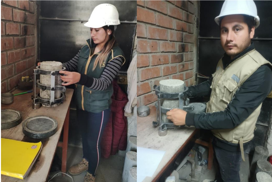
Figura 22: Colocación de probeta para ensayo de módulo de elasticidad
