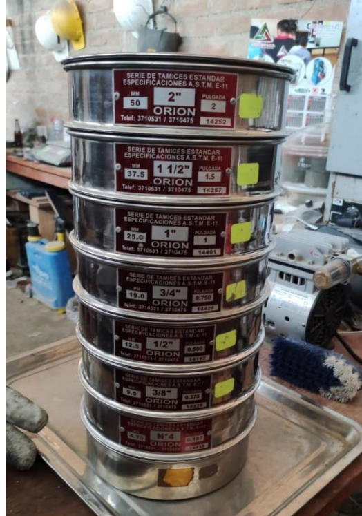
Fotografía 07: Ensayo de granulometría del agregado grueso
