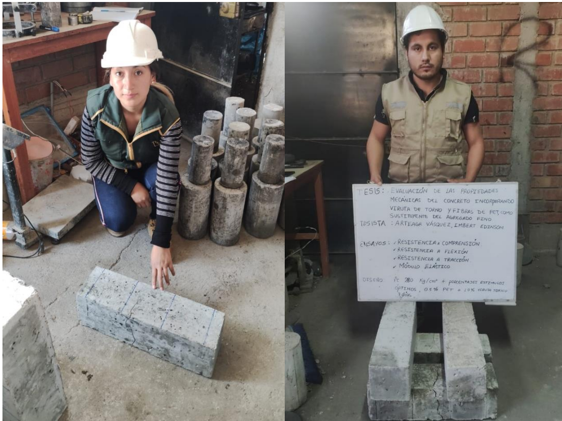
Figura 18: Resultado de la rotura de ensayo a flexión
