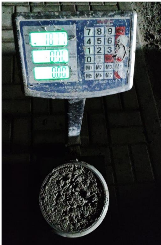
Figura 10: Ensayo de peso unitario y Temperatura del concreto fresco
