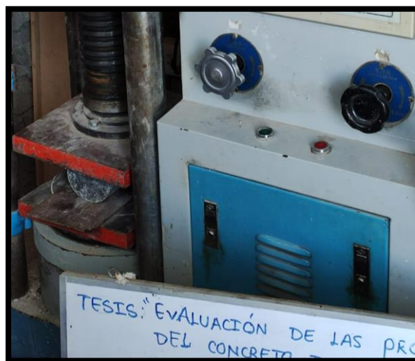
Fig. 6. Ensayo de resistencia a tracción
