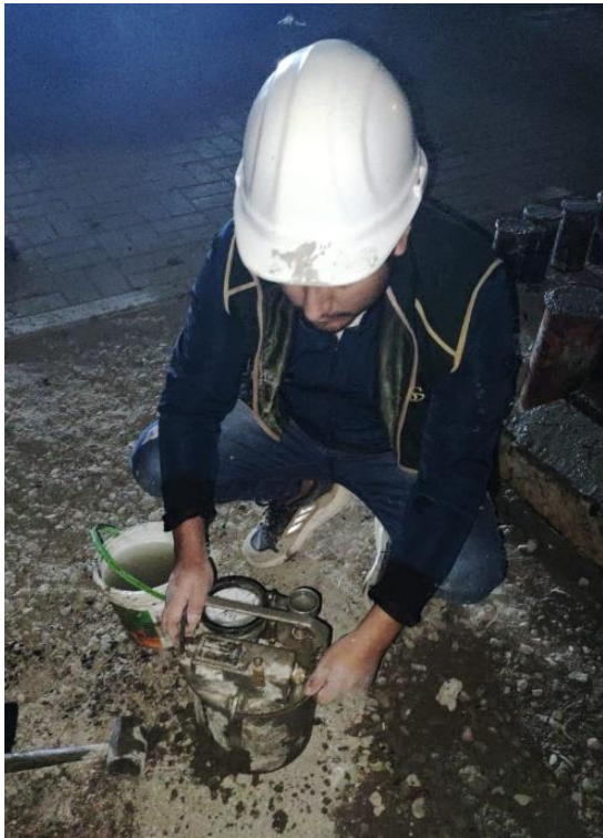
Figura 11: Ensayo de contenido de aire del concreto en su estado fresco
