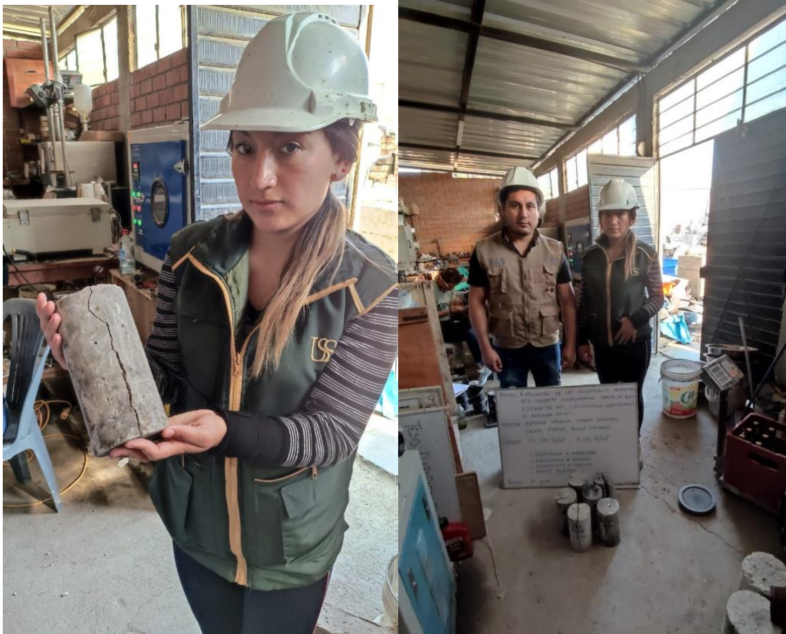
Figura 21: Rotura de probeta en ensayo a tracción
