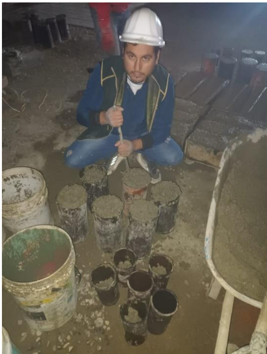
Figura 12: Vaciado de concreto patrón f'c 210 kg/cm 2 a los moldes de probetas y viguetas
