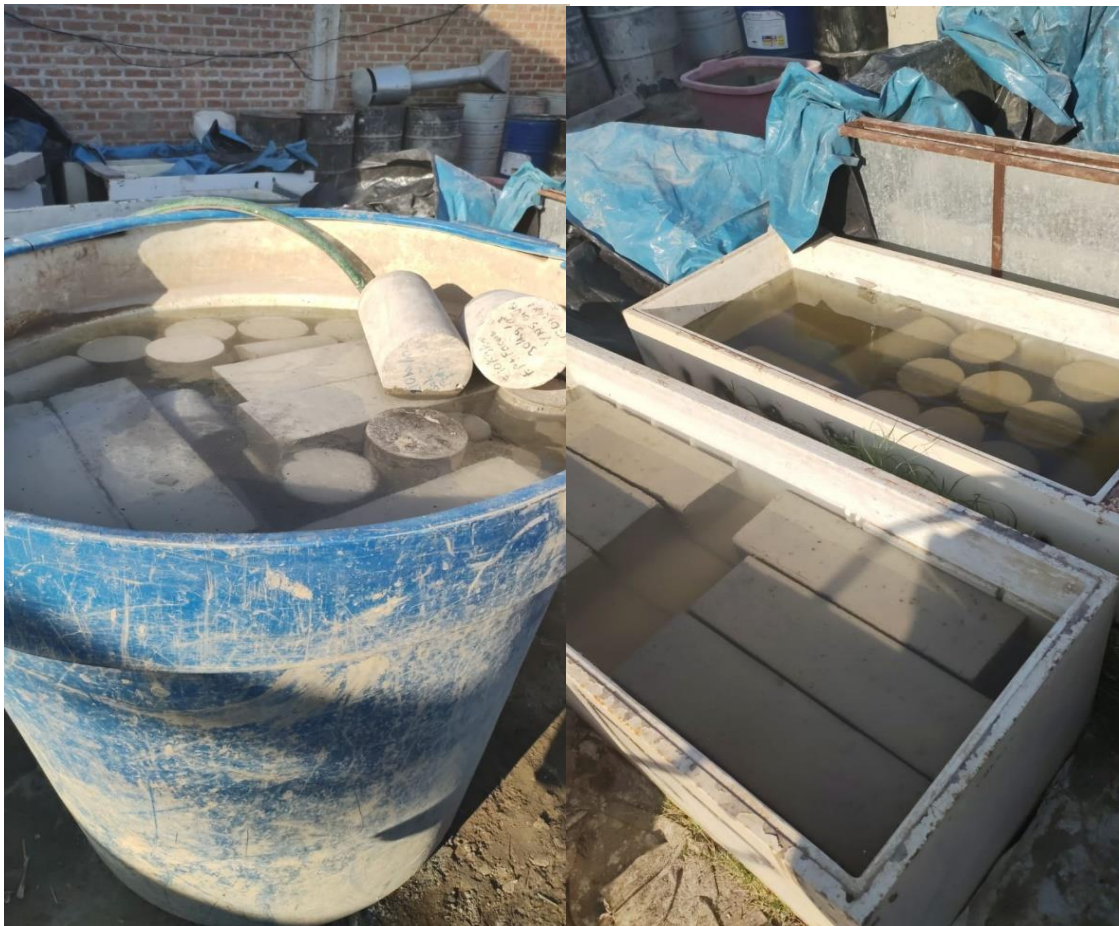
Figura 14: Curado de probetas y viguetas para proceder a ensayos
