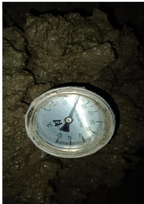
Figura 10: Ensayo de peso unitario y Temperatura del concreto fresco
