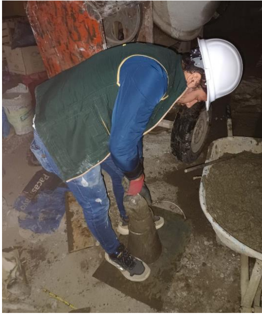
Figura 9: Ensayo de consistencia del concreto en su estado fresco
