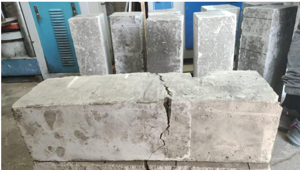
Figura 19: Rotura de viga en ensayo a flexión
