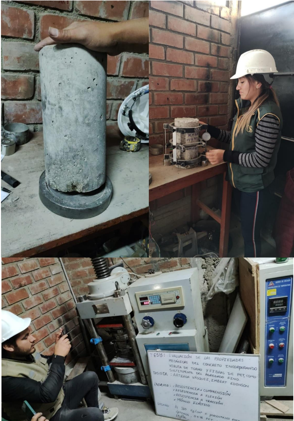
Figura 15: Ensayo de Módulo de elasticidad del concreto
