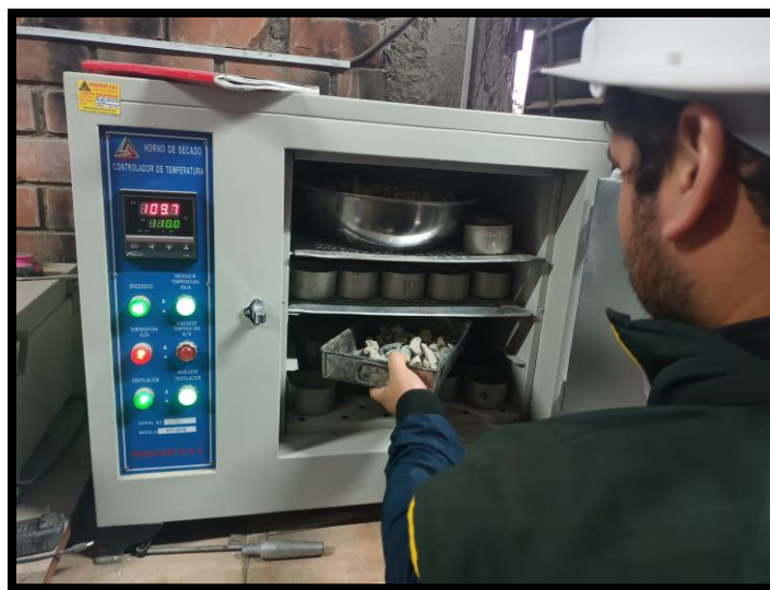
Fig. 2. Ensayo de contenido de humedad
