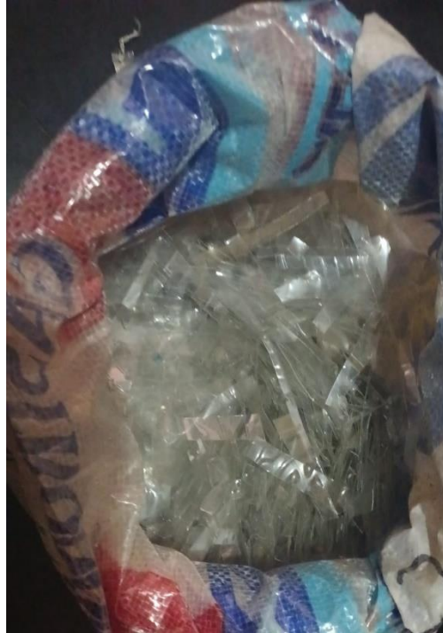
Fotografía 04: Fibra PET cortada en dimensiones de 0.075mm x 75mm
