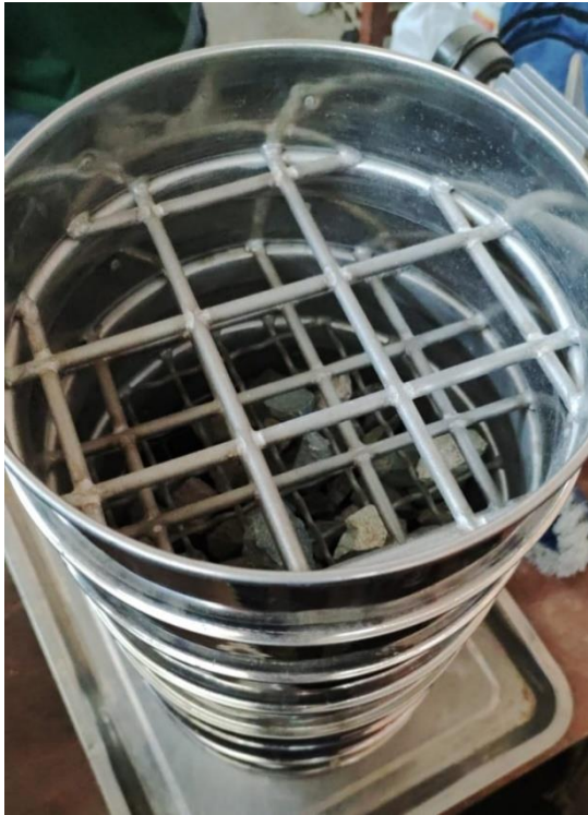
Fotografía 07: Ensayo de granulometría del agregado grueso
