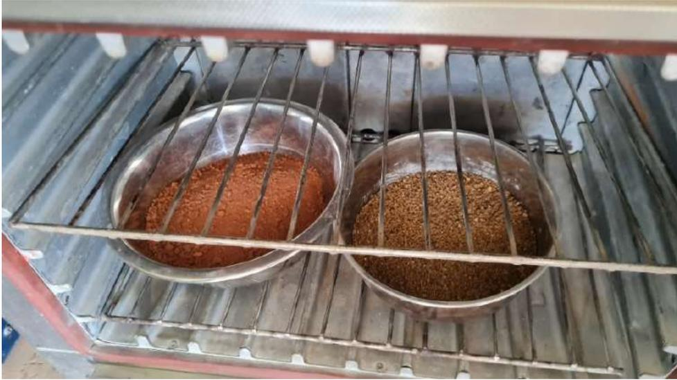
**Fig. 22.** Muestra de arena y ladrillo puesta al horno por 24 horas.
