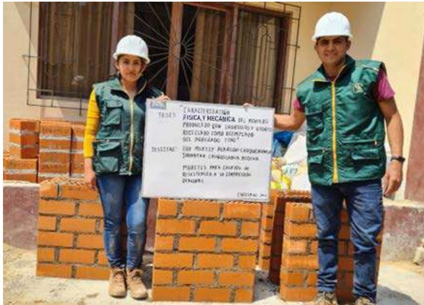
Muretes asentados con mortero con reemplazo parcial del agregado fino con ladrillo y vidrio reciclado.
