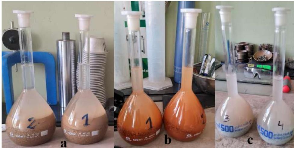
**Fig. 21.** Saturación de los materiales a. Agregado fino, b. ladrillo reciclado triturado, c. vidrio reciclado triturado.
