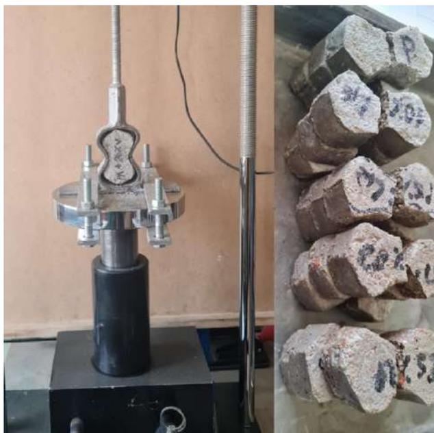
**Fig. 33.** Resistencia a la tensión ensayado a los 28 días.
