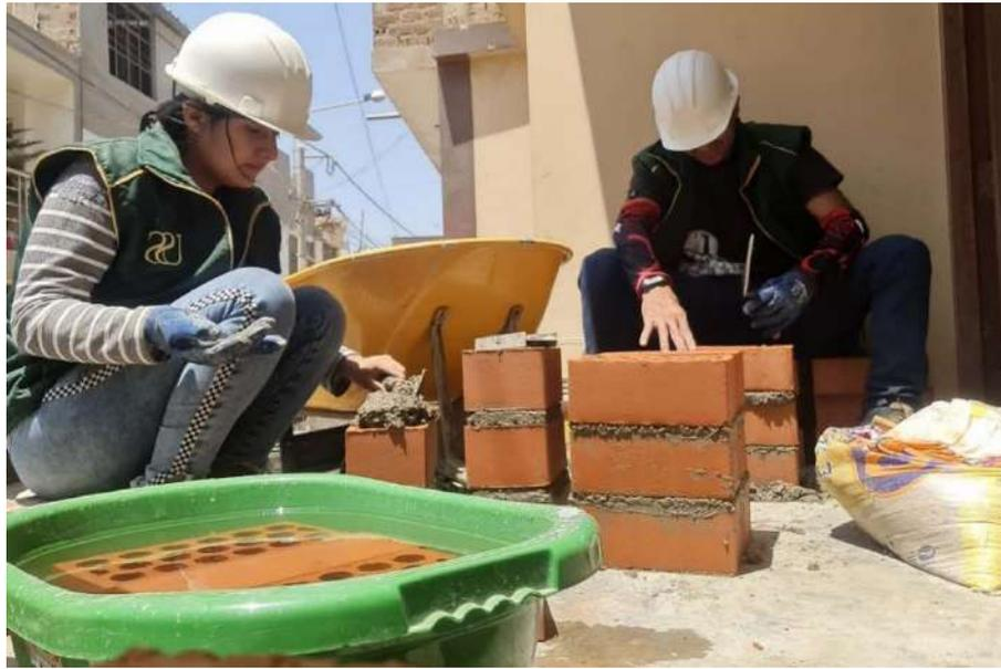
Asentado de pilas para ensayos de compresión y adherencia a la flexión.
