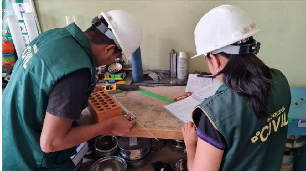
**Fig. 23.** Medida de las dimensiones de las superficies de los ladrillos (Cerámicos Lambayeque, Lark, Sipán y Master).
