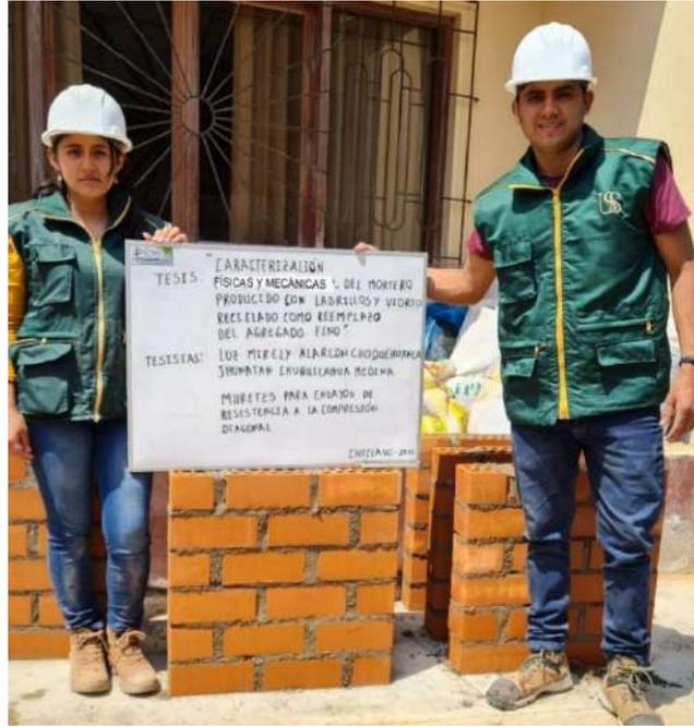
**Fig. 38.** Muretes elaborados para ensayo de compresión diagonal.
