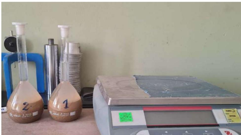
Peso específico del agregado fino natural
