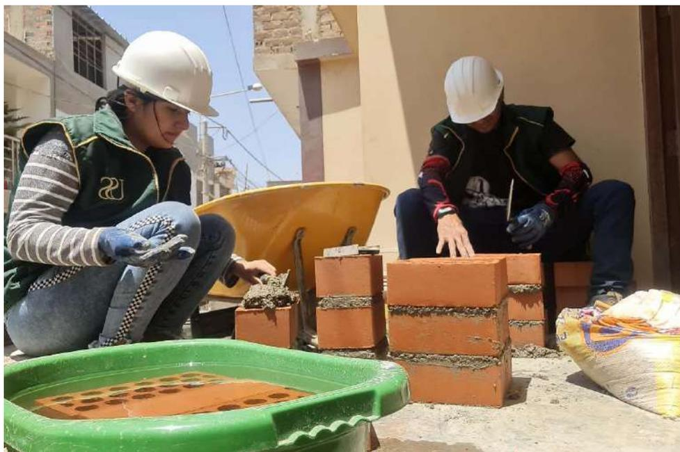
**Fig. 36.** Asentado de 3 unidades de ladrillo (pilas).
