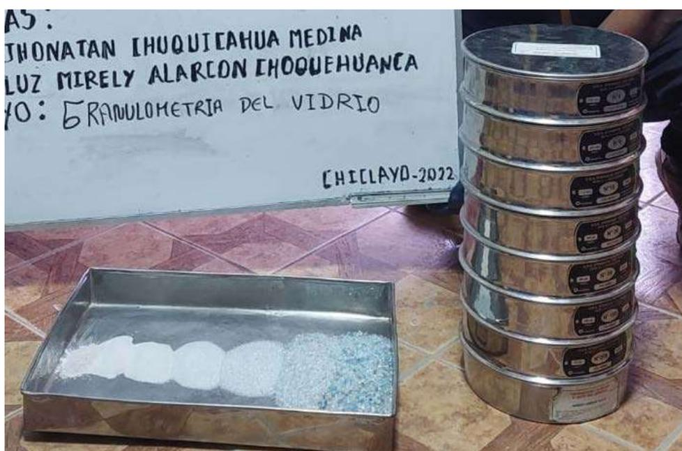
Fig. 17. Análisis granulométrico del vidrio.
