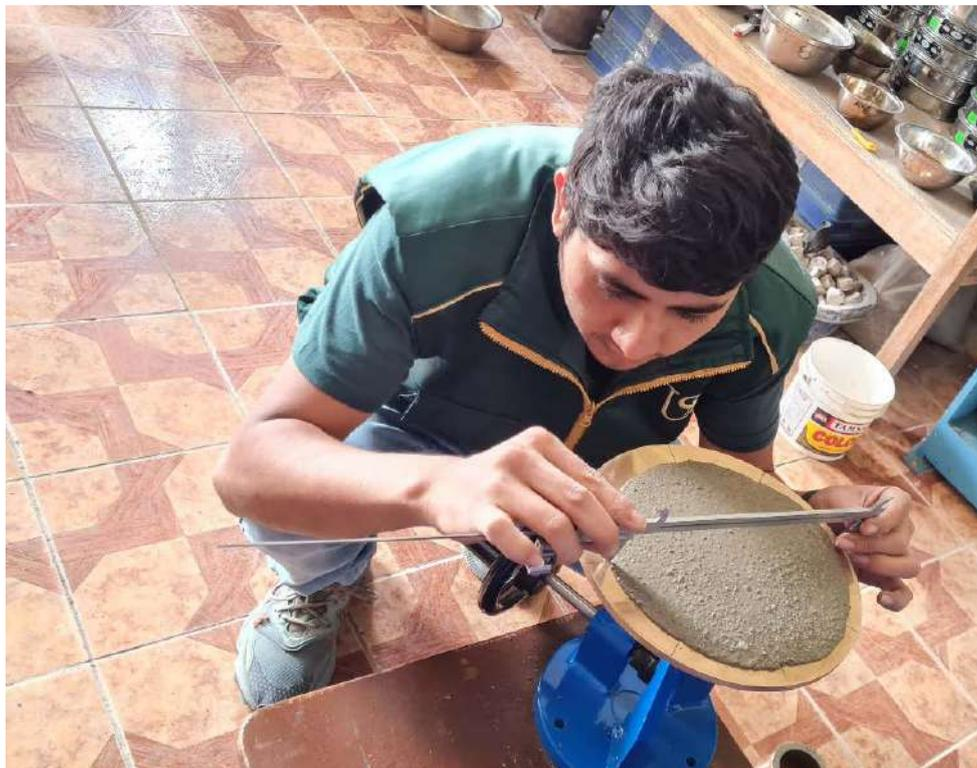
**Fig. 28.** Medida de los diámetros del mortero en la mesa de flujo.
