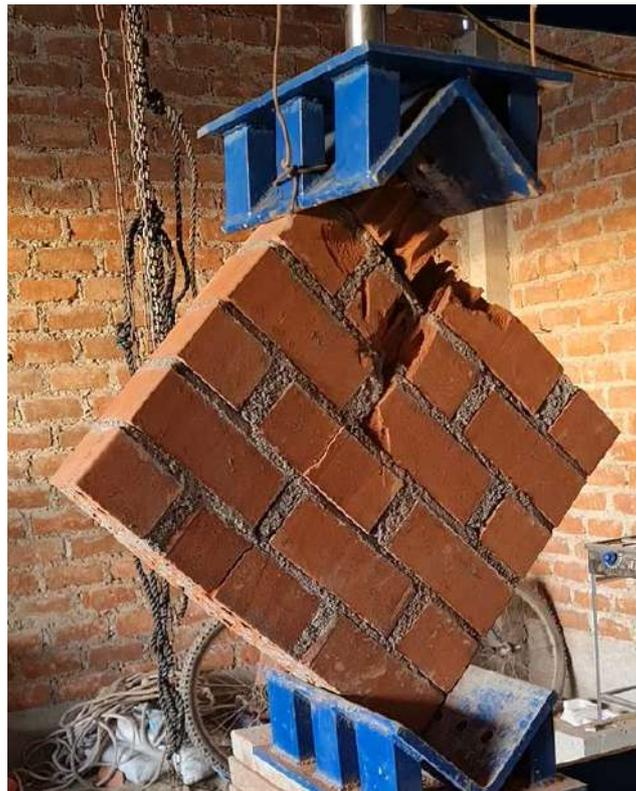
**Fig. 39.** Compresión diagonal en muretes de albañilería.
