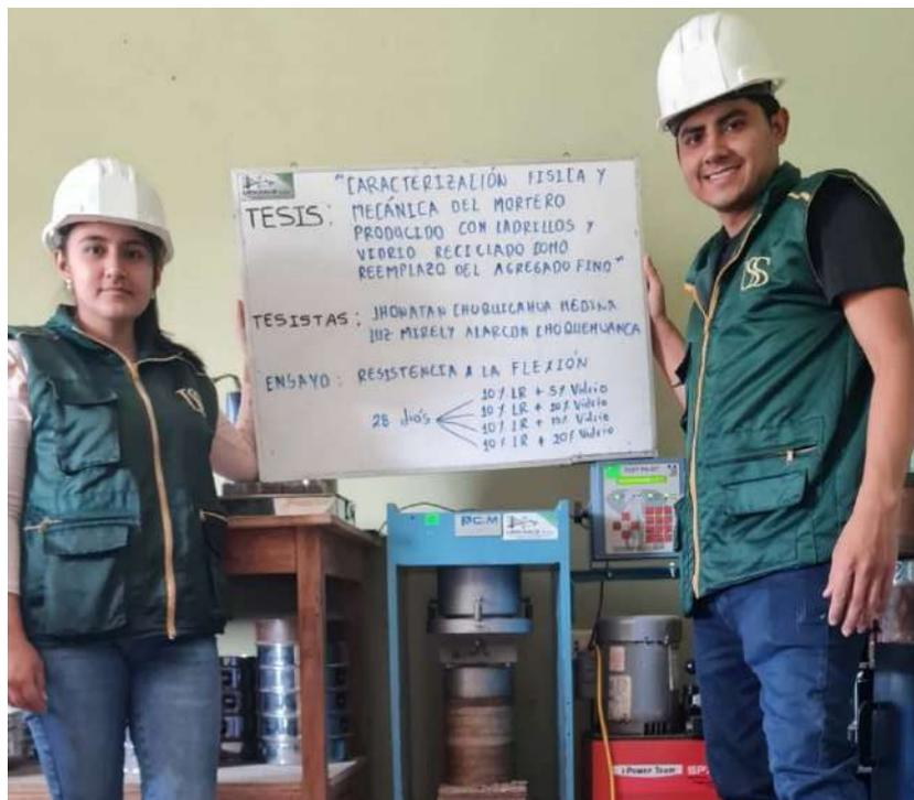
**Fig. 30.** Resistencia a la flexión en barras de mortero
