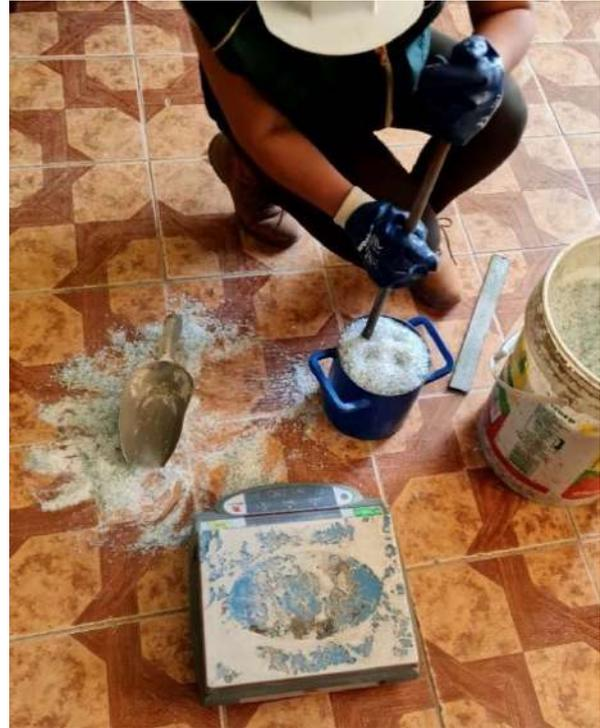
**Fig. 20.** Peso unitario compactado del vidrio.
