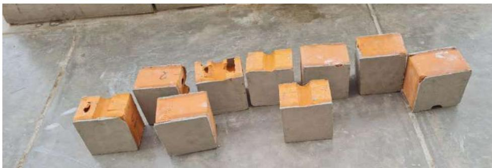
**Fig. 27.** Refrentado de los ladrillos para ensayo de compresión axial.
