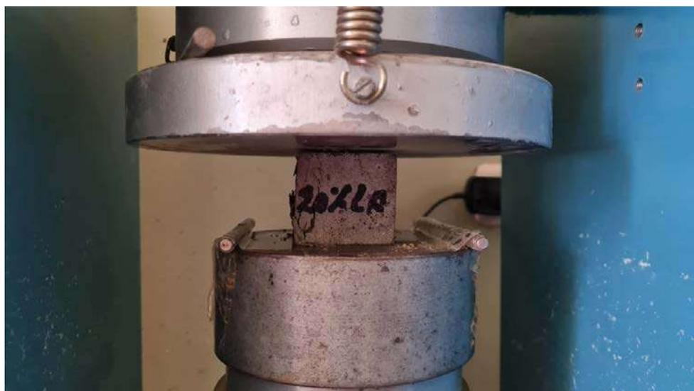
Ensayo de resistencia a la compresión de mortero con ladrillo y vidrio reciclado.
