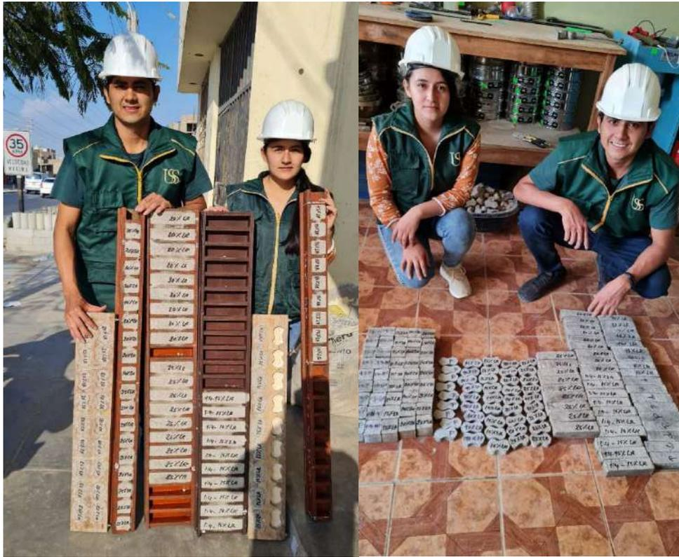
Muestras para ensayos de resistencia a la compresión, flexión y tensión.
