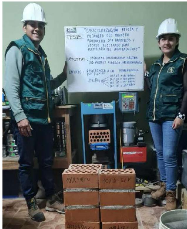
Ensayos de adherencia a la flexión de pilas con mortero de ladrillo y vidrio reciclado.
