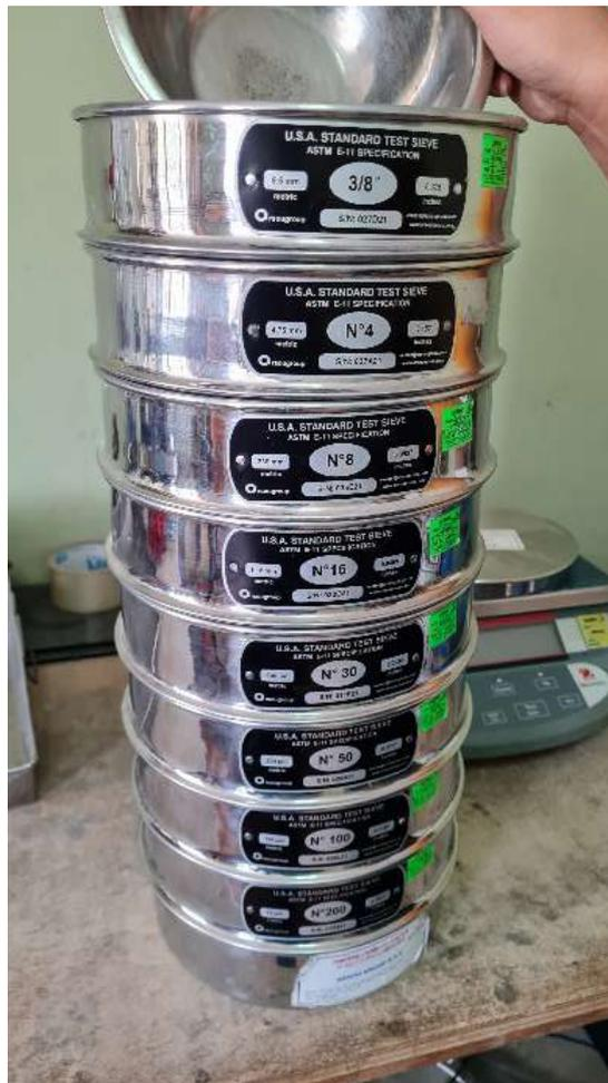
**Fig. 15.** Análisis granulométrico al agregado fino.
