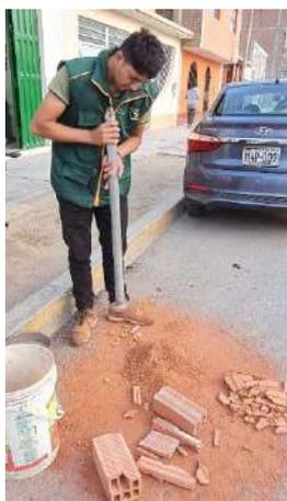
**Fig. 11.** Triturado de ladrillo reciclado
