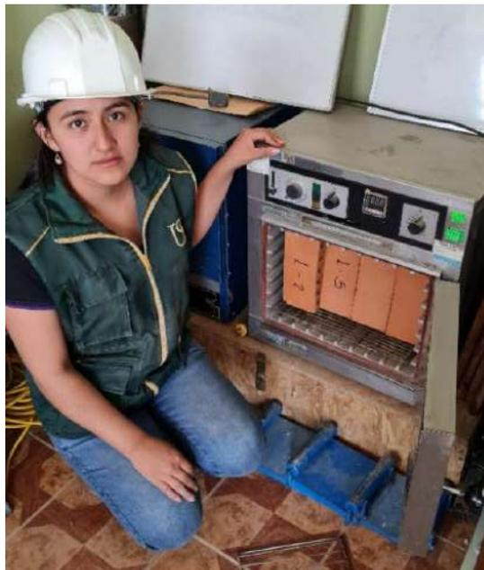
**Fig. 26.** Ladrillos puestos al horno por 24 horas.
