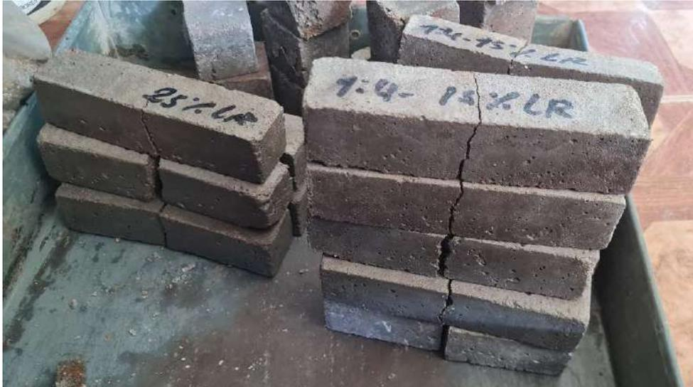
**Fig. 31.** Prismas de mortero ensayados a los 28 días
