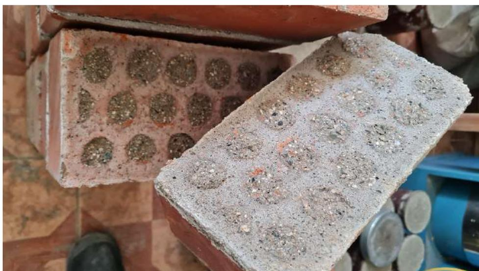
**Fig. 37.** Pila ensayada, adherencia a la flexión los 28.
