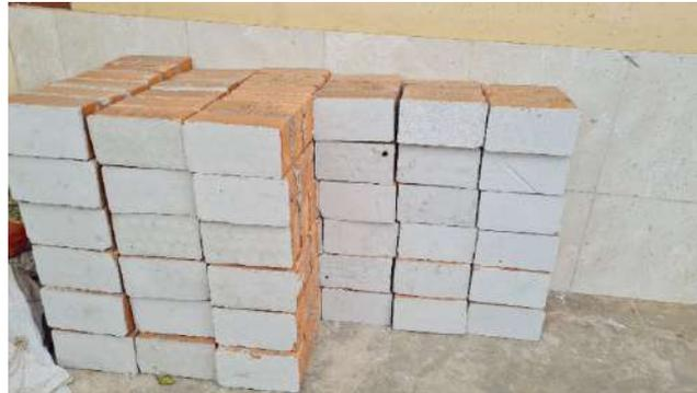
**Fig. 34.** Pilas refrentadas para ensayo a compresión axial.
