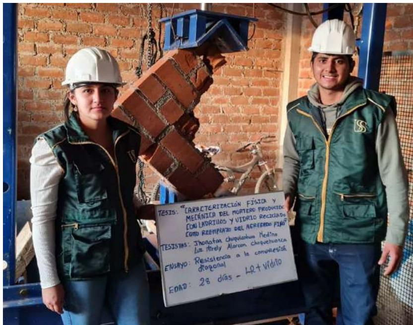
Ensayo de muretes, resistencia a la compresión diagonal.
