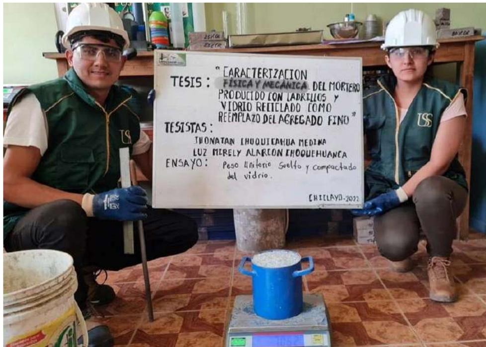
Verificación del Peso unitario suelto y compactado del vidrio reciclado triturado
