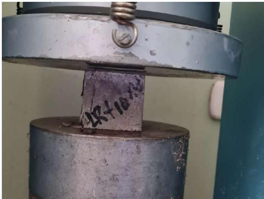
**Fig. 29.** Compresión en cubos de mortero de 50mm.
