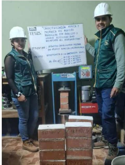
Ensayo de compresión axial en pilas con mortero de ladrillo y vidrio reciclado.
