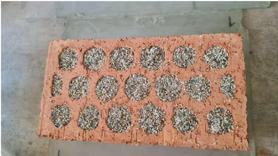
**Fig. 24.** Ladrillo llenado con arena para determinación del área de vacíos.
