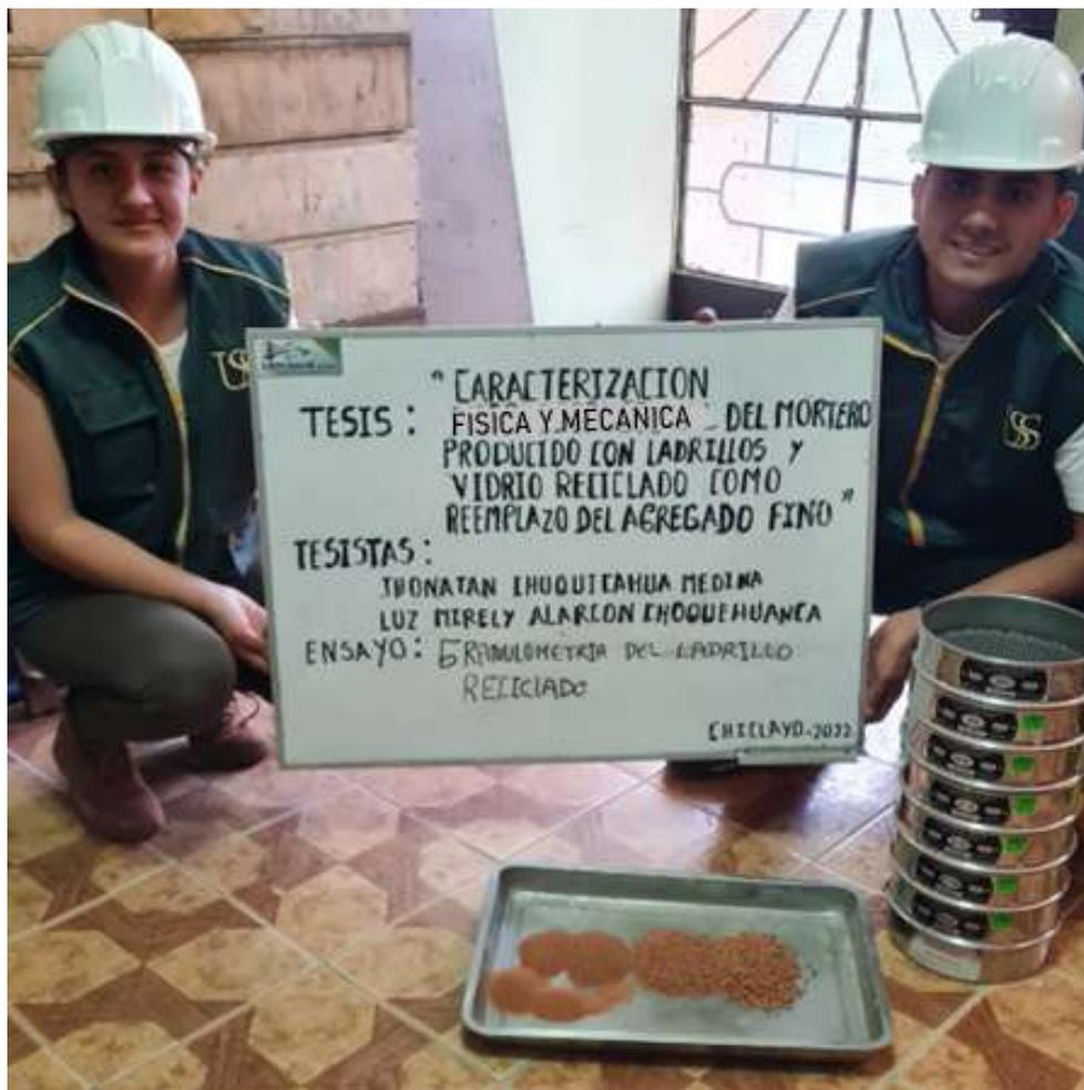
Fig. 16. Análisis granulométrico del ladrillo
