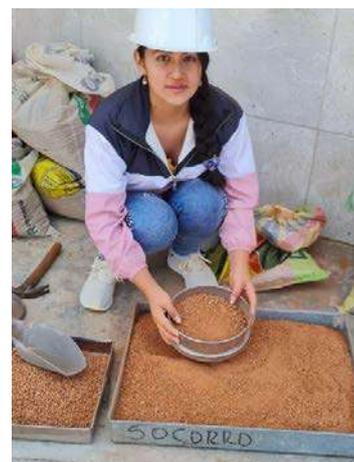
**Fig. 12.** Tamizado del ladrillo triturado
