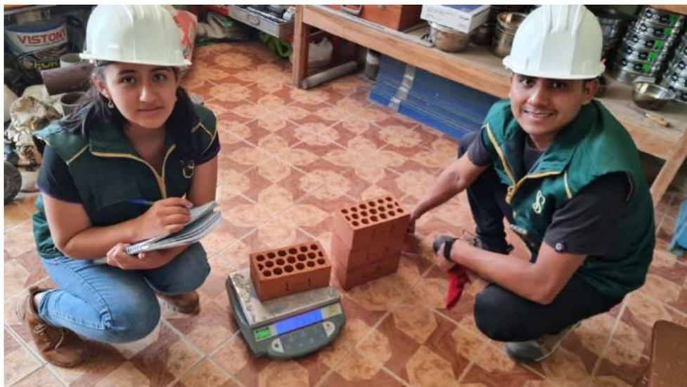
**Fig. 25.** Pesado de unidades de ladrillos después de la saturación por 24 horas.
