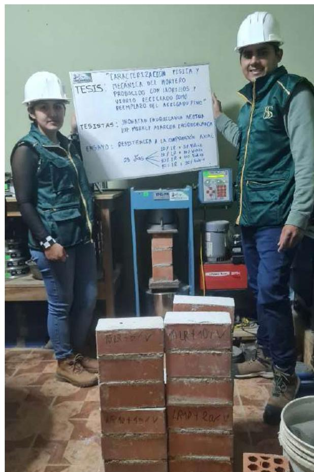
**Fig. 35.** Ensayo de compresión axial a pilas de albañilería.
