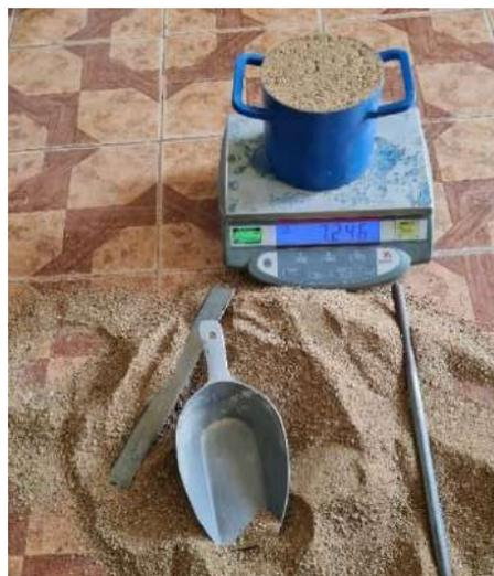
**Fig. 18.** Peso unitario suelto y compactado del agregado fino.
