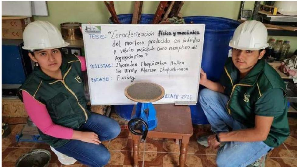
Ensayo de fluidez del mortero.
