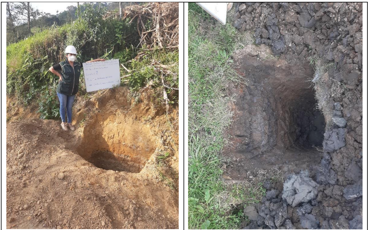
Figura 17: Excavación de calicata - C3 Fuente: Elaboración propia
