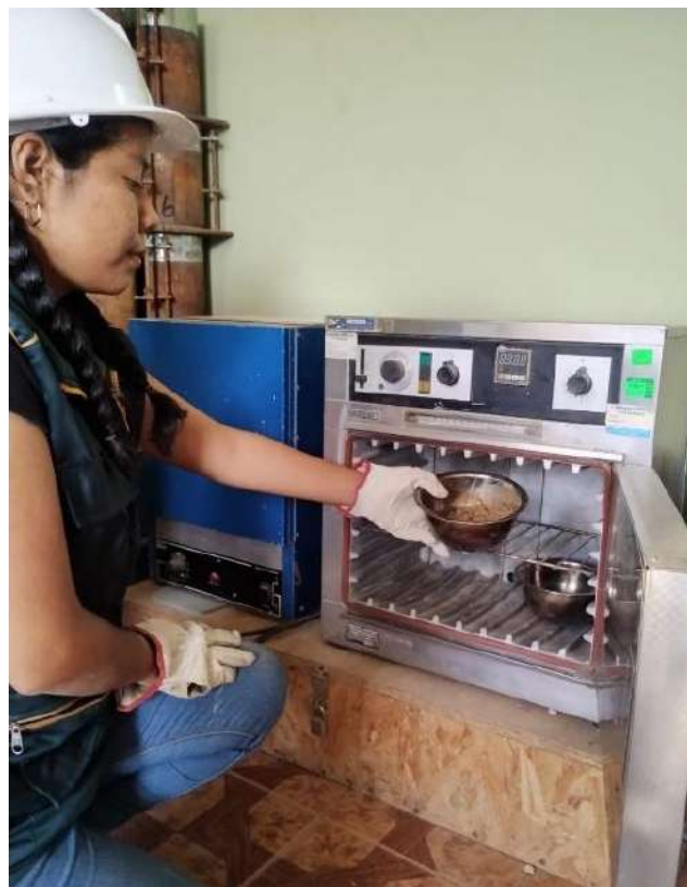
Fig. 17 Contenido de Humedad del agregado fino
