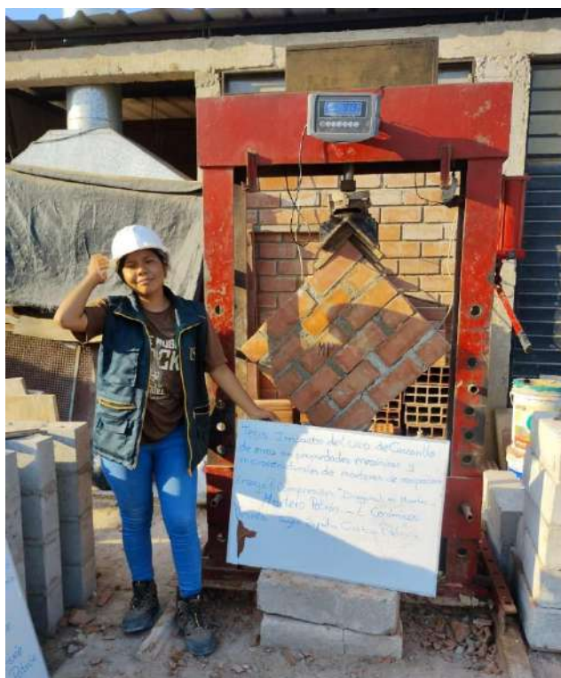
Fig. 23 Resistencia a la compresión diagonal en muretes
