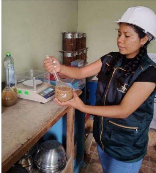
Fig. 15 Peso Específico y Absorción del agregado fino
