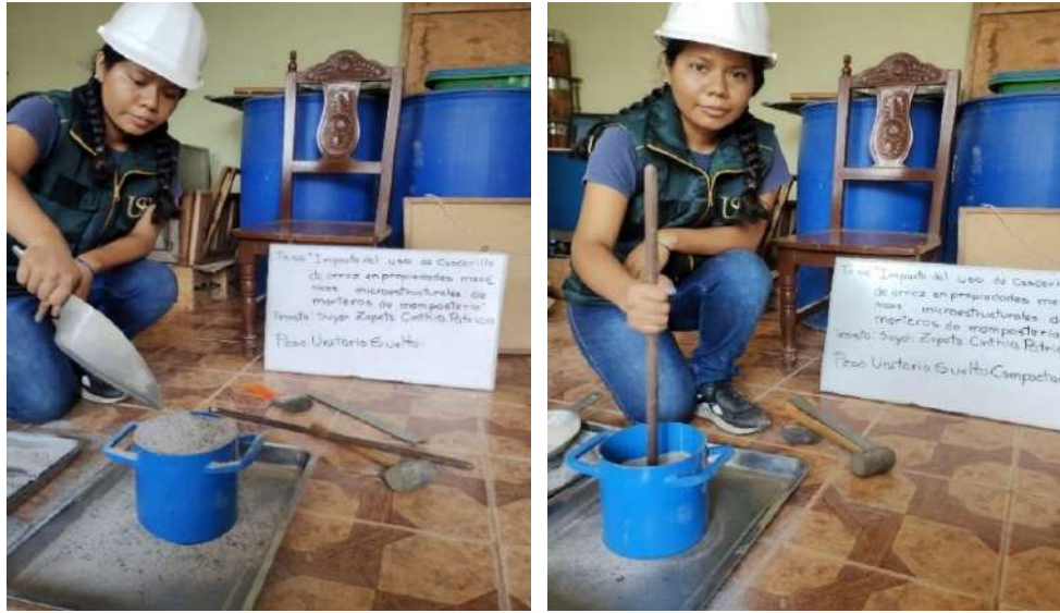
Fig. 14 Peso unitario suelto - compactado de la CCA
