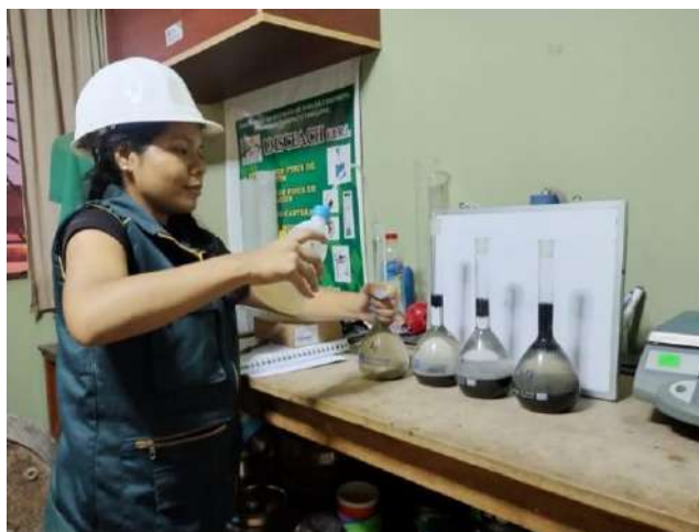
Fig. 16 Saturación de la CCA a diferentes temperaturas
