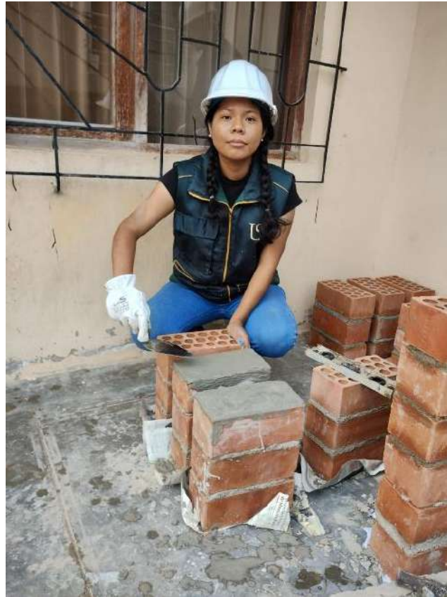
Fig. 22 Resistencia a la adherencia por flexión en pilas de albañilería ( f'r )
