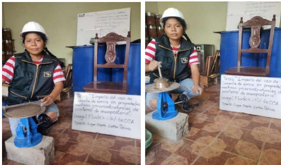
Fig. 19 Ensayo de fluidez del mortero patrón y con adición
