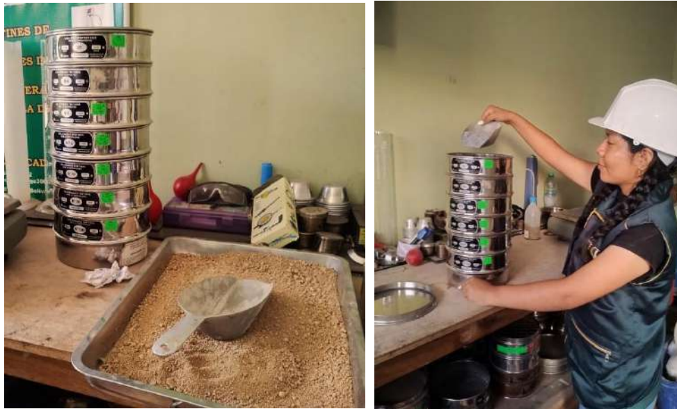
Fig. 12 Ensayo Granulométrico – Agregado fino y CCA
