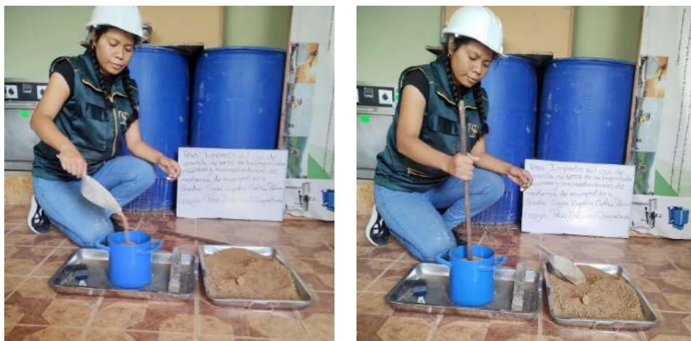
Fig. 13 Peso unitario suelto - Compactado del agregado fino
