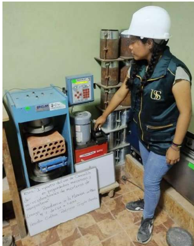
Fig. 21 Resistencia a la adherencia por flexión en pilas de albañilería
