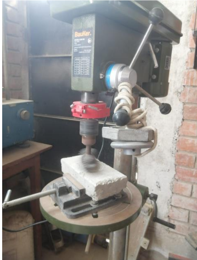
Fig. 16. Ensayo de Abrasión de las Muestras Experimentales
