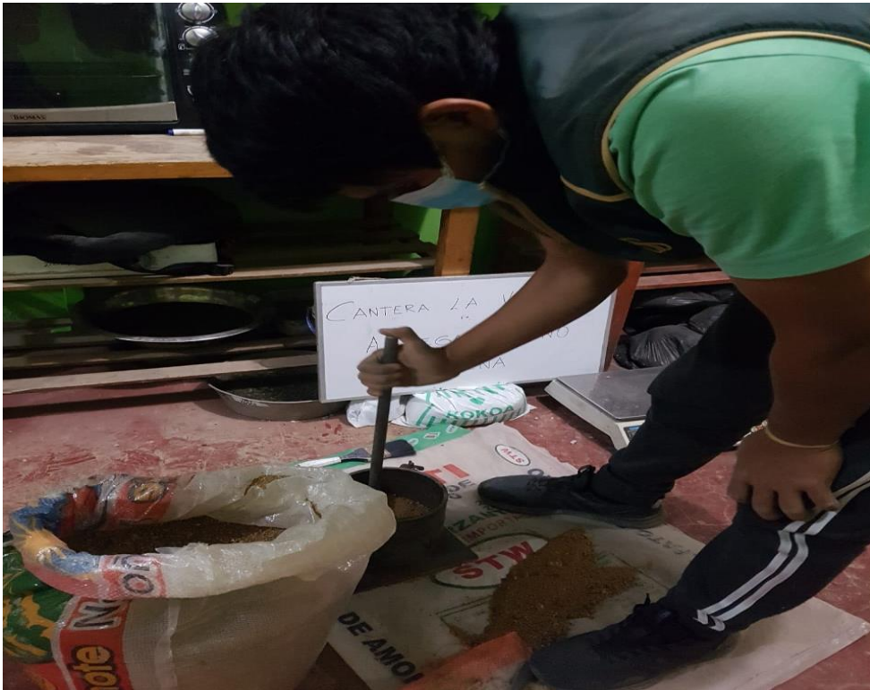
Fig. 8. Realización del peso unitario compactado del árido fino
