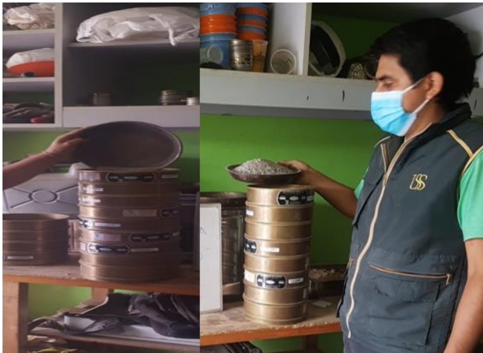
Fig. 7. Tamizado del árido fino y grueso
