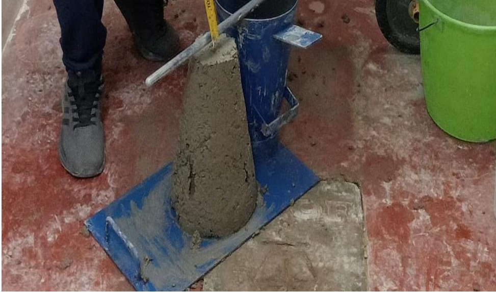
Fig. 12. Medición del asentamiento
