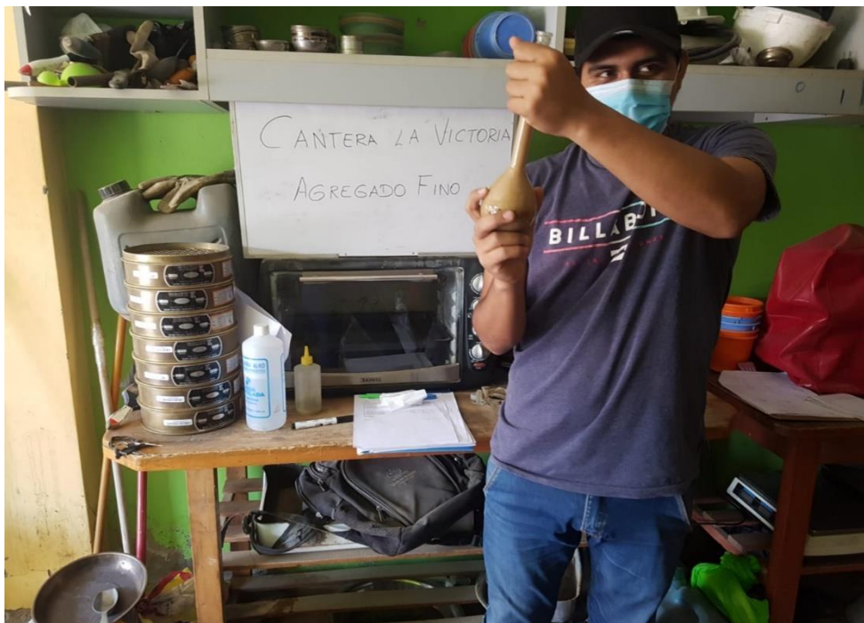
Fig. 11. Ensayo de absorción a los áridos pétreos
