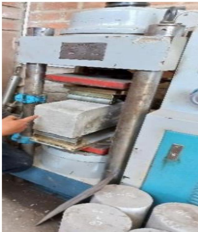
**Fig. 19.** Ensayos a flexión a las muestras prismáticas
