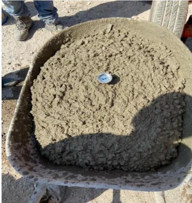
**Fig. 17.** Determinación de la Temperatura de la Mezcla
