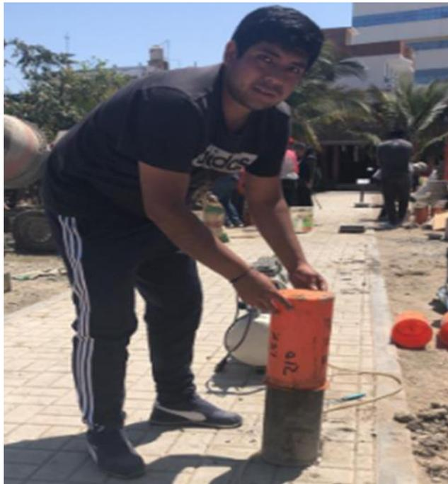
Momento de desmoldar las probetas, Realizado en el laboratorio de ensayos de materiales LEMS W&C EIRL.
