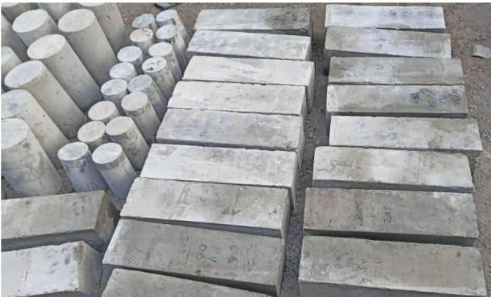
Desenfrado de Probetas y Vigas  $f'c$  210 kg/cm<sup>2</sup> con adiciones de 110 y 440 gr/m<sup>3</sup> de fibra de pino. Realizado en el laboratorio de ensayos de materiales LEMS W&C EIRL.
