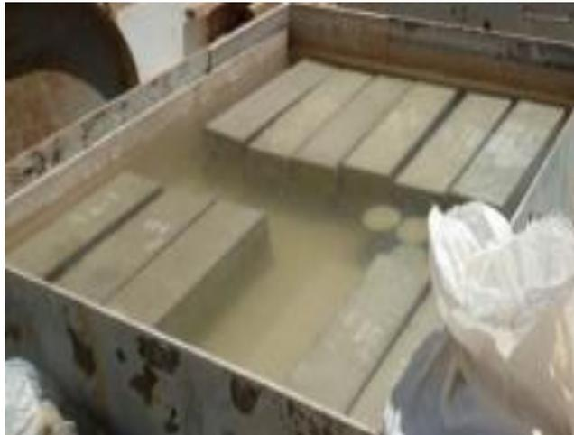
Vigas con  $f'c$  210 y 280  $\text{kg/cm}^2$  con adiciones de 110, 220, 330 y 440  $\text{gr/m}^3$  de fibra de pino, en poza de curado. Realizado en el laboratorio de ensayos de materiales LEMS W&C EIRL.
