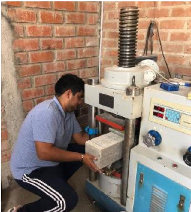
Rotura de vigas en prensa hidráulica. Realizado en el laboratorio de ensayos de materiales LEMS W&C EIRL.
