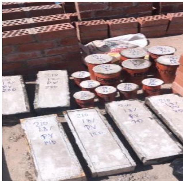
Colocación de códigos a probetas y vigas con  $f'c$  210 y 280  $kg/cm^2$  con adiciones de 110, 220, 330 y 440  $gr/m^3$  de fibra de pino. Realizado en el laboratorio de ensayos de materiales LEMS W&C EIRL.
