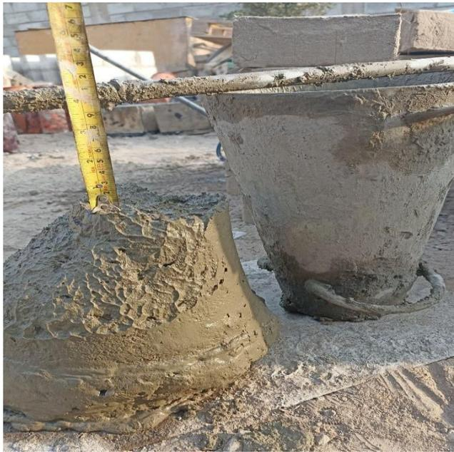
Asentamiento de diseño 4 pulg. ¡Ok!, después de varias tandas de prueba. Realizado en el laboratorio de ensayos de materiales LEMS W&C EIRL.
