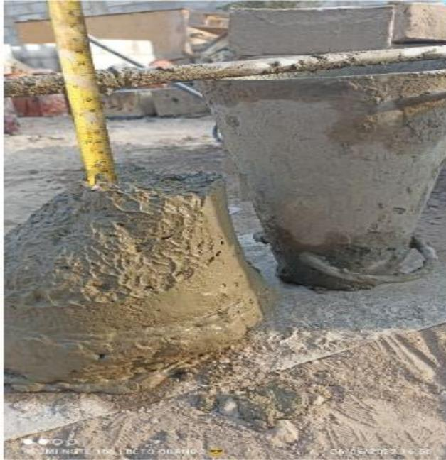
**Fig. 2.** Ensayo de Asentamiento de Slump de 4" en concreto fresco
