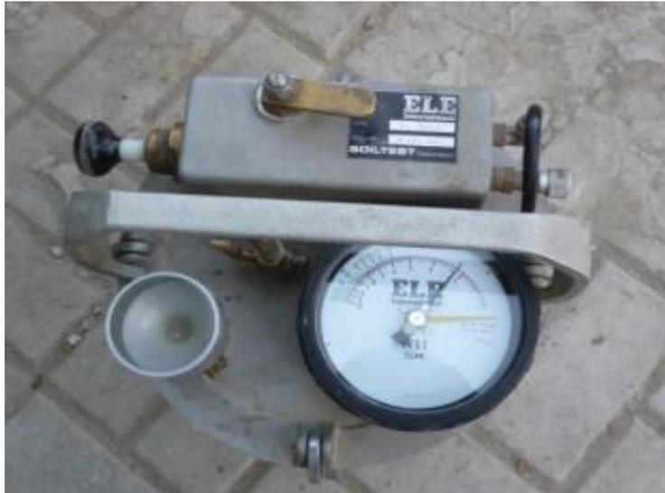
**Fig. 3.** Ensayo de contenido de aire. [52]
