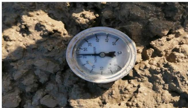
**Fig. 4.** Temperatura de concreto fresco. [52]
