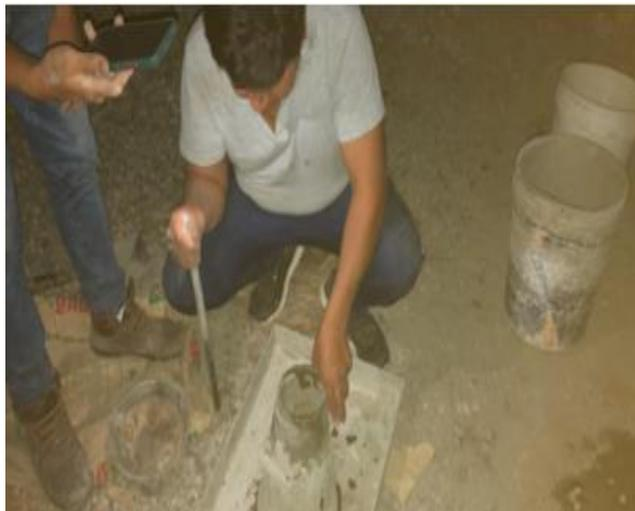
Ensayo de asentamiento del concreto fresco, realizado en el laboratorio de ensayos de materiales LEMS W&C EIRL.
