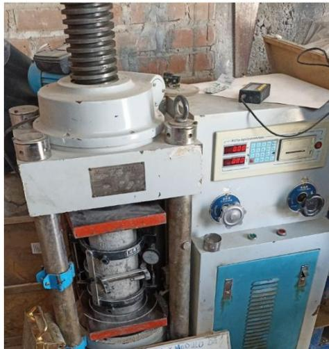
**Fig. 5.** Equipo para medir resistencia a la compresión: Prensa hidráulica
