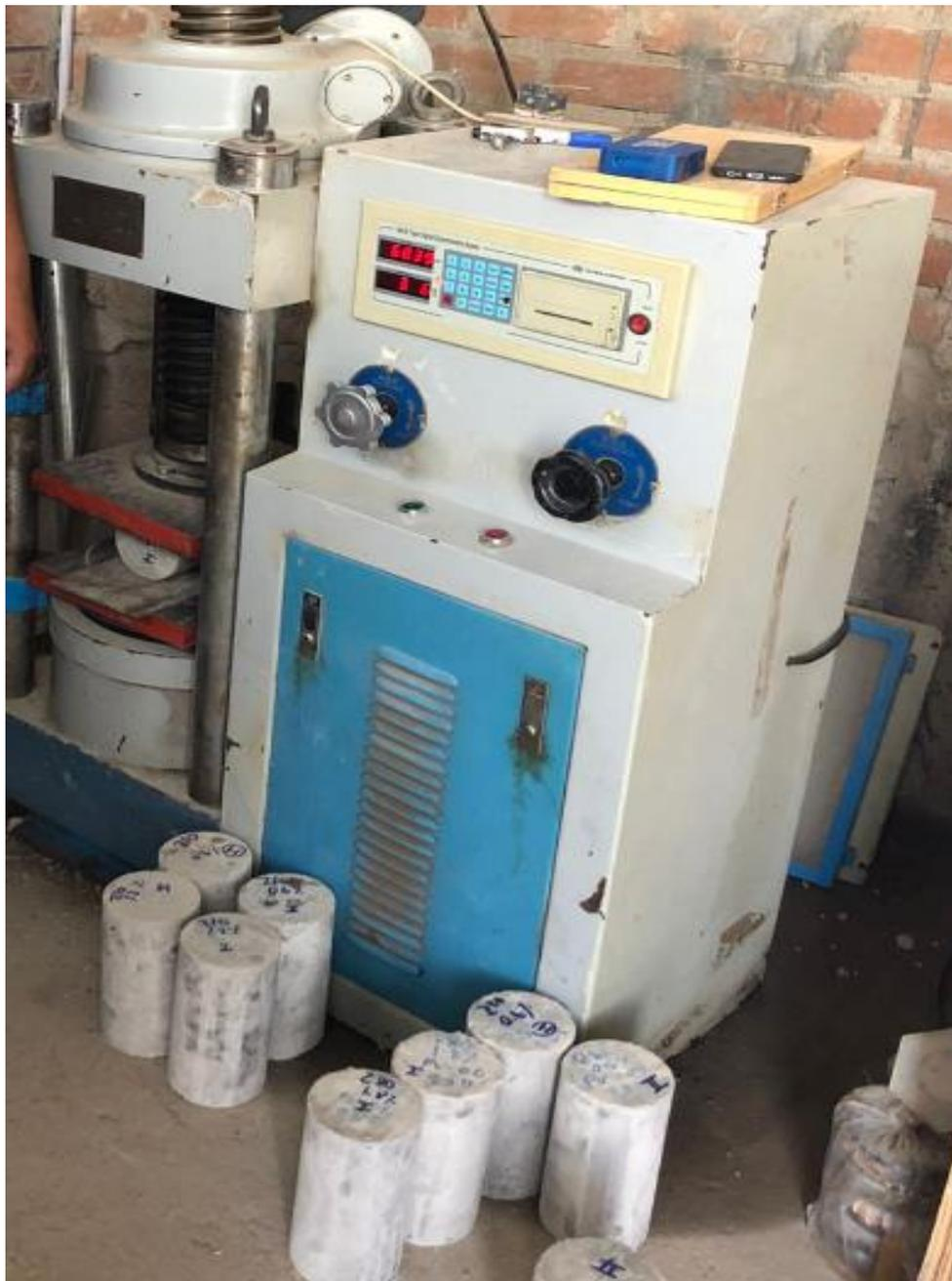
Resistencia a la tracción a los 28 días de  $280 \text{ kg/cm}^2$ . adicionado  $330 \text{ (gr/m}^3\text{)}$ .
