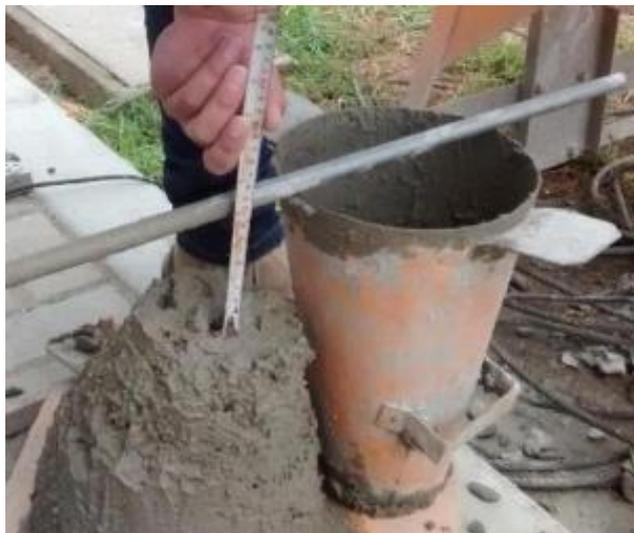
**Fig. 16.** Ensayo de Asentamiento de la Mezcla
