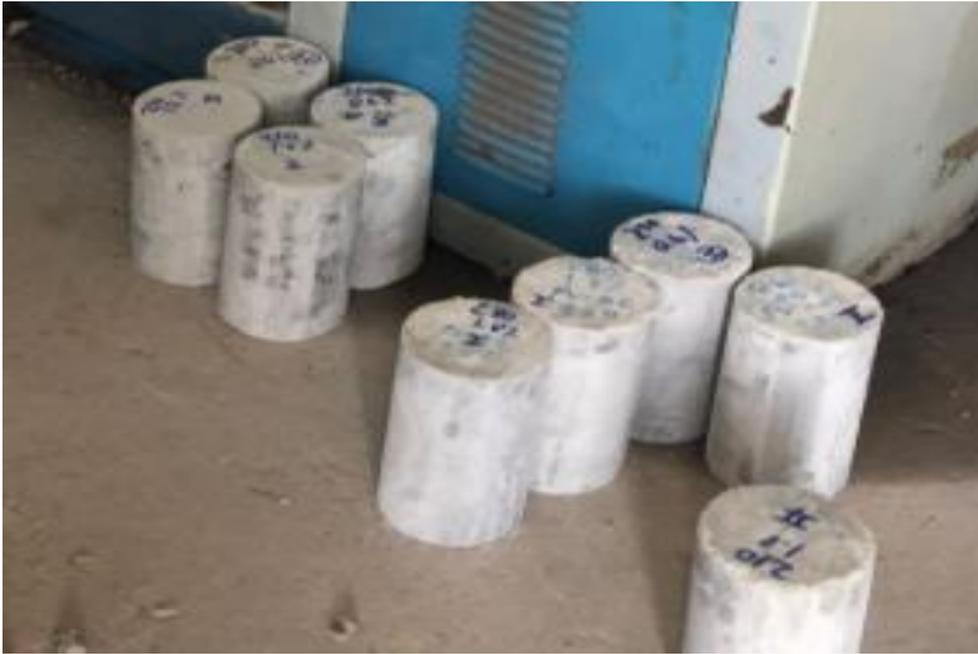
Probetas listas para rotura, Realizado en el laboratorio de ensayos de materiales LEMS W&C EIRL.
