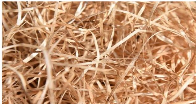
**Fig. 10.** Fibras de madera (Pinus) para la realización de los diseños de concreto
