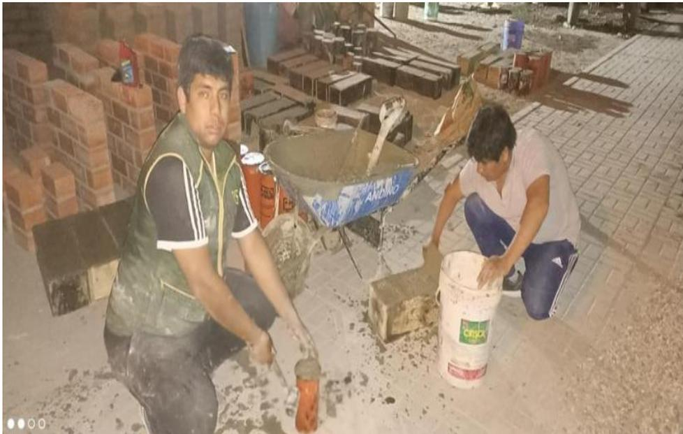
Vaciado de probetas y vigas. Realizado en el laboratorio de ensayos de materiales LEMS W&C EIRL. Con el personal de apoyo Gino Cercado.
