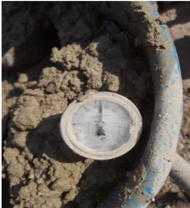
Ensayo de temperatura en concreto fresco. Realizado en el laboratorio de ensayos de materiales LEMS W&C EIRL.
