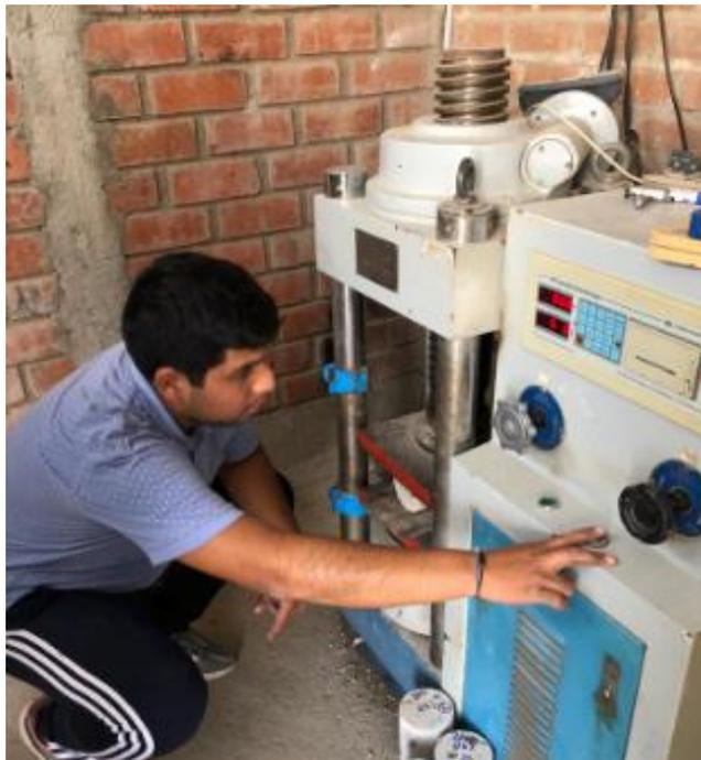
Ruptura de probetas cilíndricas para resistencia a la tracción. Realizado en el laboratorio de ensayos de materiales LEMS W&C EIRL.
