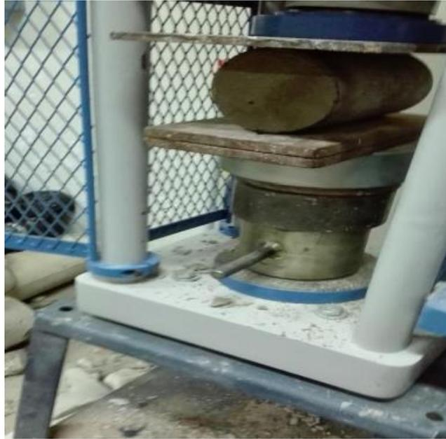
**Fig. 18.** Ensayos a compresión de las muestras cilíndricas
