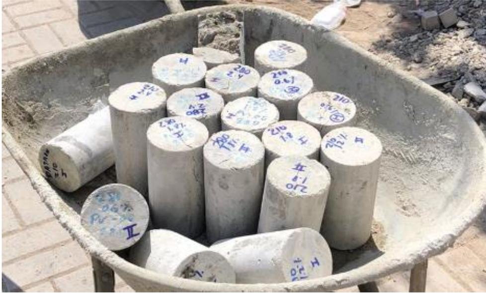
Probetas cilíndricas de 4" x 8" de las cuales se han obtenido datos de resistencia a la tracción a los 28 días de  $280 \text{ kg/cm}^2$ , adicionado  $330 \text{ (gr/m}^3\text{)}$ .
