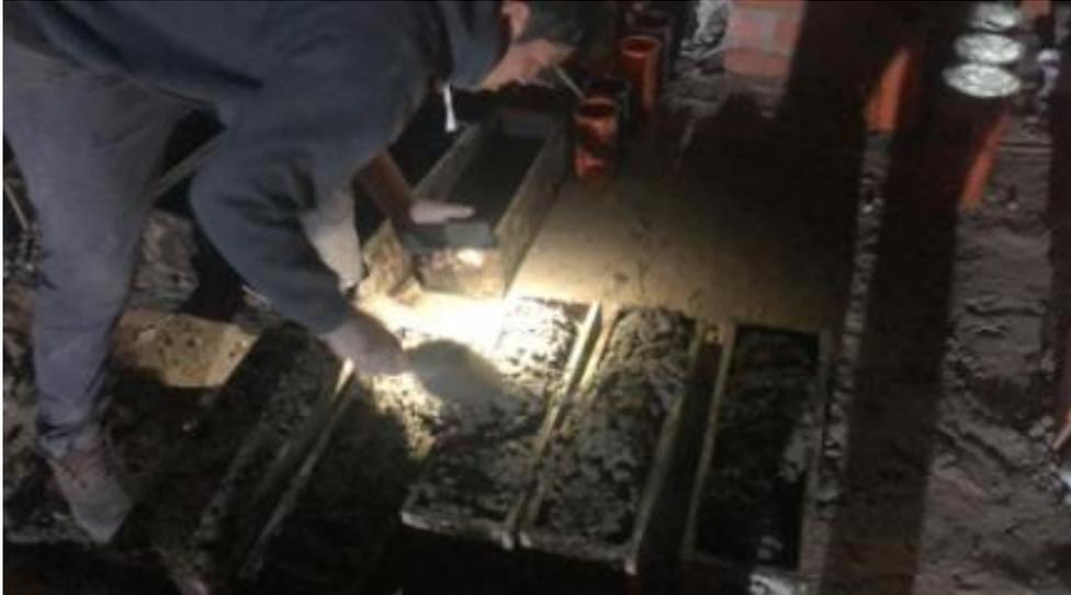
Llenado de vigas,  $f'c$  210 kg/cm<sup>2</sup> con adiciones de 220 gr/m<sup>3</sup> de fibra de pino Realizado en el laboratorio de ensayos de materiales LEMS W&C EIRL. Humberto Obando, personal de apoyo
