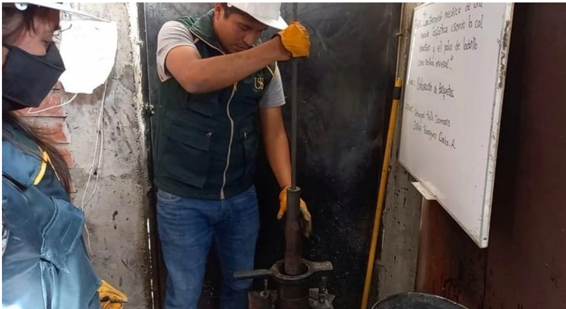
Fig. 88. Compactación con 75 golpes para ambos lados de la briqueta
