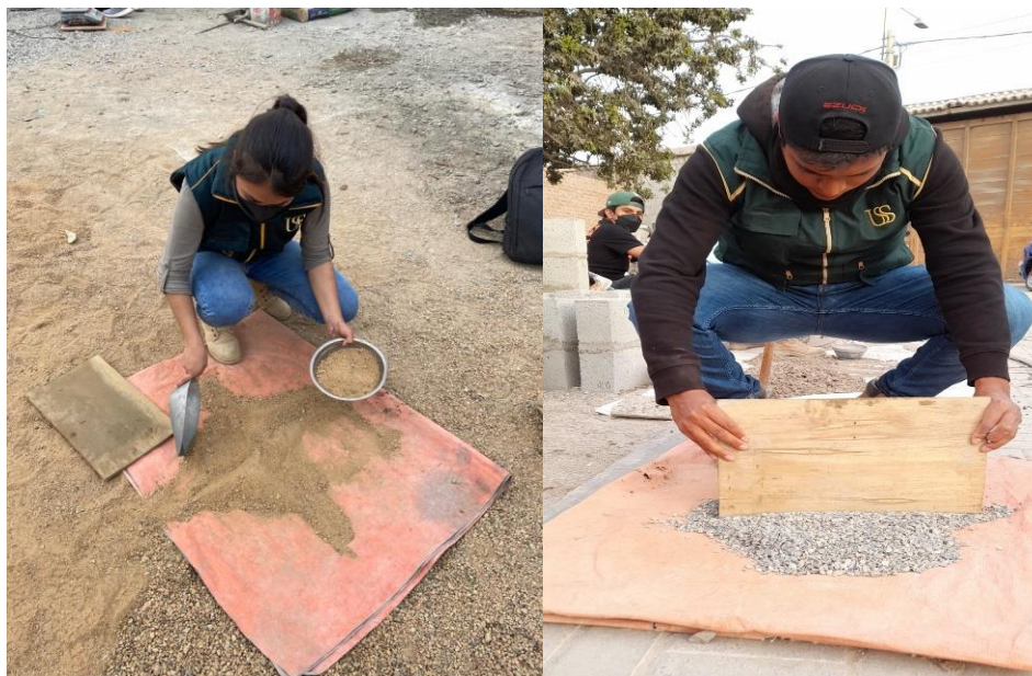
Fig. 70. Cuarteo del agregado fino y grueso
