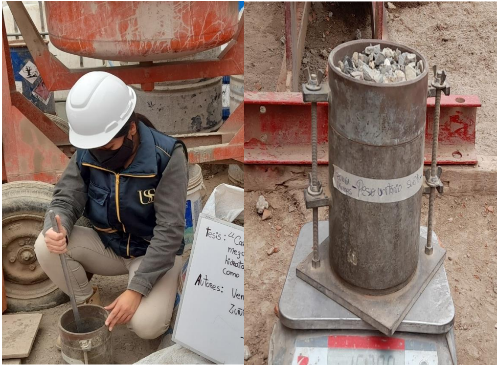
Fig. 73. Ensayo de peso unitario suelto y compactado del agregado grueso
