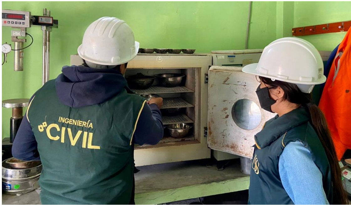
Fig. 75. Ensayo de contenido de humedad del agregado fino y grueso
