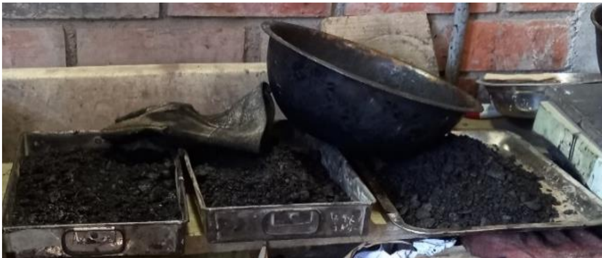
Fig. 96. Diseño de mezcla asfáltica, para ensayo Rice
