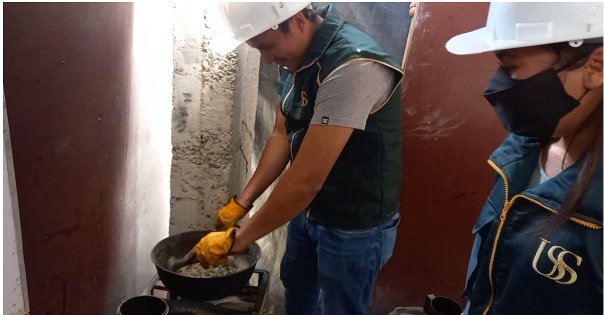
Fig. 83. Preparación y mezclado uniforme de la mezcla en caliente
