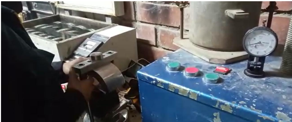
Fig. 94. Colocación de las briquetas centrada en el segmento inferior de la mordaza
