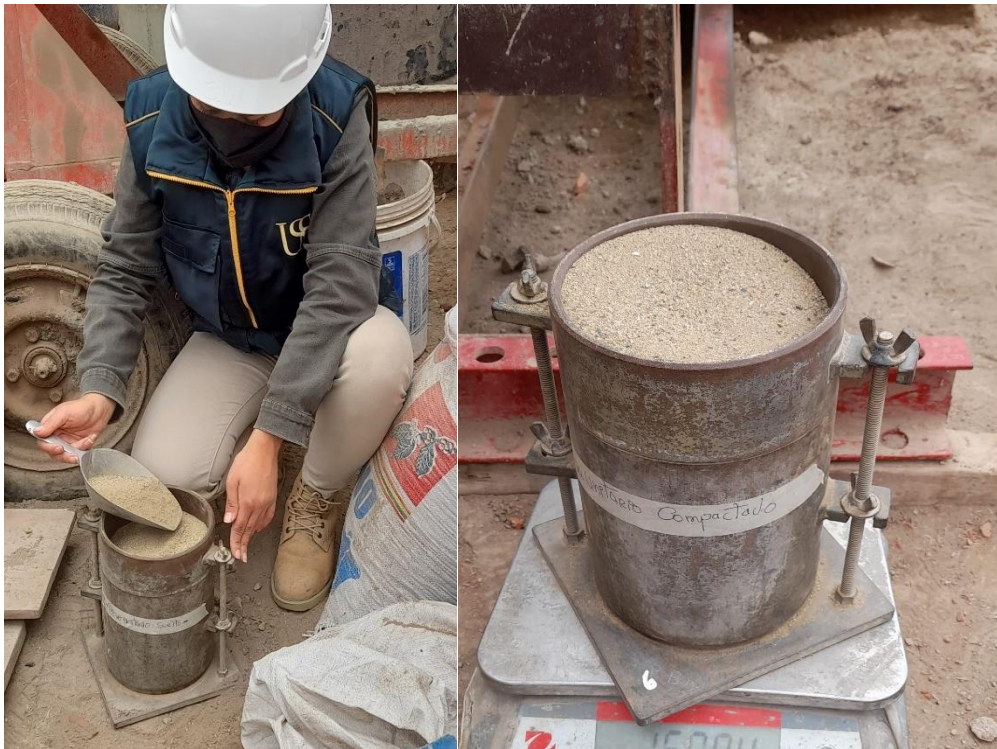
Fig. 72. Ensayo de peso unitario suelto y compactado del agregado fino
