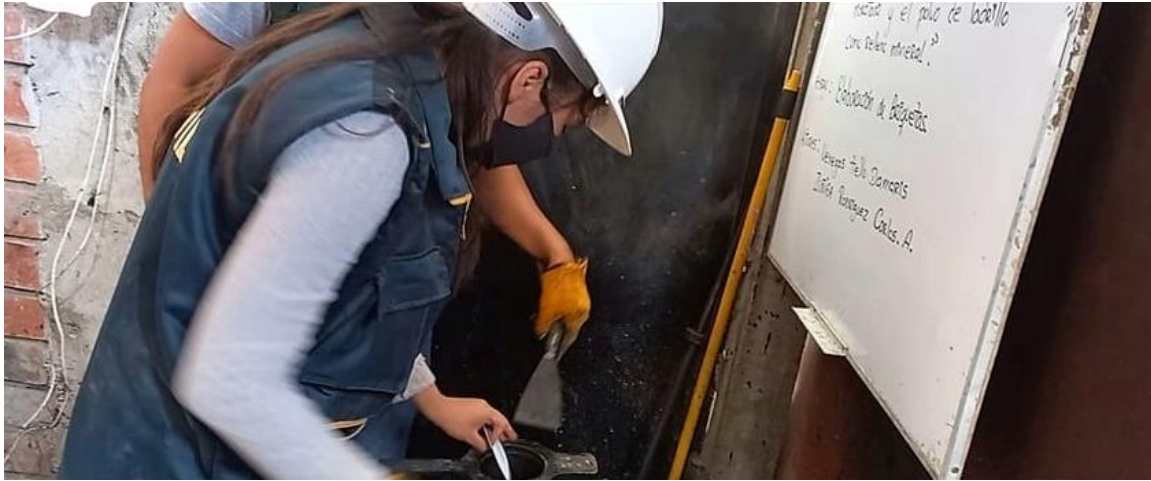
Fig. 87. 2º Aplicación del papel filtro para los moldes de las briquetas
