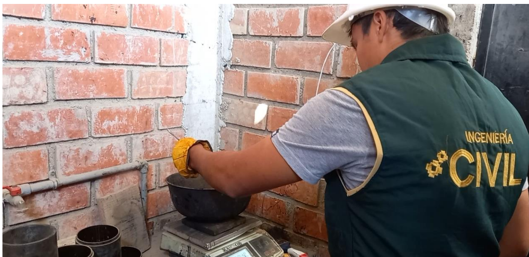
Fig. 82. Incorporación los agregados fino y grueso + filler + pen y son pesados
