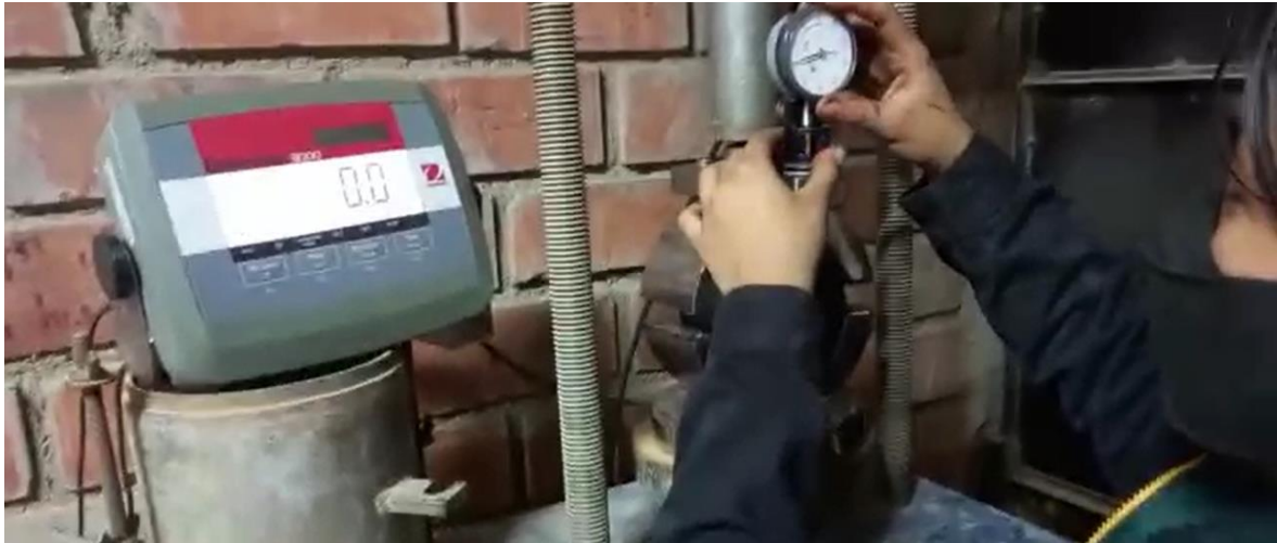
Fig. 95. Medidor de flujo en su posición de uso, no olvidando que debe estar en cero
