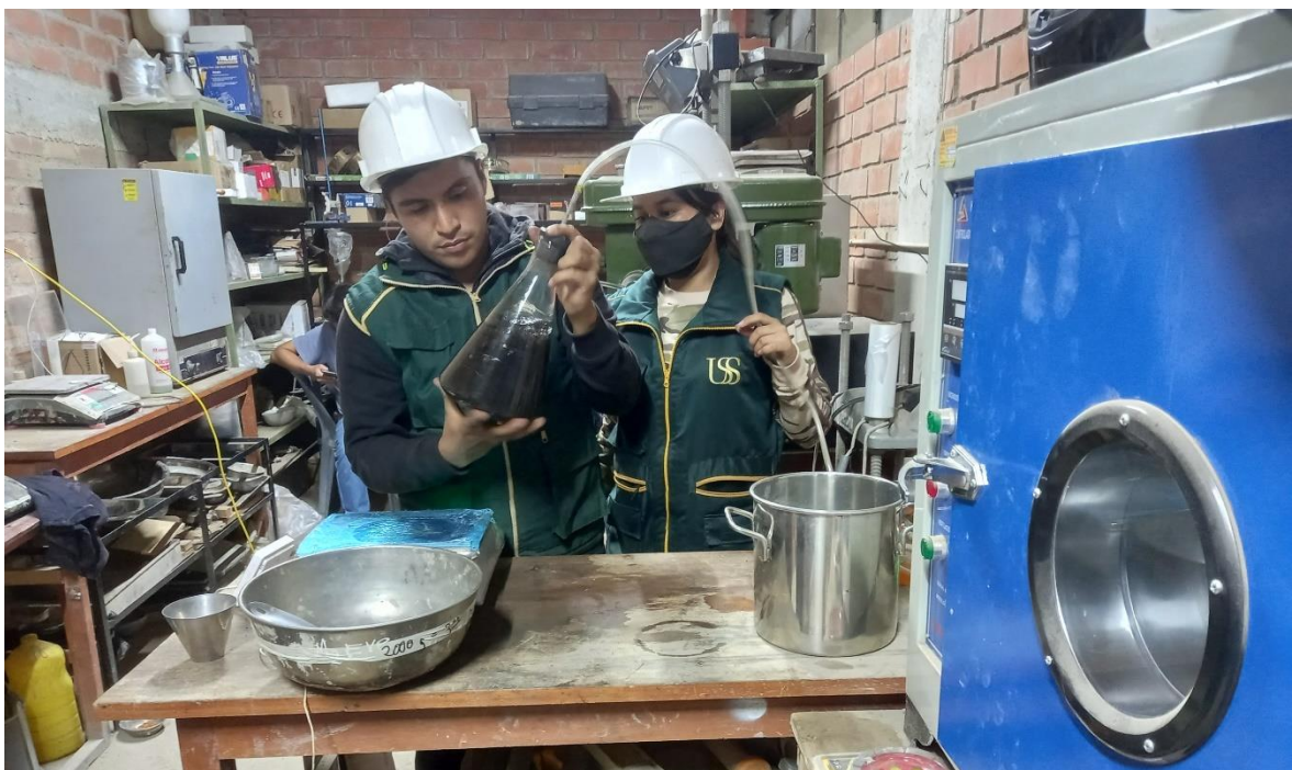
Fig. 100. Agitación del matraz manualmente y con una bomba de vacío por un periodo de 15 minutos
