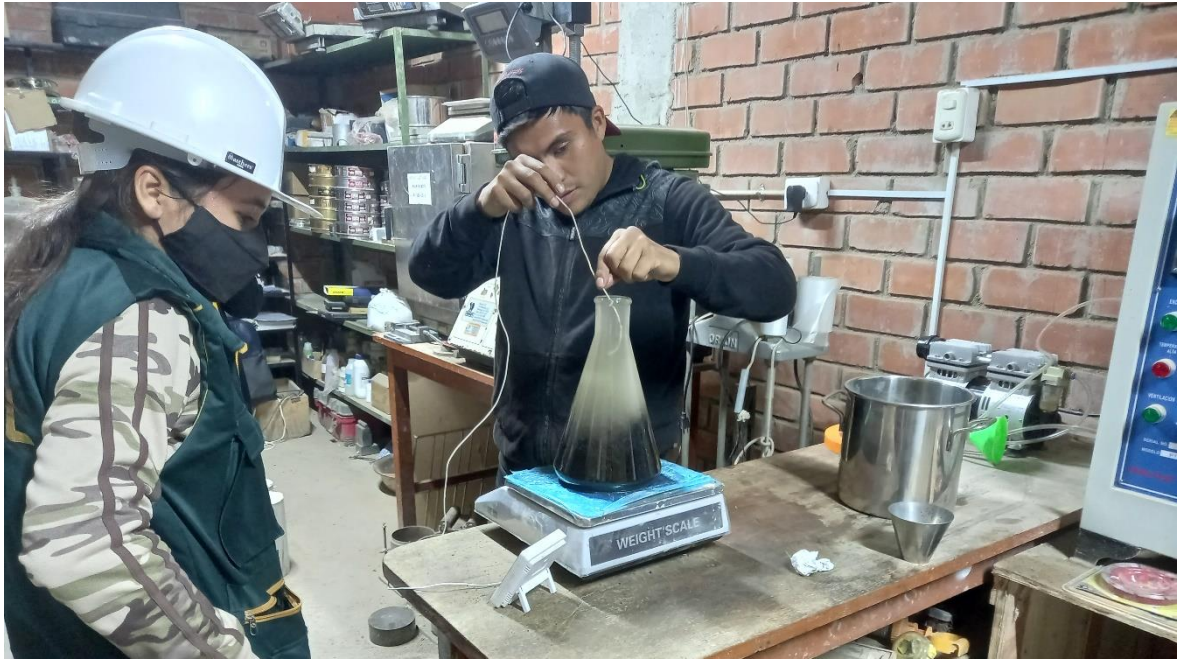
Fig. 101. Llenado del matraz con agua destilada, para obtener el peso calibrado, para obtener la temperatura adecuada
