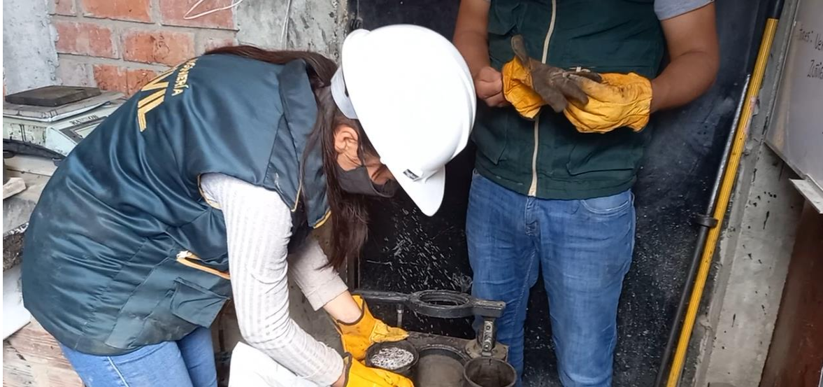
Fig. 89. Retiración de la briqueta para posterior secado a temperatura ambiente
