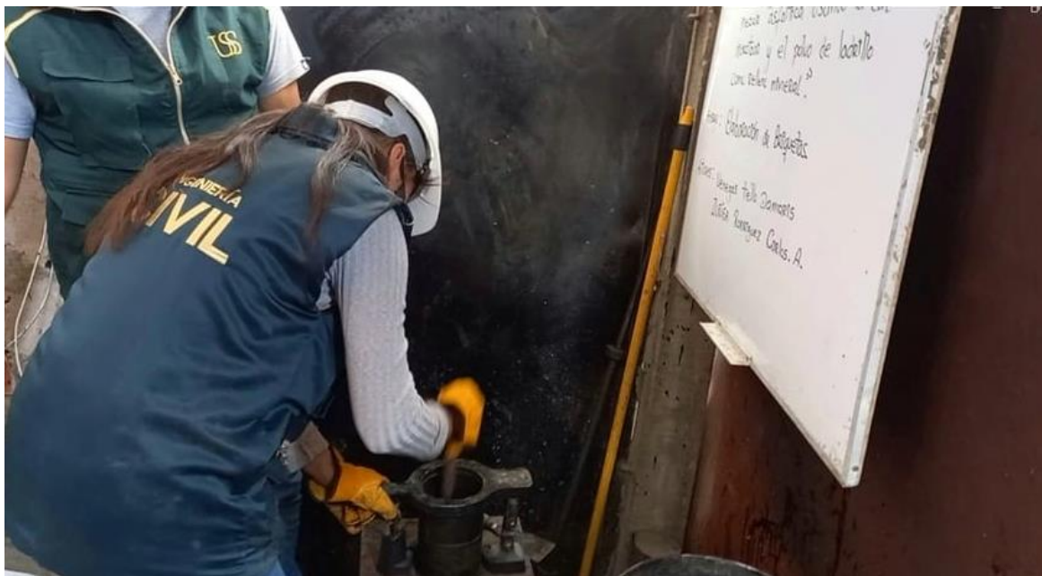
Fig. 86. Compactación con barra de acero (25 golpes)
