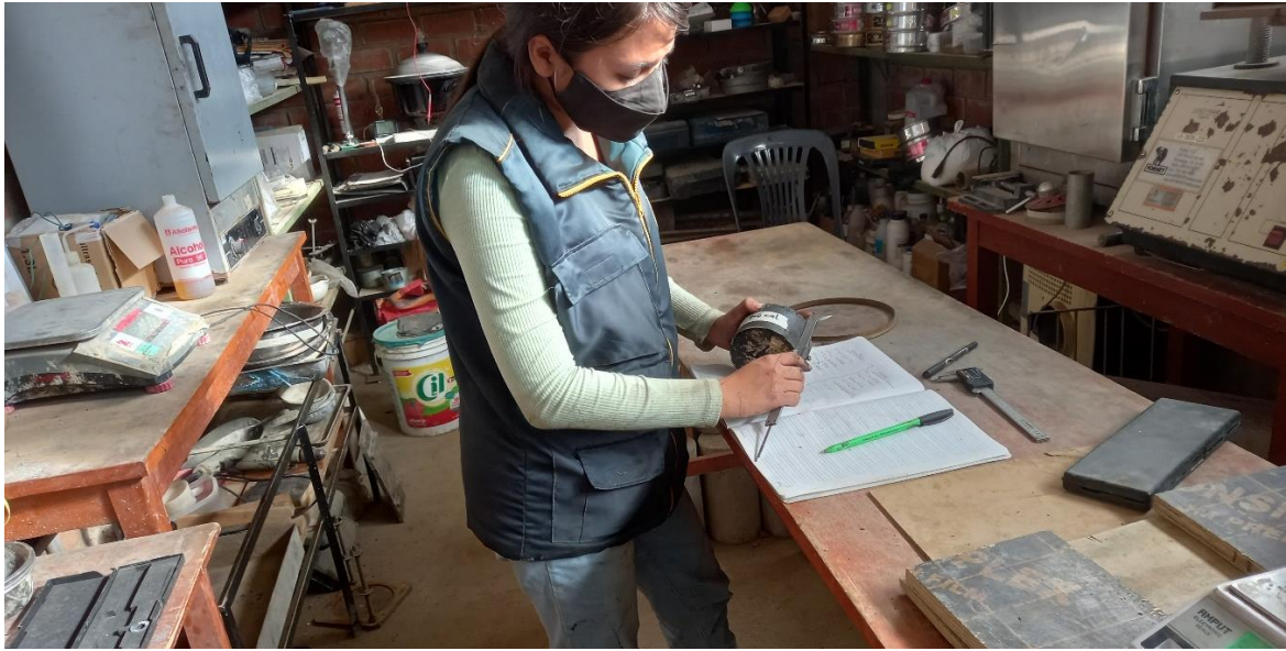
Fig. 91. Dimensionamiento de briquetas patrón + cal+ polvo de ladrillo
