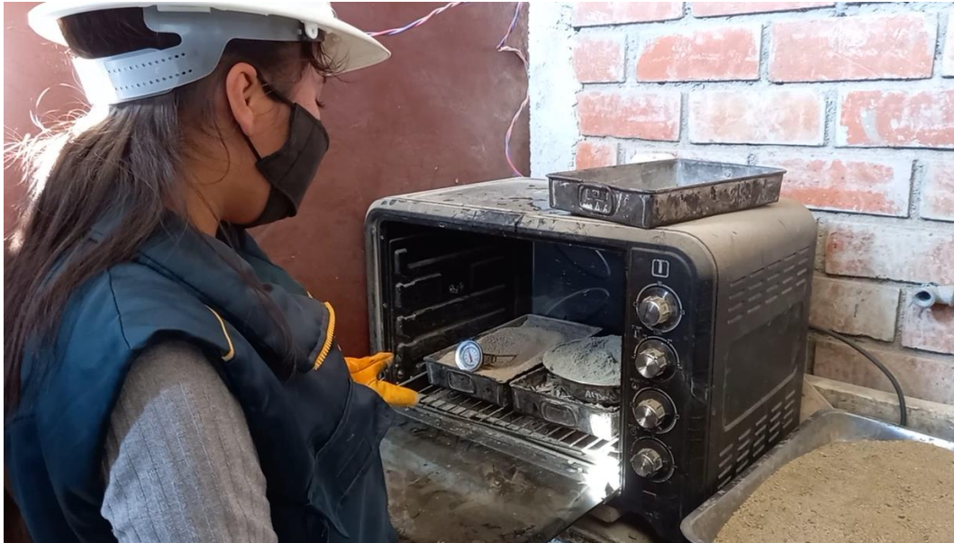
Fig. 81. Los agregados pasan a calentarse en el horno
