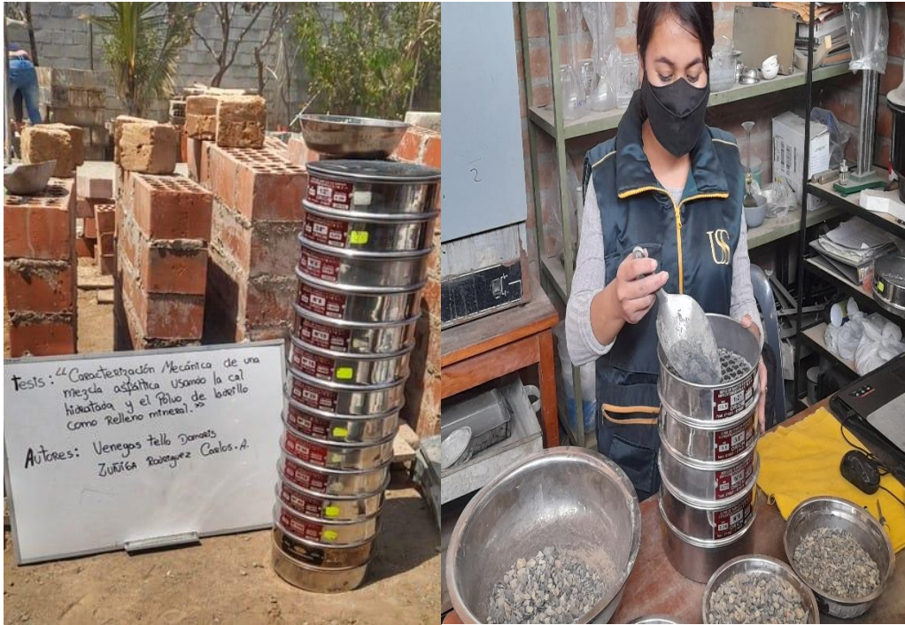
Fig. 71. Ensayo de granulometría agregado fino y grueso
