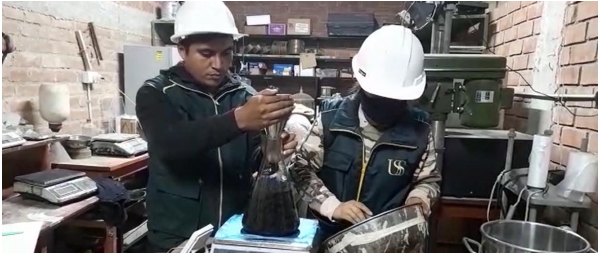
Fig. 99. Peso del matraz con la muestra sin perder partículas
