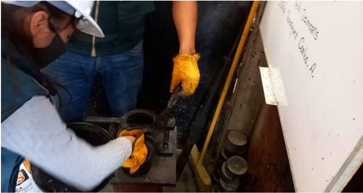
Fig. 85. Incorporación de mezcla en la primera parte del molde
