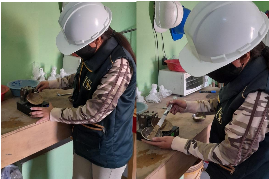
Fig. 74. Ensayo para el límite líquido, plástico e índice de plasticidad del agregado fino
