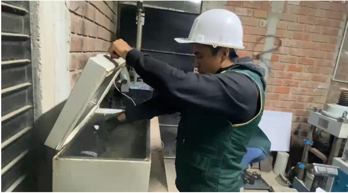
Fig. 93. Muestras a inmersión a una temperatura de 60° C
