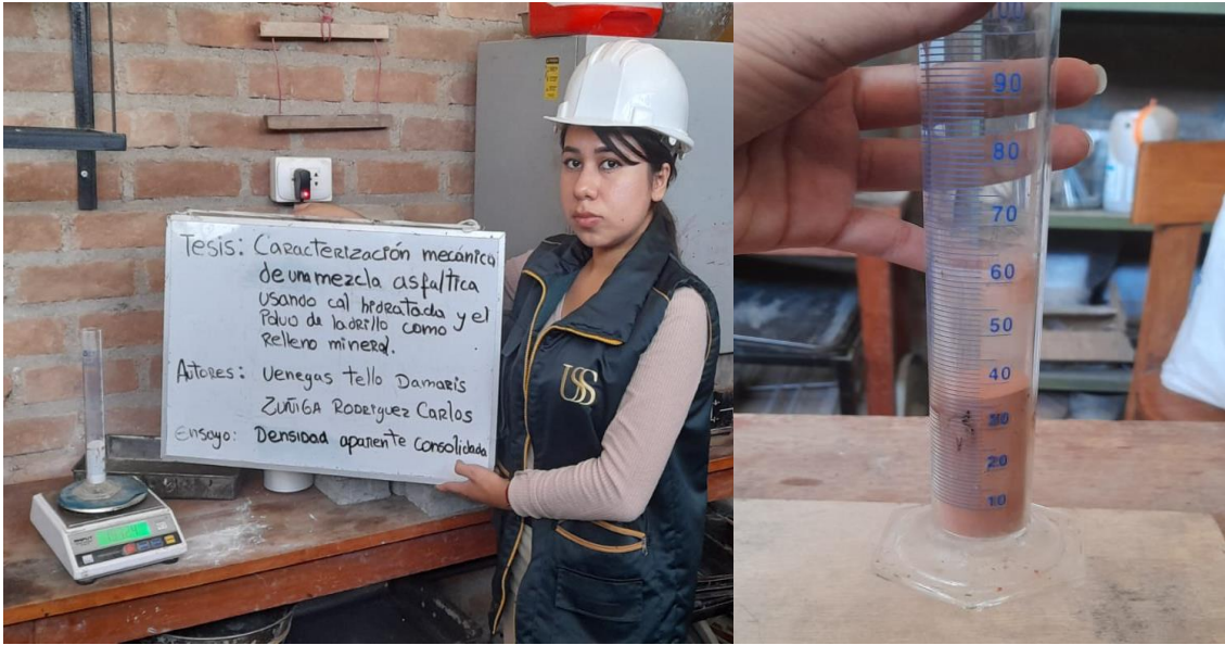
Fig. 79. Peso unitario compactado
