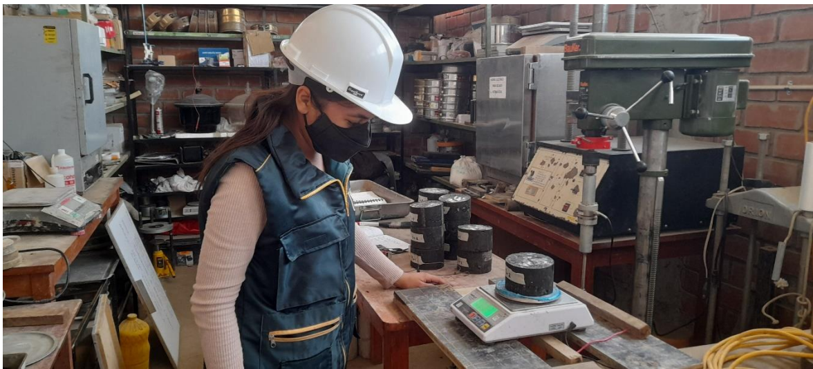
Fig. 92. Peso específico de briquetas patrón + cal+ polvo de ladrillo
