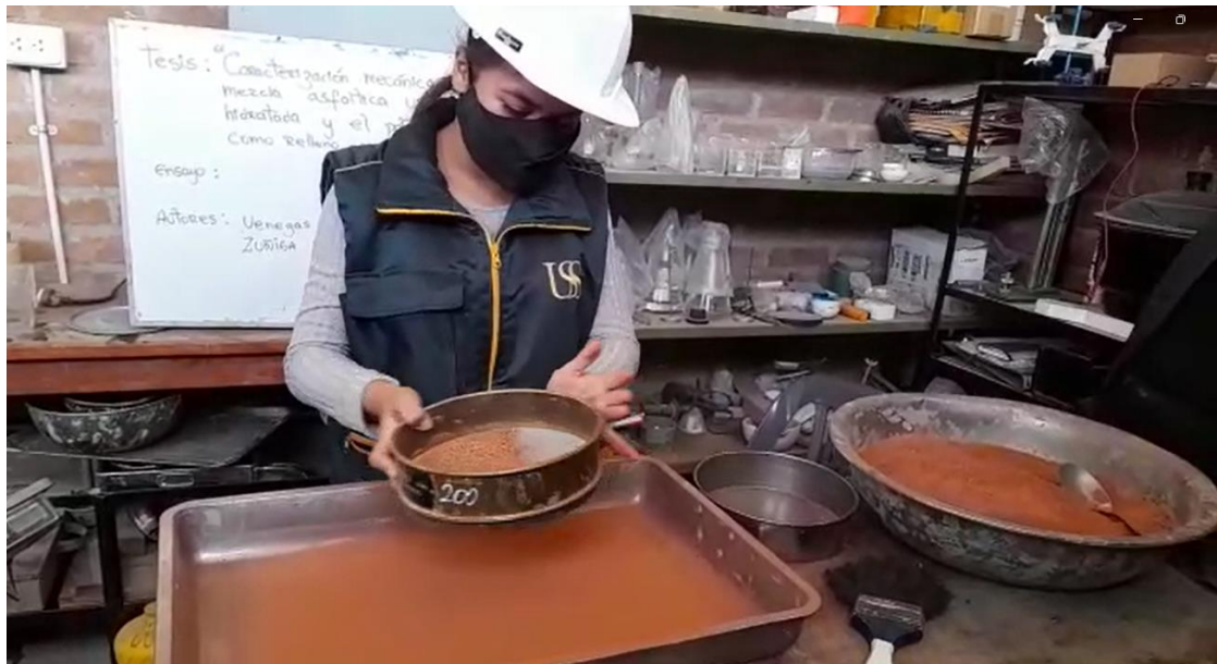
Fig. 80. Granulometría del polvo de ladrillo malla nº 200
