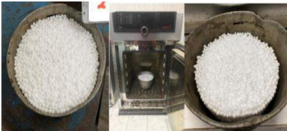
Fig. 5. El proceso de tratamiento térmico de perlas de EPS. [45]
