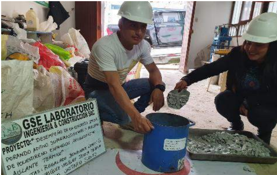
Fig. 15. Prueba de peso unitario a la grava.
