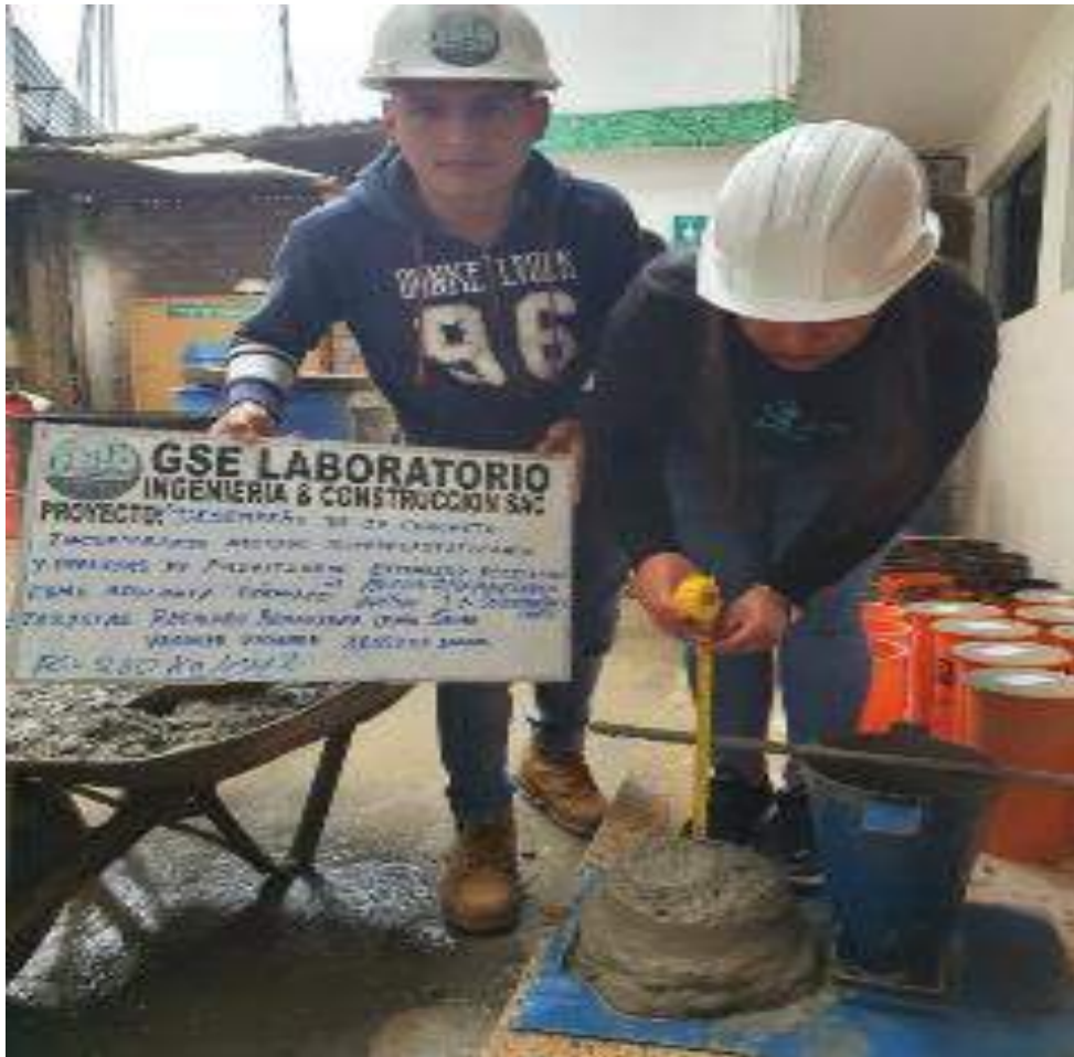
Fig. 20. Ensayo de asentamiento
