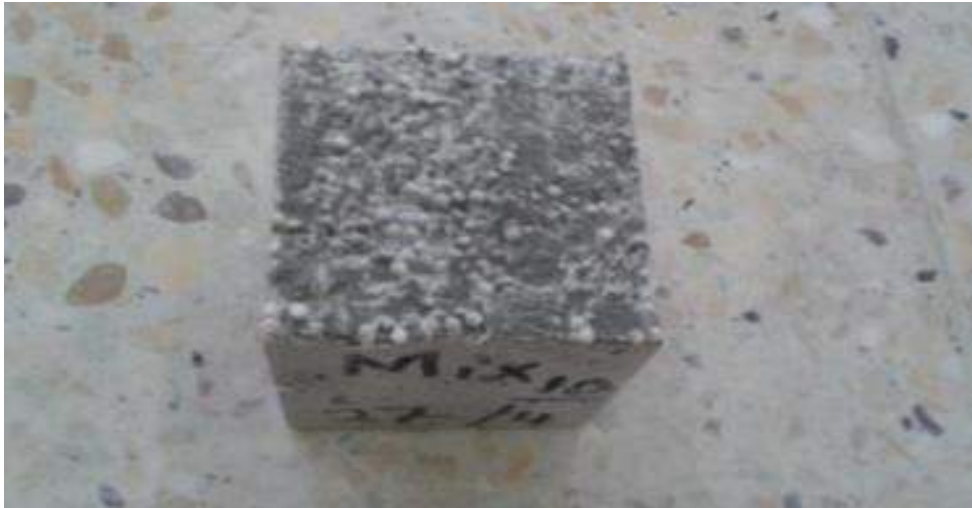
Fig. 6. Cubo de hormigón con perlas de EPS. [60]
