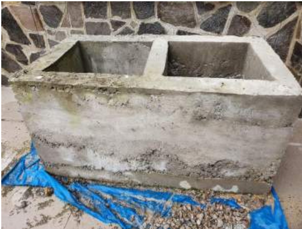
Anexo 2.21. Modelos a escala para el análisis de aislamiento térmico
