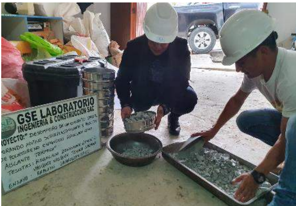
Fig. 14. Ensayo de granulometría a la grava.
