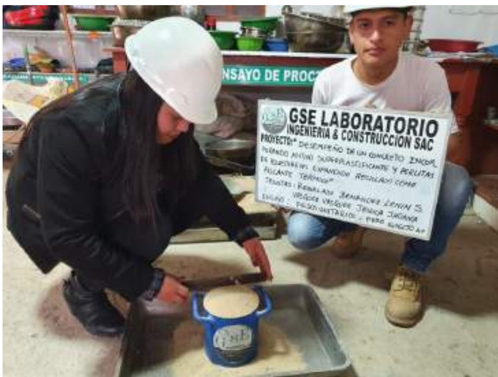
Anexo 2.10. Peso unitario peso suelto agregado fino: Enrasado para eliminar sobrante
