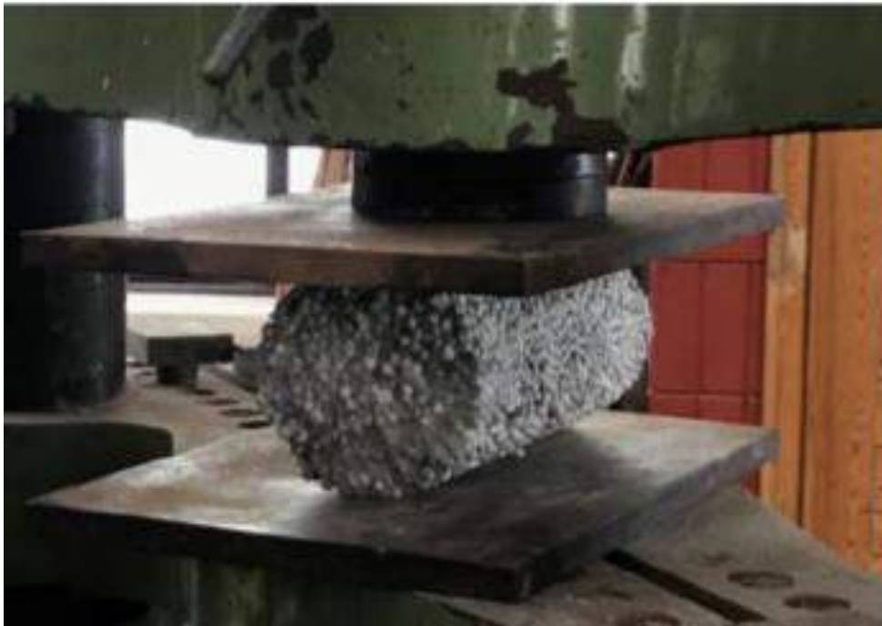
Fig. 9. Ensayo de tracción dividida. [56]
