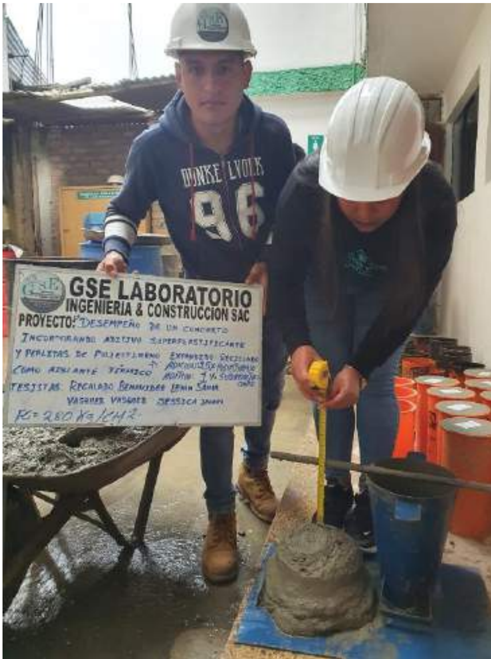
Anexo 2.15. Medición del asentamiento en la mezcla de concreto
