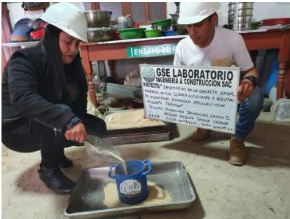
Anexo 2.10. Peso unitario peso suelto agregado fino: Enrasado para eliminar sobrante
