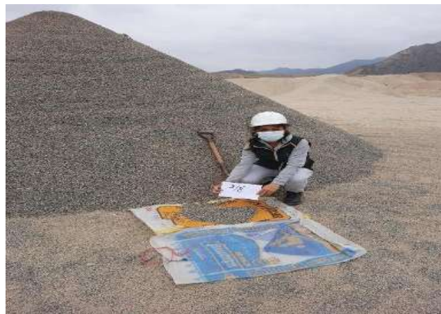
Fig. 4: Áridos de la Cantera Tres Tomas: A.G. 3/8”
