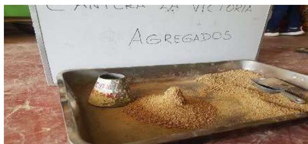
Fig. 17: Ensayando en el cono metálico
