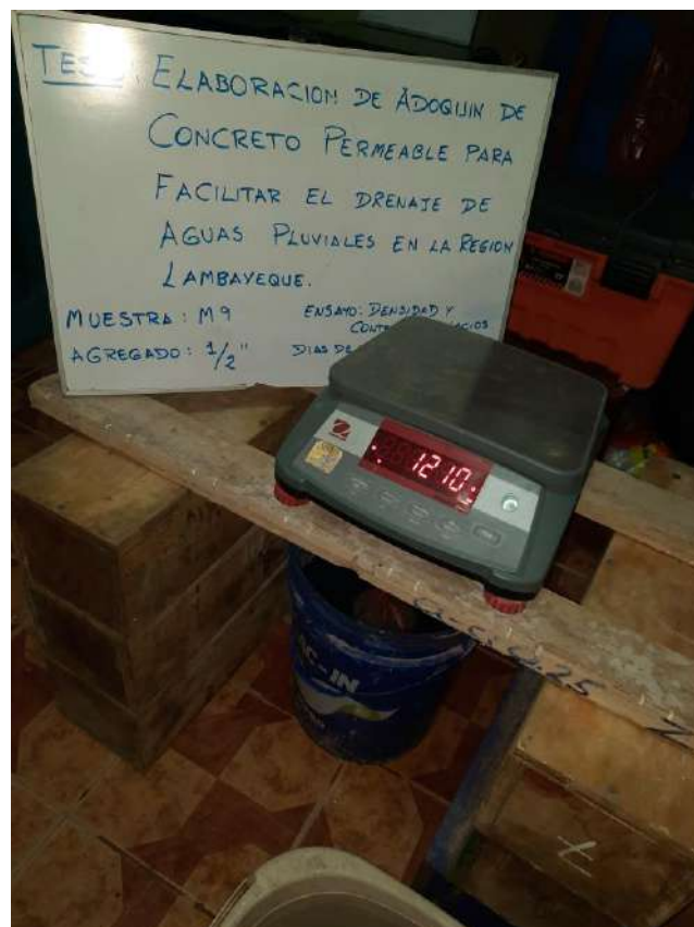
Fig. 30: Ensayo de D y %P, Peso de espécimen sumergido
