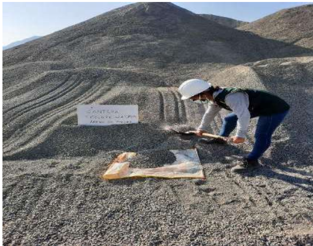
Fig. 13: Áridos de la Cantera Gogafe: A.F. Arena Zarandeada
