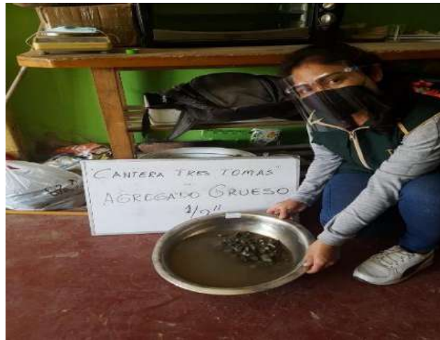
Fig. 18: Lavando agregado grueso
