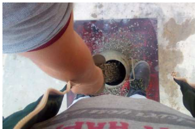
Fig. 22: Ensayo de Slump, vista de llenado del Cono de Abrams
