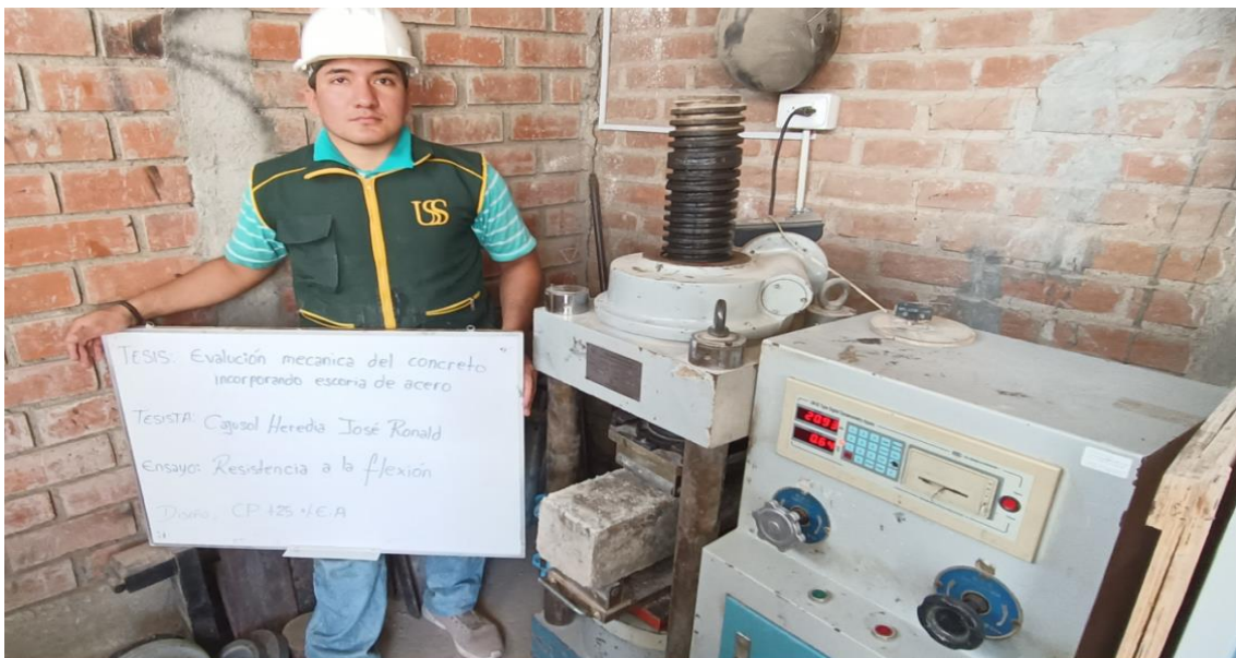
Evidencia 18: Ensayo de resistencia flexión.
