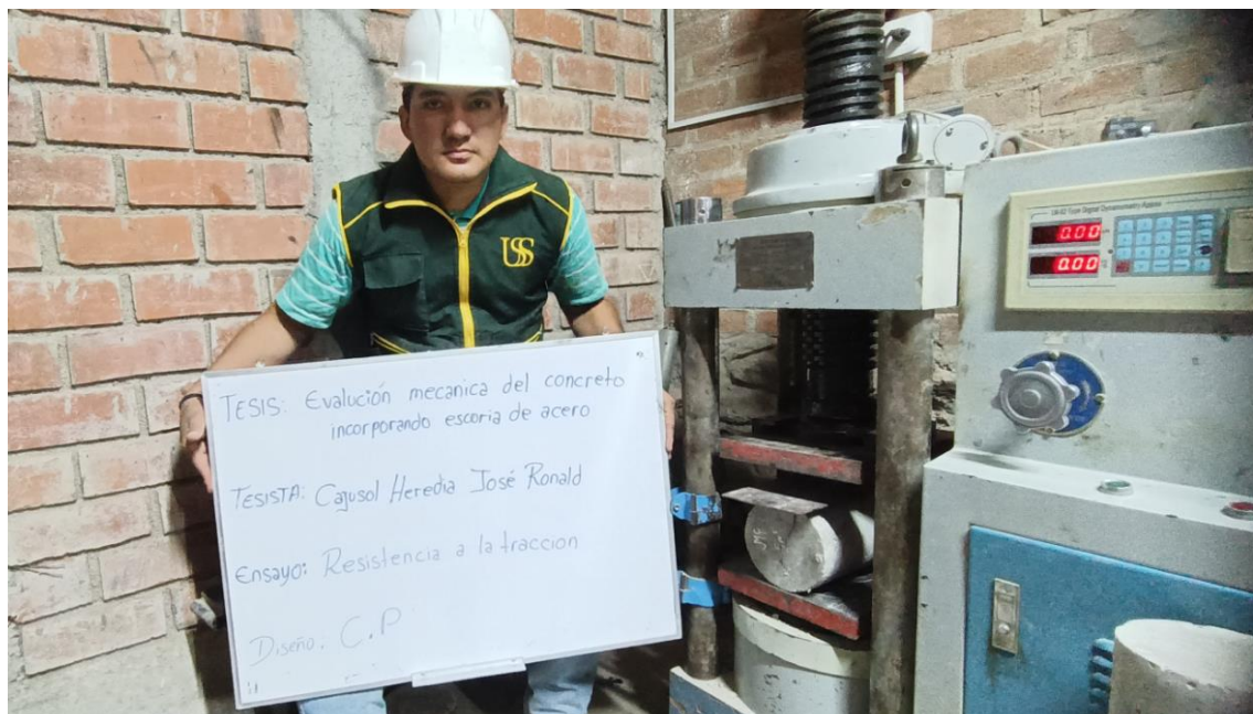
Evidencia 20: Ensayo de resistencia a la tracción
