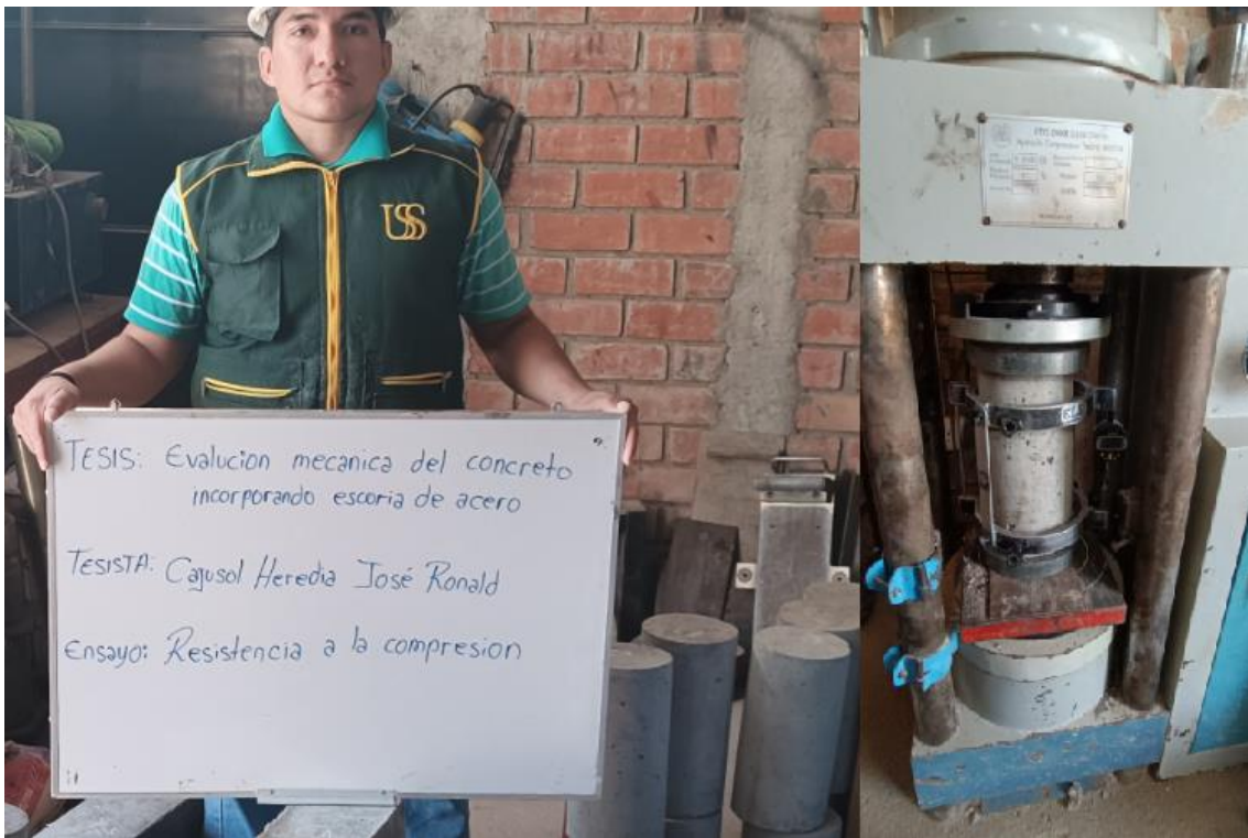
Evidencia 19: Ensayo de resistencia a la compresión
