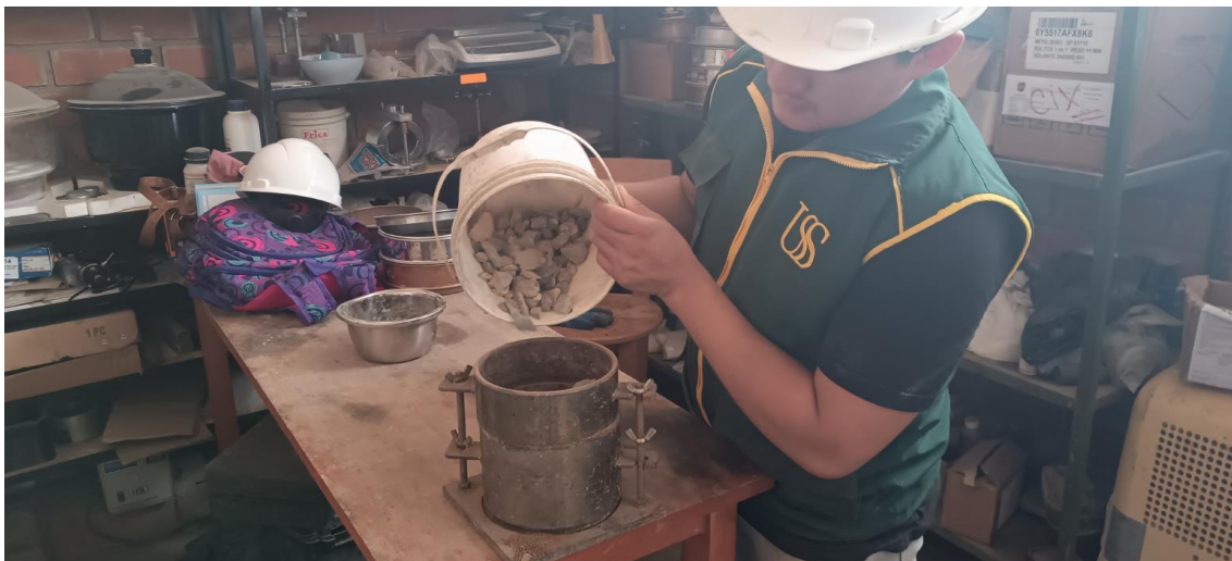
Evidencia 4: Ensayo de peso unitario suelto y compactado de los agregados
