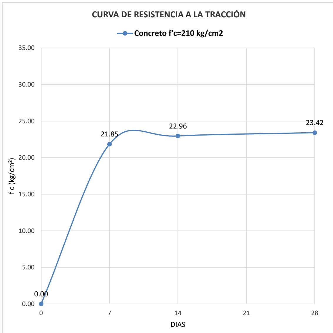
Fig. 19: Curva de resistencia a la tracción
