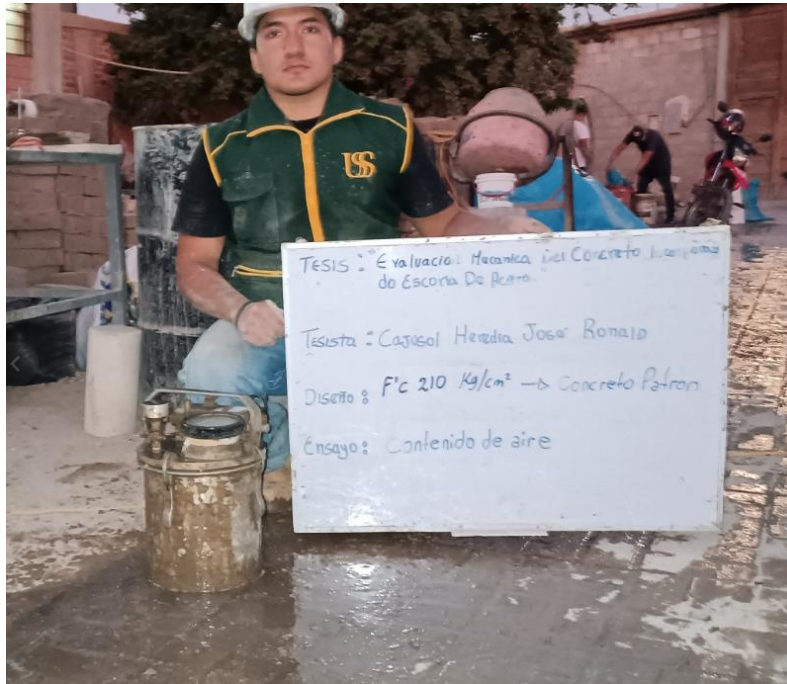
Evidencia 13: Ensayo de contenido de aire.
