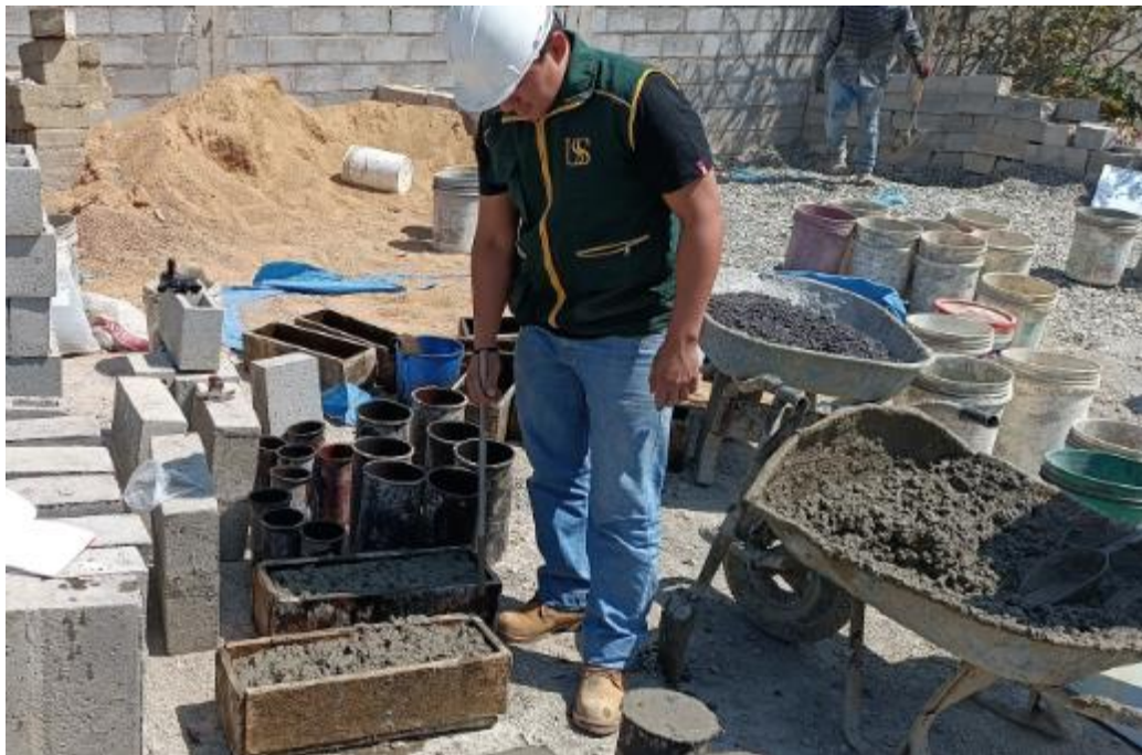
Evidencia 14: Vaciado de probetas y vigas
