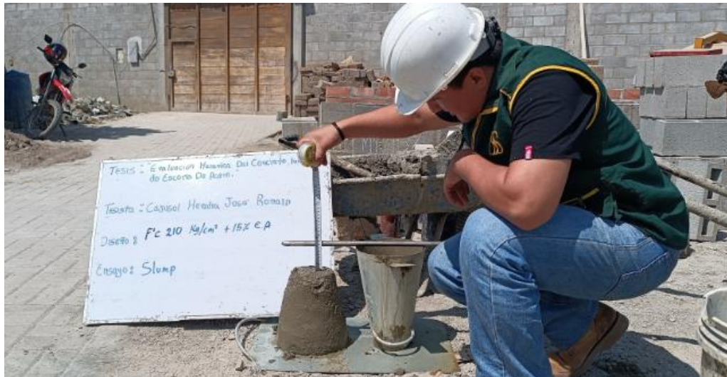
Evidencia 10: Ensayo de consistencia del concreto en estado fresco
