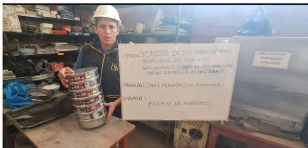
**Evidencia: Ensayo de peso unitario suelto y compactado de los agregados**
