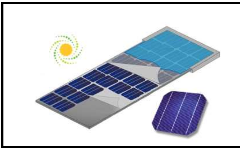
Figura 2. Grupo de celdas que forman el panel solar.
