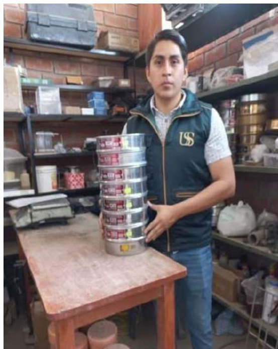
Fig.24. Tamizado de granulometría de los agregados
