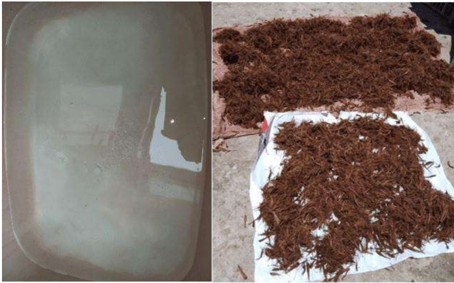
Fig.22. Lavado con cal y secado de la fibra de coco
