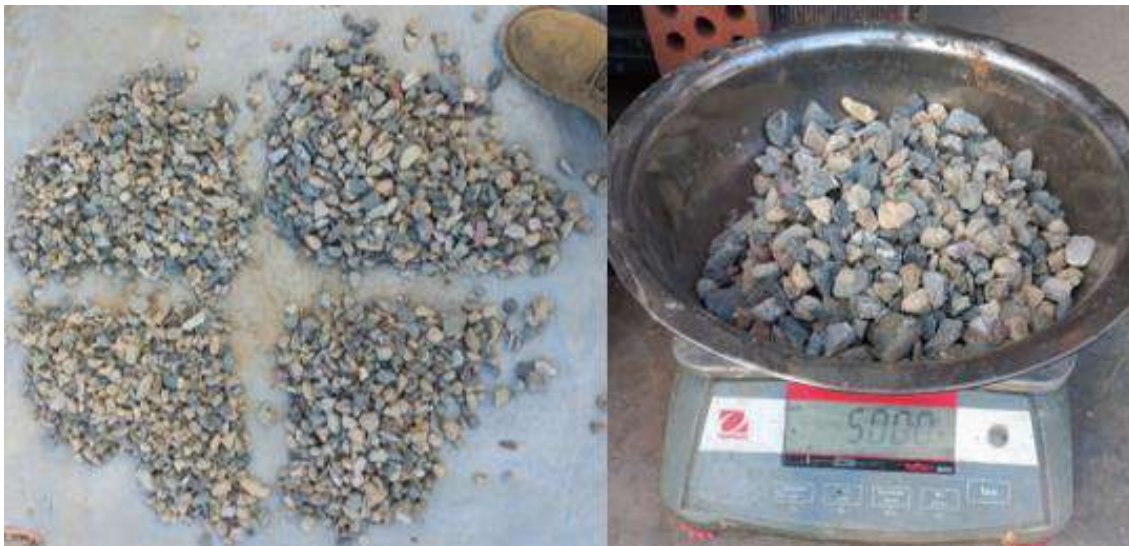
Fotografía 10. Cuarteo y peso de la muestra del agregado grueso
