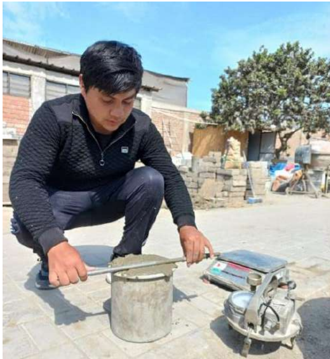
Fotografía 22. Peso Unitario del concreto fresco
