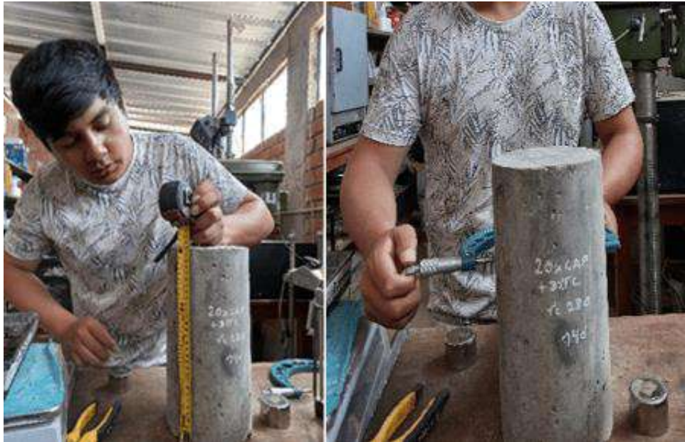
Fotografía 23. Medición de las muestras de concreto
