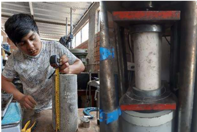
Fig.34. Muestra ensayada a compresión
