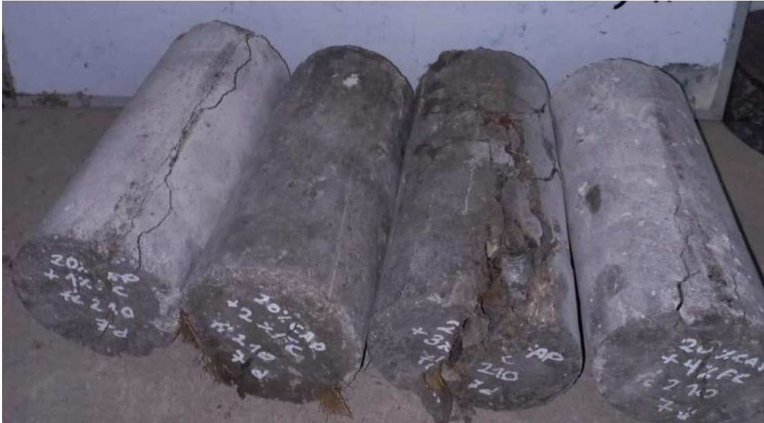
Fotografía 29. Fracturas a la tracción en los concretos para resistencia de 210kg/cm 2
