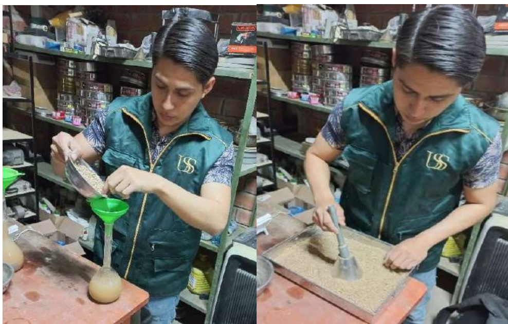
Fig.28. Ensayo de peso específico y absorción; asentamiento del AF.
