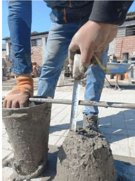
Fig.3. Prueba de asentamiento
