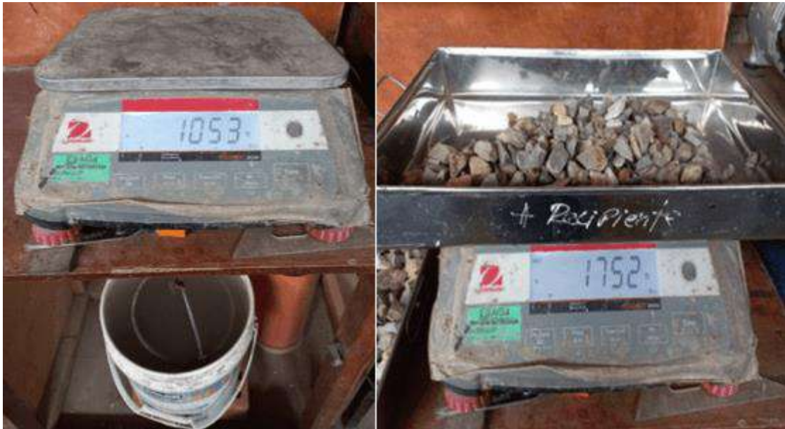
Fotografía 11. Peso específico y absorción del agregado grueso
