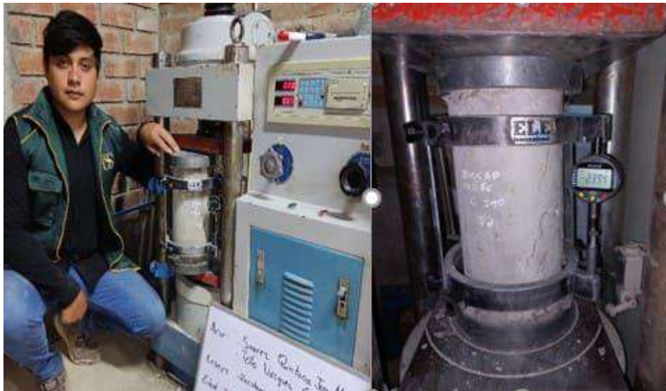
Fig.37. Muestra ensayada a módulo de elasticidad
