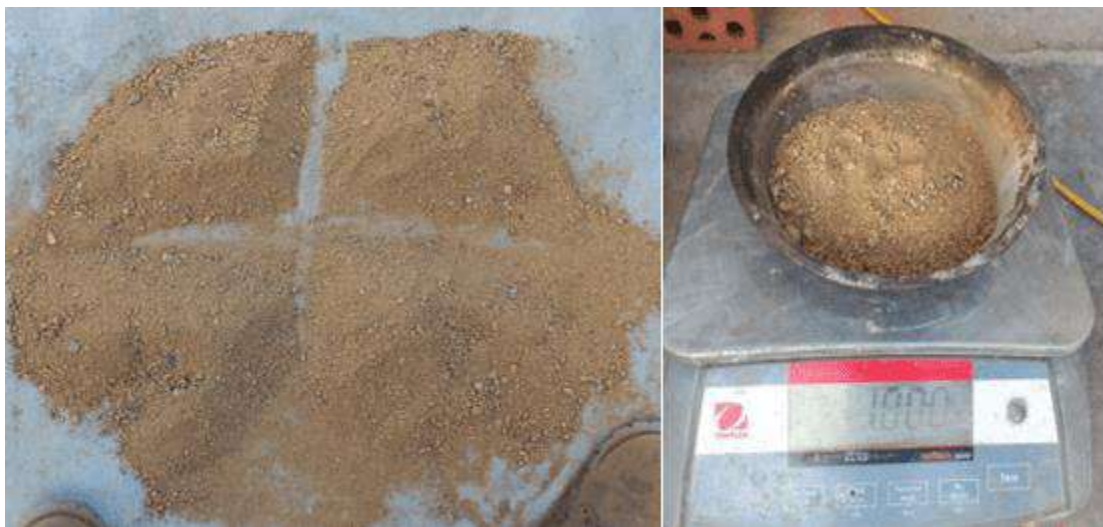
Fotografía 12. Cuarteo y peso de la muestra del agregado fino
