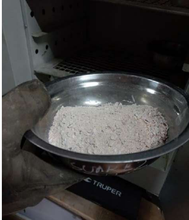
Fig.19. Ensayo de contenido de humedad del CAP
