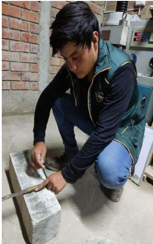
Fotografía 31. Medición de las muestras tipo viga de concreto
