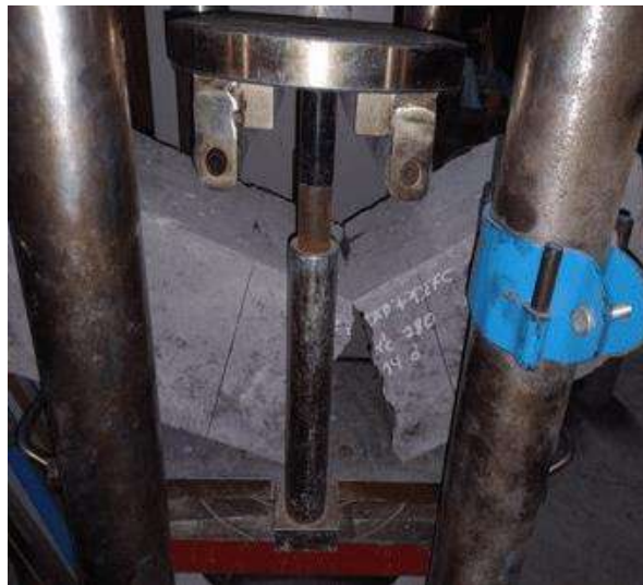
Fig.36. Muestra ensayada a flexión.
