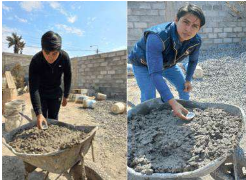
Fotografía 20. Temperatura del concreto fresco
