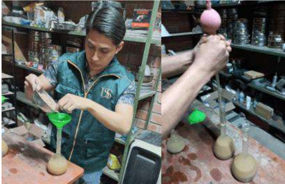
Fotografía 13. Peso específico y absorción del agregado fino
