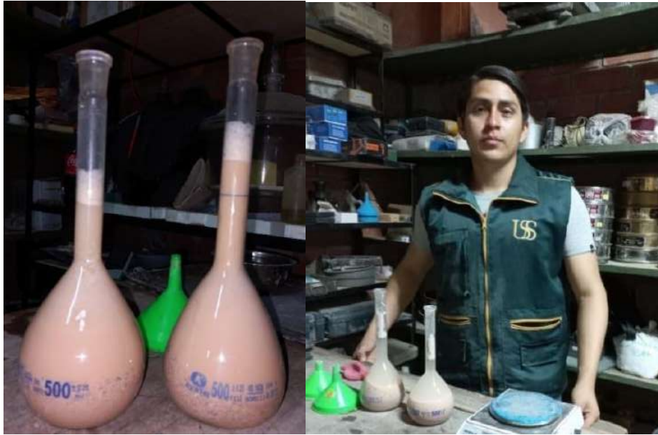
Fig.20. Ensayo de Absorción del CAP
