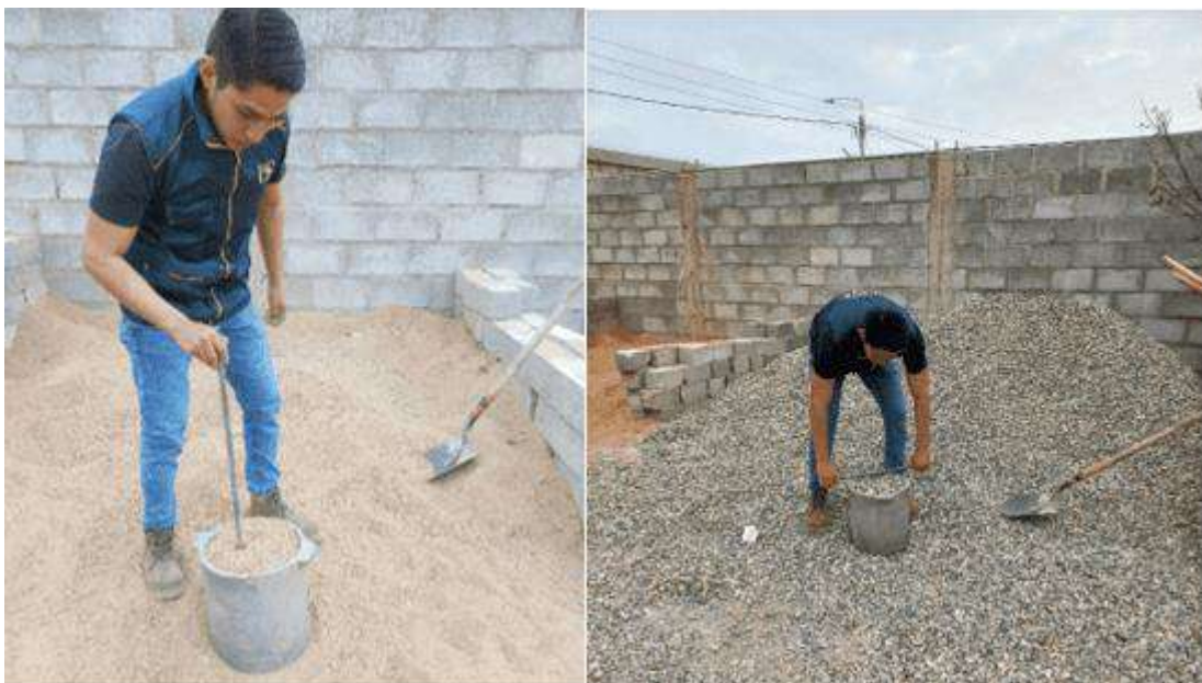
Fotografía 8. Peso Unitario de los agregados
