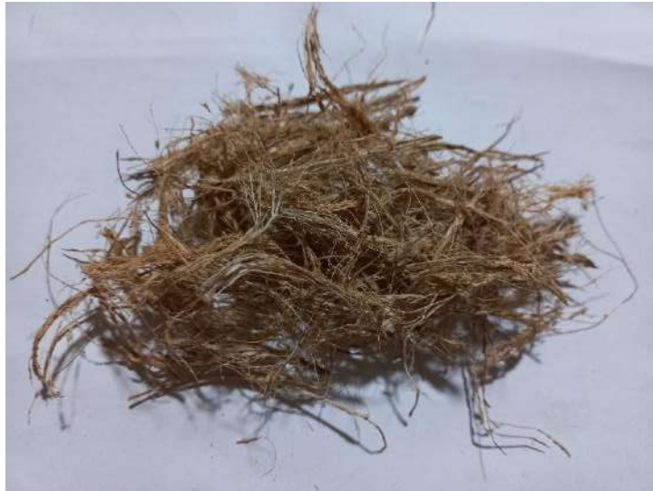
Fotografía 7. Fibra de coco dehiladas
