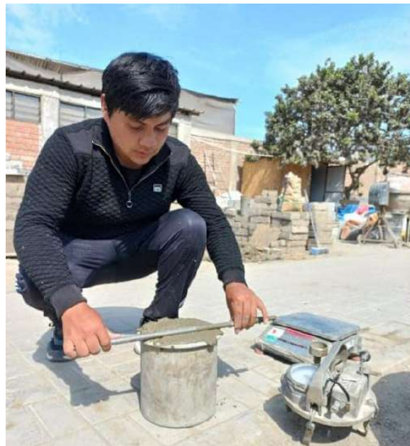
Fig.32. Peso unitario que presenta el concreto recién elaborado
