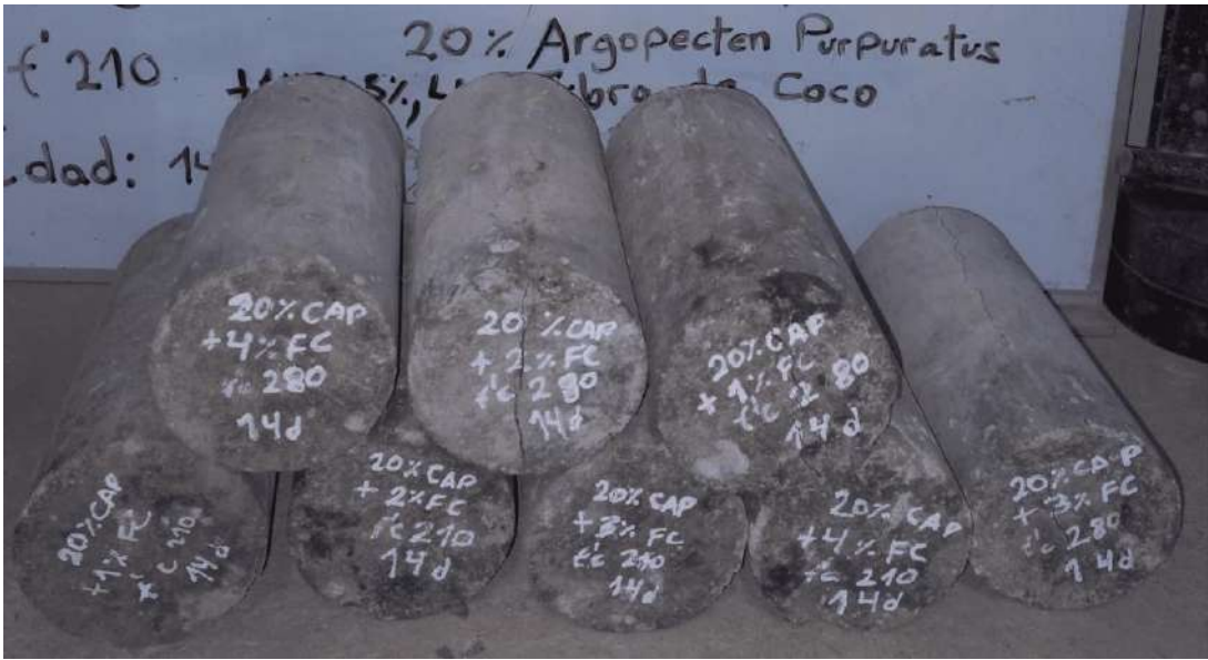
Fotografía 30. Fracturas a la tracción en los concretos para resistencia de 280kg/cm 2
