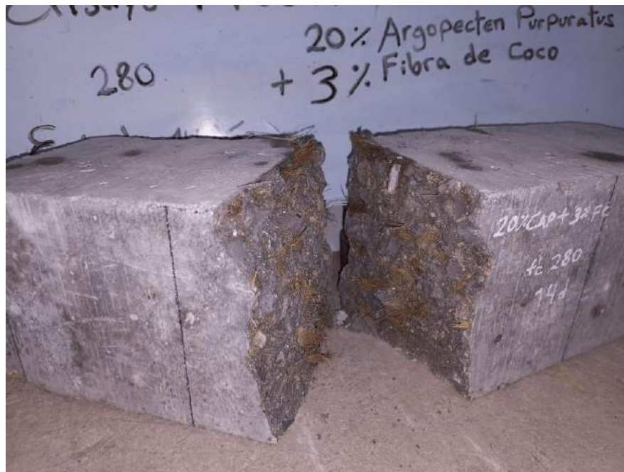
Fotografía 33. Fracturas a la flexión 280kg/cm 2
