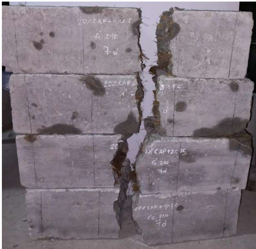
Fotografía 33. Fracturas a la flexión en los concretos para resistencia de 210kg/cm 2
