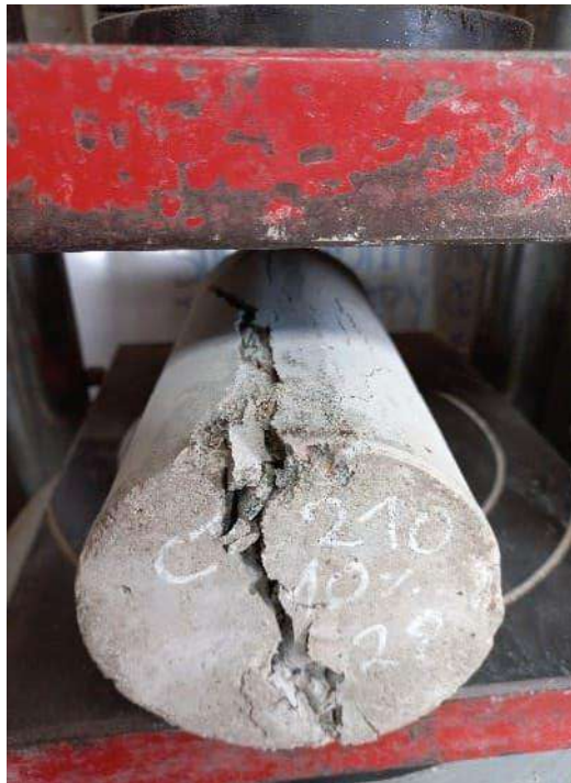
Fotografía 28. Muestras de concreto ensayado a tracción
