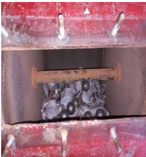
Fig.17. Proceso de triturado del CAP en la máquina de los Ángeles
