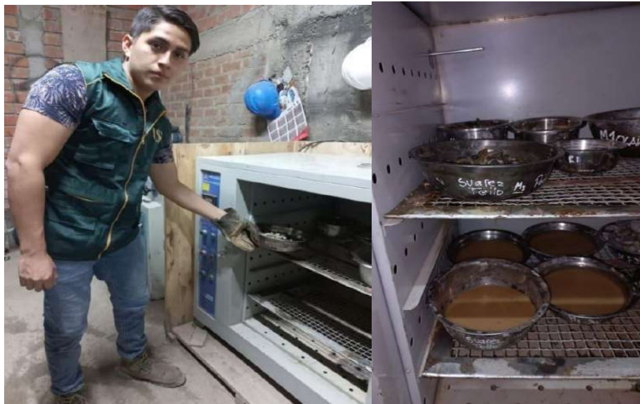
Fotografía 14. Contenido de humedad de los agregados
