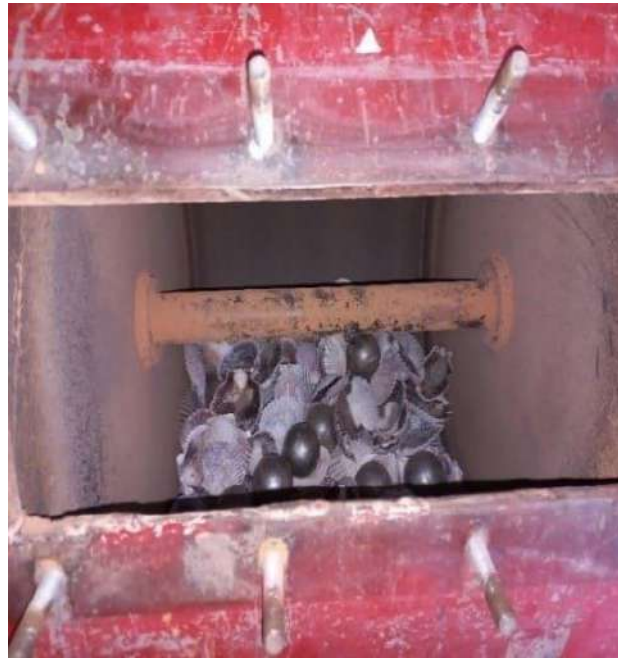
Fotografía 5. Triturado de la cáscara de Argopecten Purpuratus en la maquina de los Angeles
