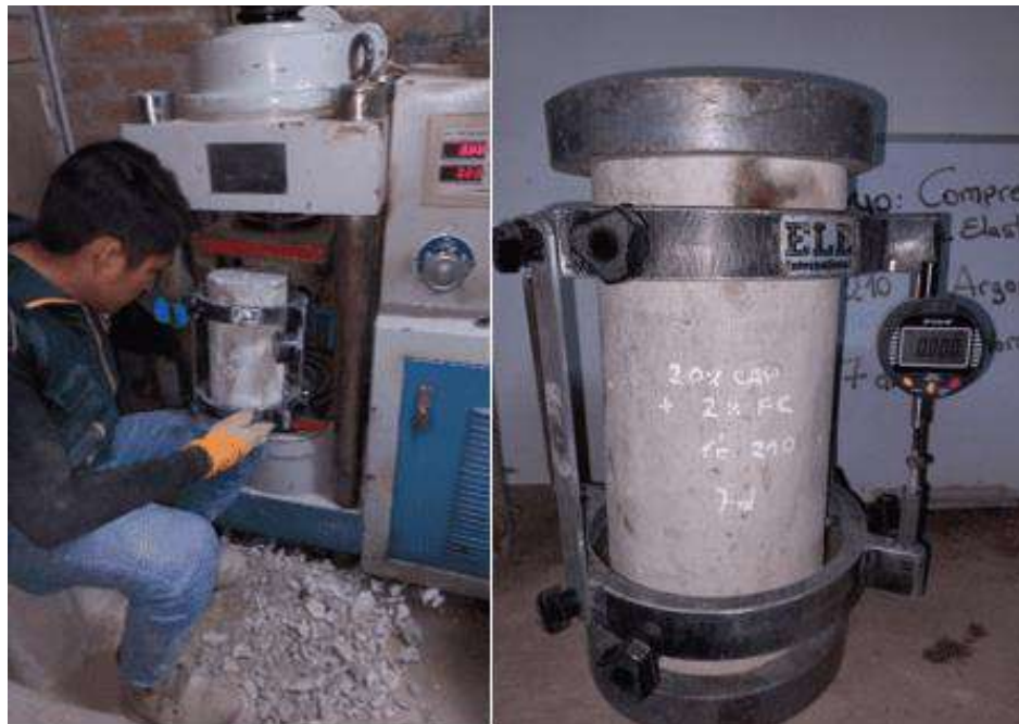
Fotografía 24. Muestras de concreto ensayadas
