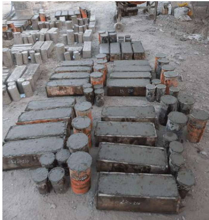
Fotografía 16. Vaciado de la mezcla de concreto en los moldes
