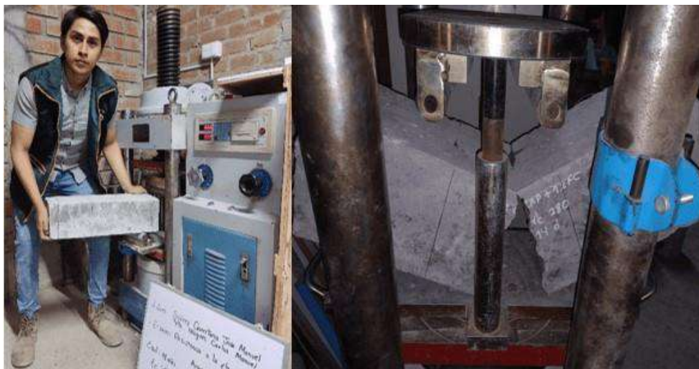
Fotografía 32. Muestra tipo viga ensayada flexión
