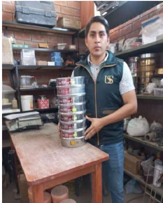
Fotografía 9. Granulometría de los agregados
