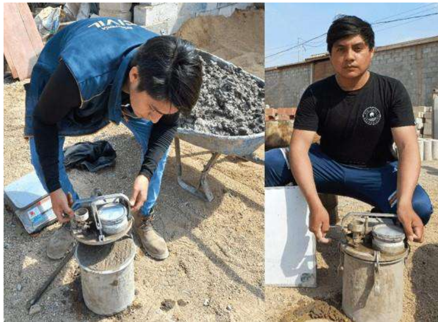
Fig.33. Medición de contenido de aire que presenta el concreto recién elaborado
