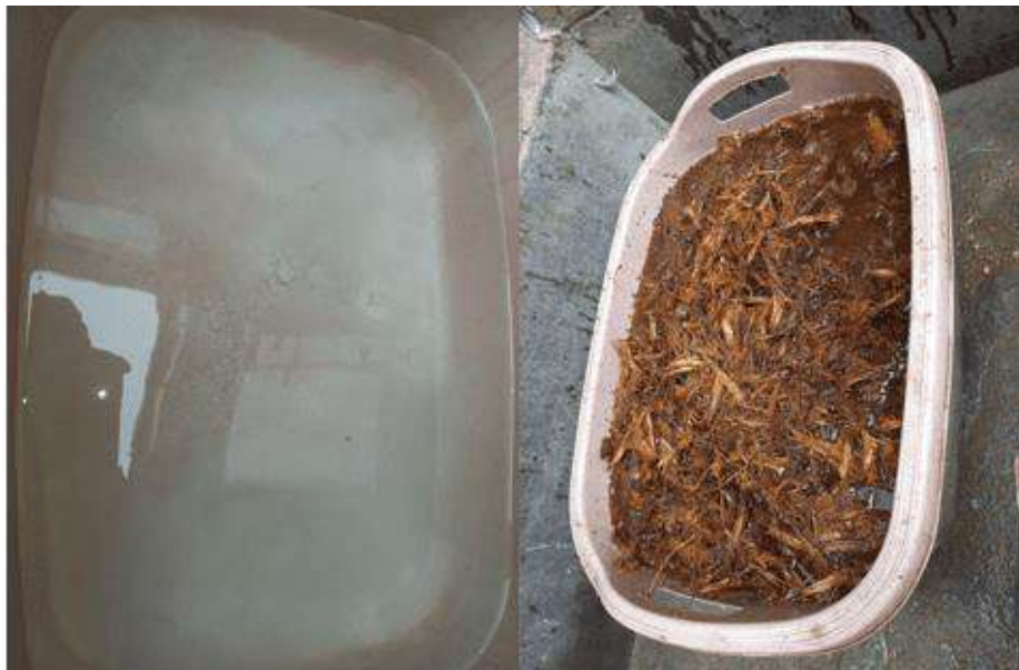
Fotografía 6. Tratamiento de la fibra de coco con Cal
