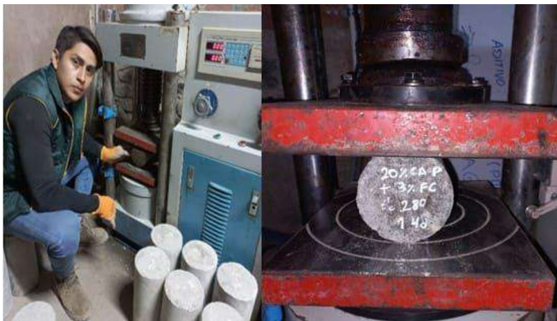
Fig.35. Muestra ensayada a tracción.
