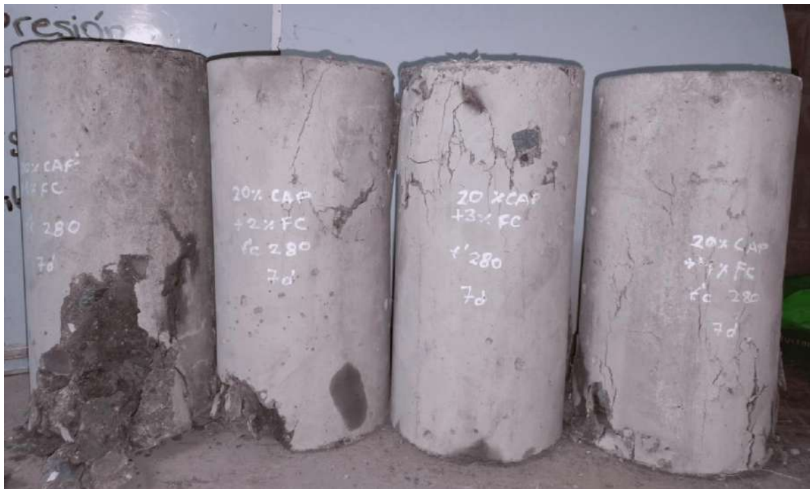
Fotografía 26. Fracturas a la compresión en los concretos para resistencia de 280\text{kg/cm}^2
