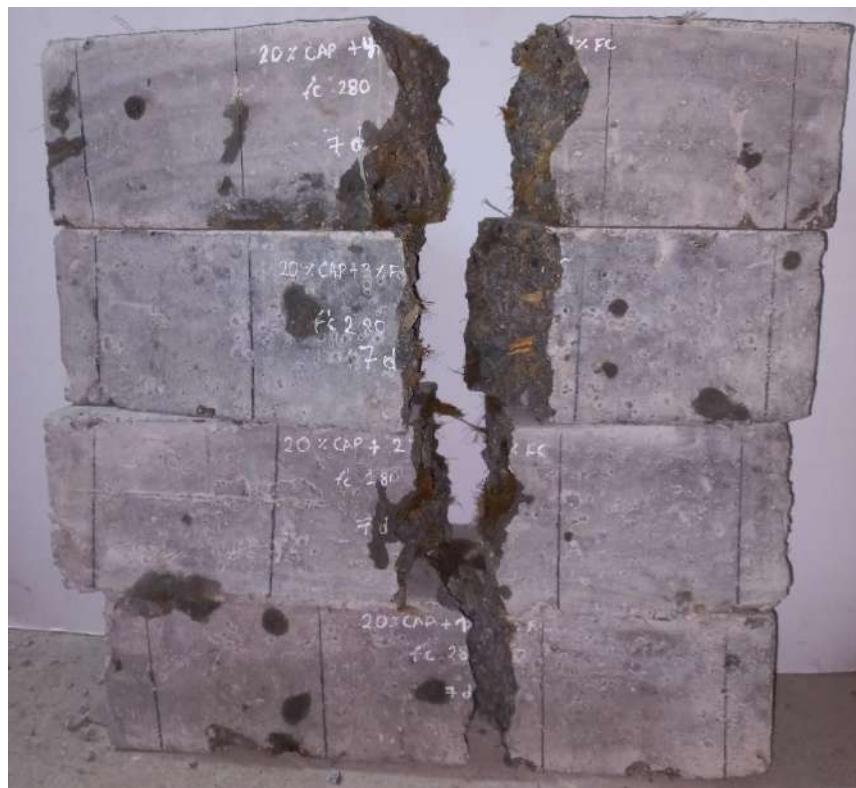
Fotografía 33. Fracturas a la flexión en los concretos para resistencia de 280kg/cm 2
