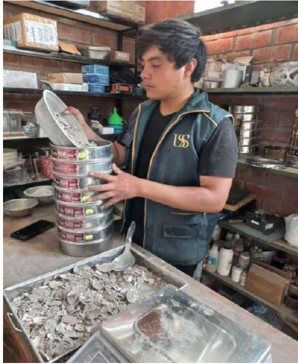
Fig.18. Proceso de tamizado del CAP
