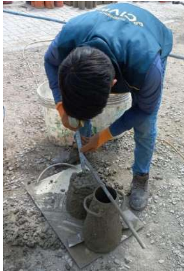
Fig.30. Medición del asentamiento que presenta el concreto fresco.
