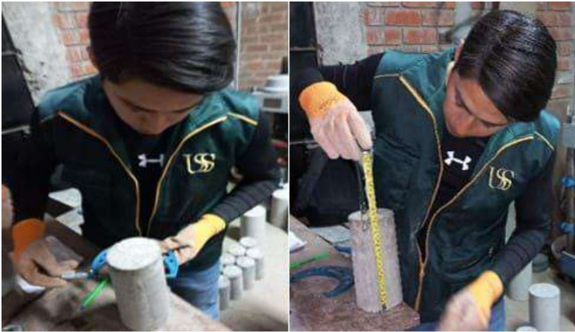
Fotografía 27. Medición de las muestras de concreto
