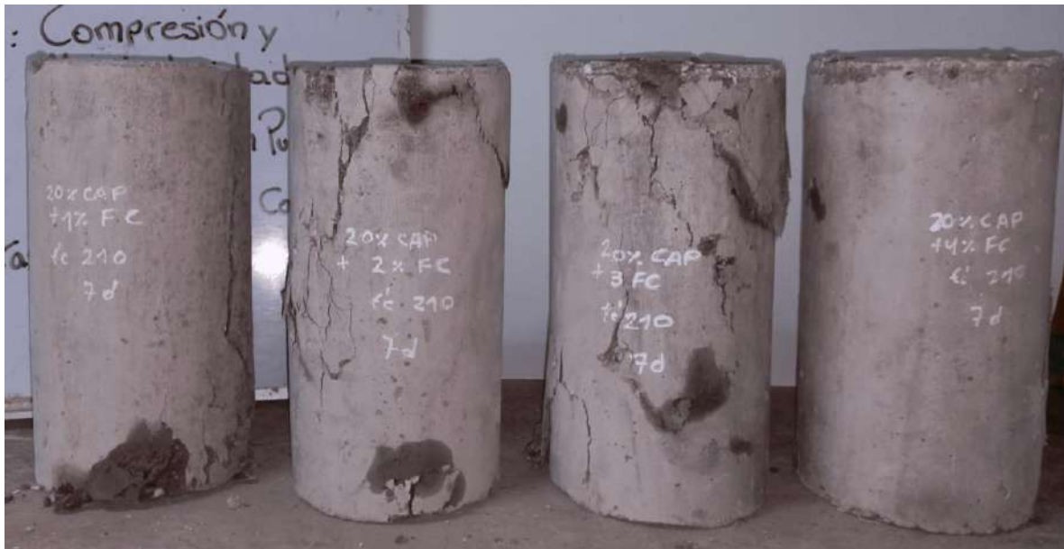
Fotografía 25. Fracturas a la compresión en los concretos para resistencia de 210\text{kg/cm}^2
