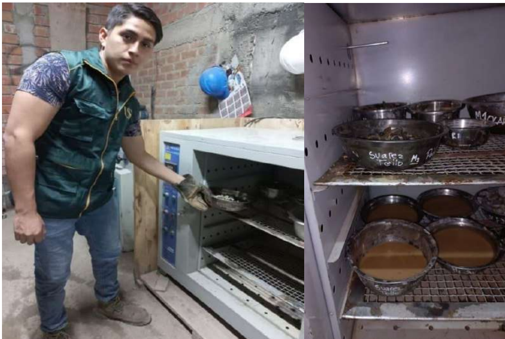
Fig.26. Muestra de los agregados colocados en el horno
