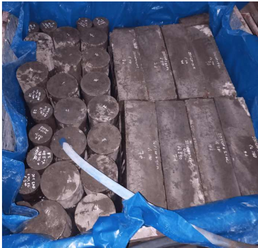
Fotografía 18. Curado del concreto
