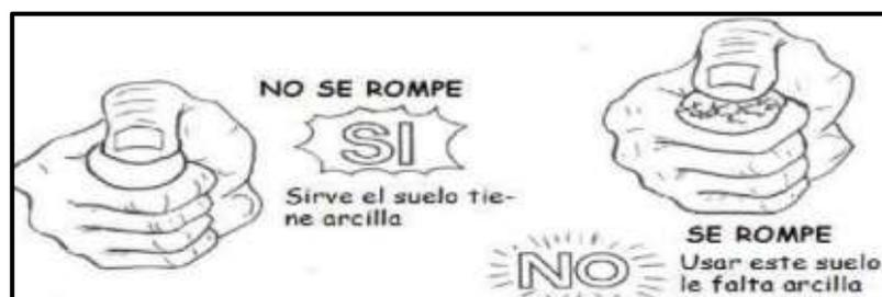
**Fig. 9.** Realización de prueba. [40]
