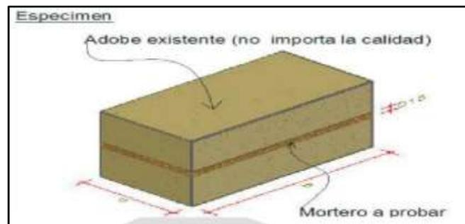
**Fig. 10.** Prueba control de fisuras. [40]
