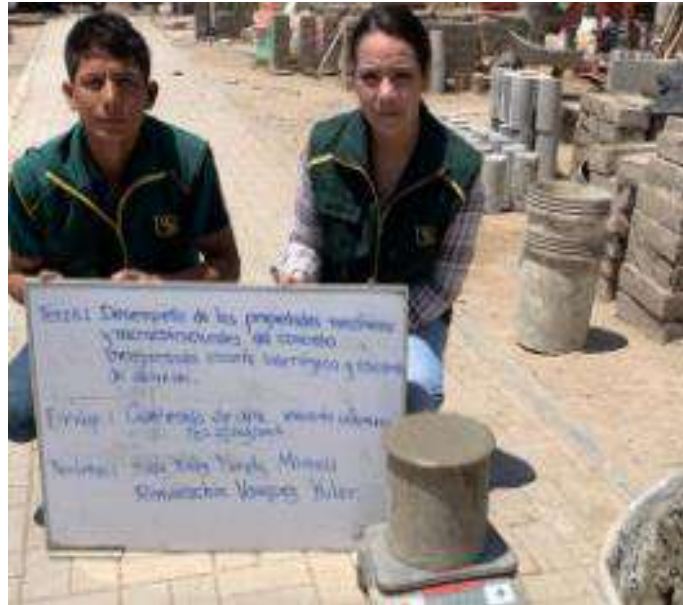
Fig. 14. Ensayo de peso unitario del concreto fresco.
