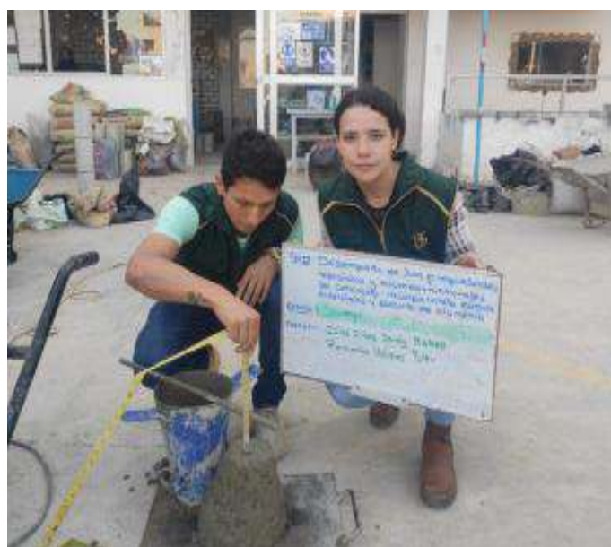
Fig. 12. Ensayo de asentamiento al concreto en estado fresco.
