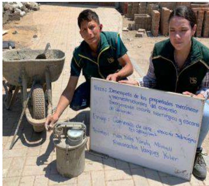
Fig. 15. Ensayo de contenido de aire.
