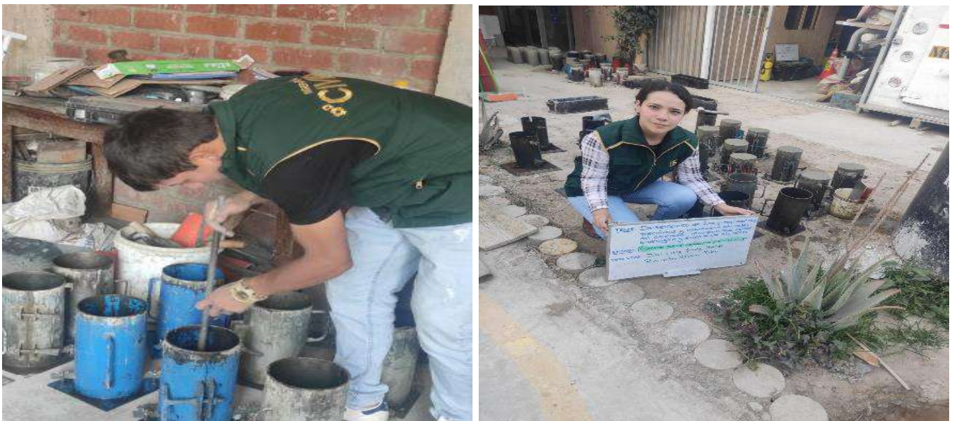
Fig. 43. Vaciado de probetas y vigas del concreto con ES
