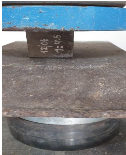
Figura 16: Rotura de cubos
