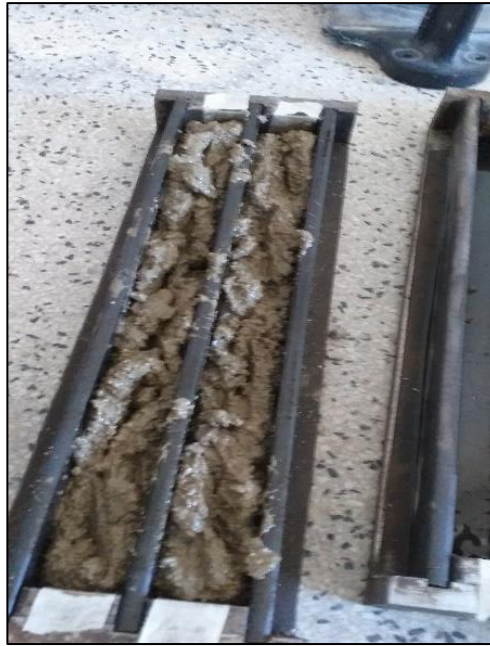
Figura 17: Elaboración de vigas de mortero
