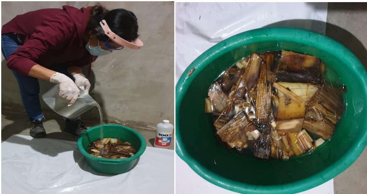
Fotografía 6. Proceso de mercerización de la fibra en solución de hidróxido de sodio
