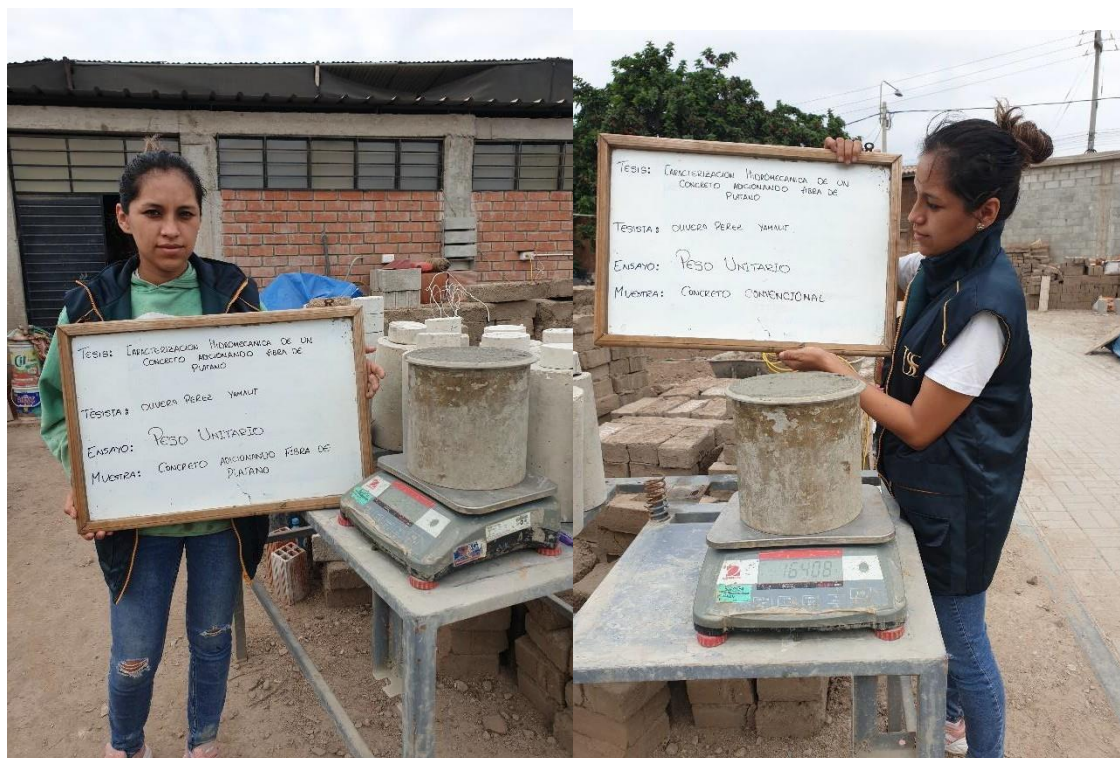
Fotografía 18. Ensayo de peso unitario para las muestras experimentales
