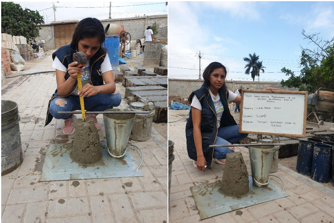
Fotografía17. Ensayo slump para muestras experimentales
