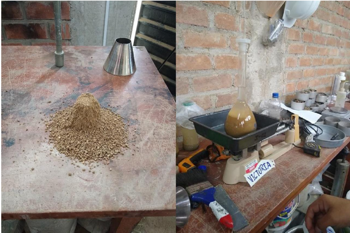
Fotografía 11. Ensayo de peso específico y absorción del agregado fino
