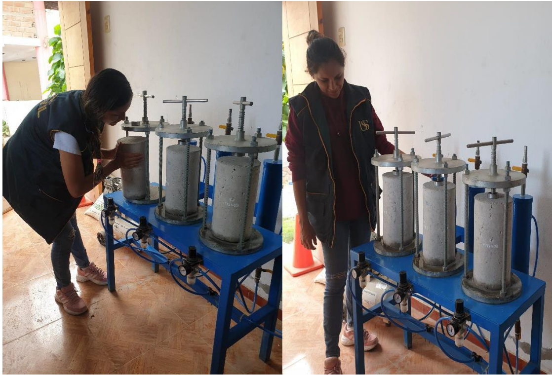
Fotografía 21. Ensayo de permeabilidad de las muestras experimentales
