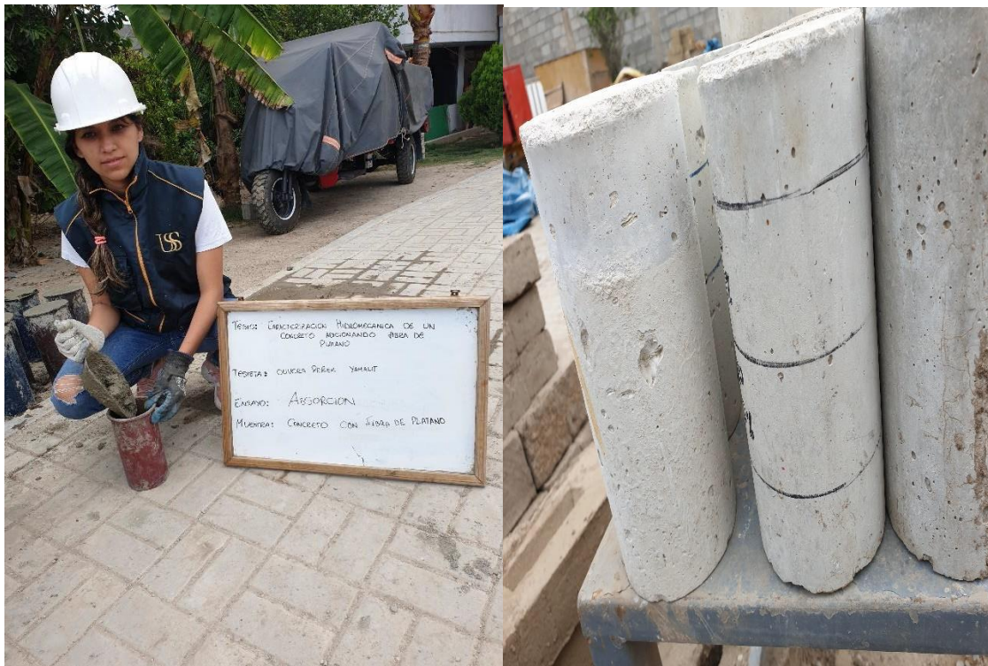
Fotografía 20. Ensayo de absorción de las muestras experimentales
