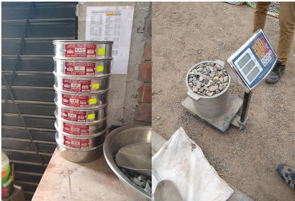
Fotografía 10. Granulometría, peso unitario compactado del árido grueso
