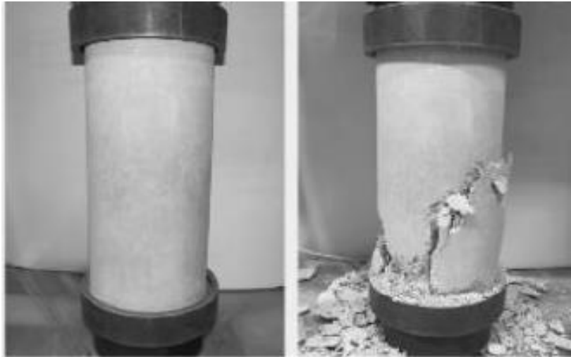
Fig. 5. Rotura de probeta a la fortaleza a la compresión axial. [50].
