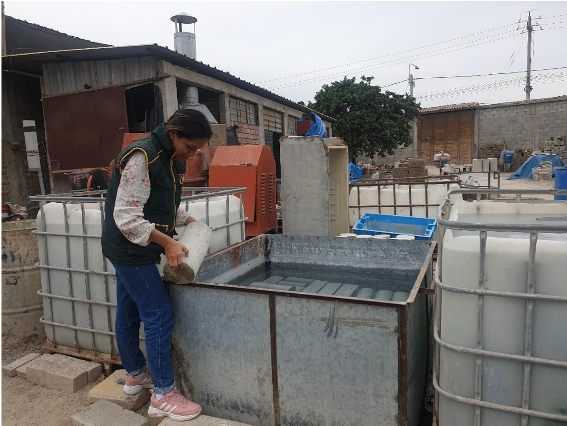
Fotografía15. Curado de testigos de concreto en estado endurecido para los días establecidos
