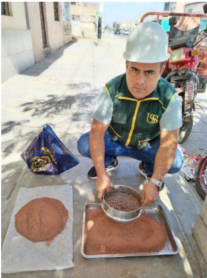
Tamizado del ladrillo de arcilla reciclado
