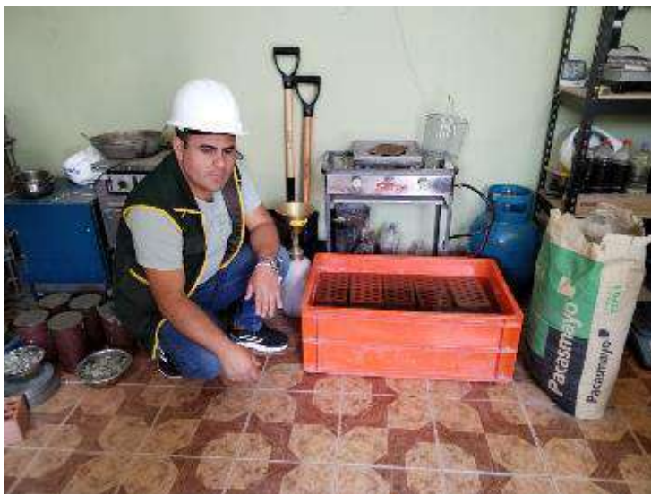
Peso de unidades saturadas para determinar el porcentaje de absorción (%).
