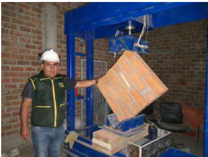
Rotura de muretes de albañilería.
