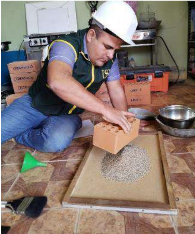
Determinación del porcentaje de vacíos en la unidad de albañilería.
