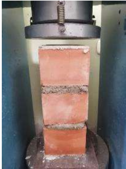
Fig. 21. Resistencia a la compresión: Pilas.
