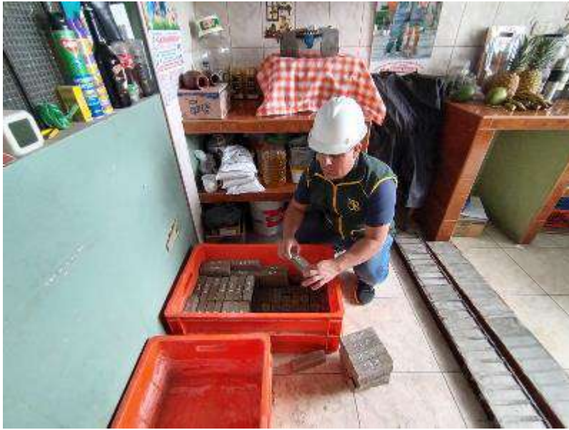
Curado de vigas
