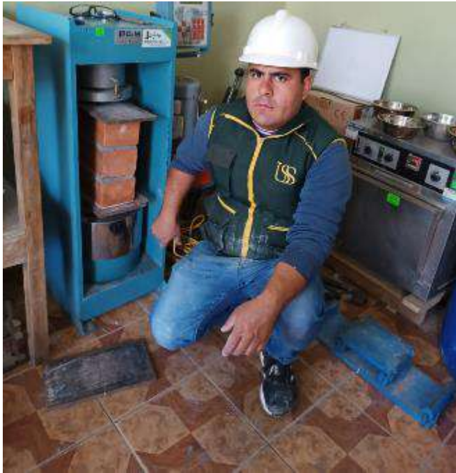
Ensayo de resistencia a compresión axial.
