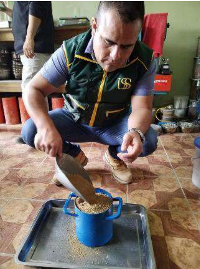
Peso unitario suelto del agregado fino.
