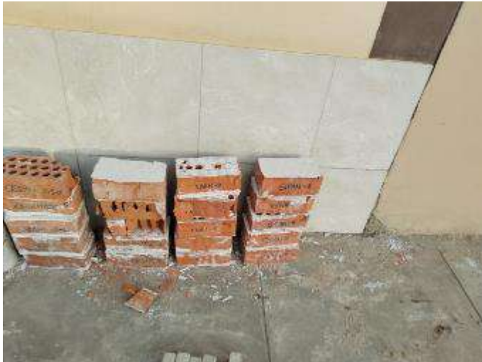
Ensayo de resistencia a compresión axial de las unidades de albañilería
