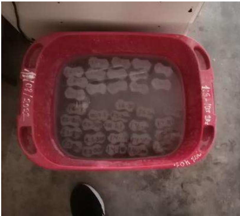
Curado de especímenes de tracción
