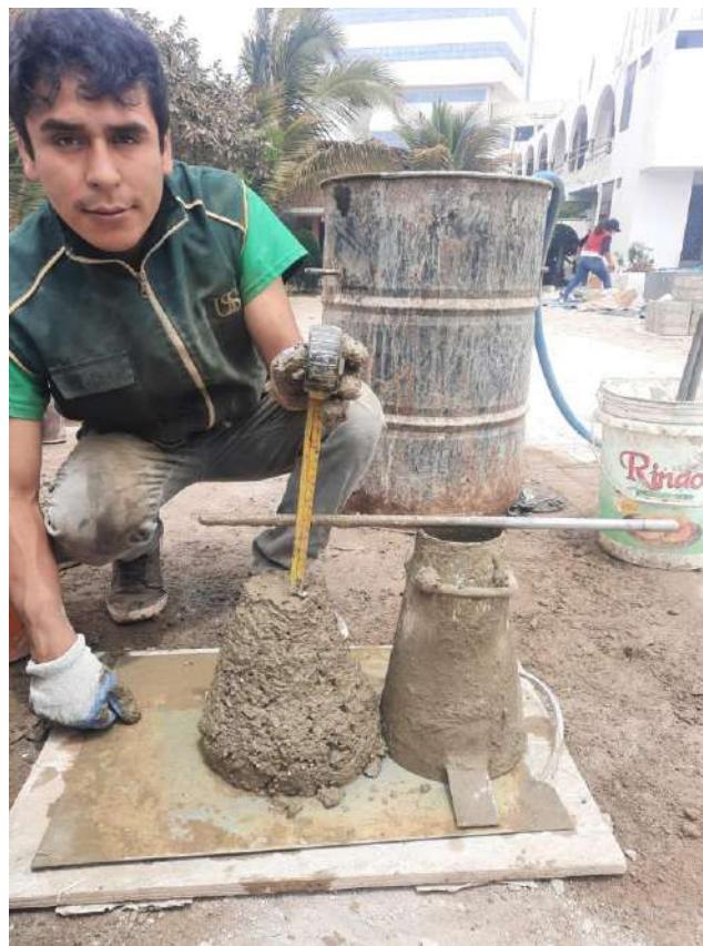
Fig. 10. Asentamiento del concreto
