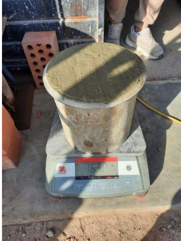
Fig. 12. Peso unitario del concreto
