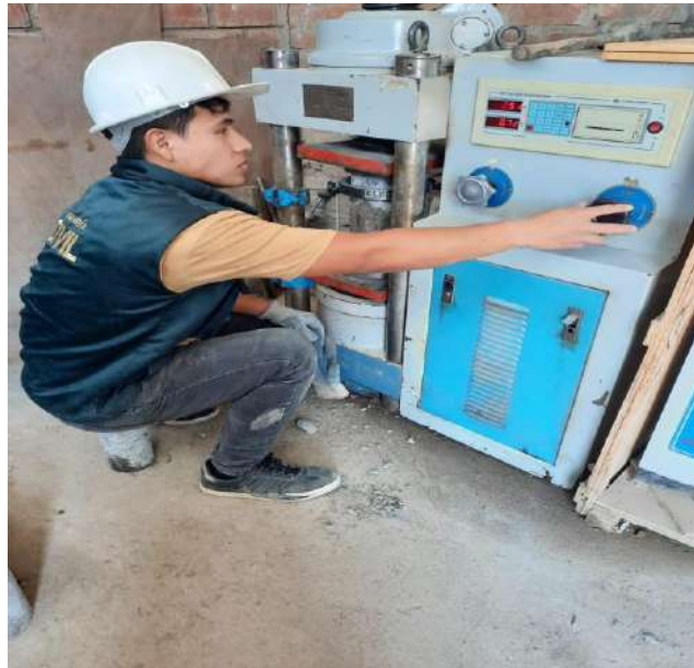
Fig. 13. Ensayo de resistencia a compresión
