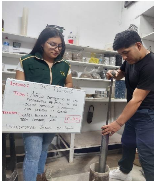
Fig. 22. Ensayo de CBR
