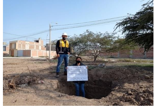
Fig. 28. Muestra de calicata con fines de evaluación
