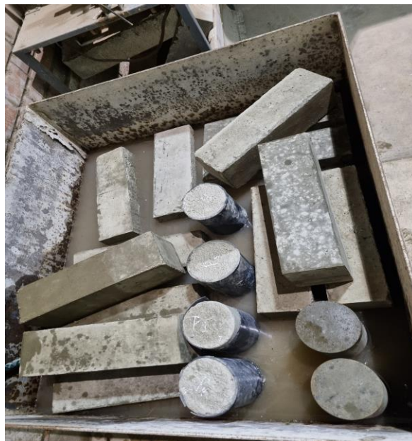
Fotografía 12. Llenado con agua para el Curado de los especímenes
