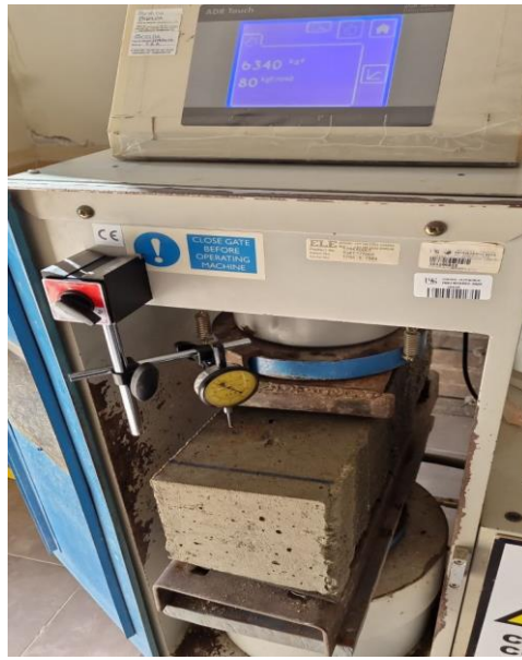
Fotografía 13. Ruptura de las vigas reforzadas de bambú y acero por el ensayo a Flexión Fuente: Propia
