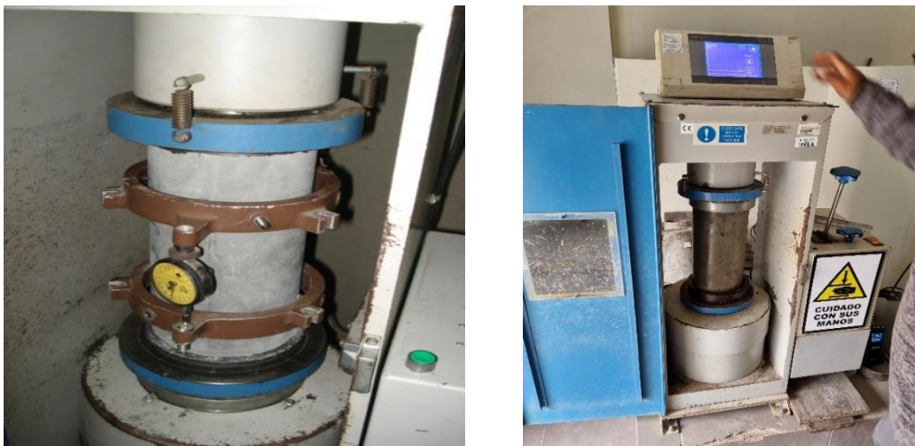
Fig. 9. Ensayo de módulo de elasticidad. [81]
