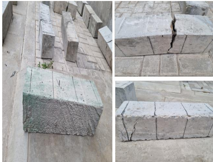
Fotografía 14. Fallas por corte y agrietamiento tras recibir cargas de la maquina a flexión de las vigas reforzadas de bambú y acero por el ensayo a Flexión
