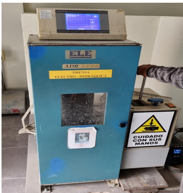
Fig. 7 Dispositivo para evaluar la resistencia a la compresión. [78]
