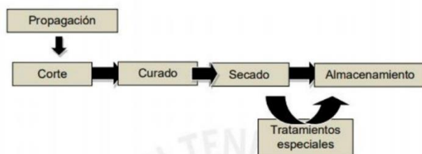
Fig. 3 El diagrama ilustra el procedimiento de acondicionamiento del bambú con el propósito de emplearlo como material estructural en construcción [45].
