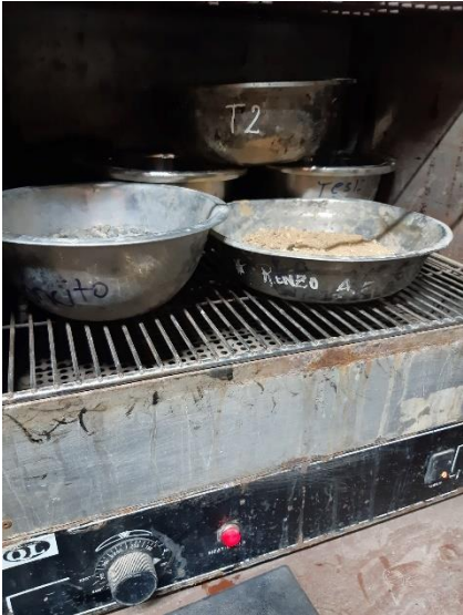
Fig. 43. Contenido de humedad del agregado grueso y fino
