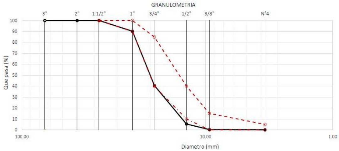
Fig. 8. Distribución de partículas del A. grueso de la cantera La Victoria - Pátapo
