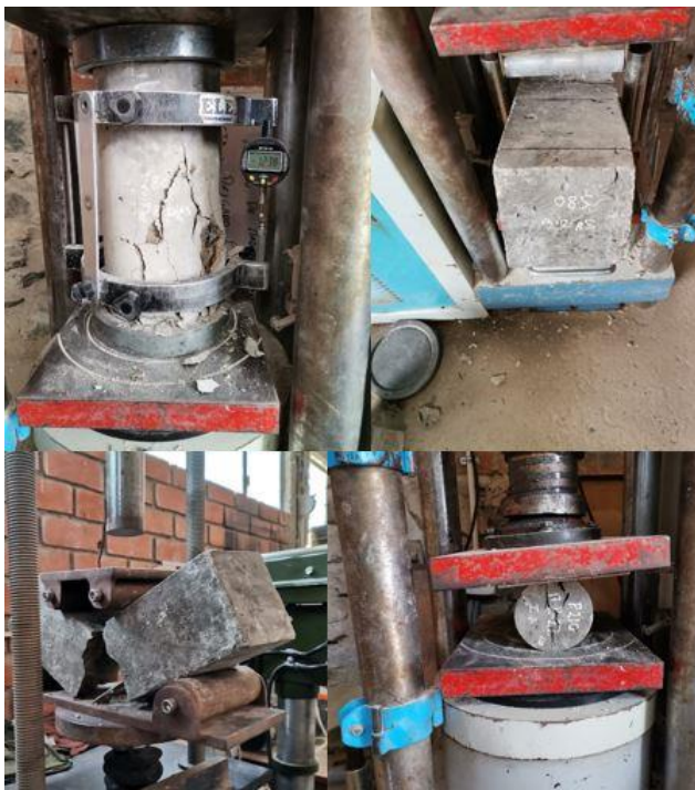
Fig. 54. Ensayos de resistencia a la compresión, flexión, tracción y módulo de elasticidad
