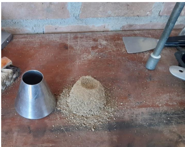
Fig. 40. Ensayo de consistencia del agregado fino
