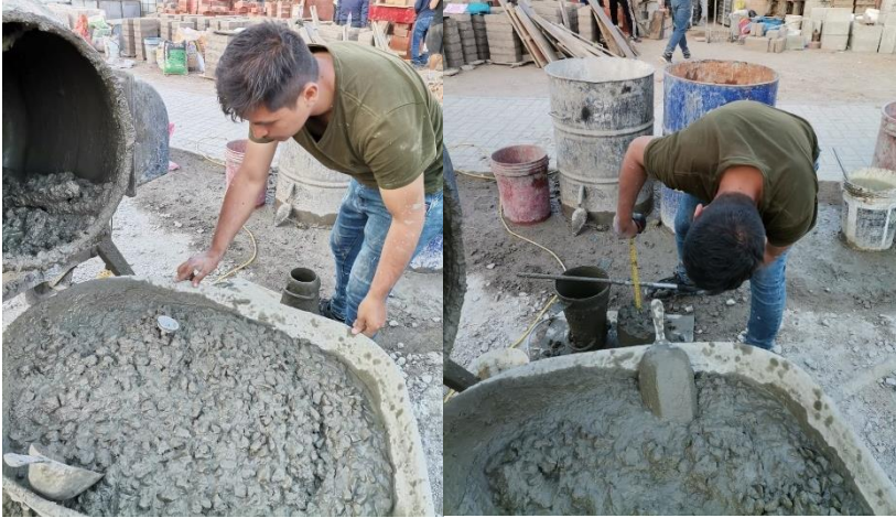
Fig. 47. Diseño de mezcla y asentamiento (Slump)
