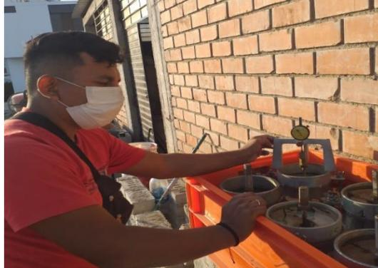
**Fig. 21.** Toma de medida con manómetro.
