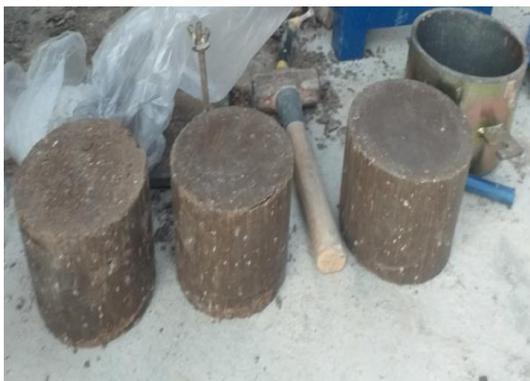
**Fig. 18.** Moldes terminados para extracción de muestra.
