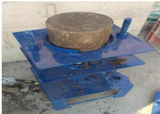
**Fig. 17.** Prensa hidráulica para retirar moldes.
