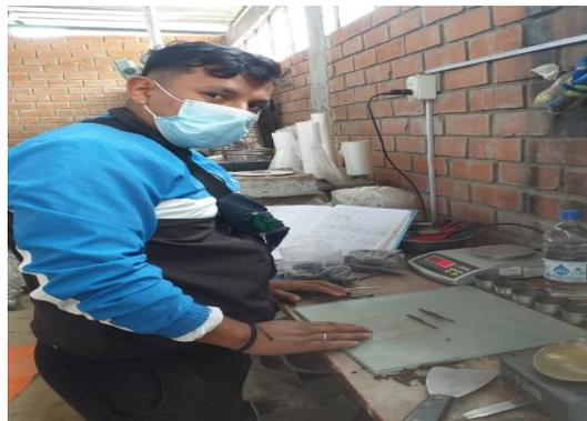
**Fig. 14.** Ensayo limite plástico.
