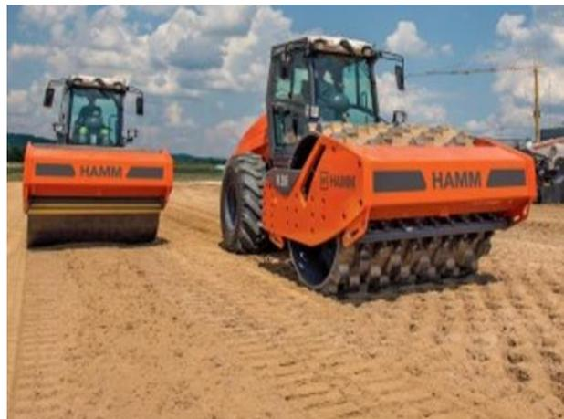
**Fig. 4.** Estabilización por compactación usando "pata de cabra" y "Rodillo tándem" [19].
