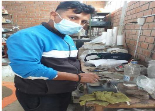
**Fig. 13.** Ensayo de límite líquido.
