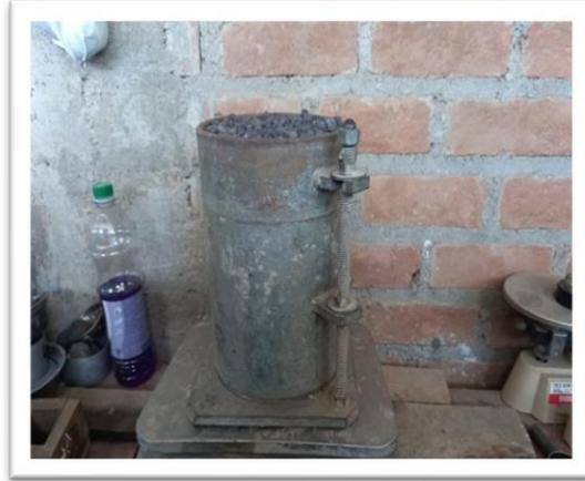
Nota: en esta figura se muestra el proceso del cuarteo de la escoria de acero, donde se calculará el peso del recipiente y de la muestra después de golpear 15 veces y del cuarteo.
