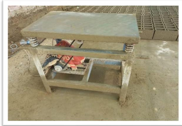
**La máquina vibradora para elaboración de ladrillo de concreto**
