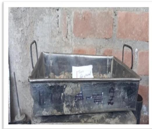
Salido del horno el peso seco con tara
