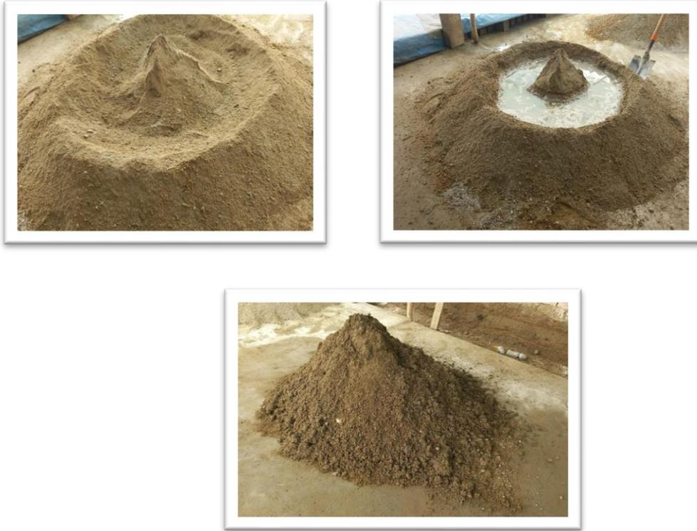
Nota: en esta figura podemos observar cómo el proceso final del mezclado cuando se le agrega agua, se le da 4 mezcla totales de diferentes direcciones hasta obtener una mezcla homogénea.
