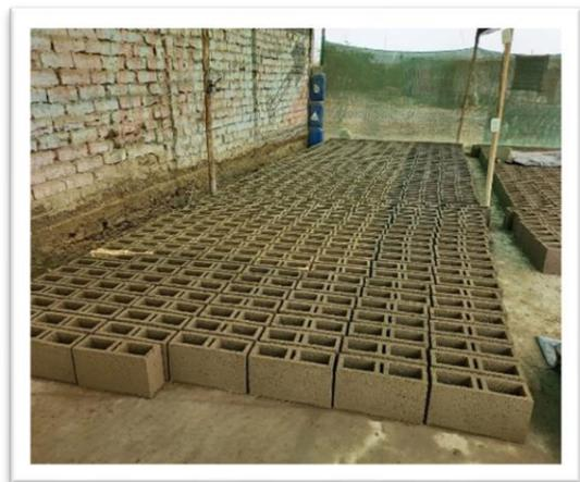
**Nota: en esta figura podemos observar la elaboración de los ladrillos con su porcentaje que se le añadió, utilizando un molde N°12 para luego esperar que seque y comenzar con las pruebas respectivas.**
