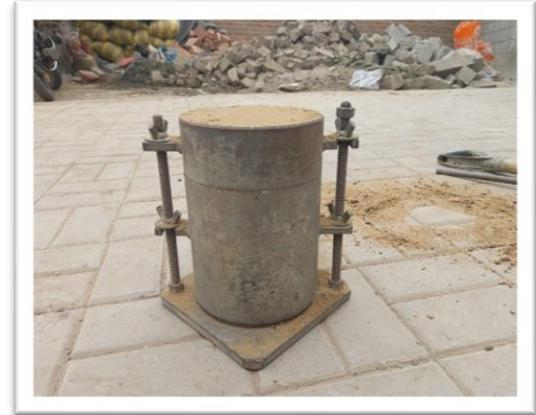
Nota: en esta figura se muestra el peso unitario compactado de la arena, cada uno de los procedimientos y procesos que se llevó a cabo para su elaboración y muestreo.
