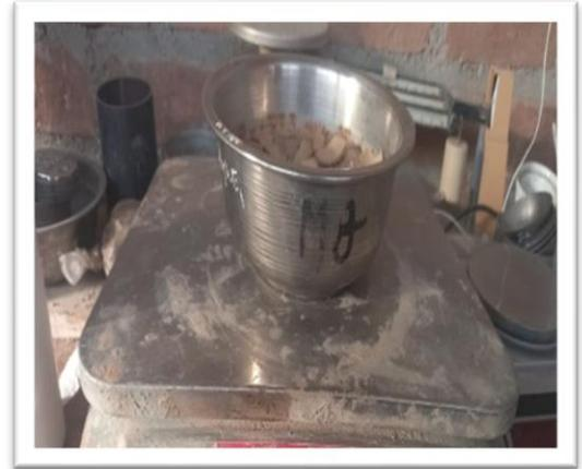
Nota: en esta figura se muestra el proceso del peso unitario suelto de la arena donde podemos realizar el peso de la tara y el recipiente, después se vuelve a ejecutar con el muestro después de haber sido colocado en el horno.
