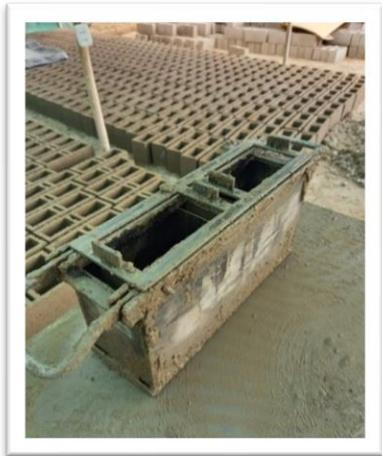
**Molde para la elaboración de ladrillo de concreto**
