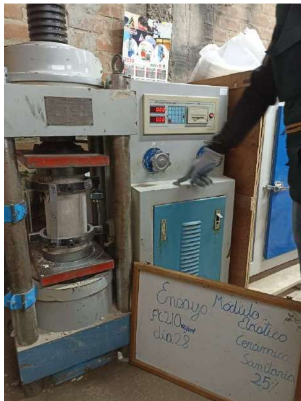
Fotografía 64 Módulo elástico CE25
