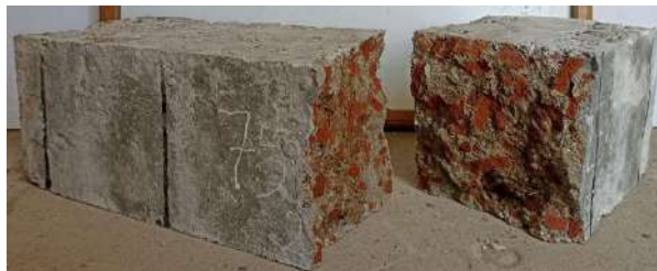
Fig. 16 Detalle interno del concreto con alto porcentaje de ladrillo
