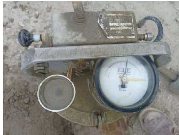
Fotografía 40 Ensayos de aire atrapado (3)
