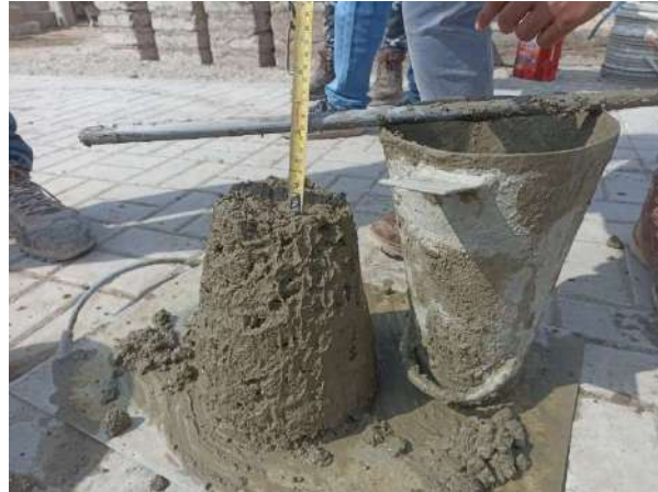
Fotografía 33 Ensayos de slump (5)
