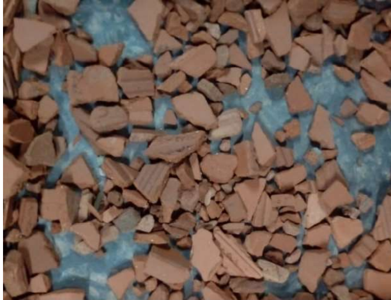
Fig. 1 Fragmentos de cerámica de ladrillo de arcilla roja
