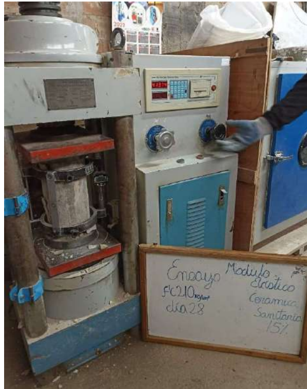
Fotografía 63 Módulo elástico CE15
