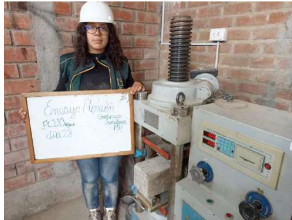
Fotografía 48 Colocación de las probetas en la prensa (4)
