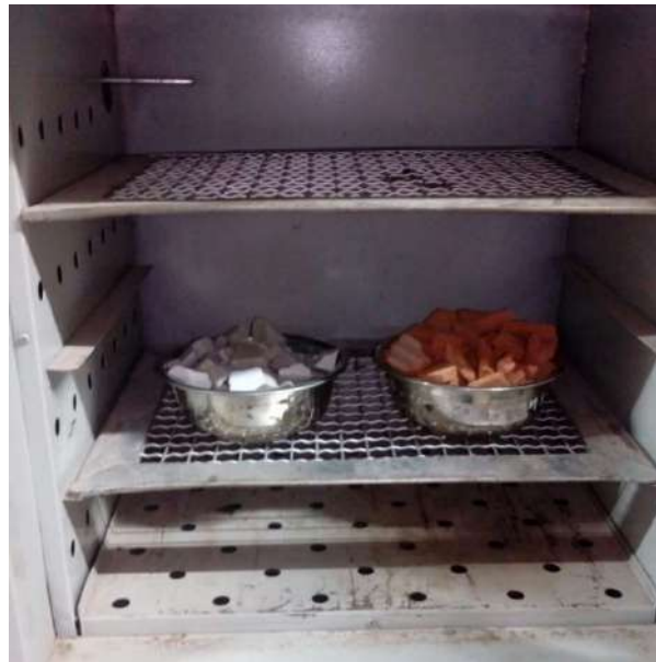
Fotografía 14 Horneado agregados cerámicos
