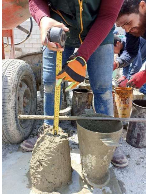
Fotografía 31 Ensayos de slump (3)
