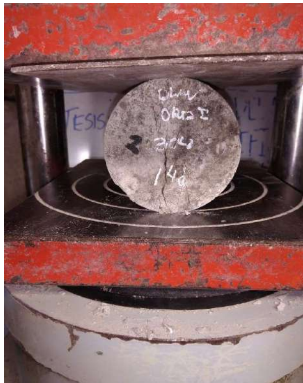
Fotografía 55 Ensayo tracción La30
