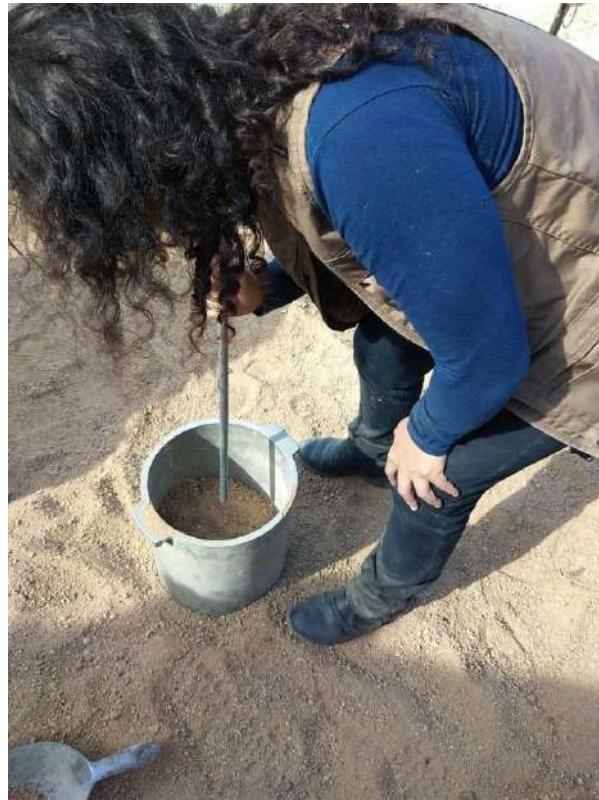
Fotografía 6 Compactación peso unitario
