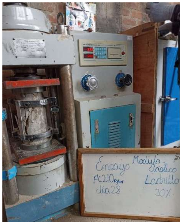
Fotografía 59 Módulo elástico LA20
