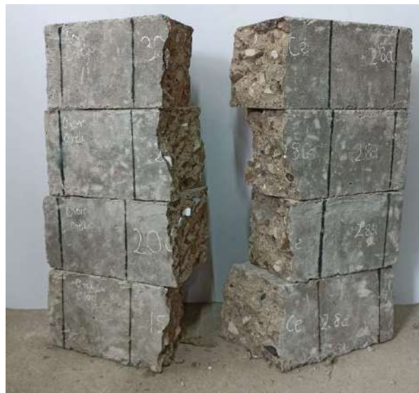
Fotografía 101 Probetas a flexión 15% al 30% de reemplazo por cerámica sanitaria
