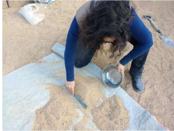
Fotografía 1 Cuarteo del agregado fino
