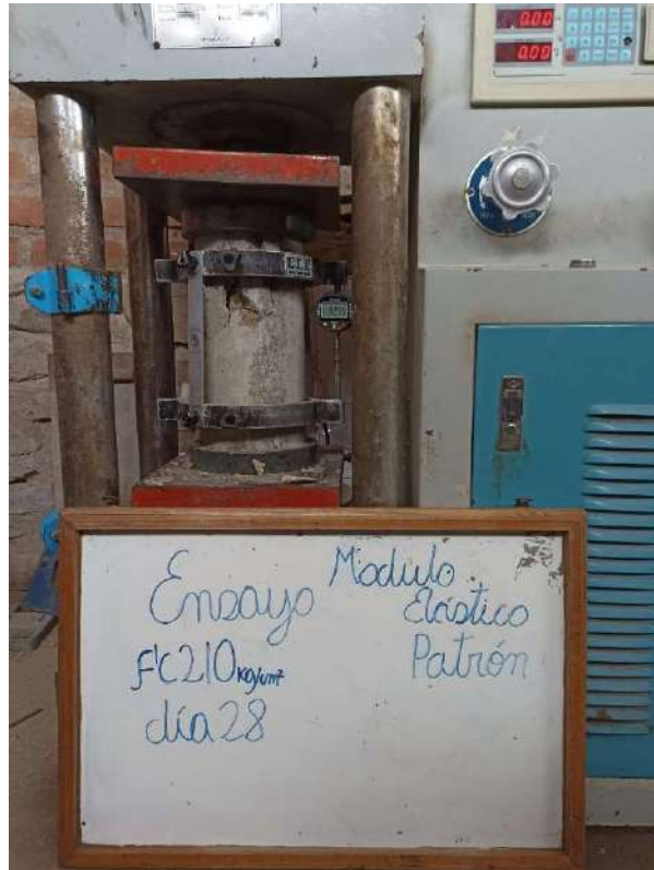
Fotografía 57 Módulo elástico patrón
