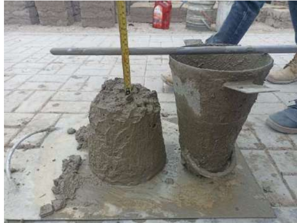
Fotografía 29 Ensayos de slump (1)
