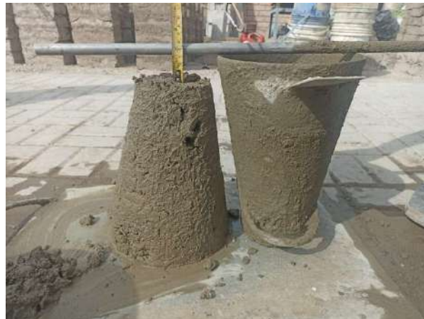
Fotografía 34 Ensayos de slump (6)
