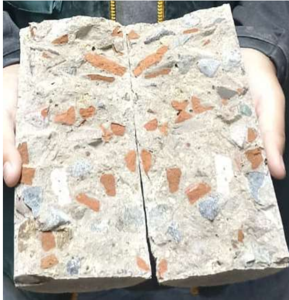
Fig. 33 Detalle de la rotura del concreto con ladrillo de arcilla roja
