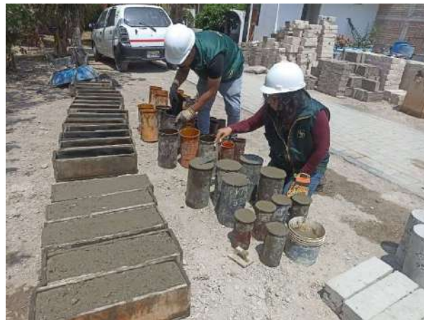
Fotografía 27 Vaciado de mezclas (5)
