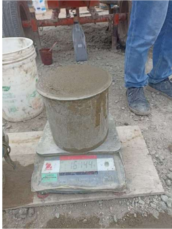
Fotografía 43 Ensayos de peso unitario (3)
