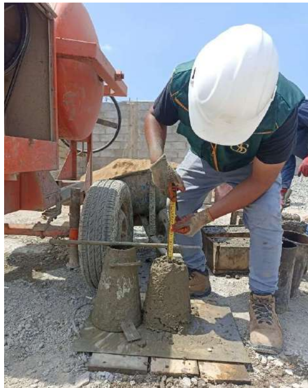
Fotografía 32 Ensayos de slump (4)
