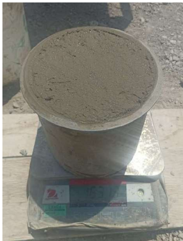
Fotografía 42 Ensayos de peso unitario (2)
