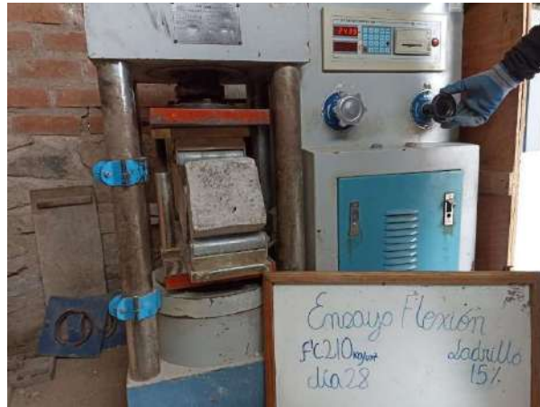
Fotografía 52 Ensayo flexión La15
