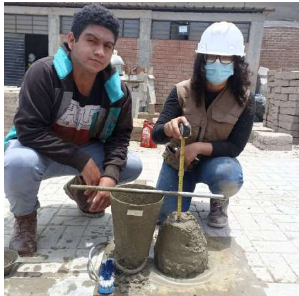
Fotografía 30 Ensayos de slump (2)
