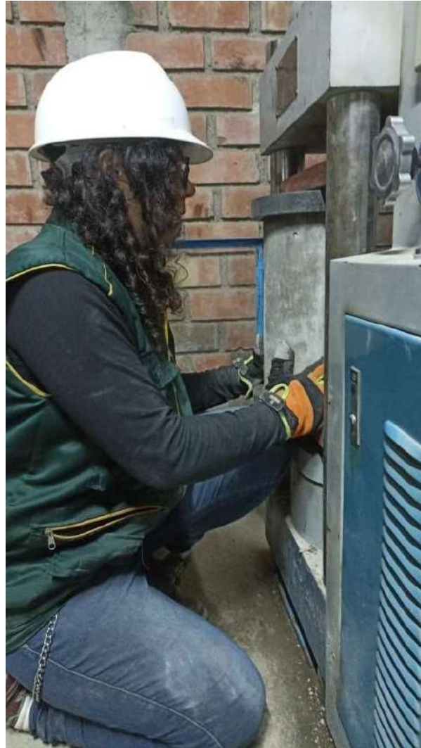
Fotografía 45 Colocación de las probetas en la prensa (1)
