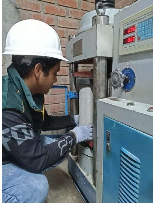
Fotografía 46 Colocación de las probetas en la prensa (2)
