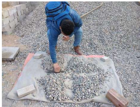
Fotografía 2 Cuarteo del agregado grueso
