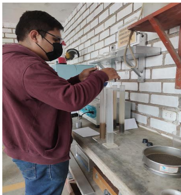
Figura 6. Equivalente de arena.
