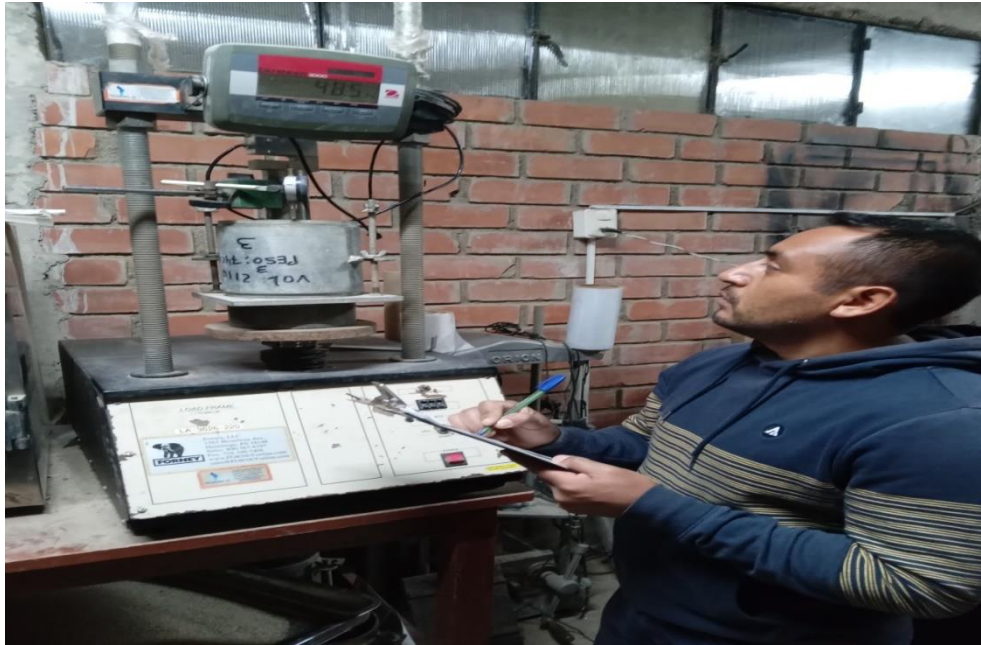
Fotografía 35 Ensayo de CBR en una muestra de suelo natural.
