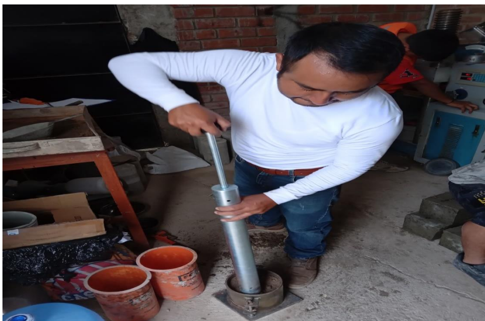
Fotografía 32 Ensayo de Proctor modificado.
