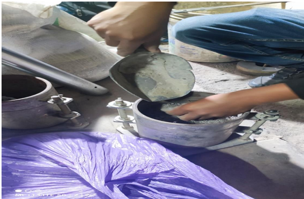
Fotografía 40 Llenado de molde de CBR con la muestra.
