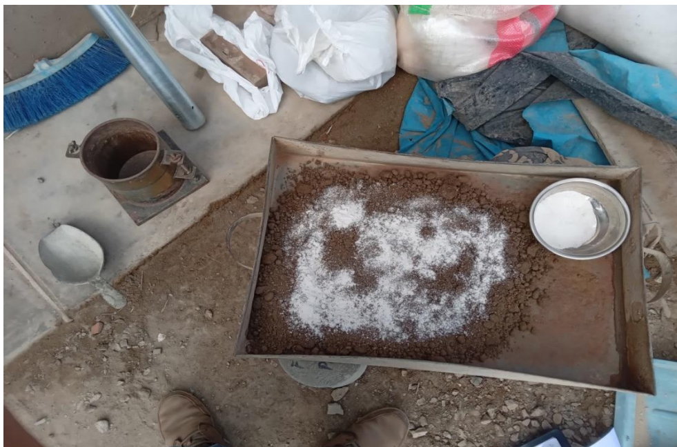
Fotografía 34 Combinación de suelo natural con yeso reciclado.
