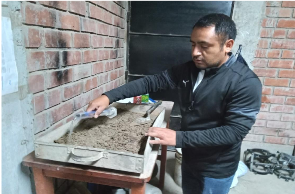
Fotografía 31 Saturación del material para ensayo de proctor modificado.
