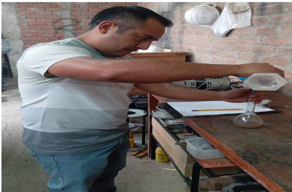
Fotografía 28 Análisis de peso específico.
