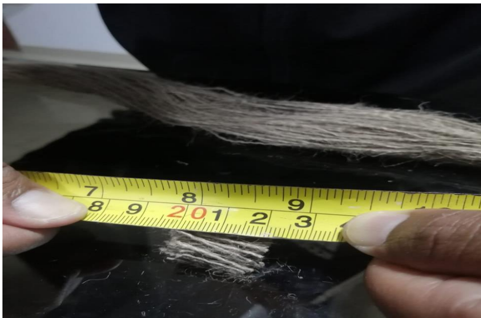
Fotografía 2 Corte de las fibras de yute.
