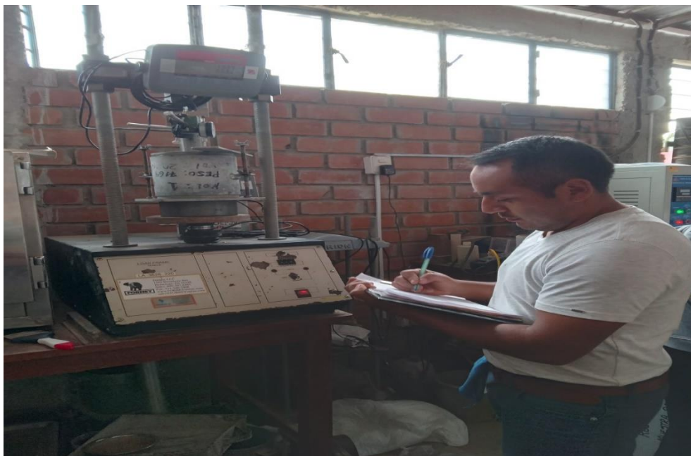
Fotografía 42 Ensayo de CBR en un suelo con adición de yeso reciclado y fibras.
