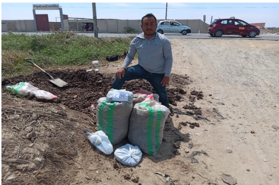
Fotografía 20 Muestras extraídas de la Calicata 6.
