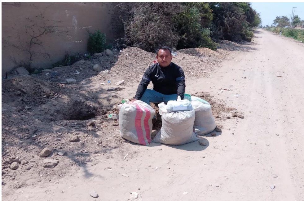
Fotografía 8 Muestras extraídas de la Calicata 1.
