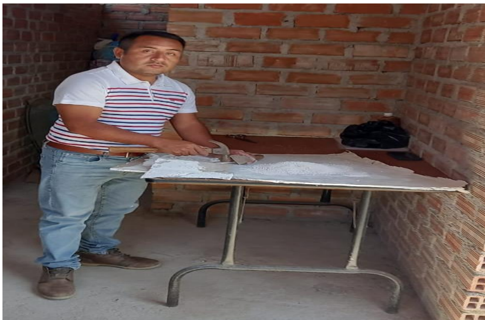
Fotografía 4 Pulverizado de las planchas de yeso reciclado.
