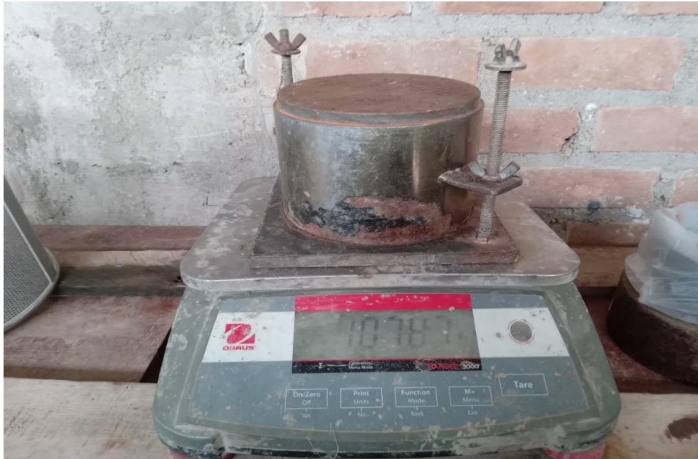
Fotografía 33 Pesaje de la muestra.
