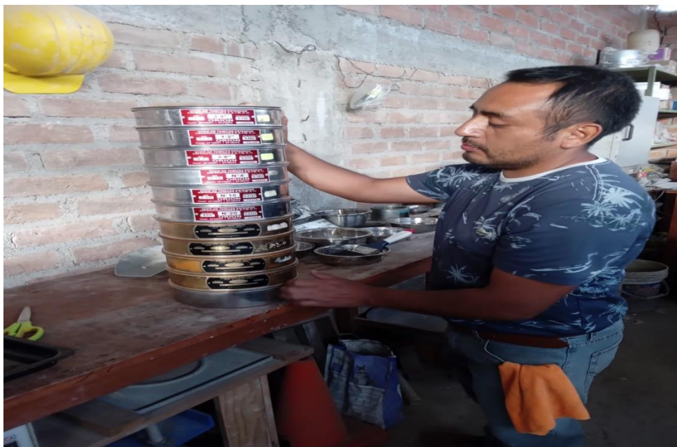
Fotografía 24 Ensayo de granulometría.
