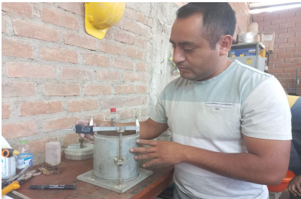
Fotografía 30 Calibración de moldes para ensayo CBR.
