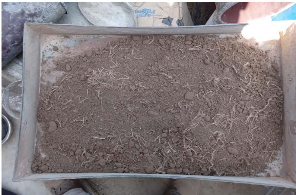
Fotografía 36 Combinación de suelo natural con fibras de yute.
