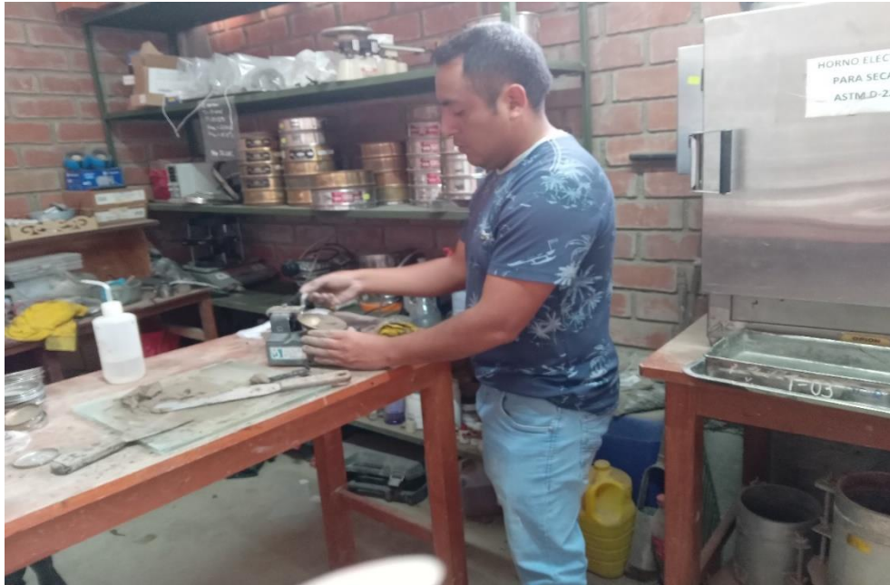
Fotografía 25 Ensayo de límite líquido.
