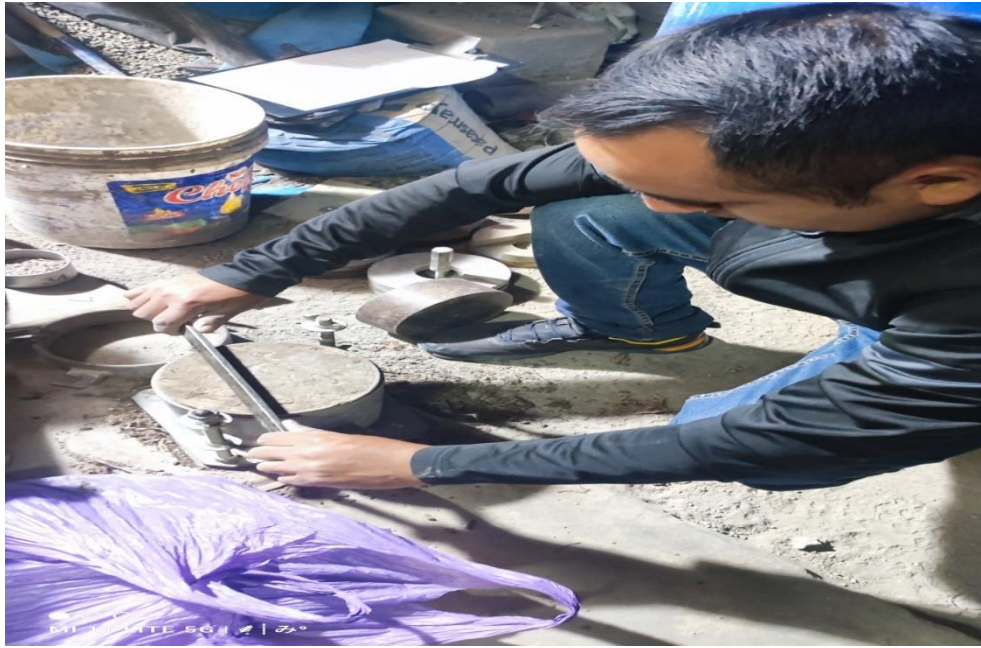
Fotografía 41 Enrasado de molde para realizar el pesado.
