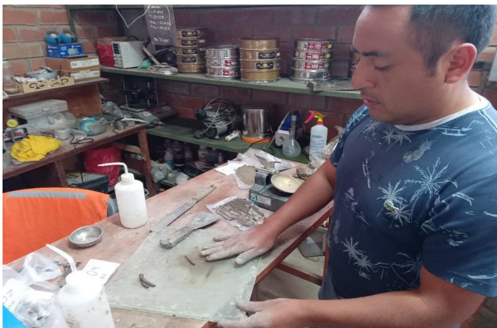
Fotografía 26 Ensayo de límite plástico.
