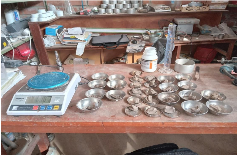
Fotografía 27 Muestras secas para los ensayos de límite líquido y plástico.
