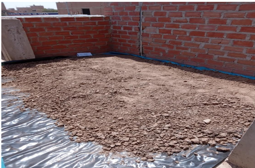
Fotografía 21 Secado de las muestras extraídas.
