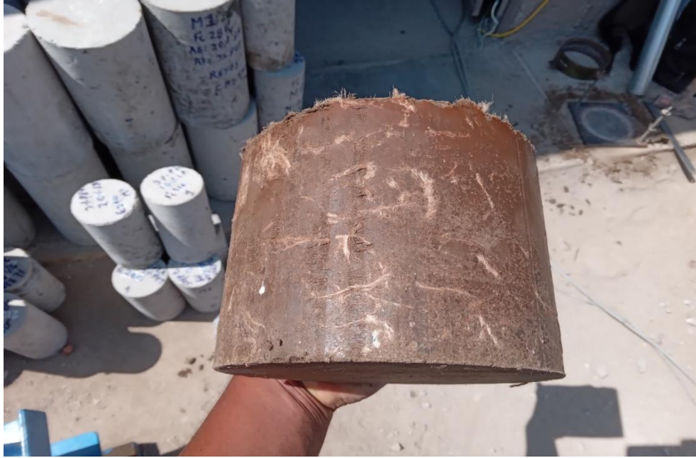
Fotografía 37 Ejemplar de una muestra de suelo con la adición de fibras de yute.
