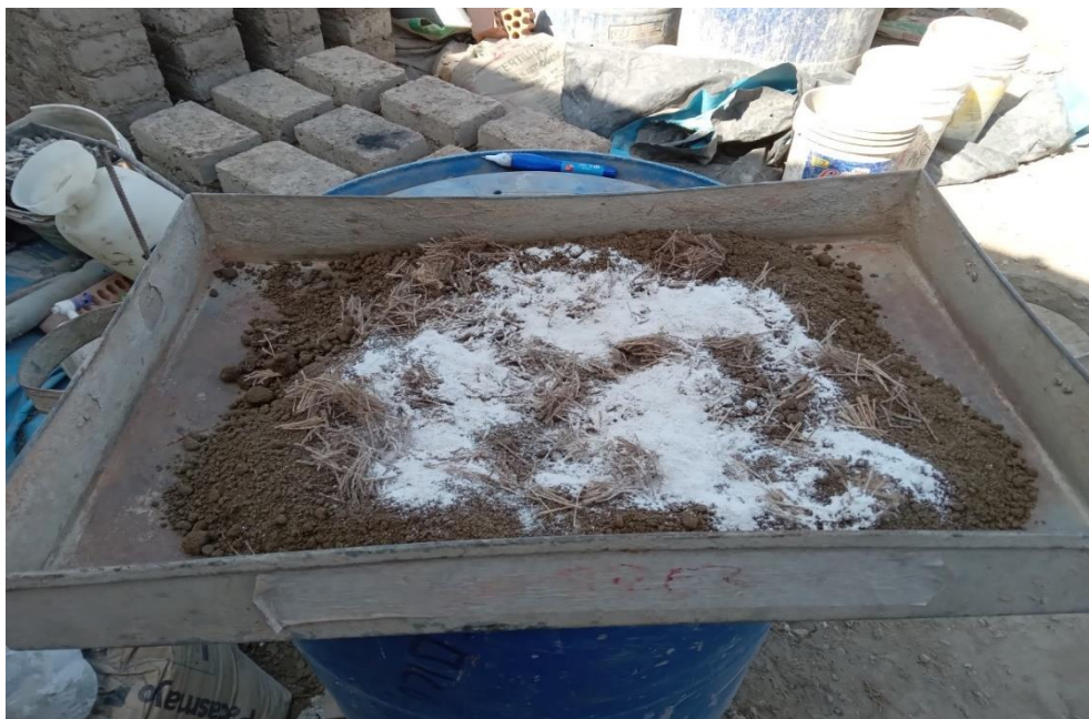
Fotografía 38 Combinación de yeso reciclado y fibras de yute a una muestra de suelo natural.
