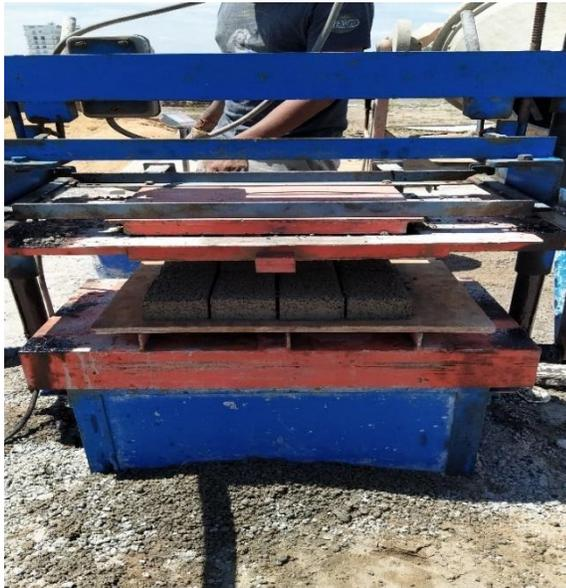
**Ilustración 9:** Proceso de elaboración y diseño de los adoquines de concreto
