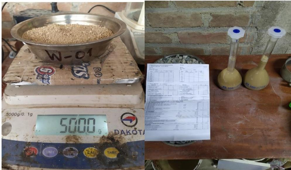
**Ilustración 6:** Contenido de humedad, peso específico y absorción.
