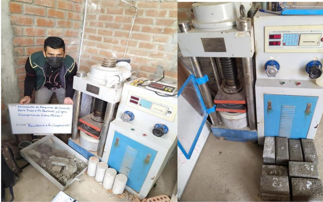
Ilustración 13: Ensayo resistencia a la compresión
