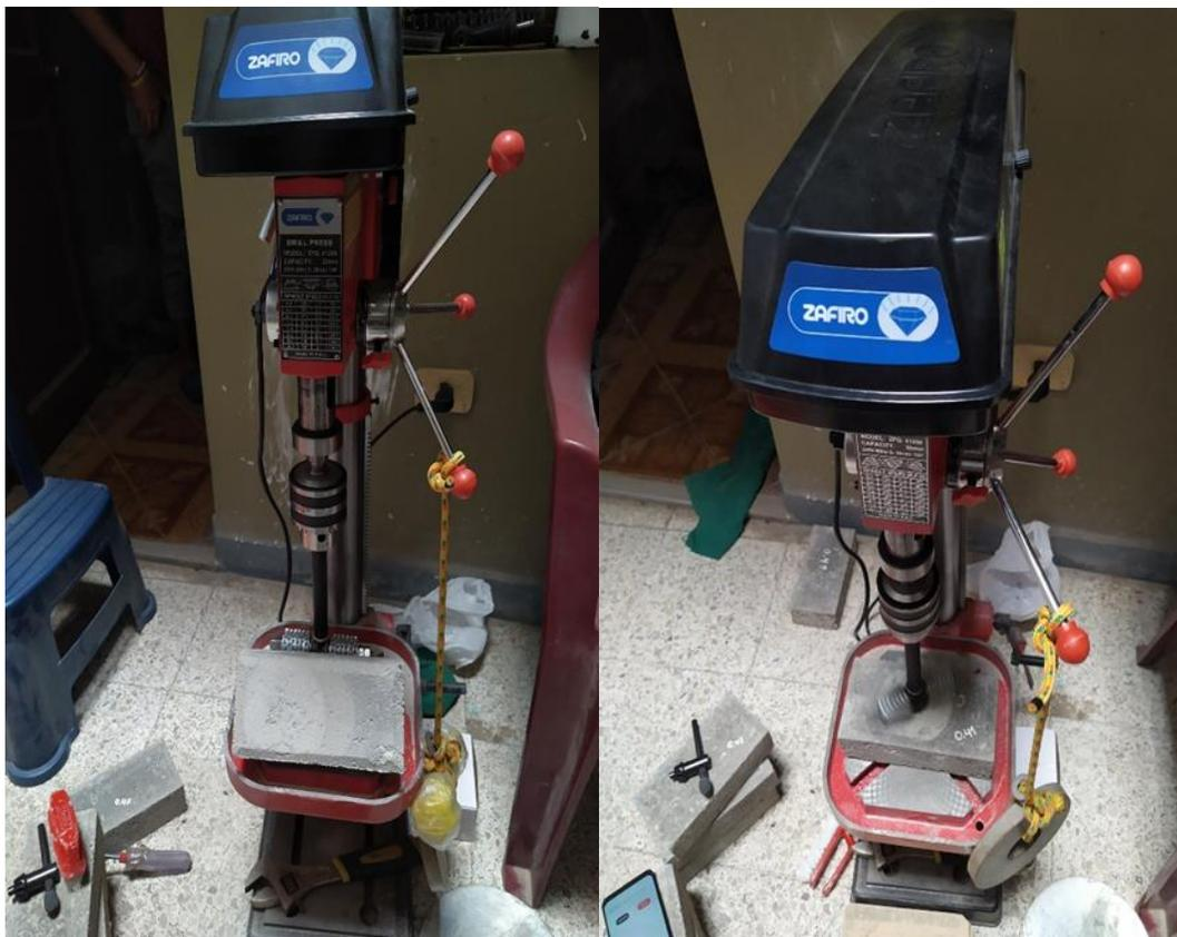
**Fig.18.** Abrasión del concreto mediante el ensayo del rodillo giratorio – adoquines de concreto.
