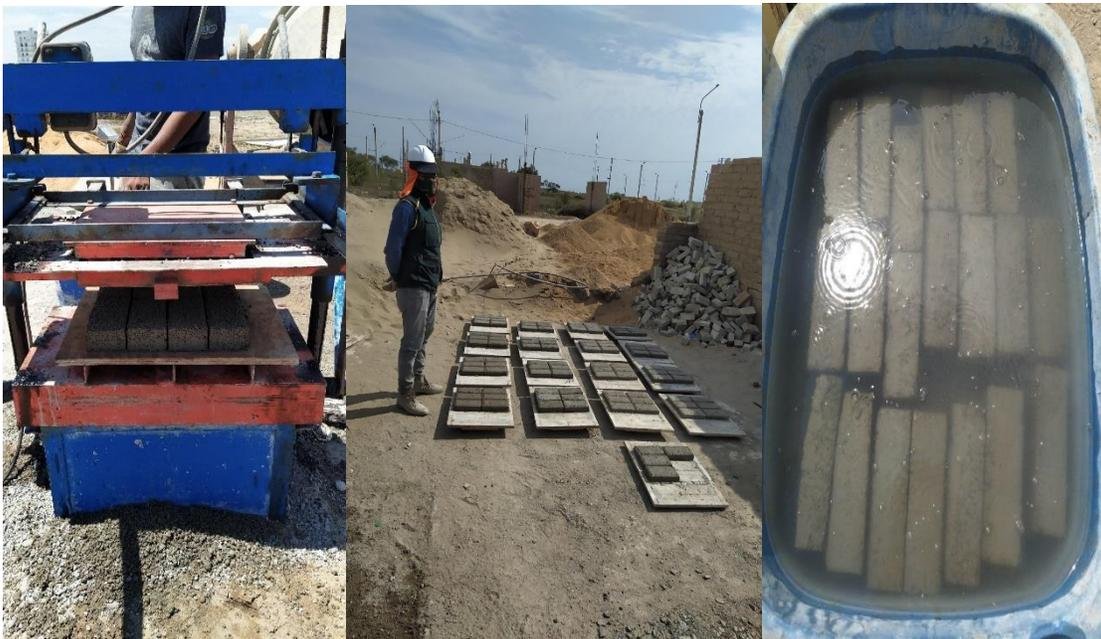
**Fig.12.** Proceso de elaboración, secado y curado del adoquín de concreto
