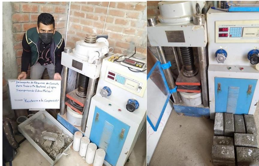
**Fig.14.** Resistencia a la compresión de adoquines de concreto.
