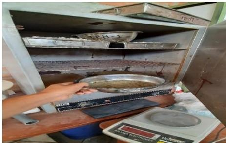
**Fig.10.** Contenido de humedad del vidrio molido
