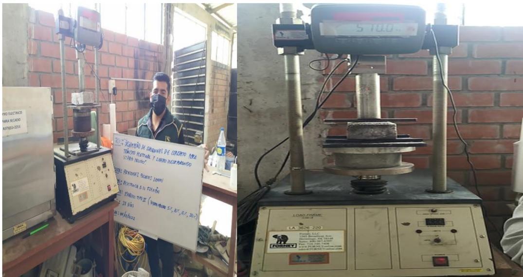
Ilustración 14: Ensayo resistencia a la flexión
