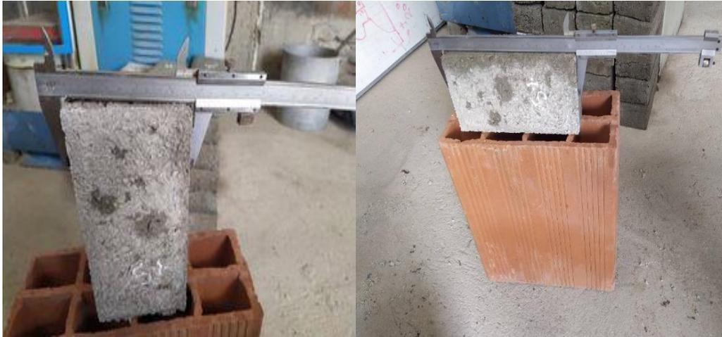
**Ilustración 11:** Ensayo de variación dimensional
