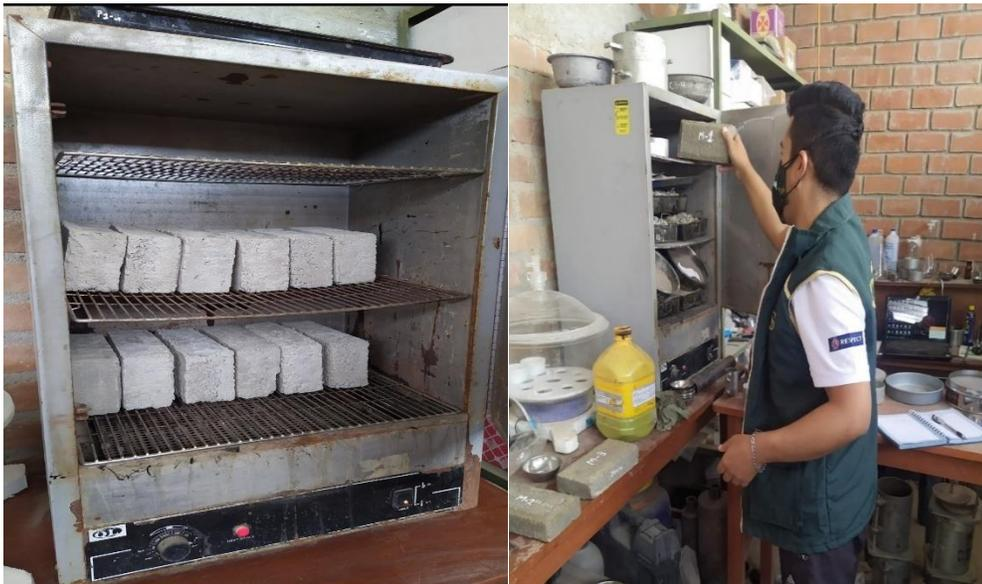
**Ilustración 12:** Ensayo de densidad y absorción
