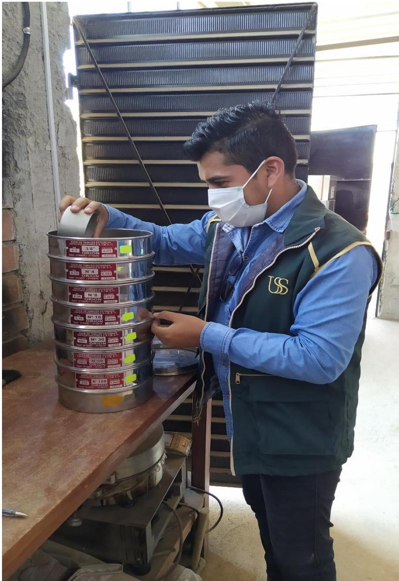
**Fig.6.** Análisis granulométrico del agregado fino y del vidrio molido.
