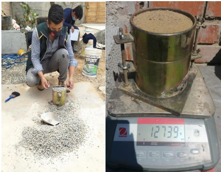
**Fig.7.** P.U.S y P.U.C del agregado grueso (AG) y fino (AF).
