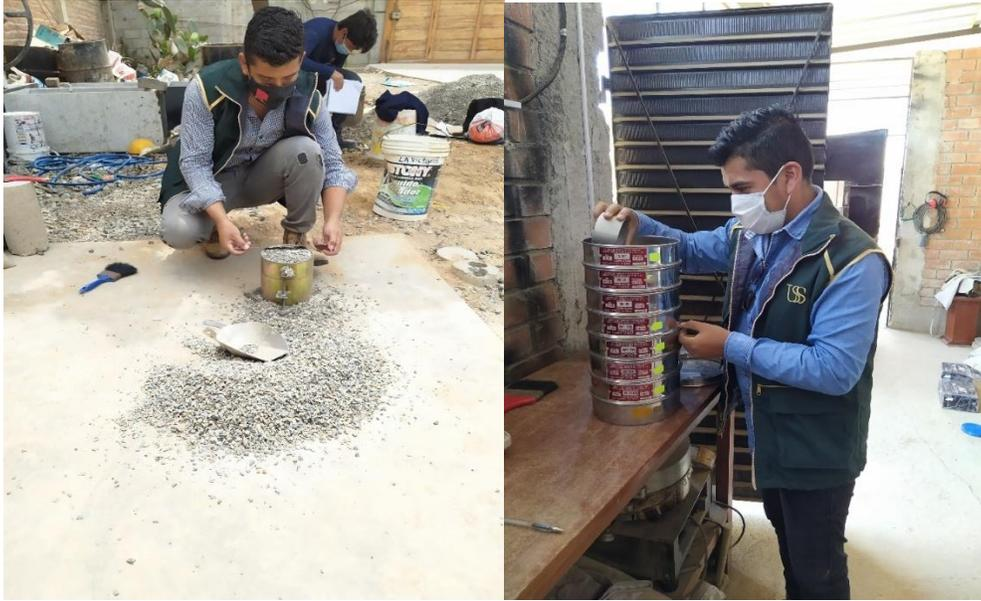
**Ilustración 5:** Granulometría, peso unitario suelto y compactado
