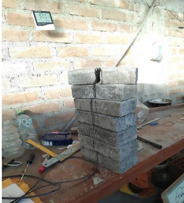
**Ilustración 15:** Muestras de adoquín ensayo a la resistencia a la flexión
