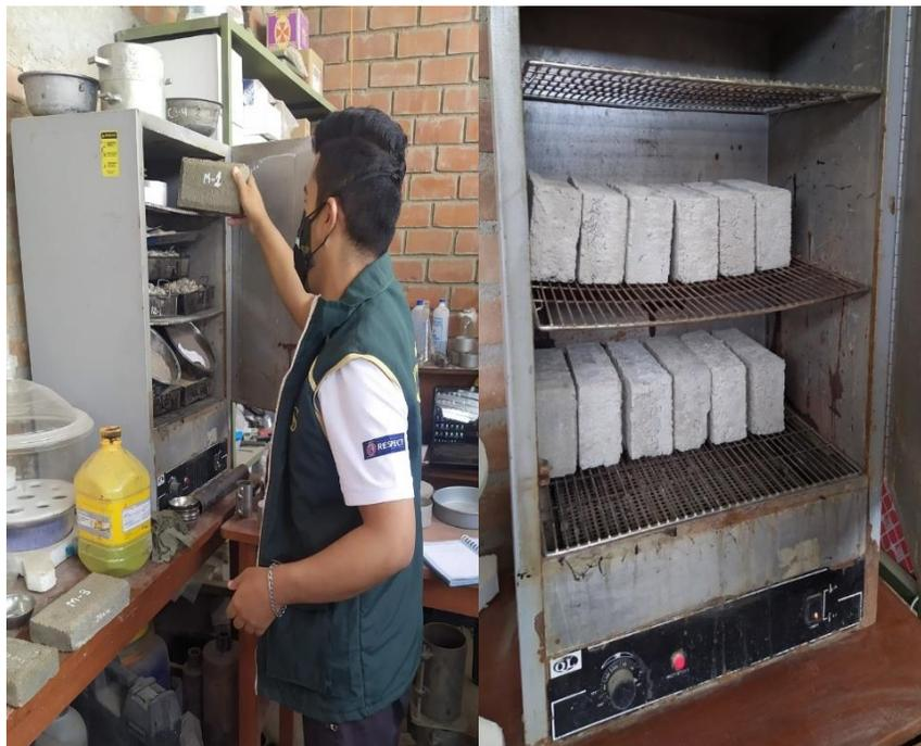
**Fig.17.** Absorción de adoquines de concreto.
