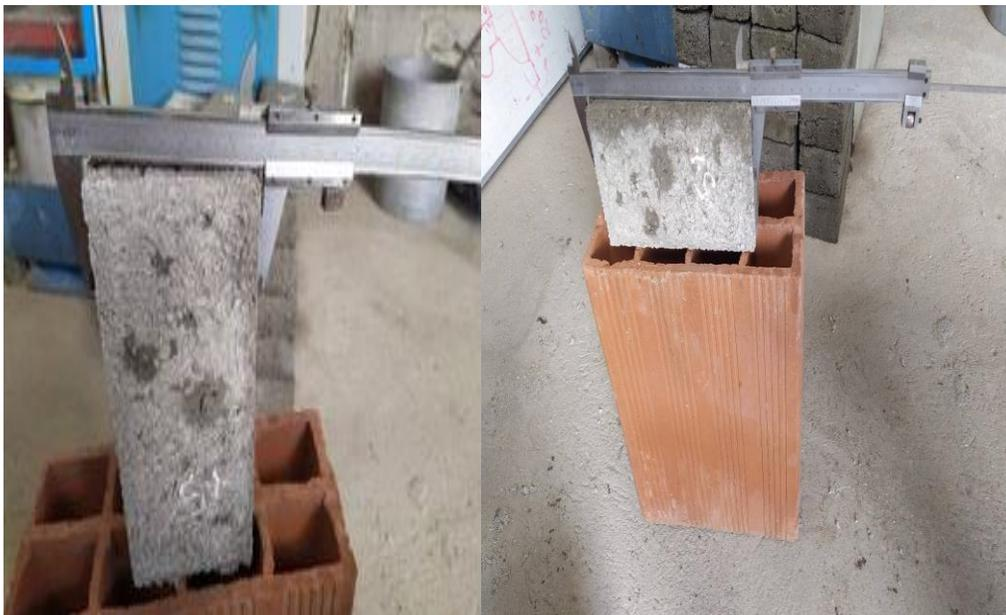
**Fig.13.** Variación dimensional de adoquines de concreto.
