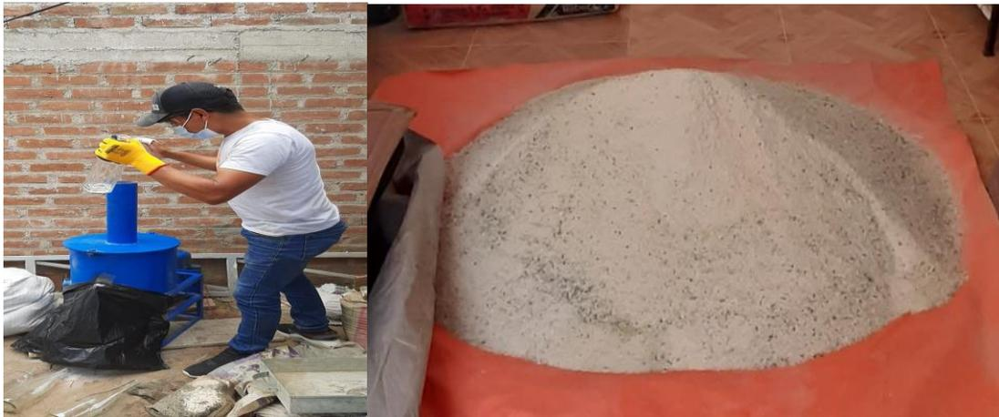
**Fig.5.** Proceso de demolición del vidrio molido
