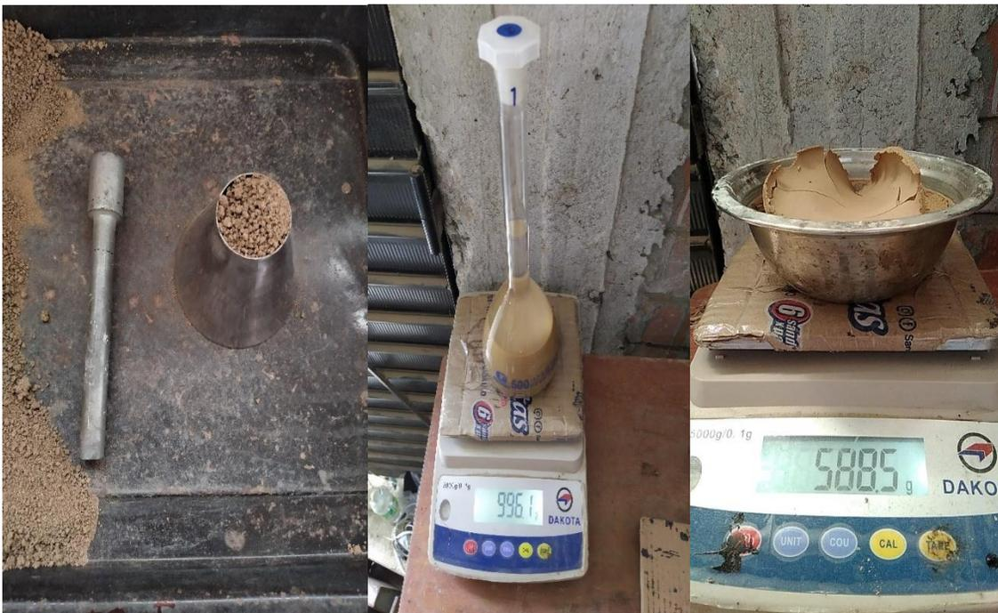
**Fig.11.** Peso específico y absorción de la arena gruesa.
