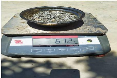
**Fig.8.** Contenido de humedad del AG
