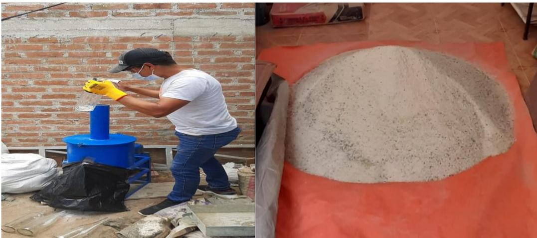
**Ilustración 8:** Proceso de demolición del vidrio
