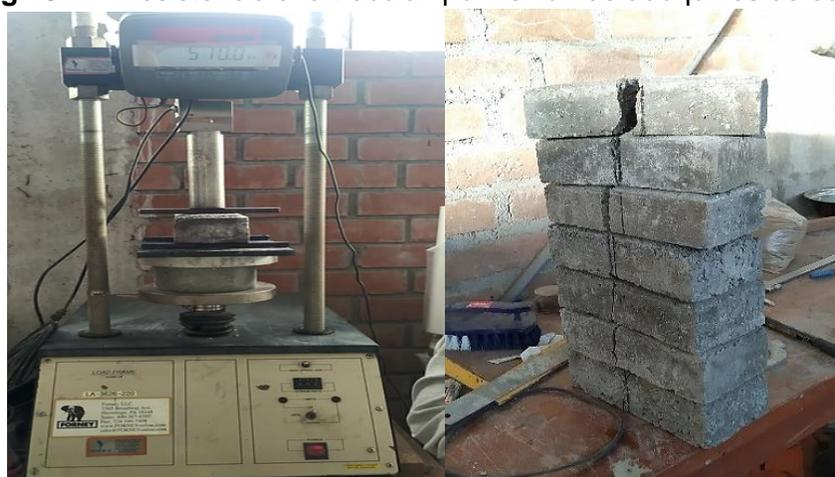
**Fig.16.** Resistencia a la tracción y fracturas por flexión de adoquines de concreto.
