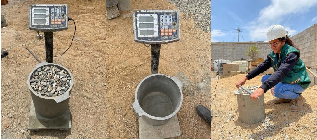
Ilustración 23: Ensayo de peso unitario suelto y compactado del agregado grueso
