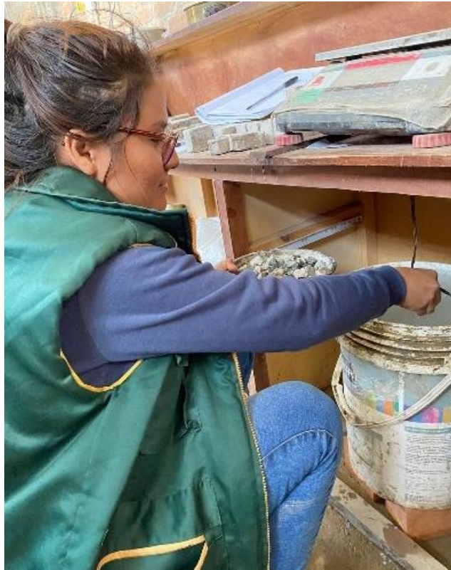
Fig. 16. Peso del balde más el peso de la muestra para el ensayo de peso específico de material grueso.
