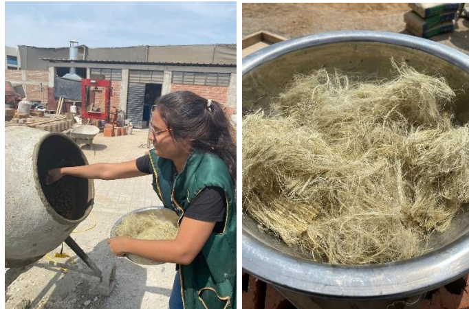
Ilustración 33: Mezcla de concreto adicionando fibra de hoja de piña.
