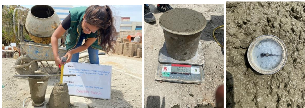
Ilustración 32: Ensayo de concreto fresco del concreto patrón.
