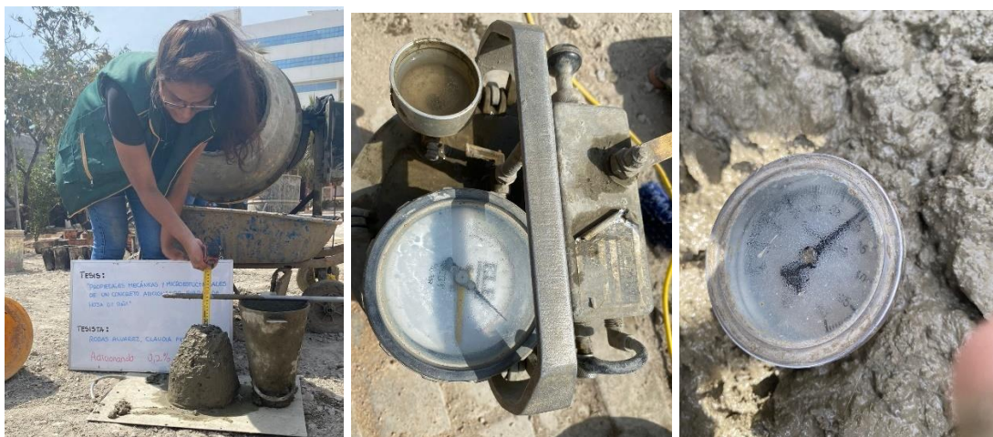
Ilustración 35: Ensayo de concreto fresco adicionando fibra de hoja de piña.
