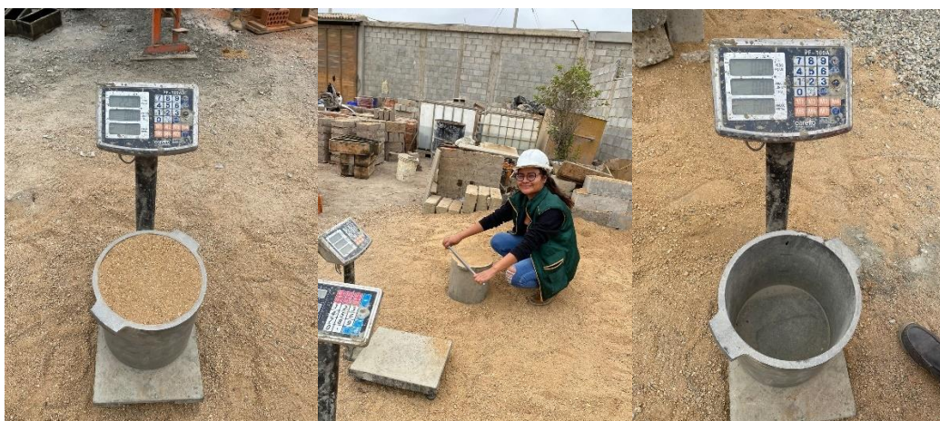
Ilustración 29: Ensayo de peso unitario suelto y compactado del agregado fino
