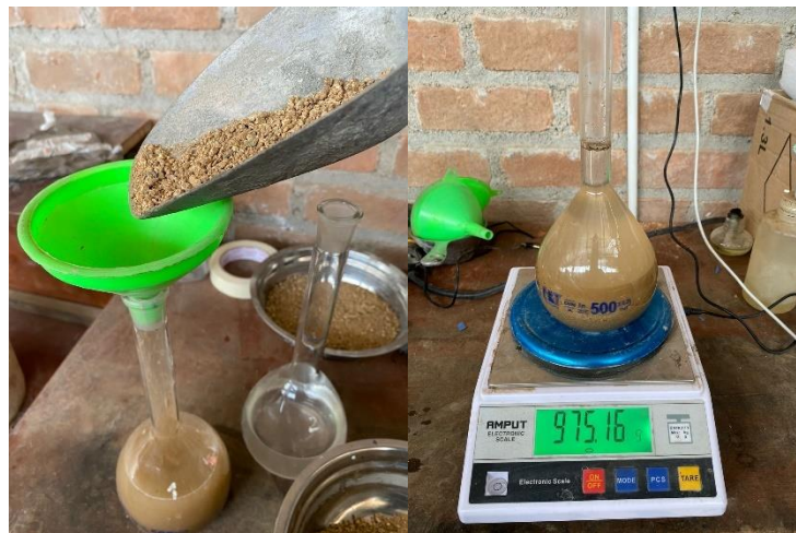
Ilustración 28: Ensayo de Peso Específico y Absorción del agregado fino
