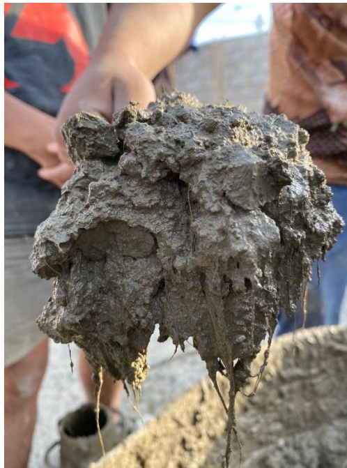
Ilustración 34: Matriz de concreto adicionando fibra de hoja de piña.
