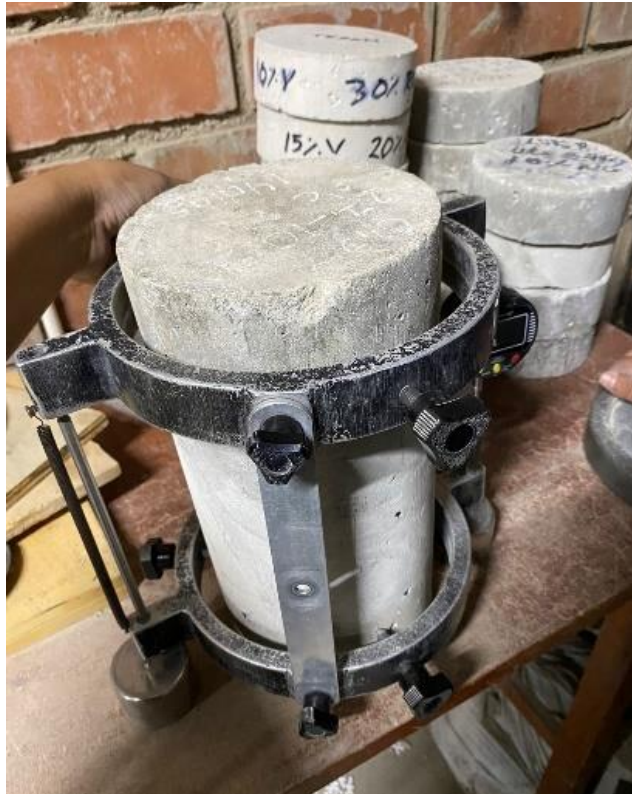
Fig. 28. Probeta con el compresometro para ser sometido al ensayo de módulo de elasticidad del concreto.
