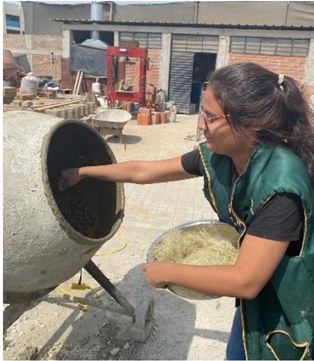
Fig. 20. Elaboración en trompo de mezcla de concreto con incorporación de FHP.
