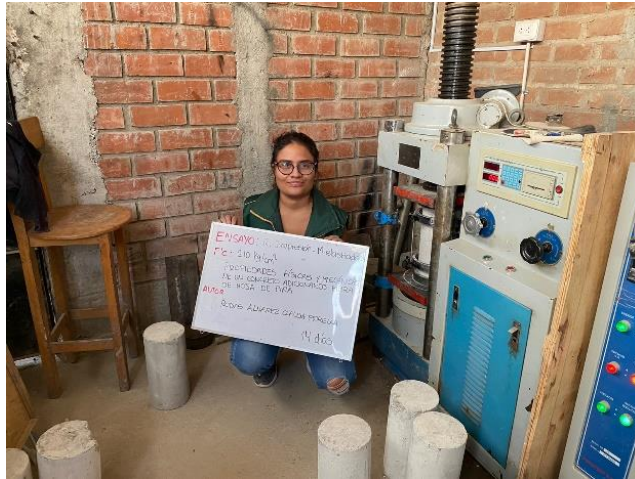
Fig. 25. Medición de ensayo de resistencia a la compresión a 28 días de curado.
