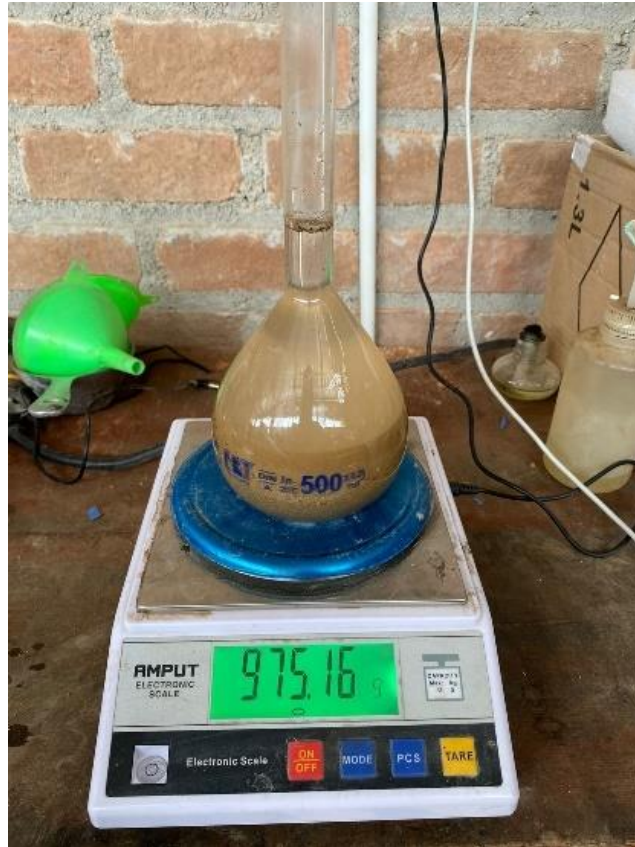
Fig. 17. Peso de la fiola, más el agua y la arena para el ensayo de peso específico.
