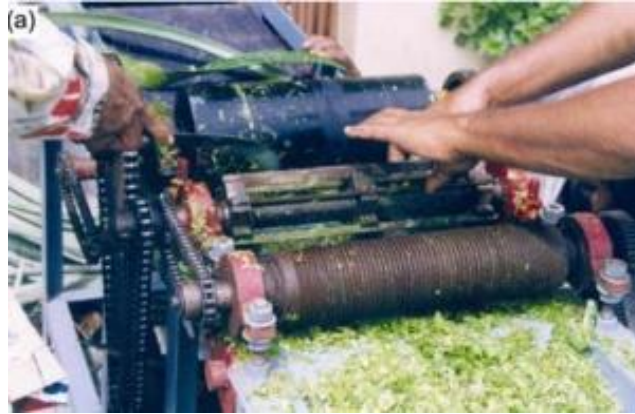
Fig. 4. Máquina de raspado para obtención de fibra de hoja de piña. [46]
