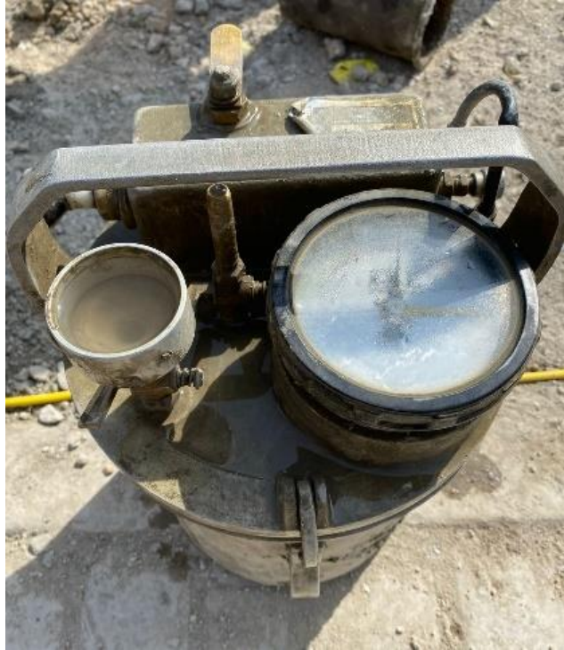
Fig. 24. Proceso para la medición de contenido de aire del concreto en estado fresco.
