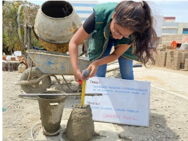
Fig. 21. Procedimiento para la determinar el asentamiento del concreto.
