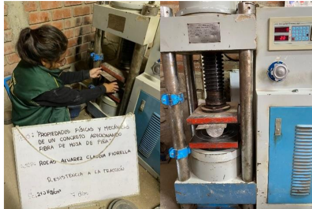
Fig. 26. Medición de ensayo de resistencia a la tracción del concreto.
