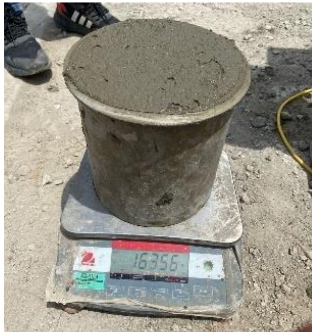
Fig. 23. Proceso de medición para el peso unitario del concreto.
