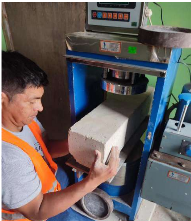
Fig. 20 Medición de viga para ensayo de resistencia a la flexión
