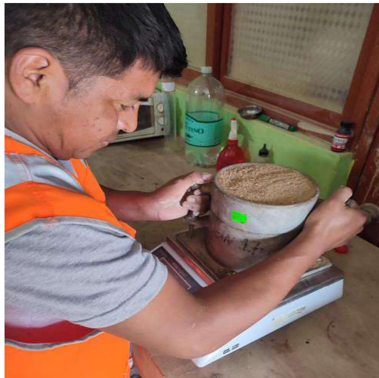
Fotografía 4. Ensayo de Peso unitario del agregado fino
