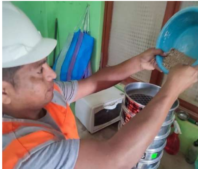
Fig. 5 Tesista realizando el análisis granulométrico del agregado fino
