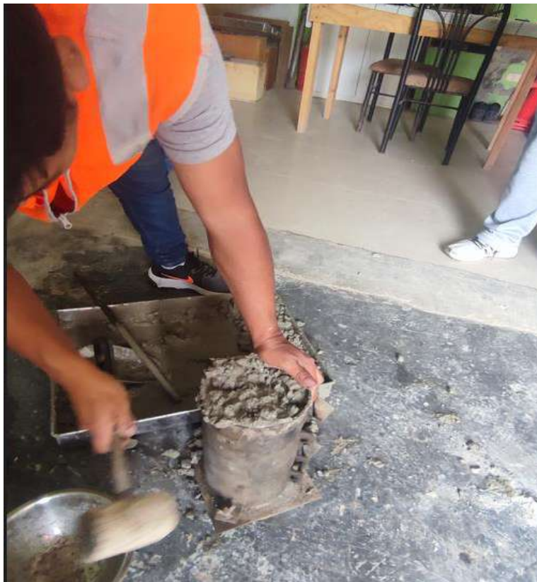
Fotografía 12. Vaciado de moldes cilíndricos para ensayos de compresión.
