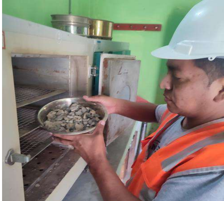
Fotografía 5. Secado del agregado grueso para determinar el contenido de humedad.
