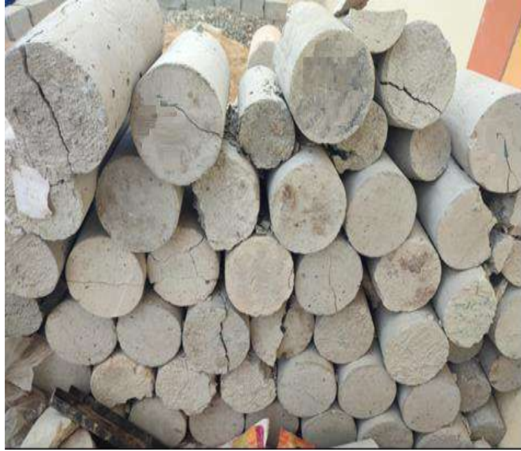
Fotografía 21. Probetas tras ser sometidas a ensayos de compresión y tracción.
