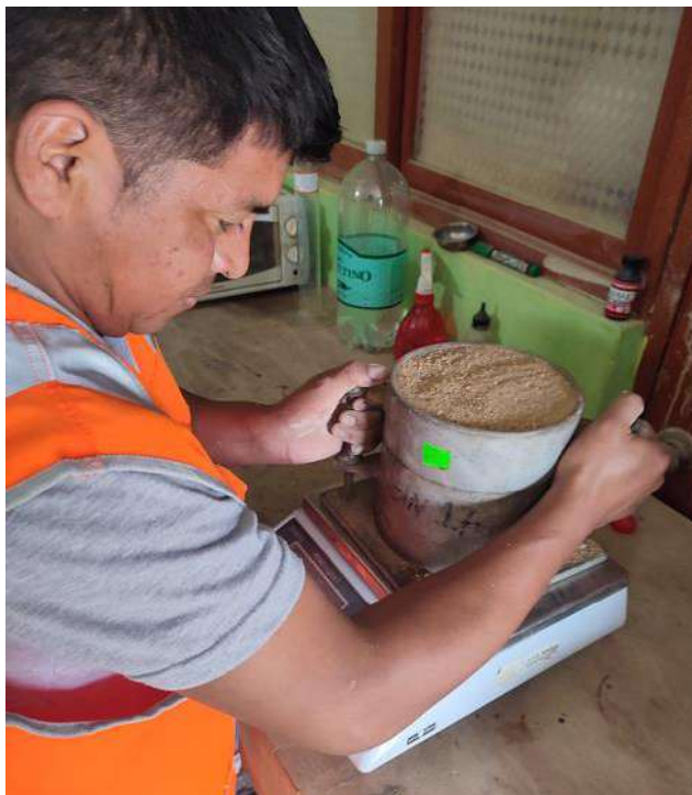
Fig. 9 Ensayo de Peso unitario del agregado fino.
