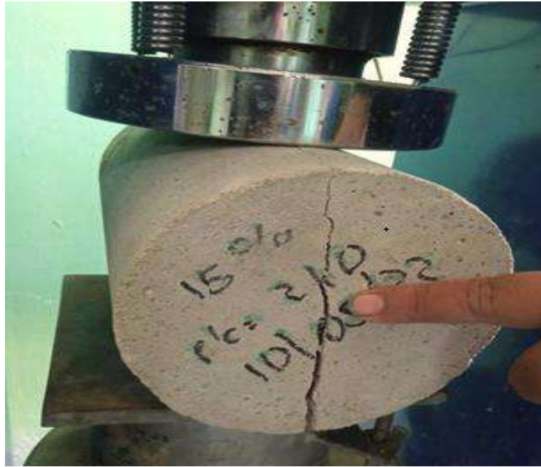
Fotografía 19. Rotura de probetas en el Ensayo de Tracción.
