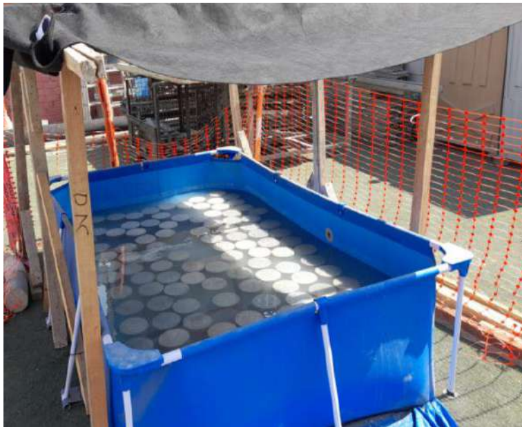
Fotografía 14. Curado de Probetas cilíndricas.
