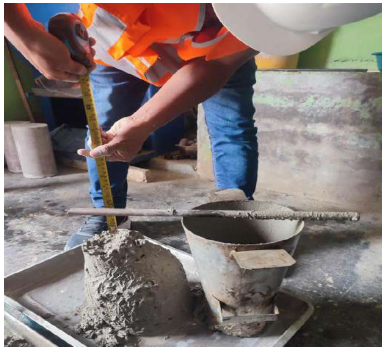
Fotografía 10. Ensayo de Asentamiento
