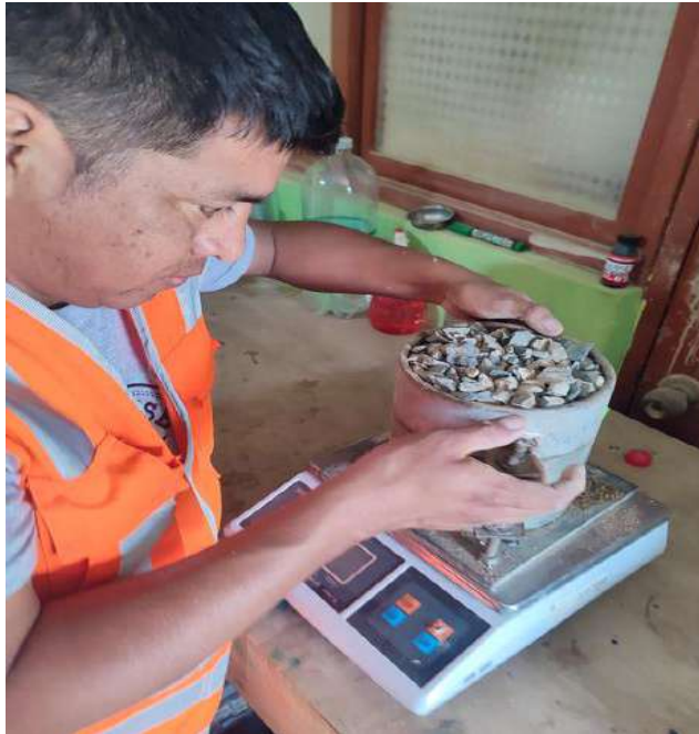
Fig. 8 Ensayo de Peso unitario del agregado grueso.
