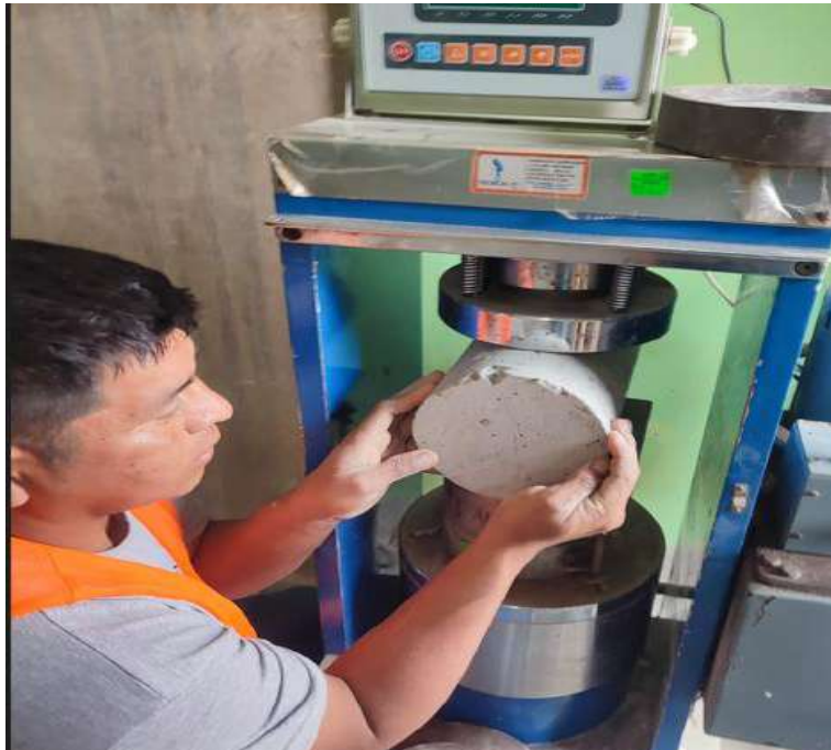
Fotografía 19. Colocación de probeta en máquina para Ensayo de Tracción.
