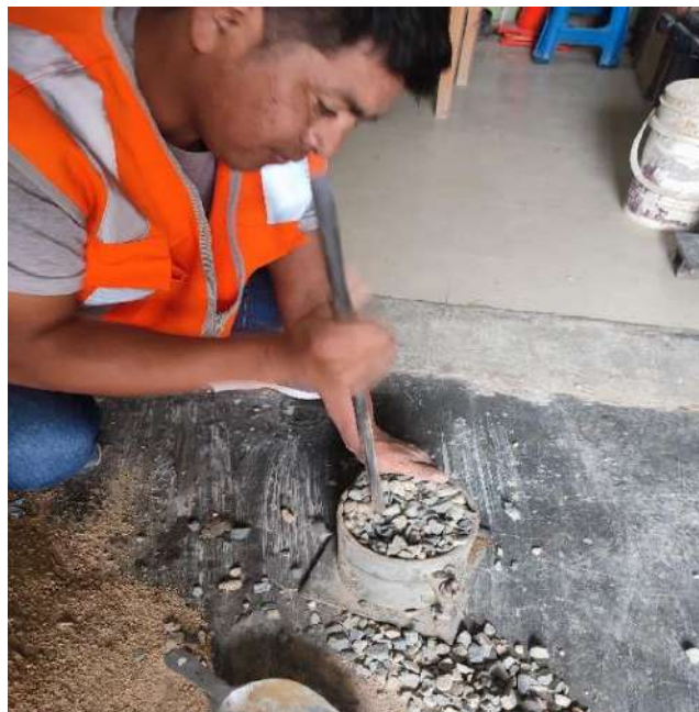
Fig. 11 Peso unitario compactado del agregado grueso Nota: Realizado en el laboratorio
