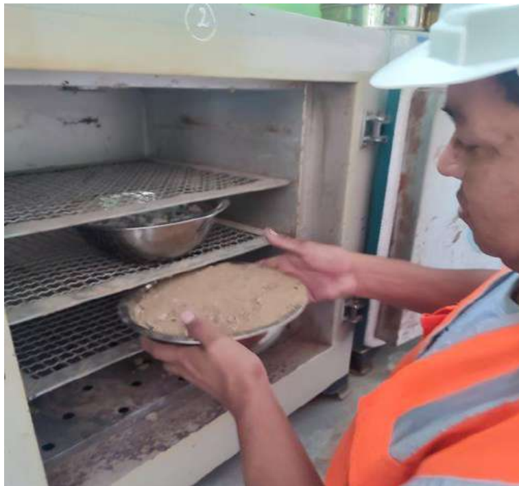
Fotografía 6. Secado del agregado fino para determinar el contenido de humedad.
