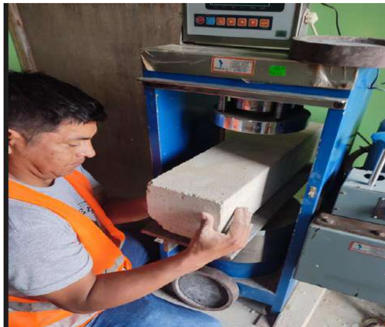
Fotografía 17. Colocación de vigas en máquina de Ensayo de Flexión.
