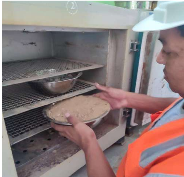
Fig. 6 Ensayo del contenido de humedad del árido fino
