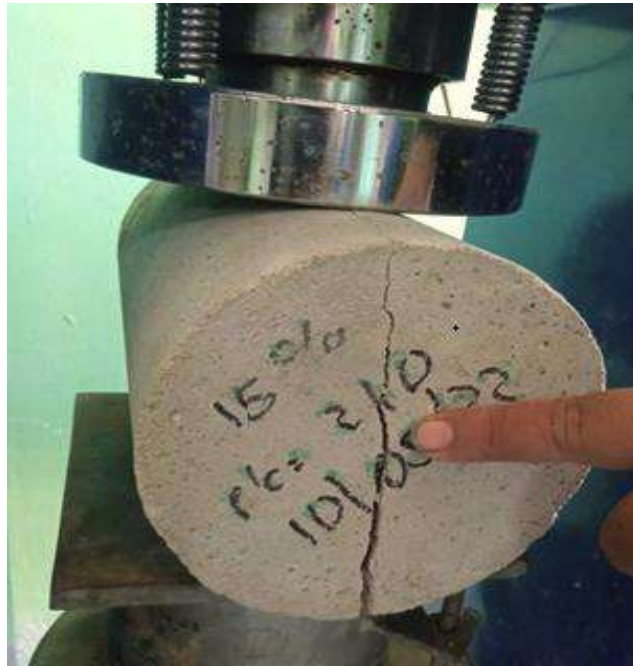
Fig. 19 Ensayo de resistencia a la tracción.
