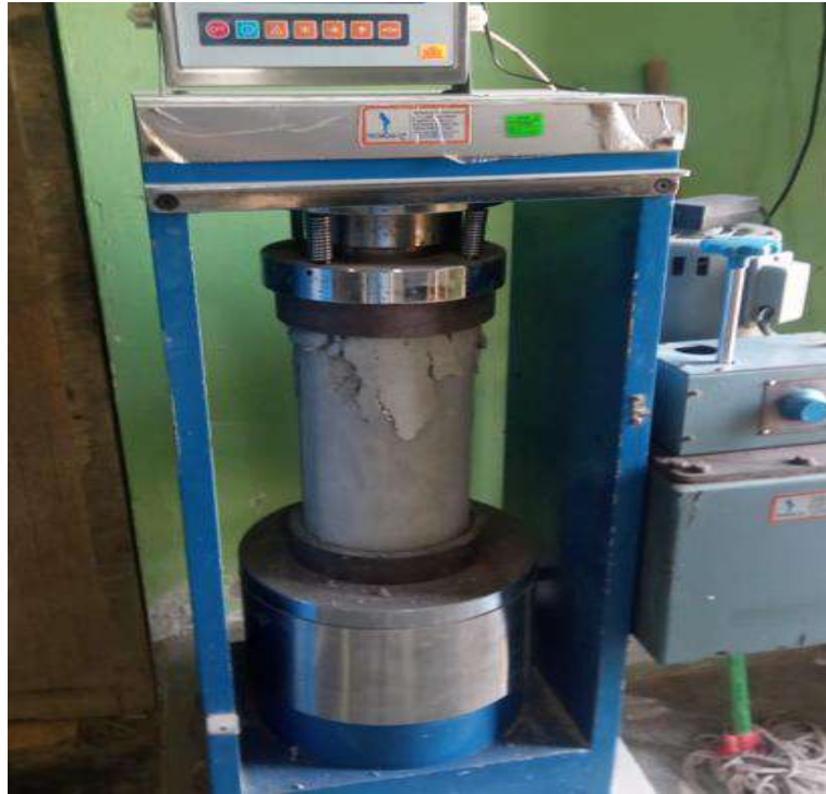
Fotografía 16. Rotura de probetas cilíndricas.
