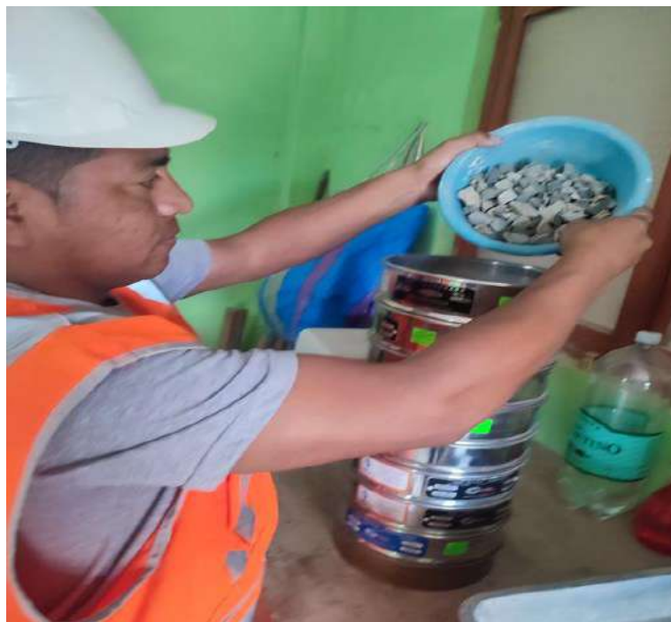
Fotografía 2. Análisis granulométrico de agregado grueso
