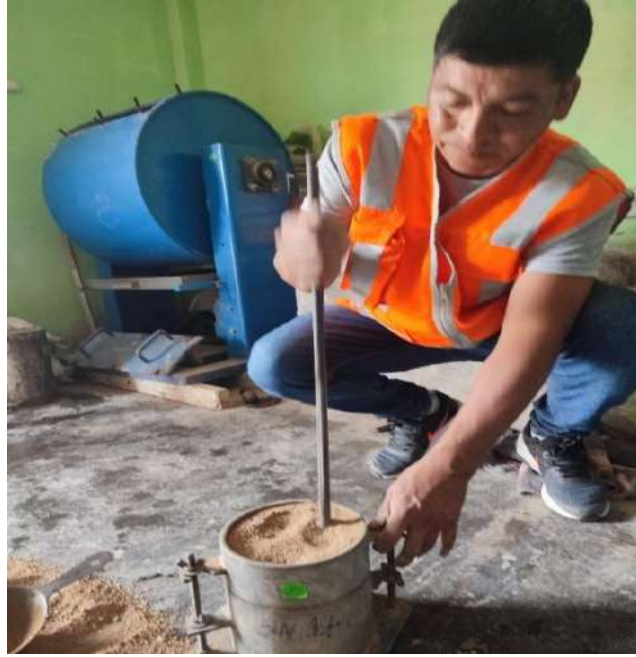
Fig. 10 Peso unitario compactado del agregado fino Nota: Realizado en el laboratorio
