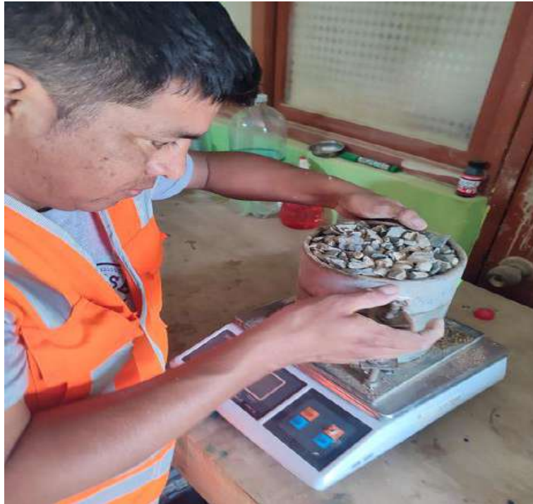
Fotografía 3. Ensayo de Peso unitario del agregado grueso.
