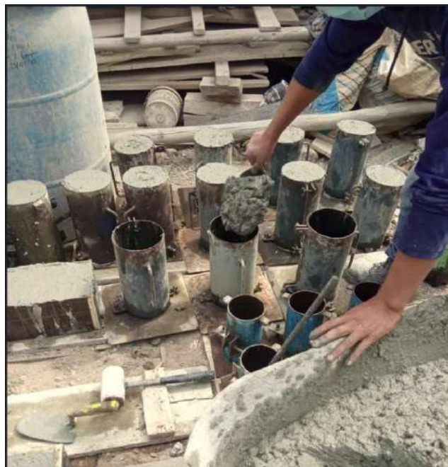
Fig. 15 Elaboración de especímenes.
