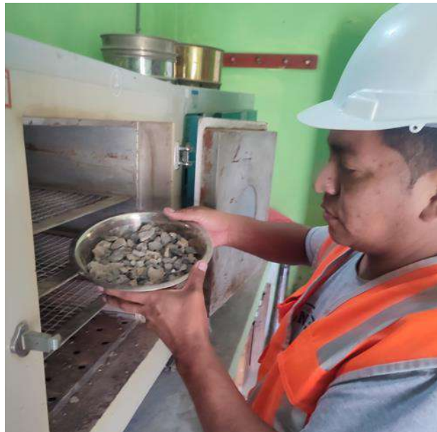
Fig. 7 Ensayo del contenido de humedad del árido grueso
