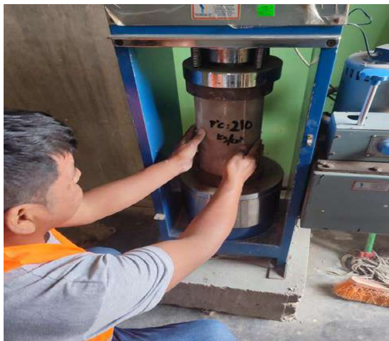
Fotografía 15. Ensayo de compresión de las probetas cilíndricas.
