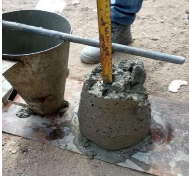
Fig. 13 Asentamiento del concreto con CA y FP
