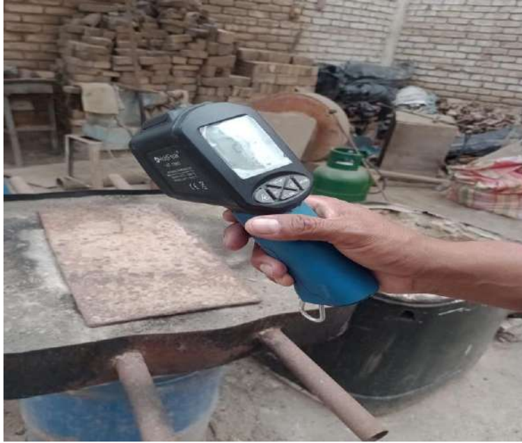
Fotografía 25. Termómetro de medir la óptima temperatura de quemado.
