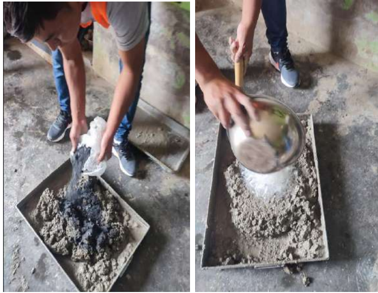
Fotografía 9. Elaboración de la mezcla del concreto adicionando ceniza de aserrín y fibras de polipropileno
