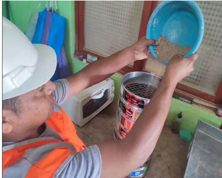
Fotografía 1. Análisis granulométrico de agregado fino.
