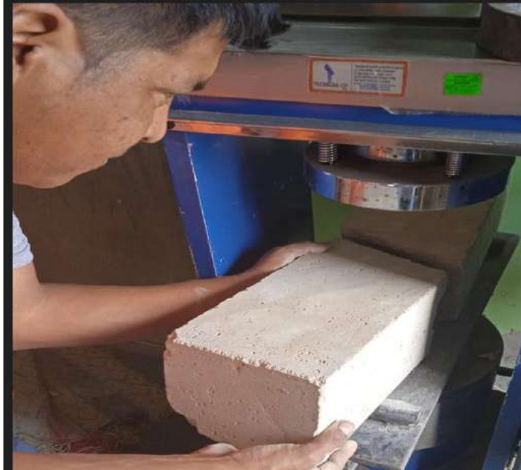
Fotografía 18. Rotura de vigas rectangulares
