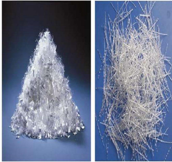
Fig. 3 Fibras de polipropileno. Microfibras y microfibras.
