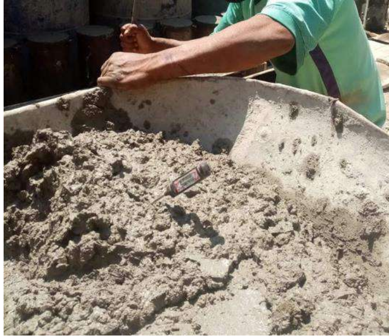
Fotografía 11. Ensayo de Temperatura
