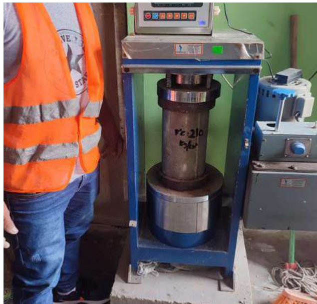
Fig. 18 Ensayo de resistencia a la compresión.
