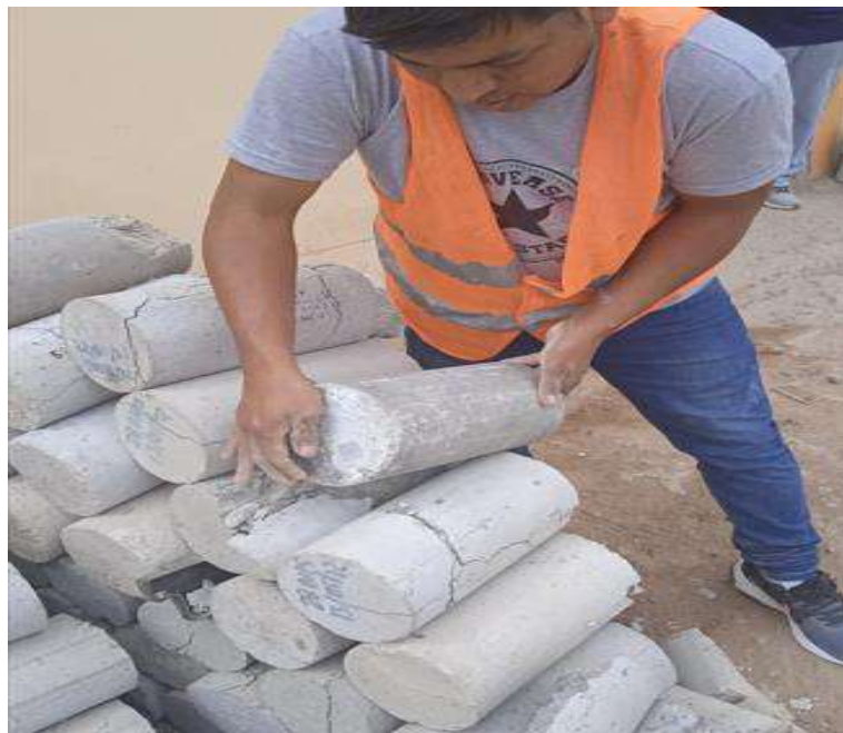
Fotografía 20. Rotura de probetas en el Ensayo de compresión y Tracción. Probetas tras ser sometidas a ensayos de compresión y tracción.
