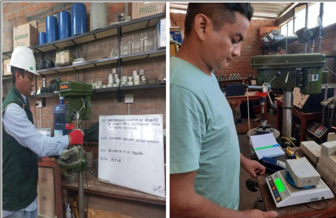
**Fig. 31.** Ensayo de abrasión de adoquines
