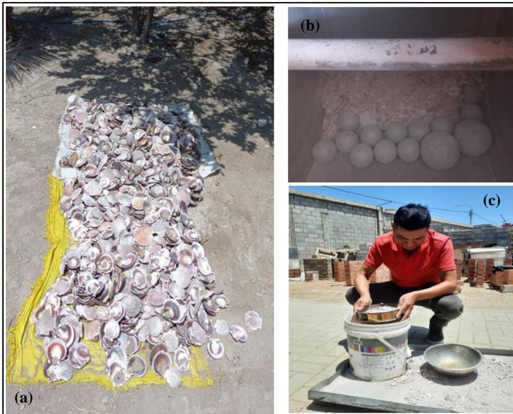
**Fig. 24.** Preparación de CA para diseño. (a) Secado, (b) triturado y (c) tamizado de la concha de abanico.
