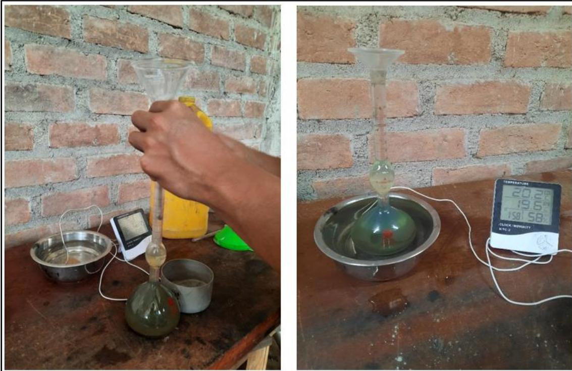
**Fig. 23.** Peso específico del cemento
