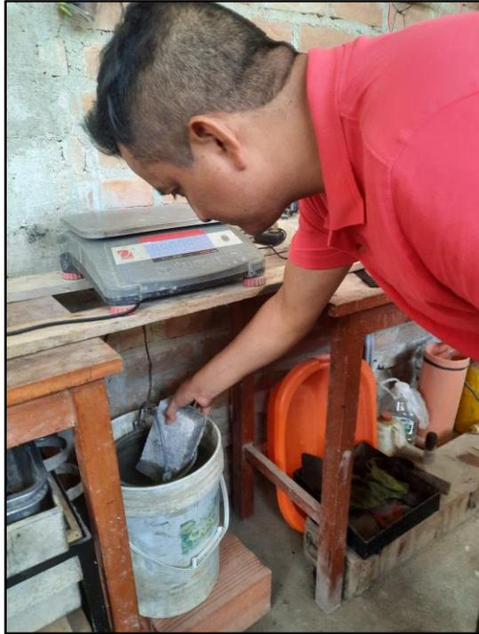
**Fig. 30.** Ensayo de densidad y absorción de adoquines.
