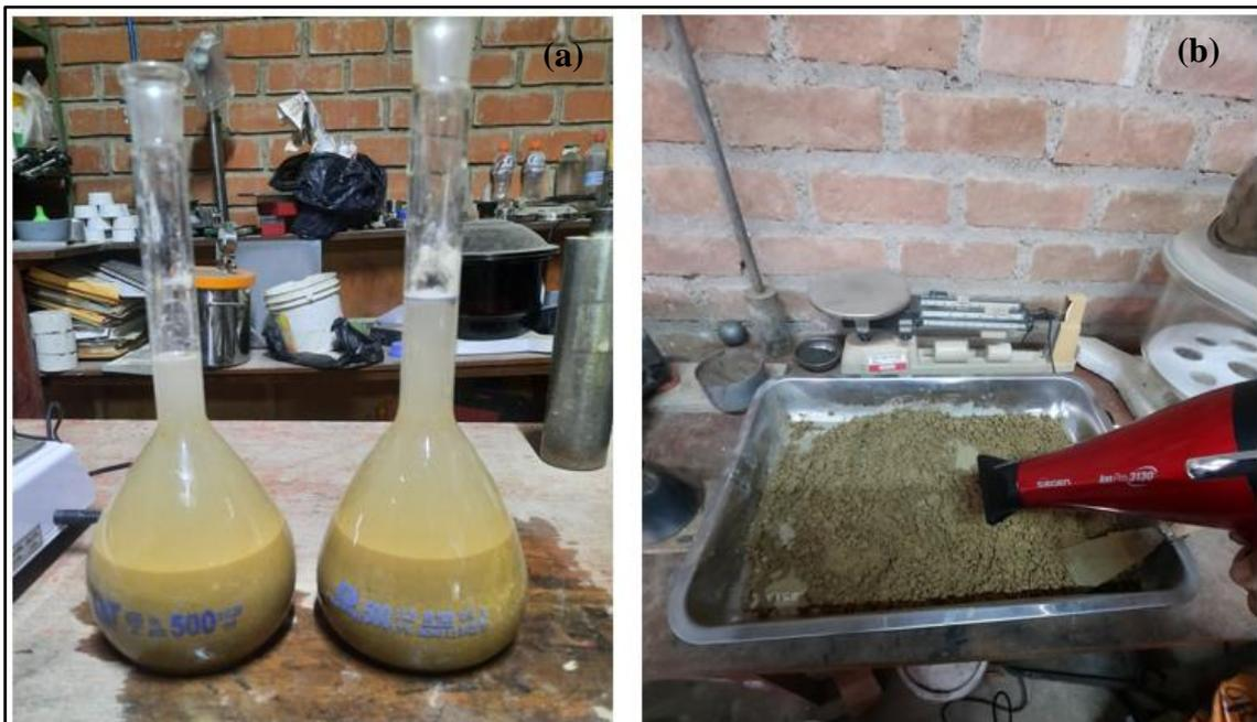
**Fig. 22.** Ensayos del agregado fino. (a) Ensayo de peso específico, (b) absorción del agregado fino.
