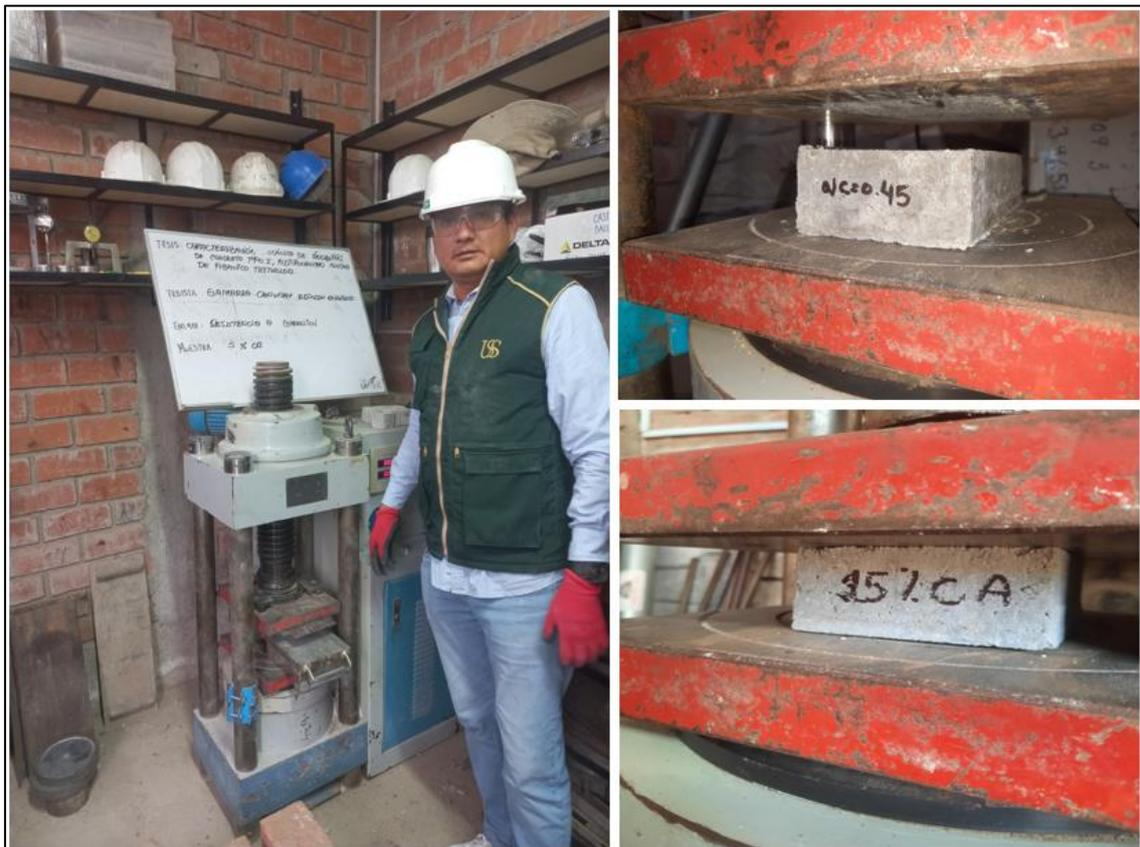
**Fig. 28.** Ensayo de compresión de adoquines
