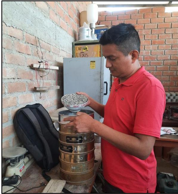
**Fig. 21.** Ensayo granulométrico de agregado grueso.
