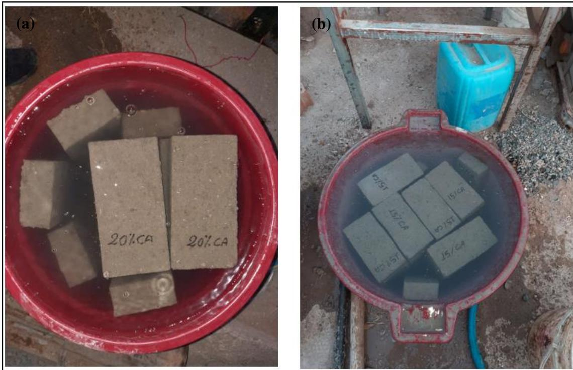
**Fig. 27.** Curado de adoquines. (a) adoquines al 20% de CA, (b) adoquines al 15% de CA.
