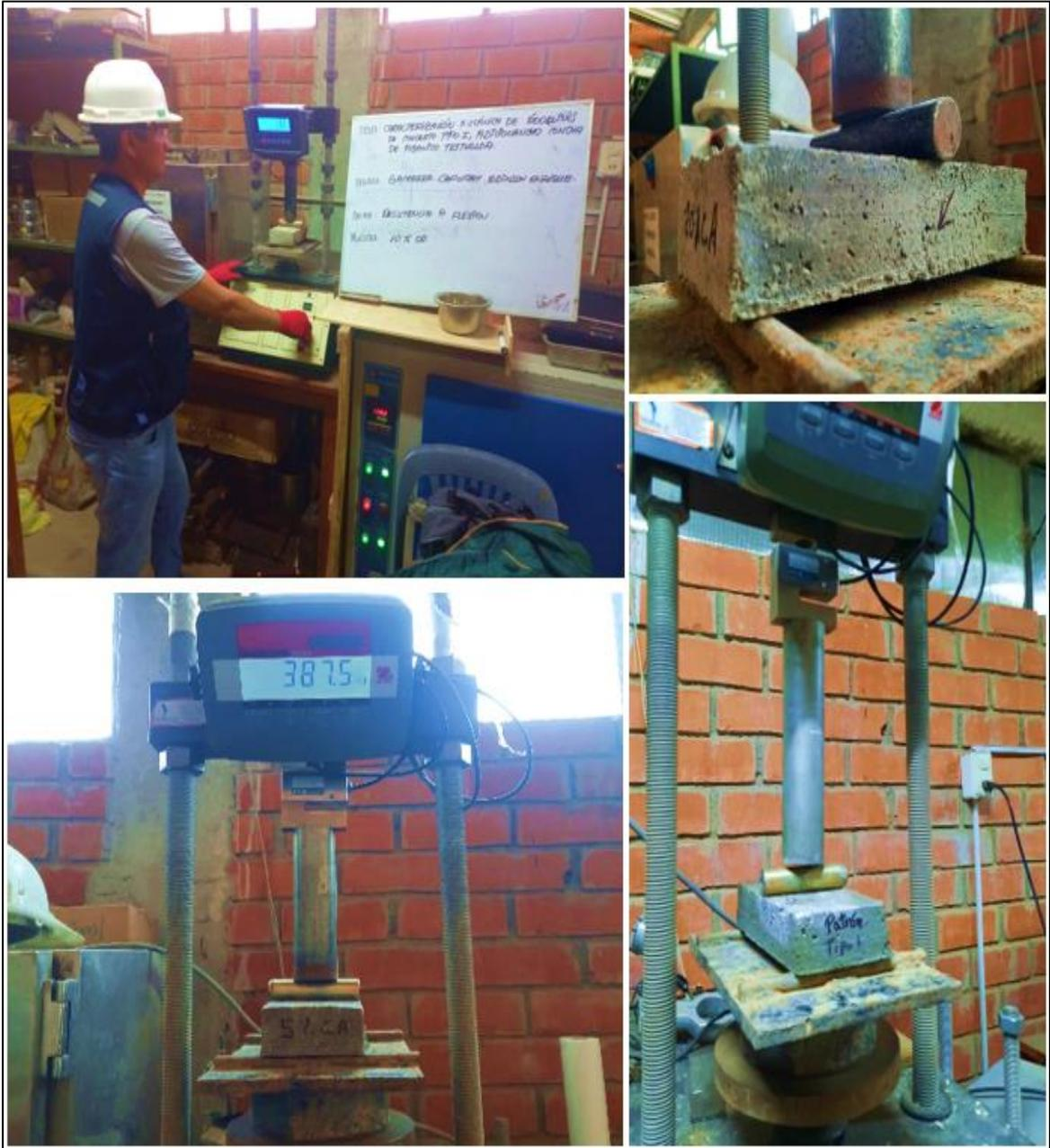
**Fig. 29.** Ensayo de flexión de adoquines
