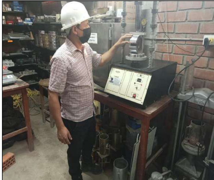
Fig. 18. Determinación de las propiedades mecánicas de las briquetas patrón y briquetas con adición de PEAD
