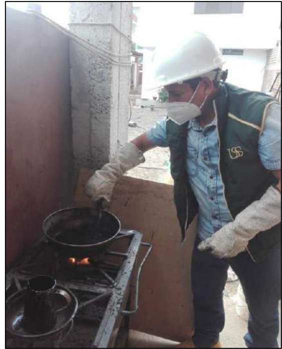
Fotografía 06. Preparación de mezcla asfáltica caliente
