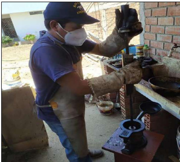
Fig. 17. Elaboración de briquetas para tres tipos de tránsito liviano, mediano y pesado.
