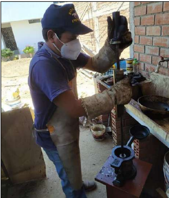
Fotografía 07. Compactación de briquetas para los 3 tipos de tránsito.
