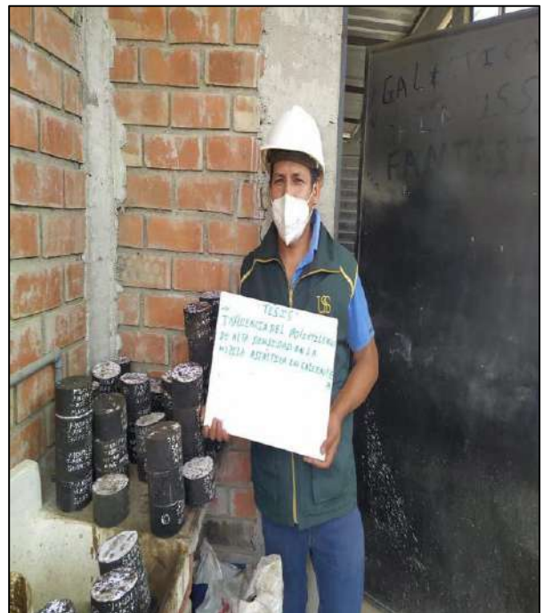
Fotografía 08. Briquetas listas para ensayar por la prensa de Marshall.
