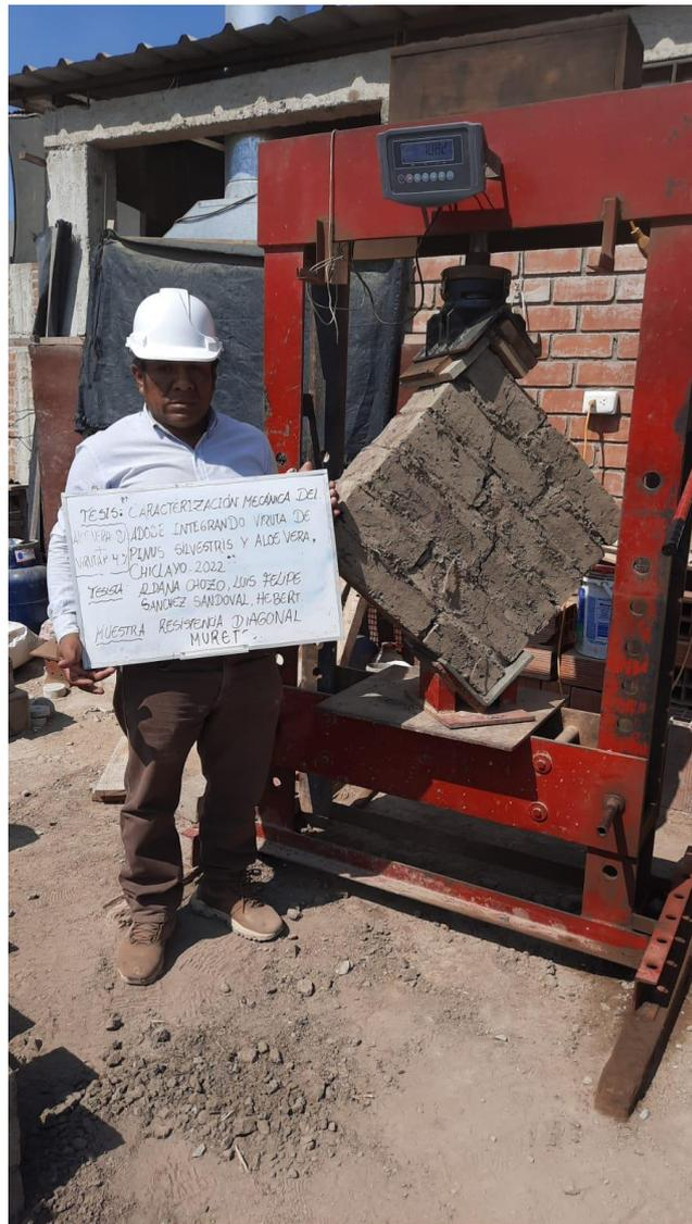
**Anexo 69- Ensayo – Resistencia a la compresión en pilas 8% Aloe vera + 2% Pinus sivestris**
