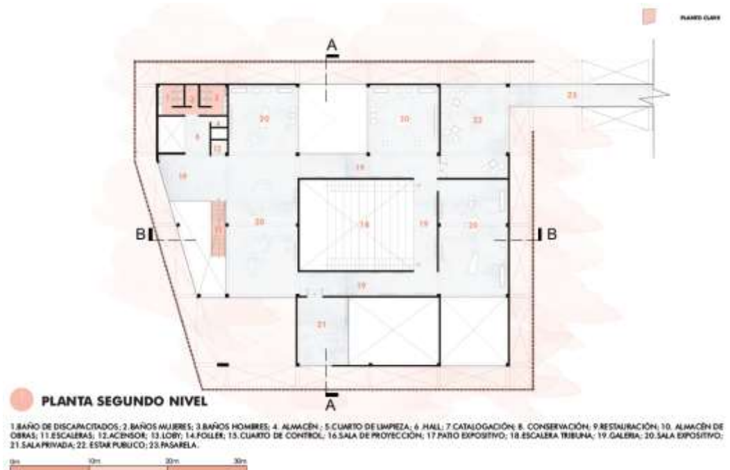
Figura 60: Planta segundo nivel bloque Museo Elaboración: Propia
