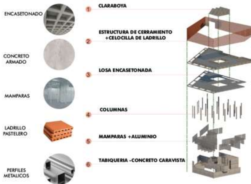
Figura 52: Sistema Constructivo Elaboración: Propia
